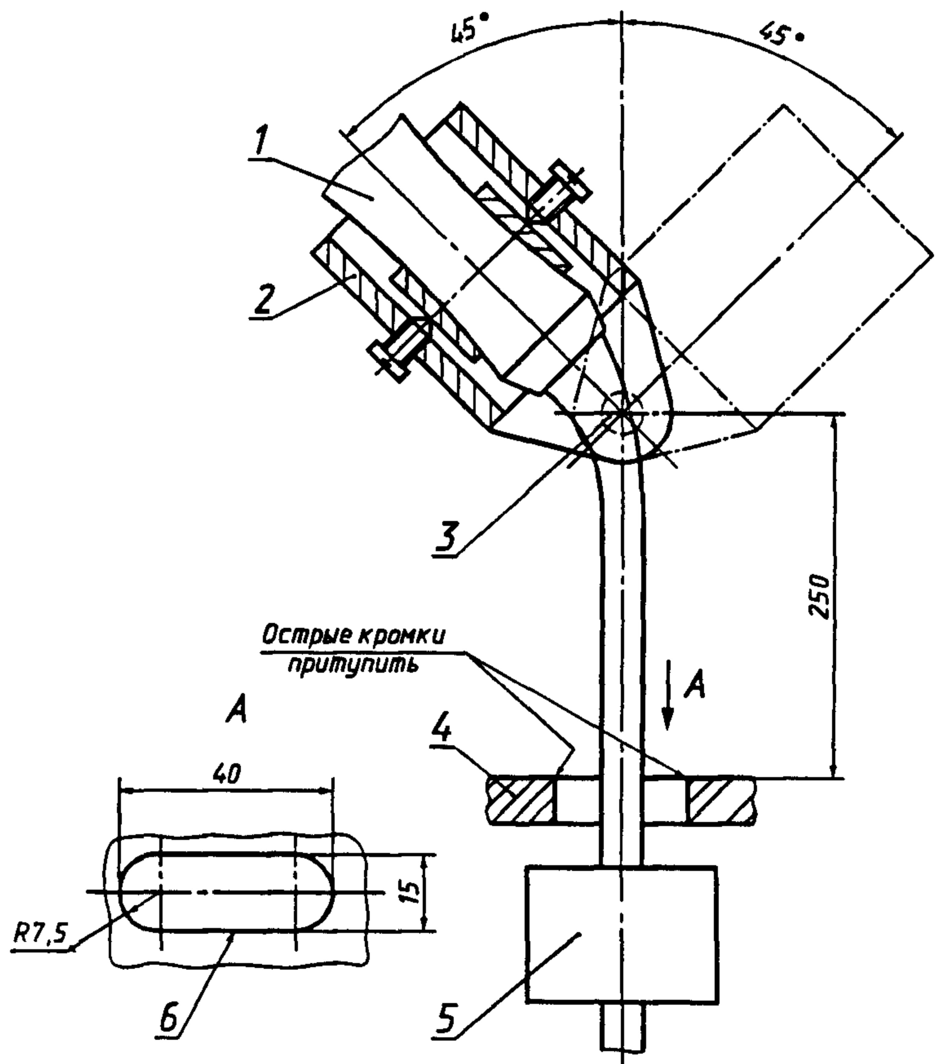
1 — образец; 2 — устройство для крепления образца; 3 — ось качания;
