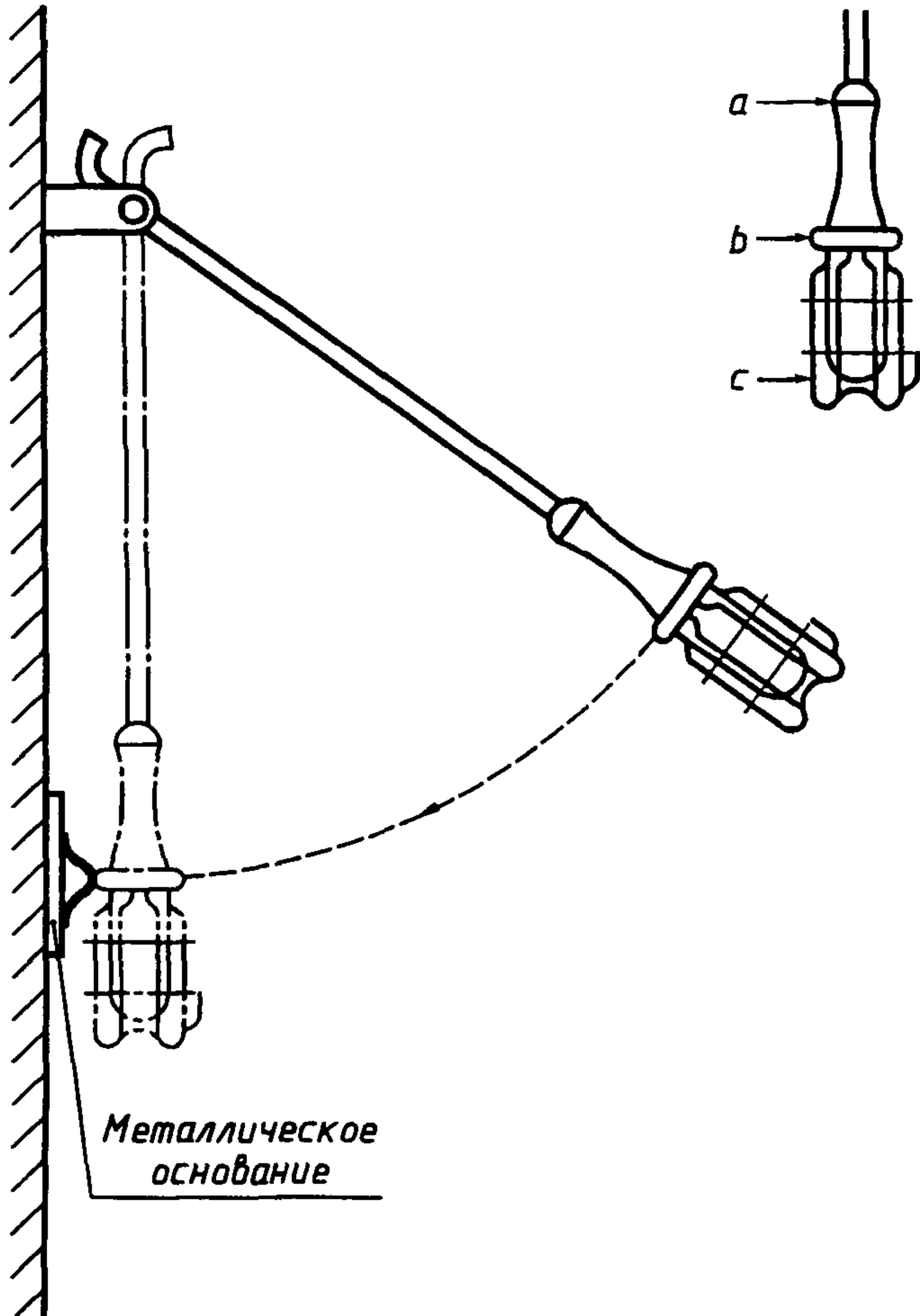
Рисунок 1 — Устройство для испытания светильника на удар
