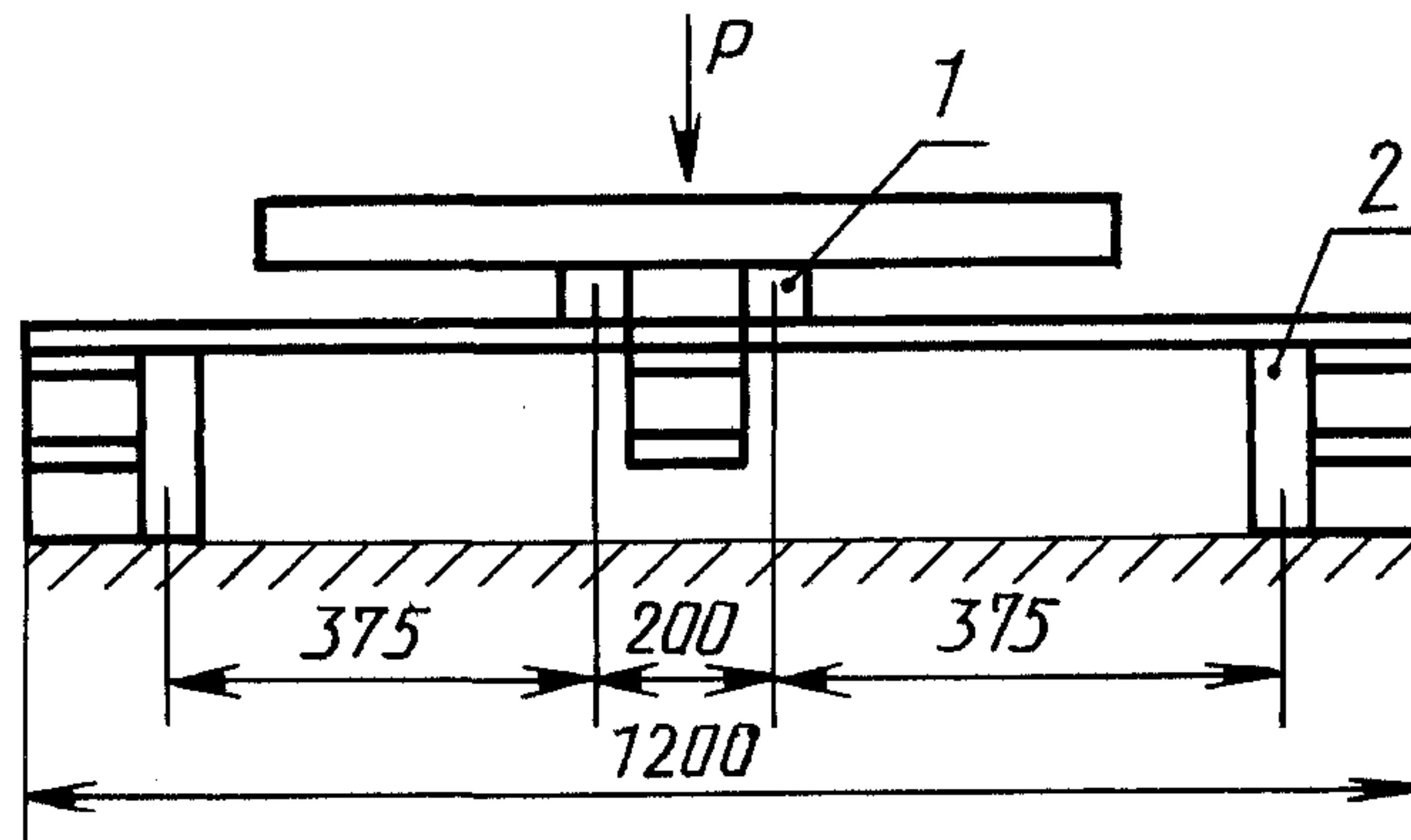
1 — брусок размером 1000 × 50 × 50 мм; 2 — брусок размером 1000 × 50 × 150 мм
