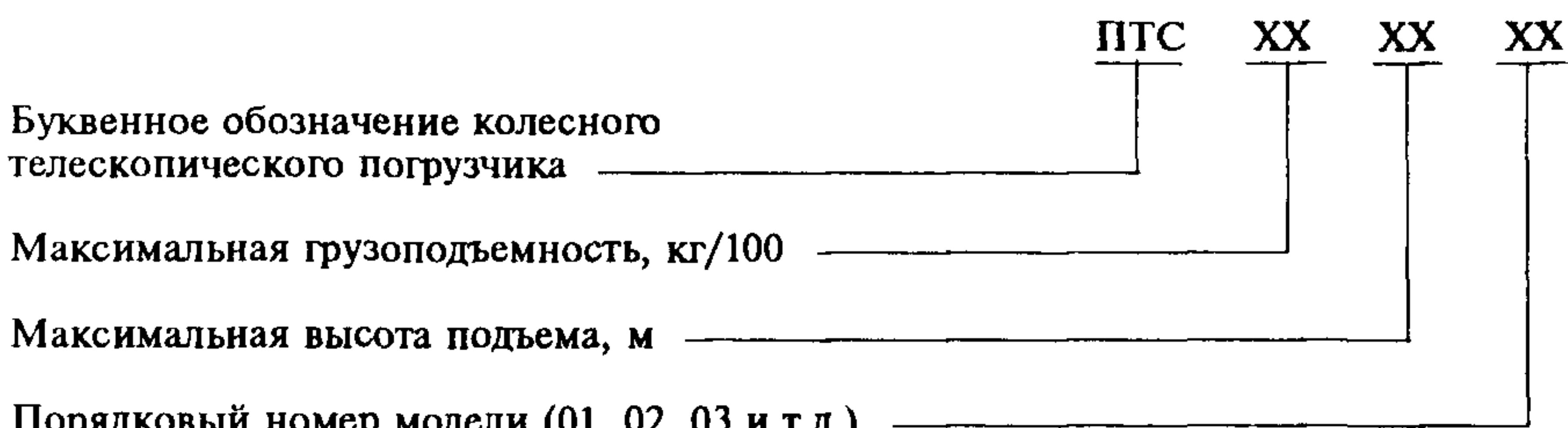
Пример условного обозначения погрузчика с телескопической стрелой с грузоподъемностью 2,5 т, высотой подъема 7 м, третьей модели:
