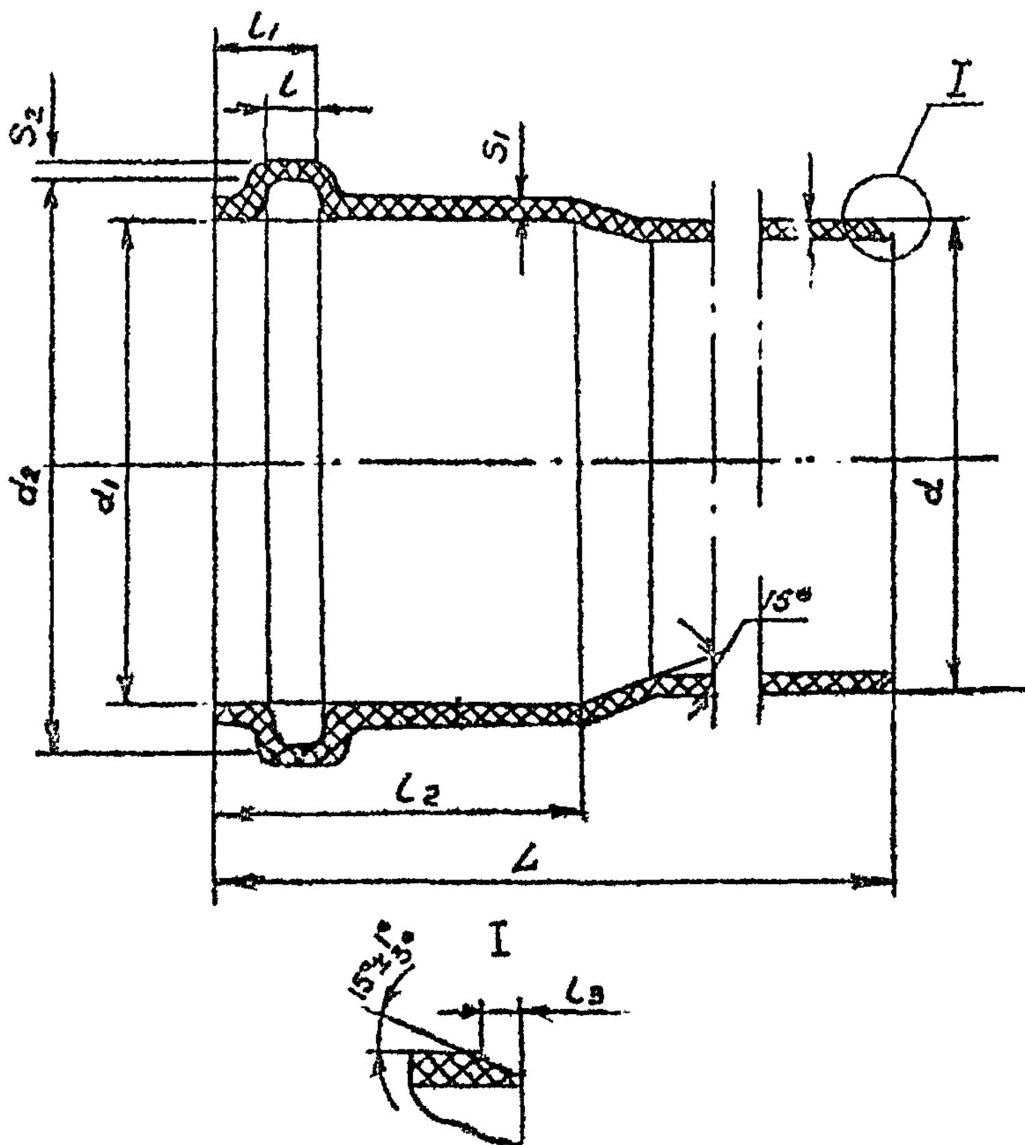
Рис. I. Канализационная раструбная труба из ПВХ
