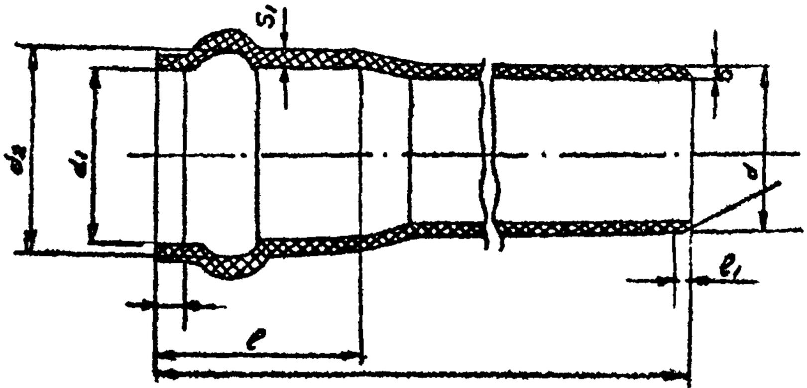
Рис. 2. Напорная раструбная труба из ПВХ
