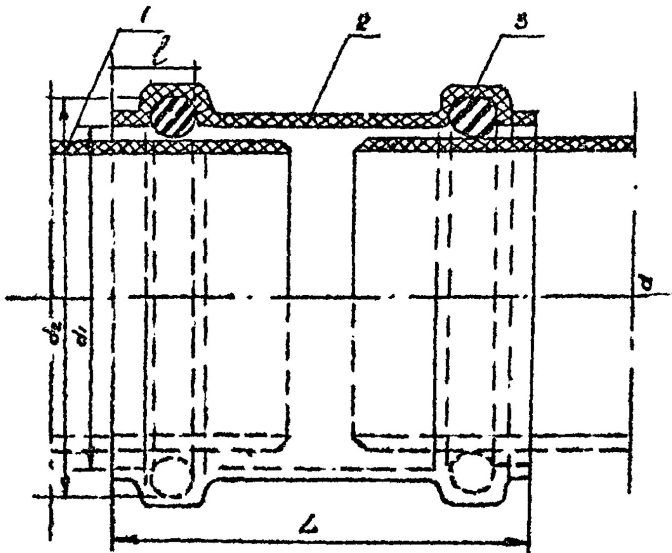
Рис. 36. Соединение канализационных труб из ПВХ на муфте из ПВХ с уплотнением резиновыми кольцами круглого сечения:
