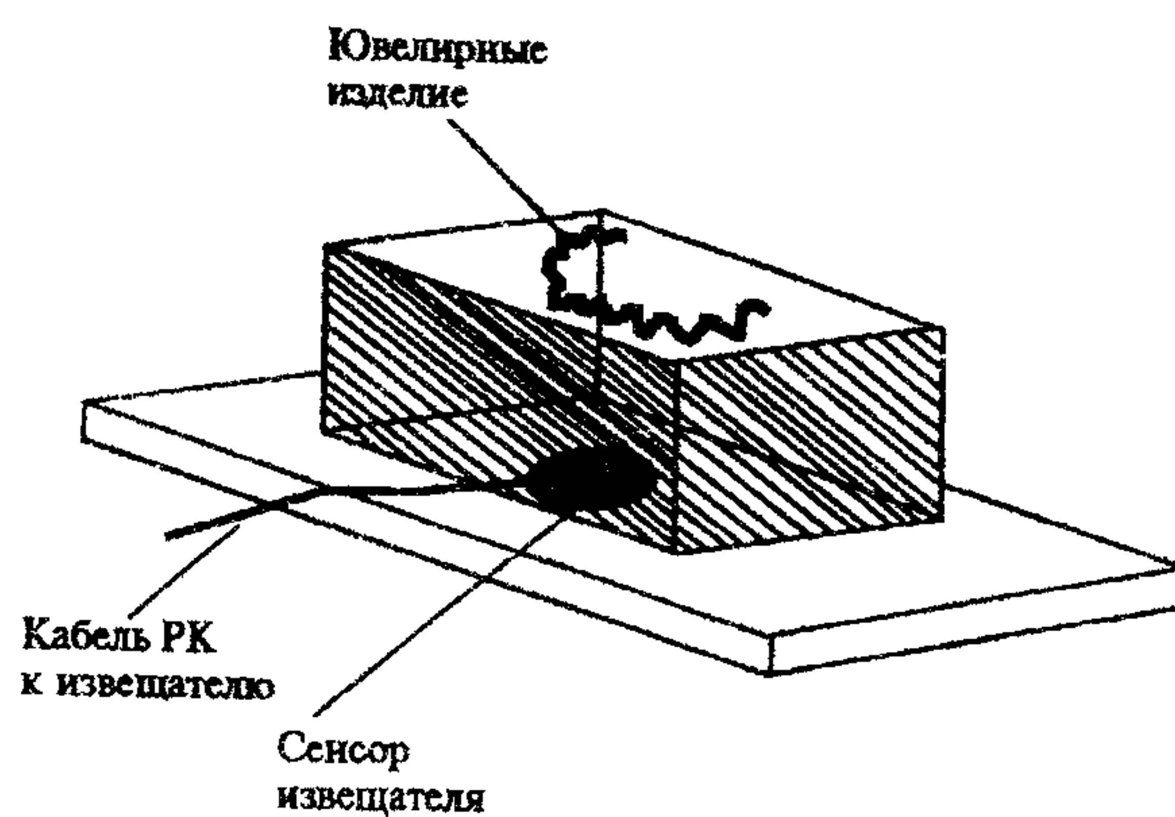
Рис.8. Блокировка отдельных предметов извещателем поверхностным пьезоэлектрическим "Гюрза-050"
