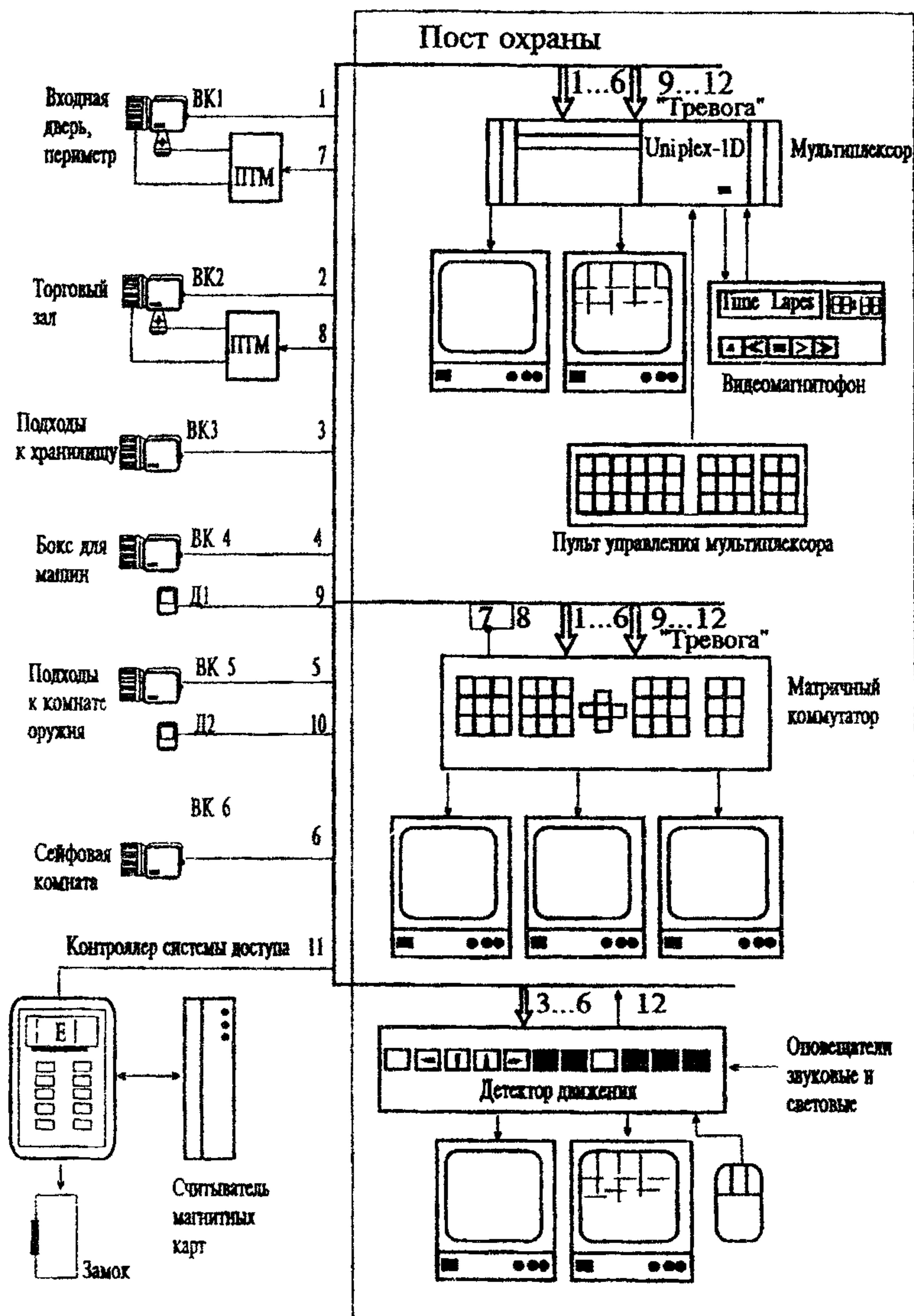
Рис.2. Примерная структурная схема оборудования объекта системой видеоконтроля.
