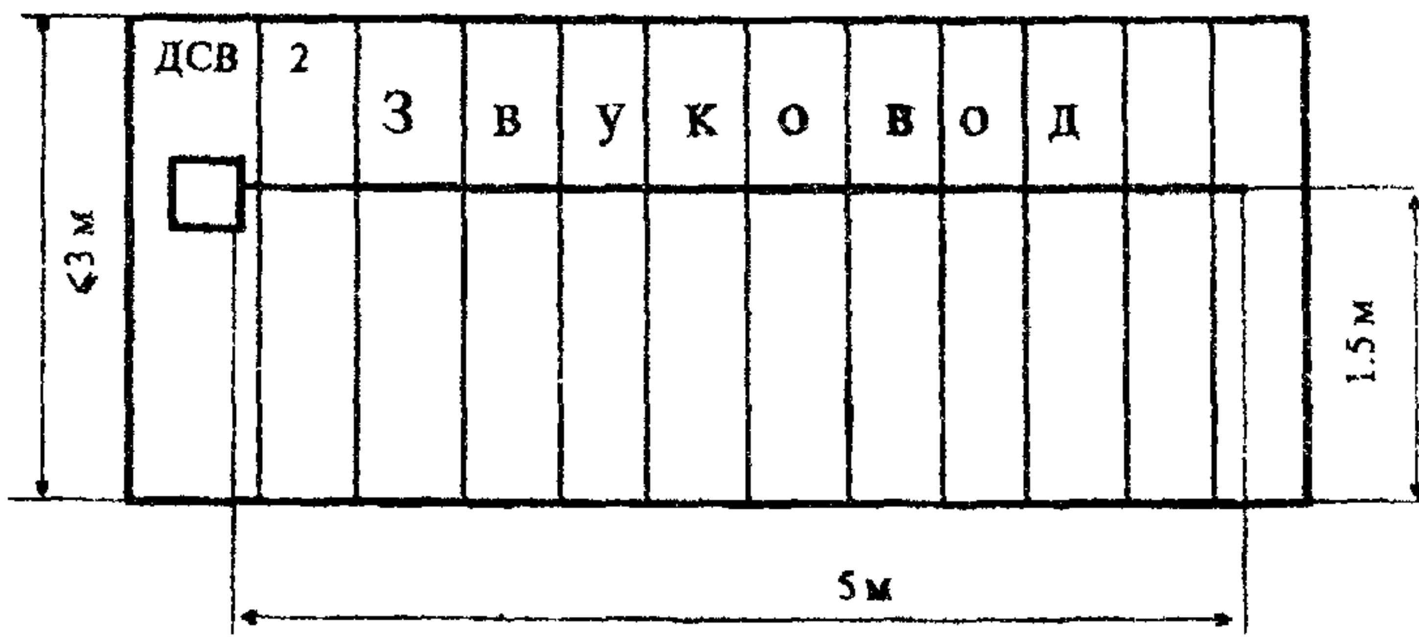
Рис.7. Блокировка стен, потолка и пола на пролом извещателем
