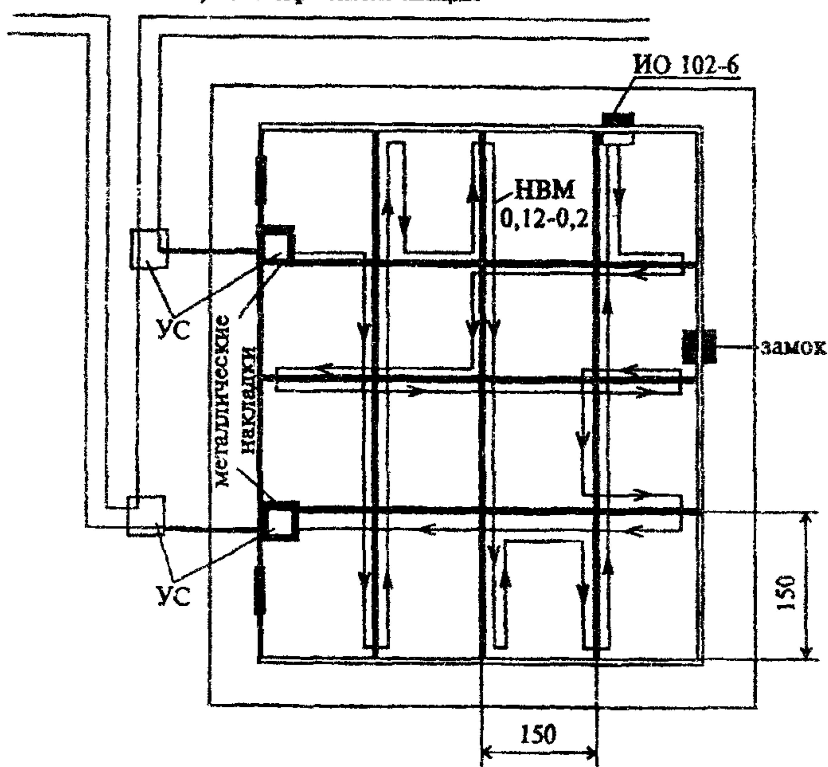
Рис.4 Блокировка оконных решеток , решеток воздуховодов и решетчатых дверей проводом НВМ
