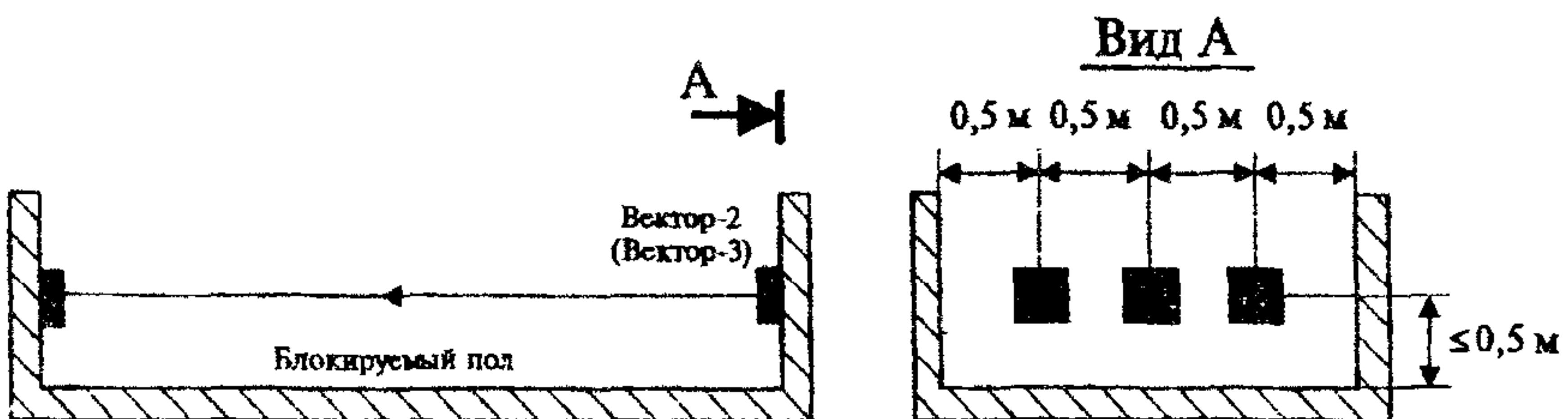
Рис.14. Блокировка стен, потолка и пола на "проникновение" извещателями активными линейными оптико-электронными
