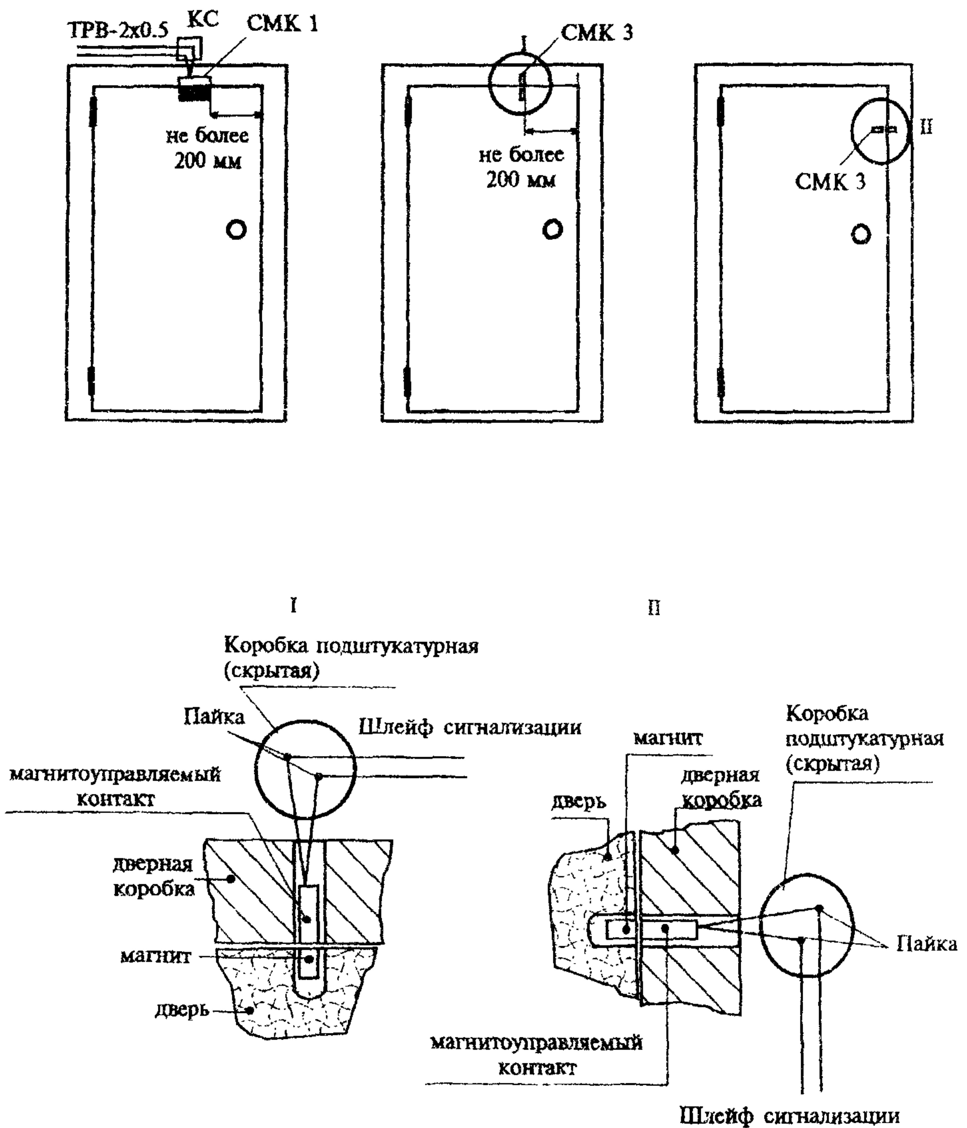
Рис. 1. Блокировка двери на открывание извещателями магнитоконтактными
