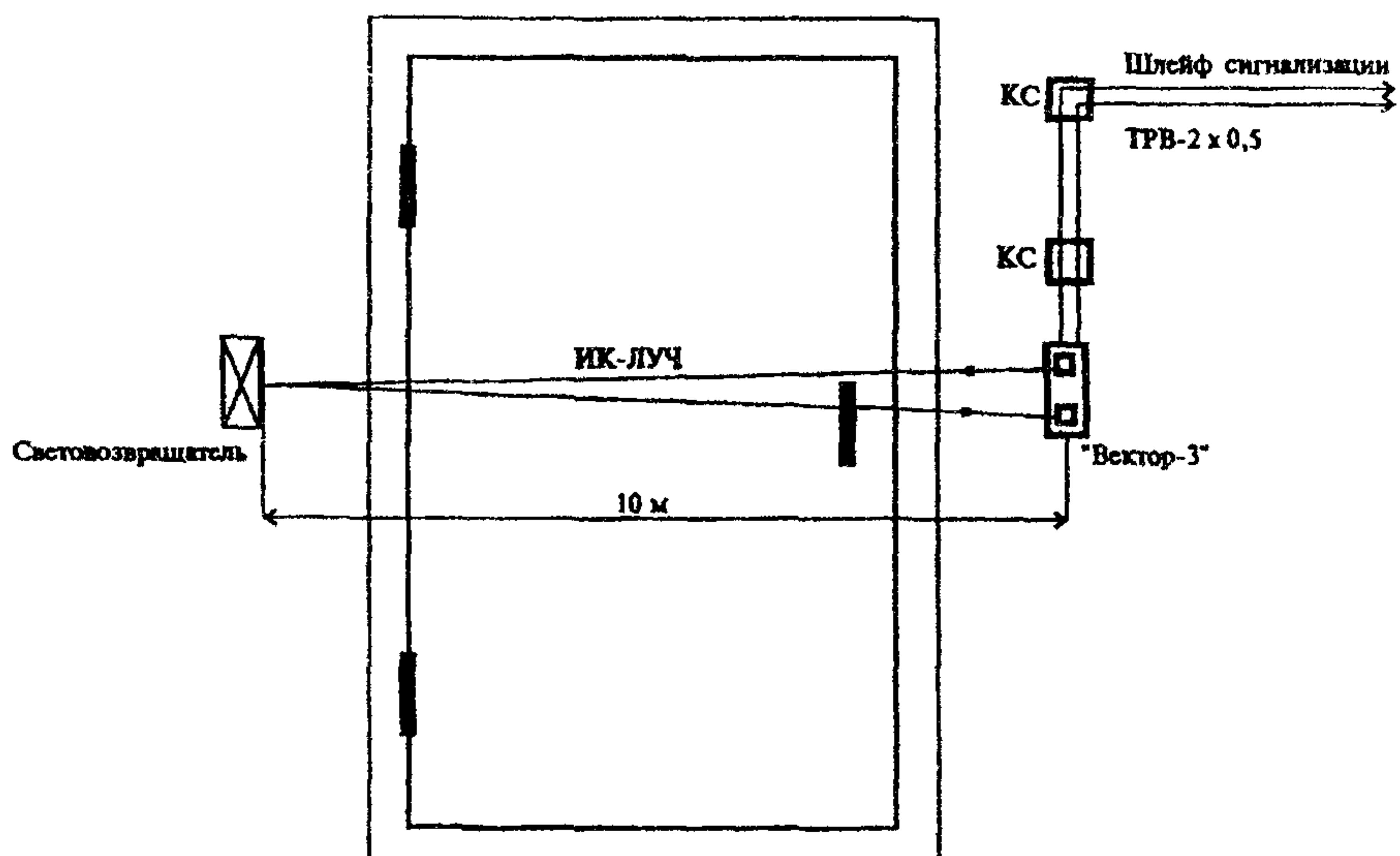
Рис.6. Блокировка дверей (ворот) на открытие извещателями активными линейными оптико-электронными
