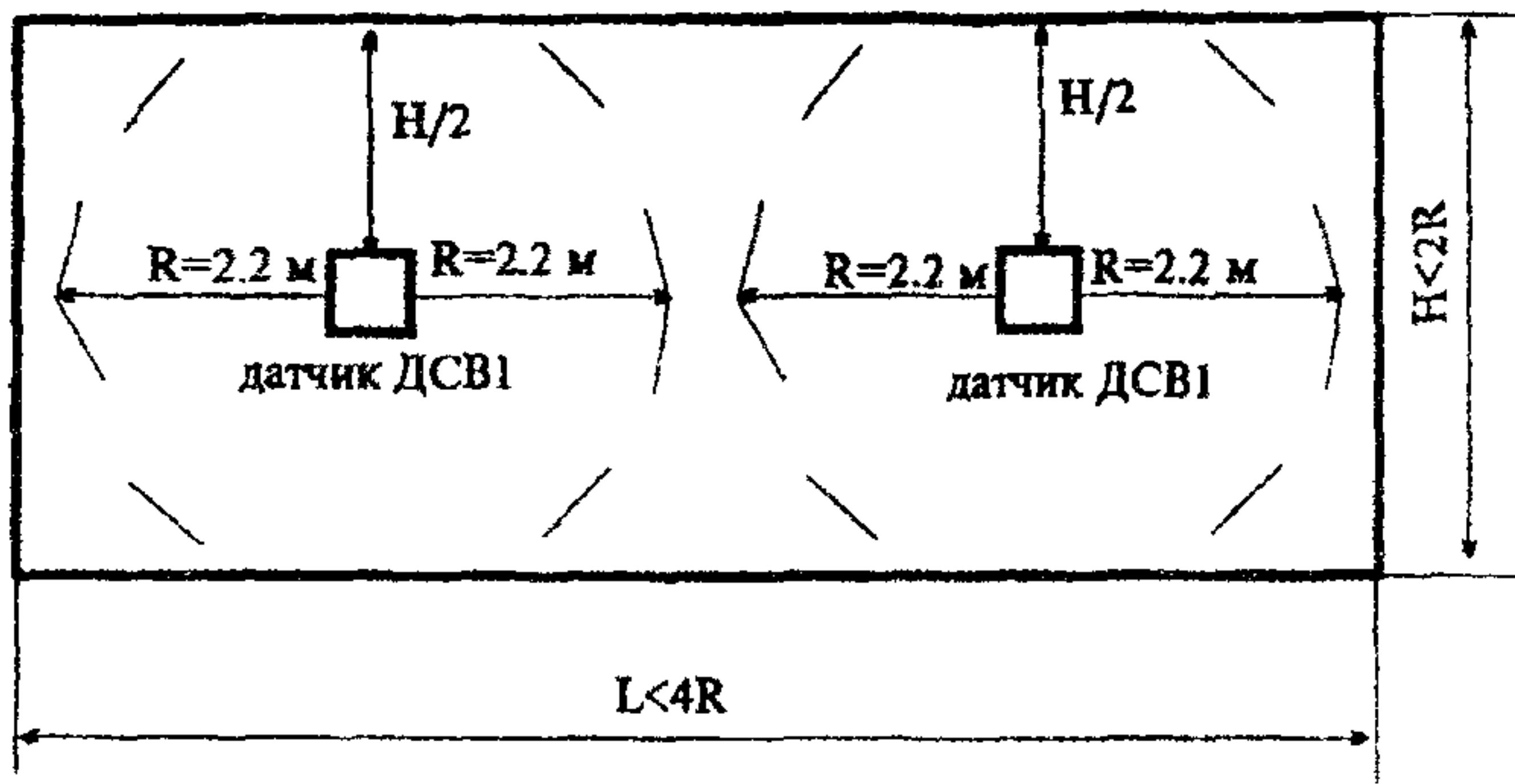
На деревянной конструкции (перегородке)
