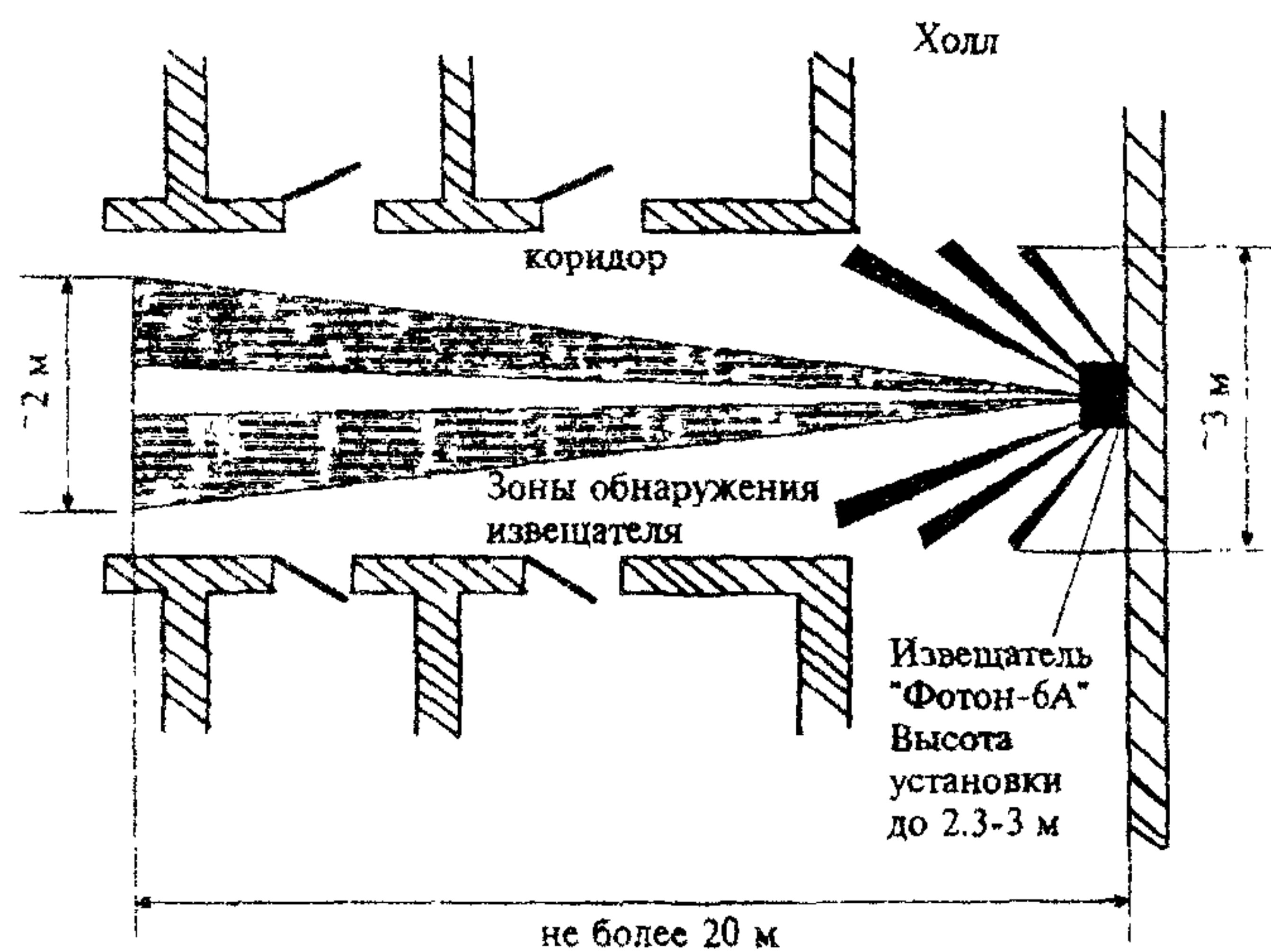
Рис.10. Блокировка коридора извещателями оптико-электронными
