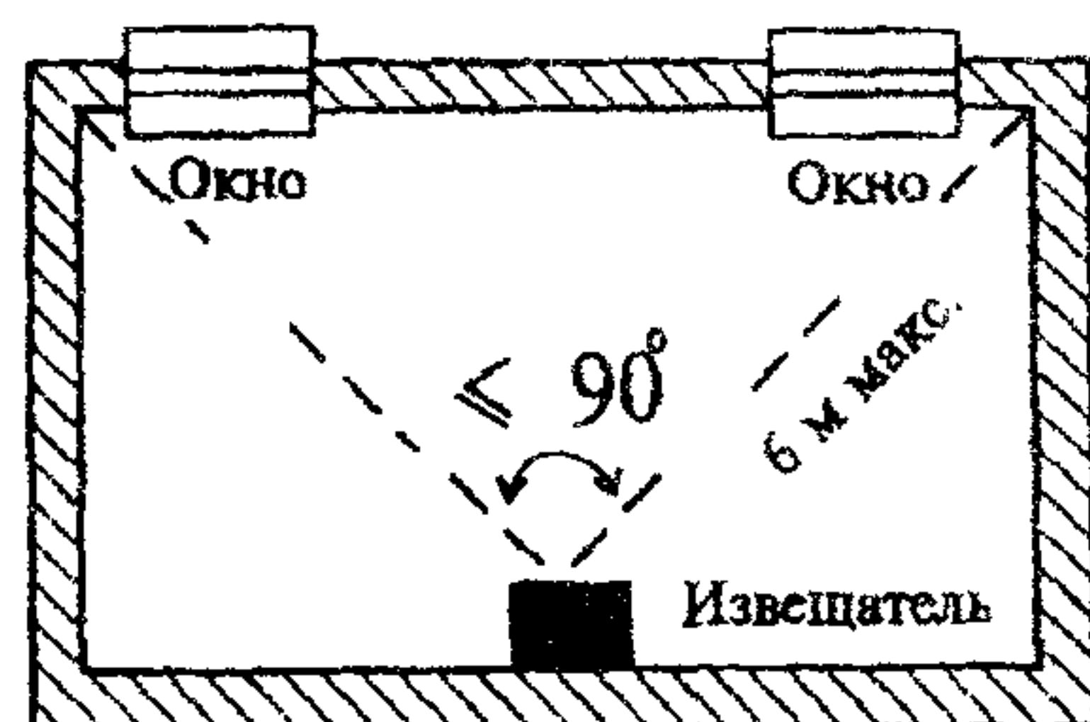
**Рис.2 Варианты установки извещателя охранного
