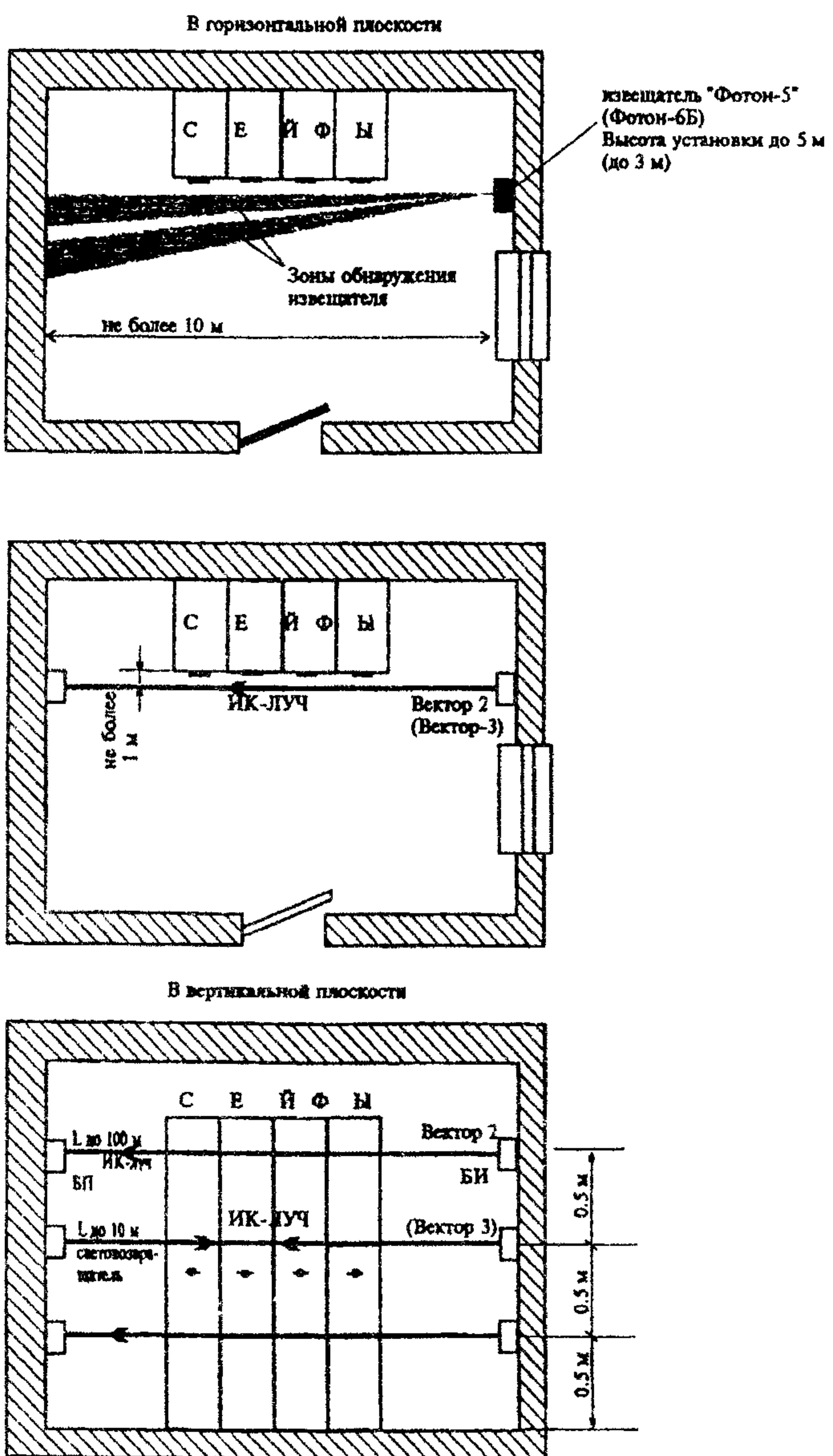
Рис.13. Блокировка сейфов (предметов) извещателями оптико-электронными
