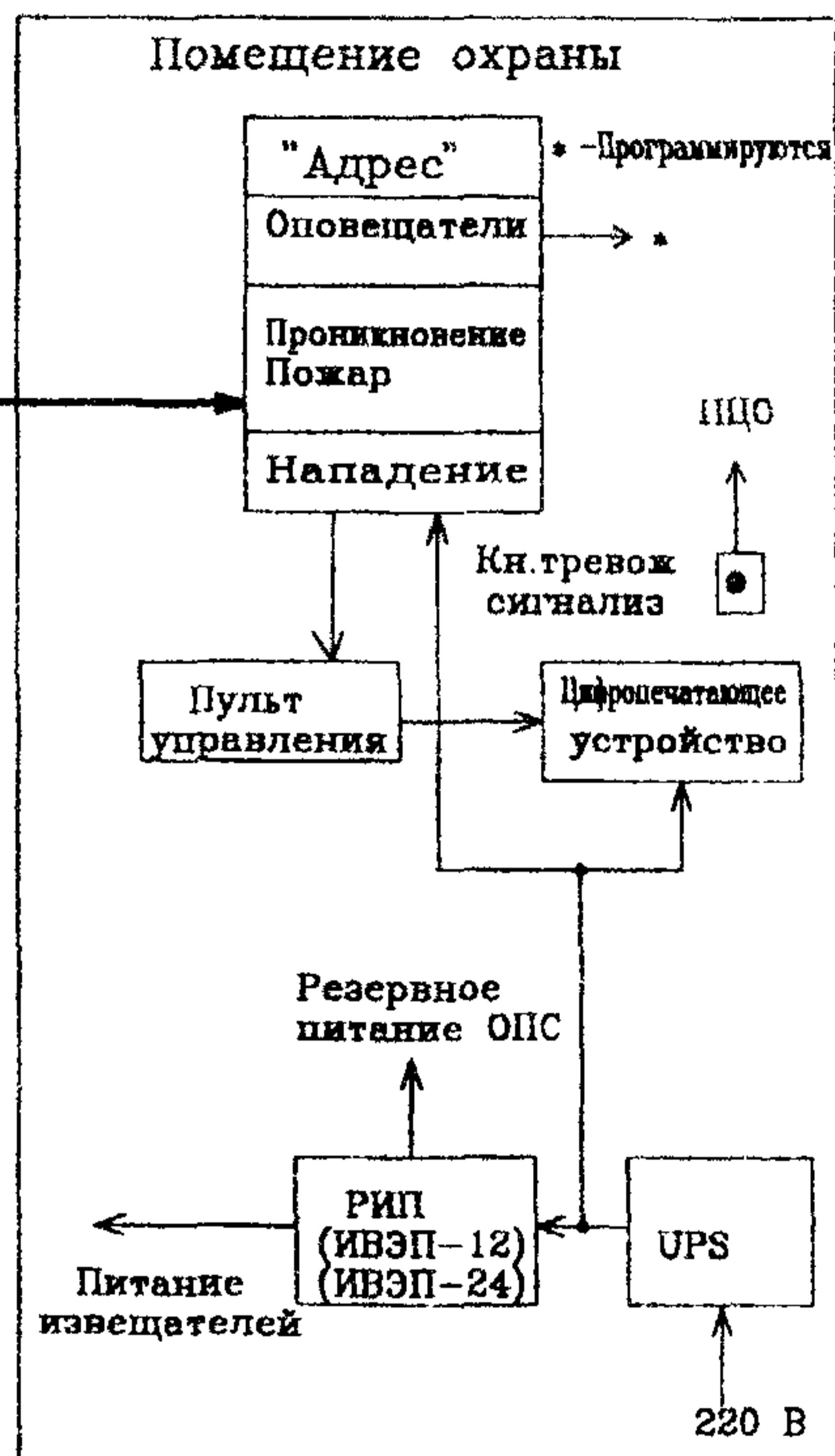
Рис.5. Примерная структурная схема оборудования объекта средствами ОПС на базе прибора "Адрес" по варианту 3.
