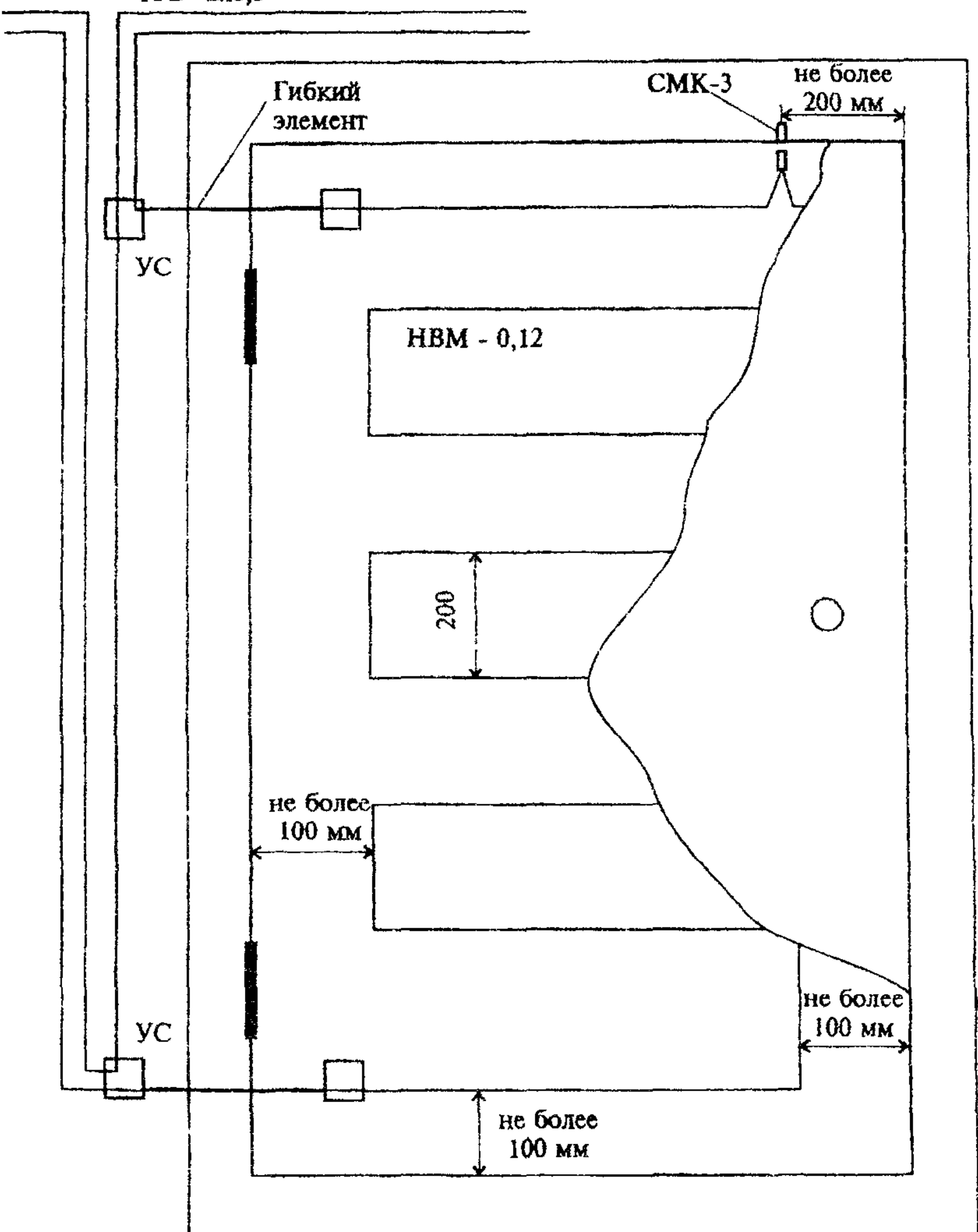
Рис.3 Блокировка дверей (ворот) на открывание и пролом
