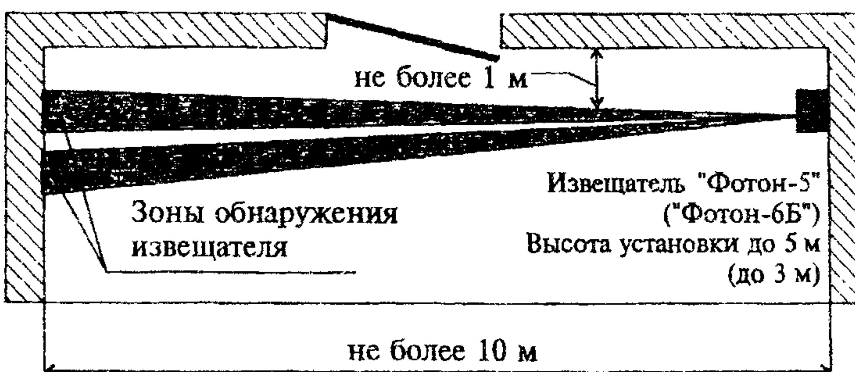
Рис.9. Блокировка двери и окан на проникновение извещателями пассивными оптико-электронными с зоной обнаружения типа "занавес"
