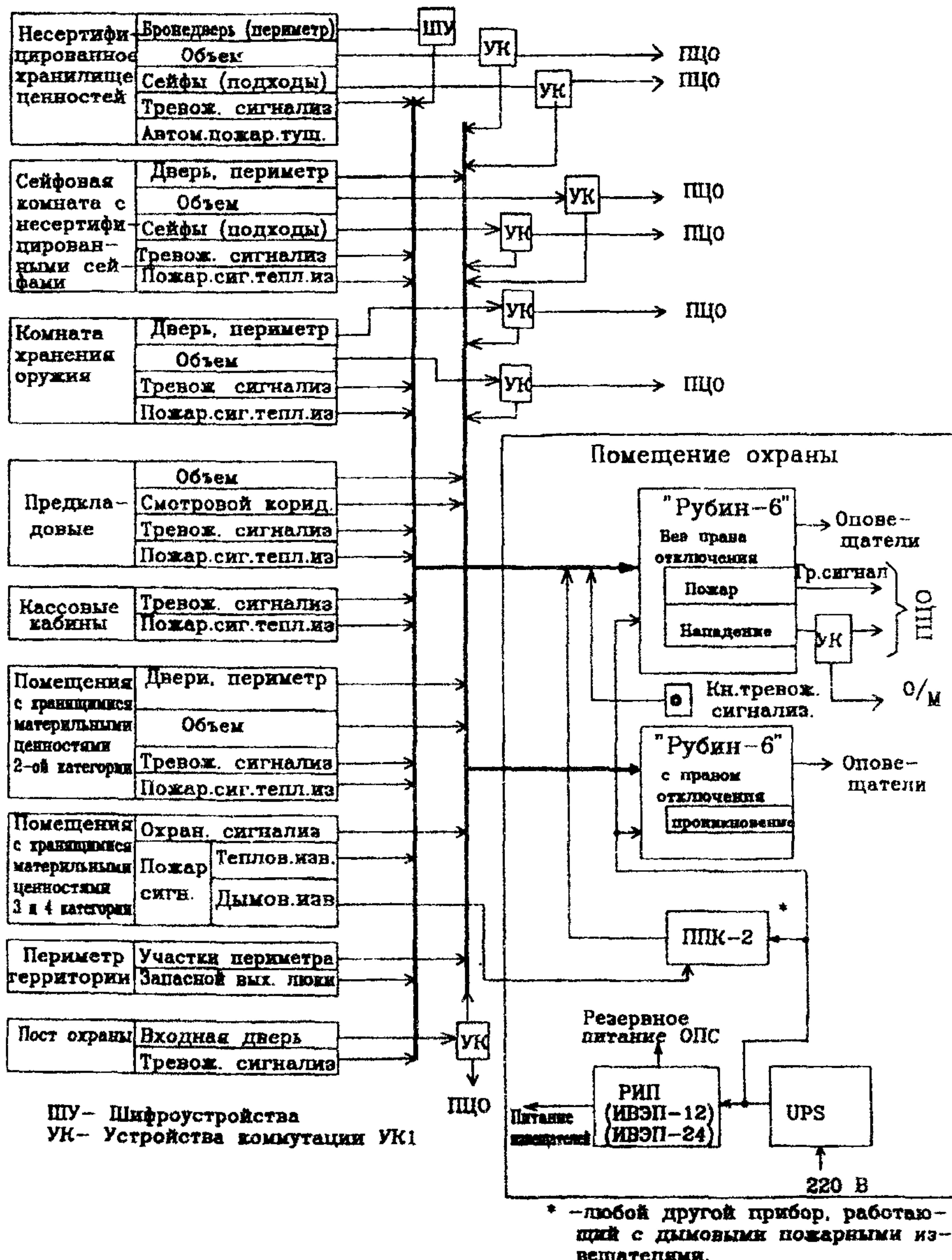
Рис.1. Примерная структурная схема оборудования объекта средствами ОПС на базе прибора "Рубин-6" по варианту 1.
