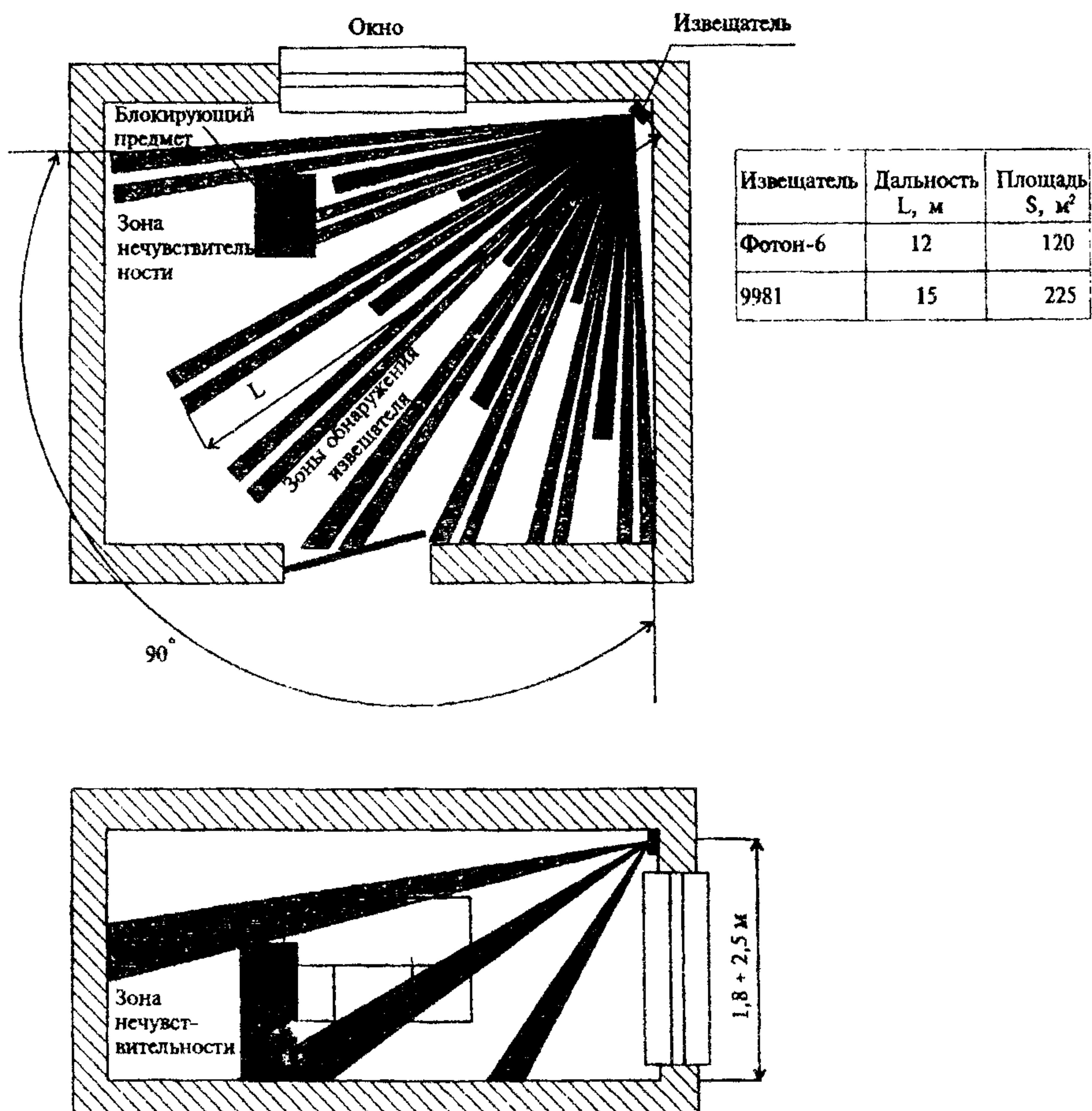
Рис.11. Одновременная блокировка объема и отдельных предметов объемными пассивными оптико-электронными извещателями
