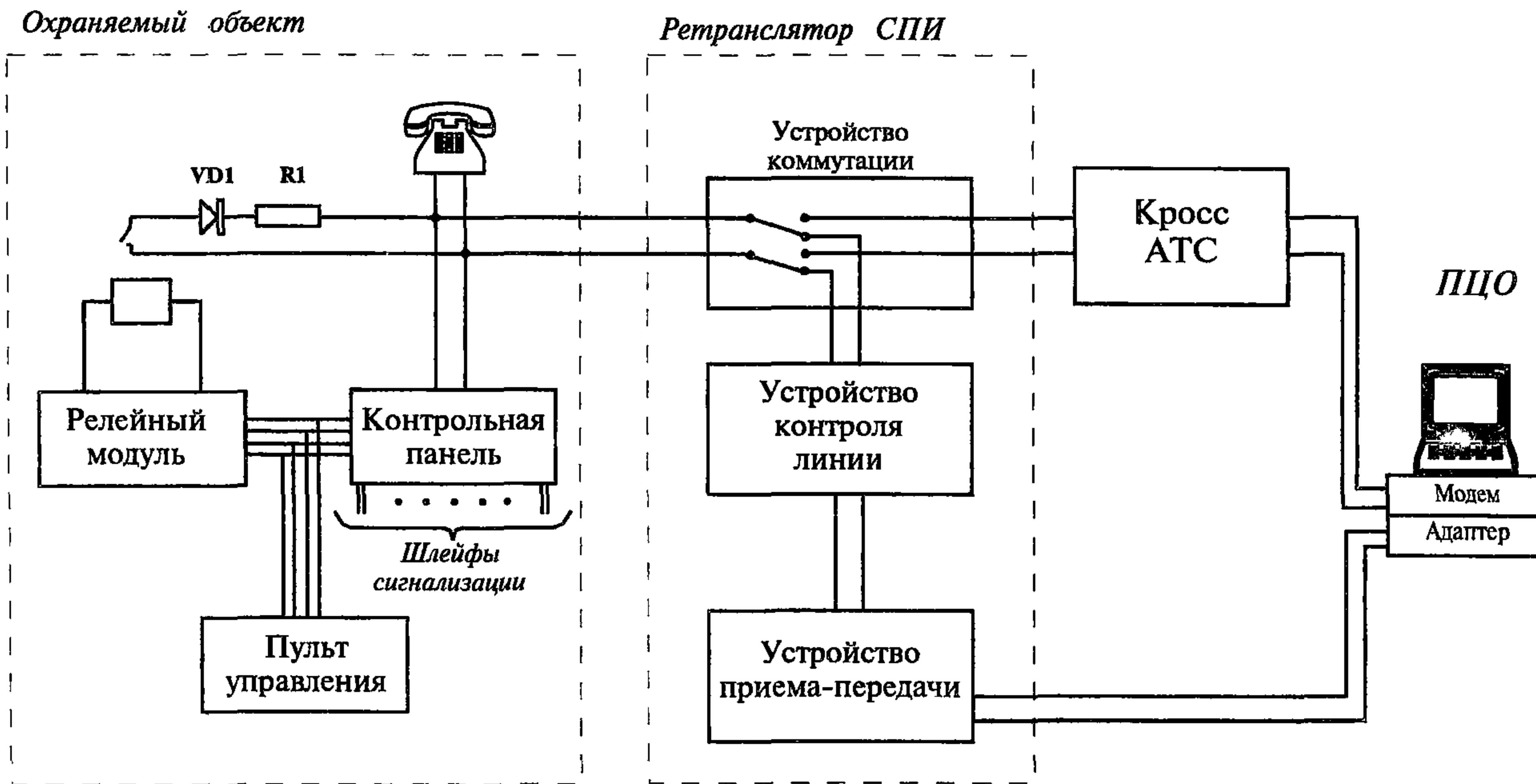
Рисунок 1 - Реализация КСЦО с использованием релейного модуля
