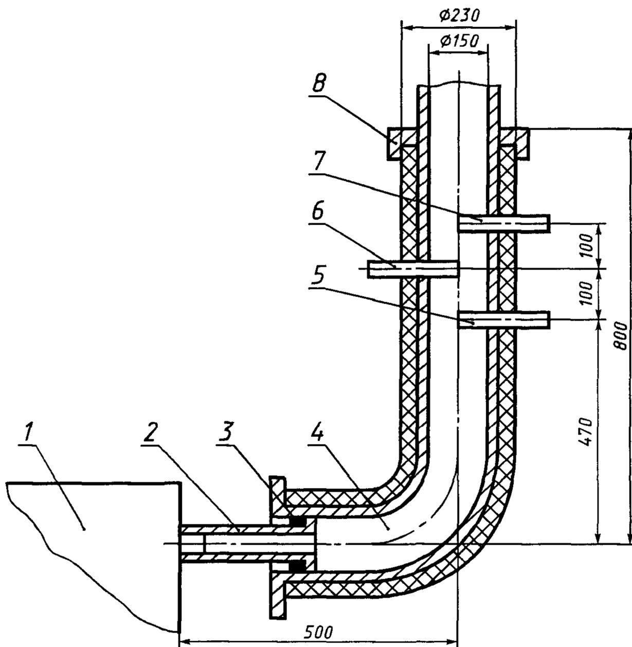
1 — аппарат; 2 — переходник; 3 — уплотнитель; 4 — труба; 5 — пробоотборник; 6 — термометр; 7 — трубка для измерения разрежения; 8 — крышка
