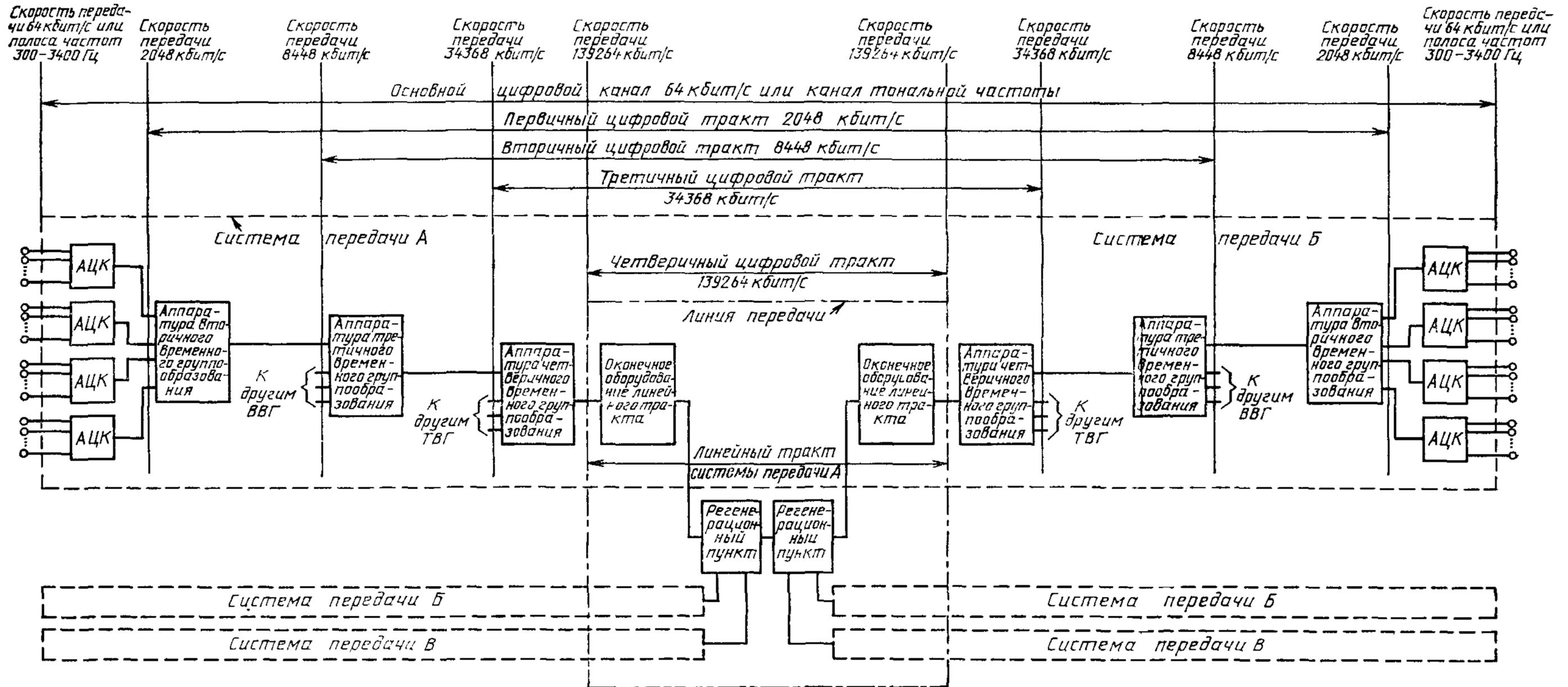
АЦК — аппаратура аналогового и цифрового каналообразования
