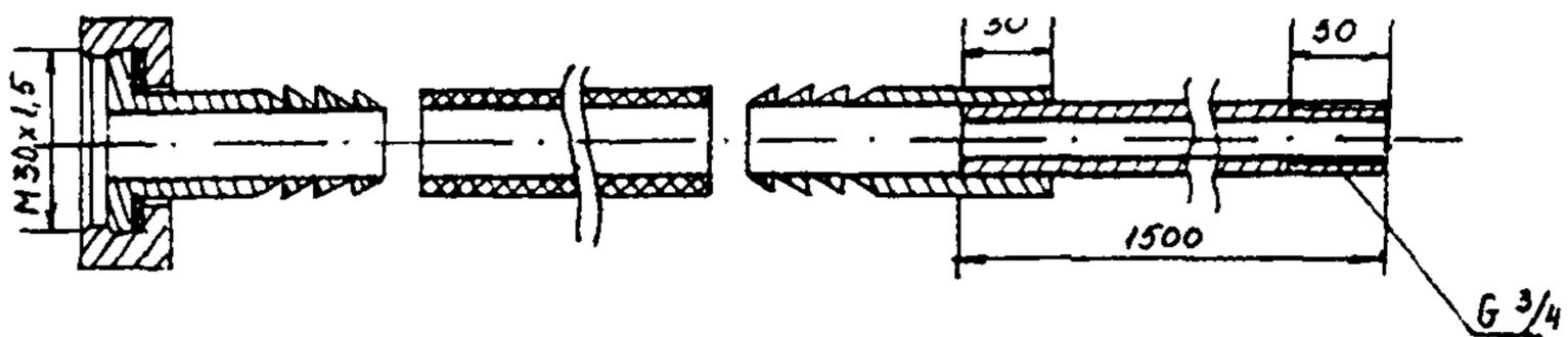
*Эластичный переходник (например, трубка из дюрита)*
