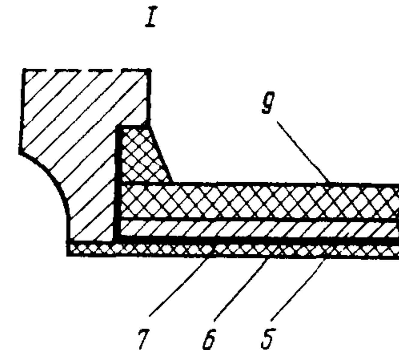
Рис. 18. Устройство примыкания гидроизоляции к блокам тротуаров:
