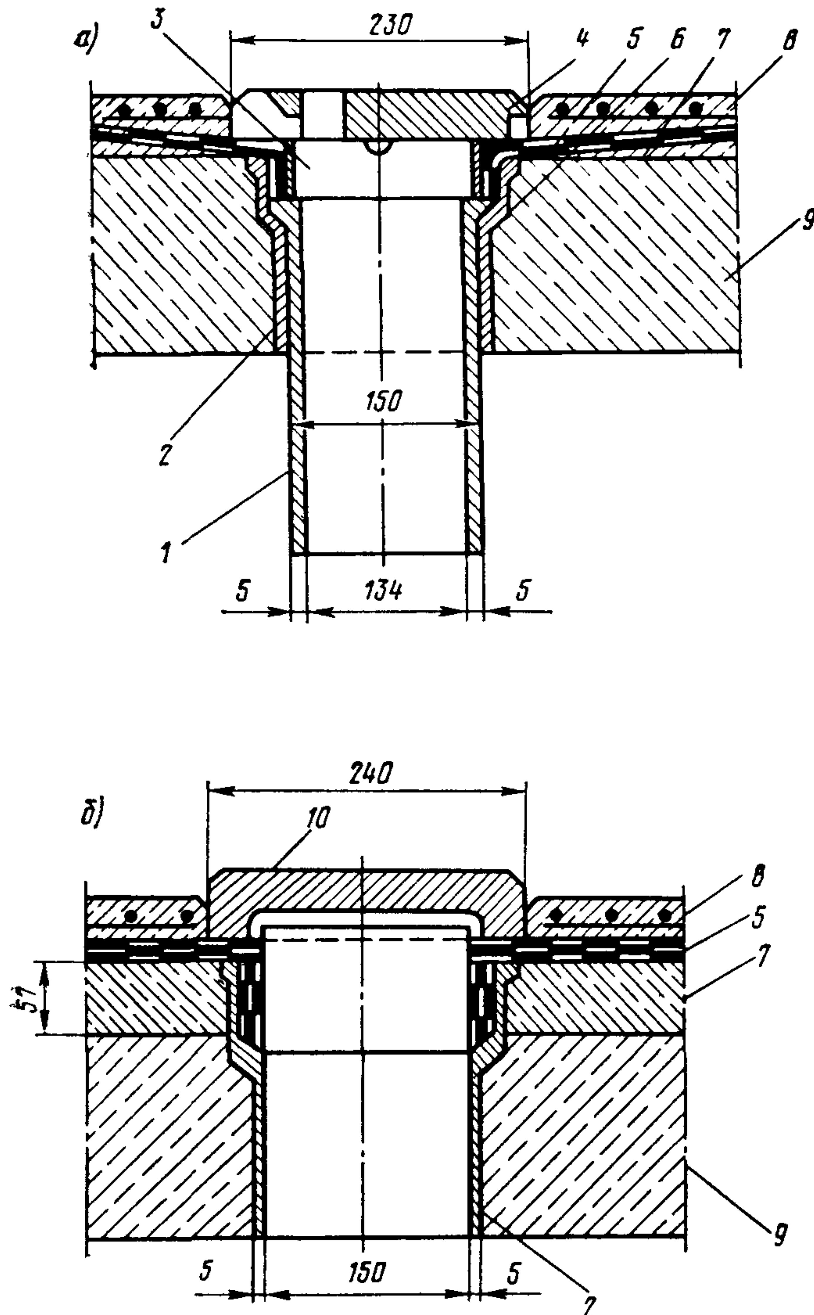
Рис. 8. Сопряжение гидроизоляции:
