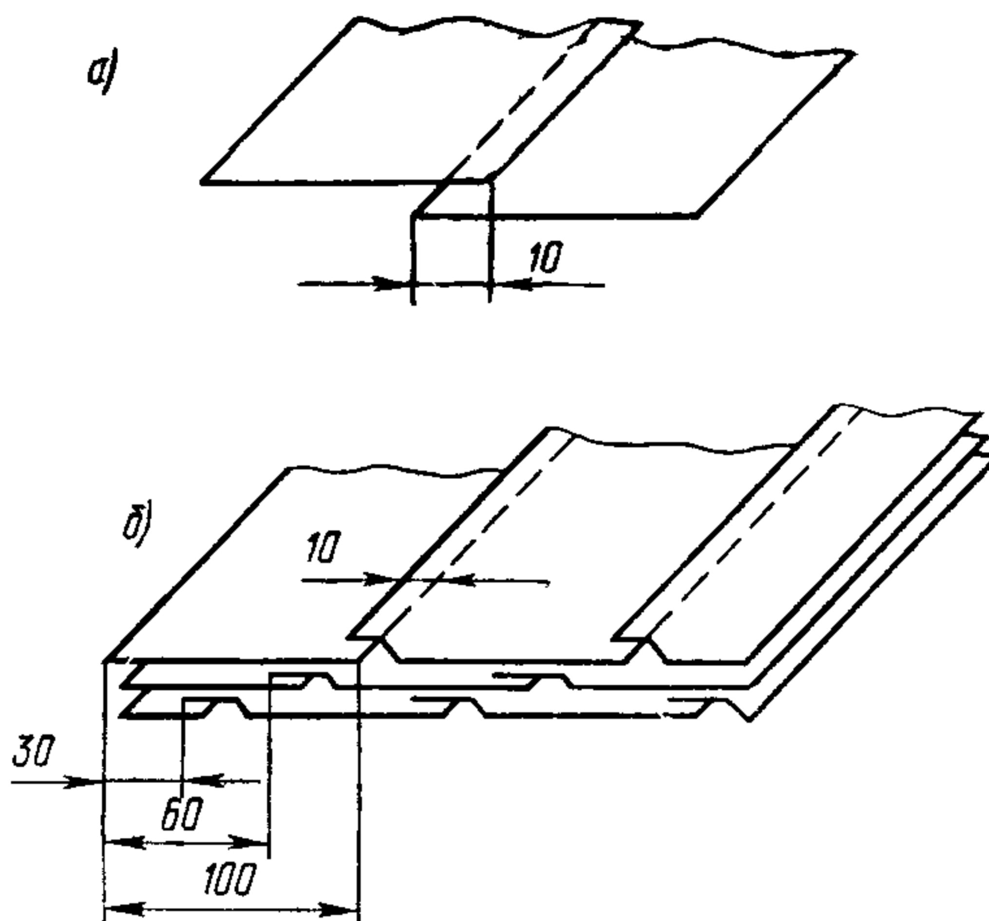
Рис. 2. Соединение полотен армирующего или гидроизоляционного рулонного материала:
