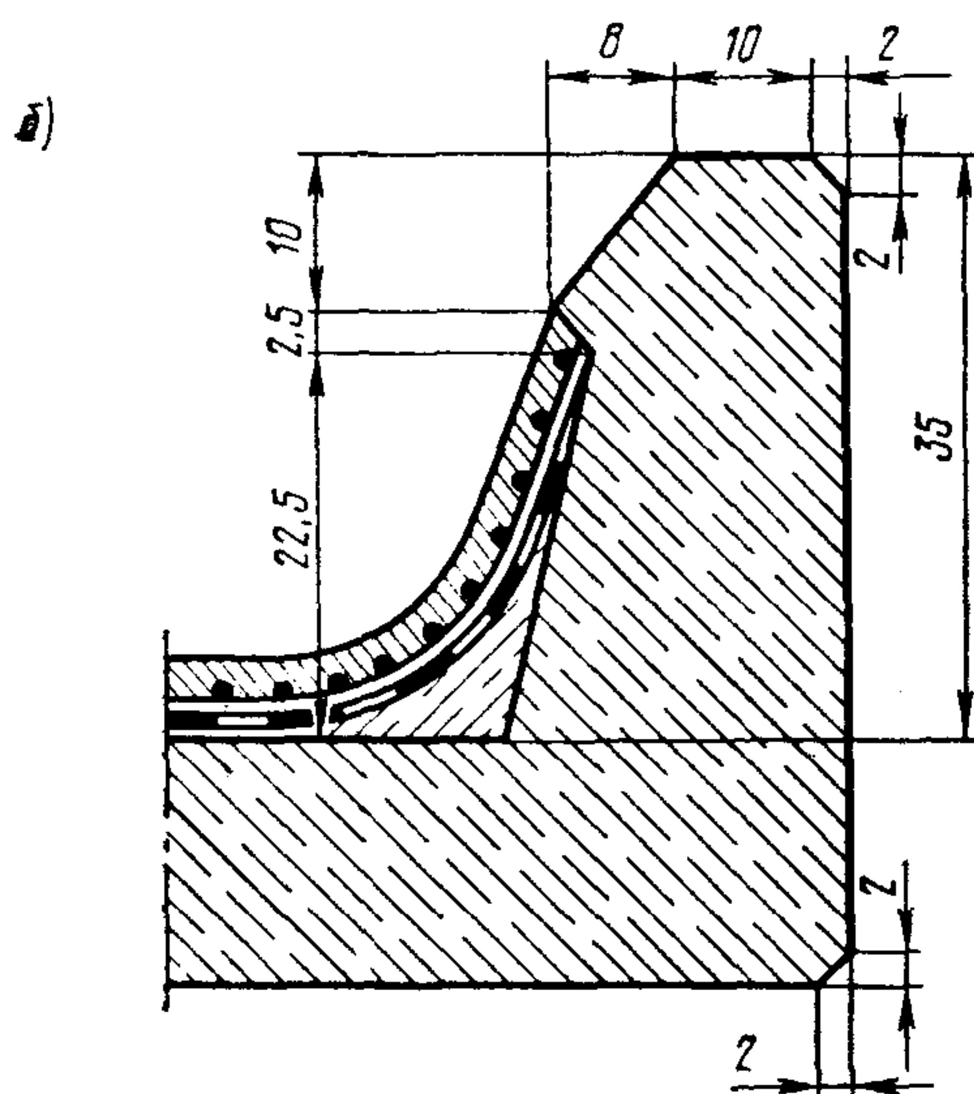
Рис. 10. Углубления по периметру балластного корыта для защемления гидроизоляции:
