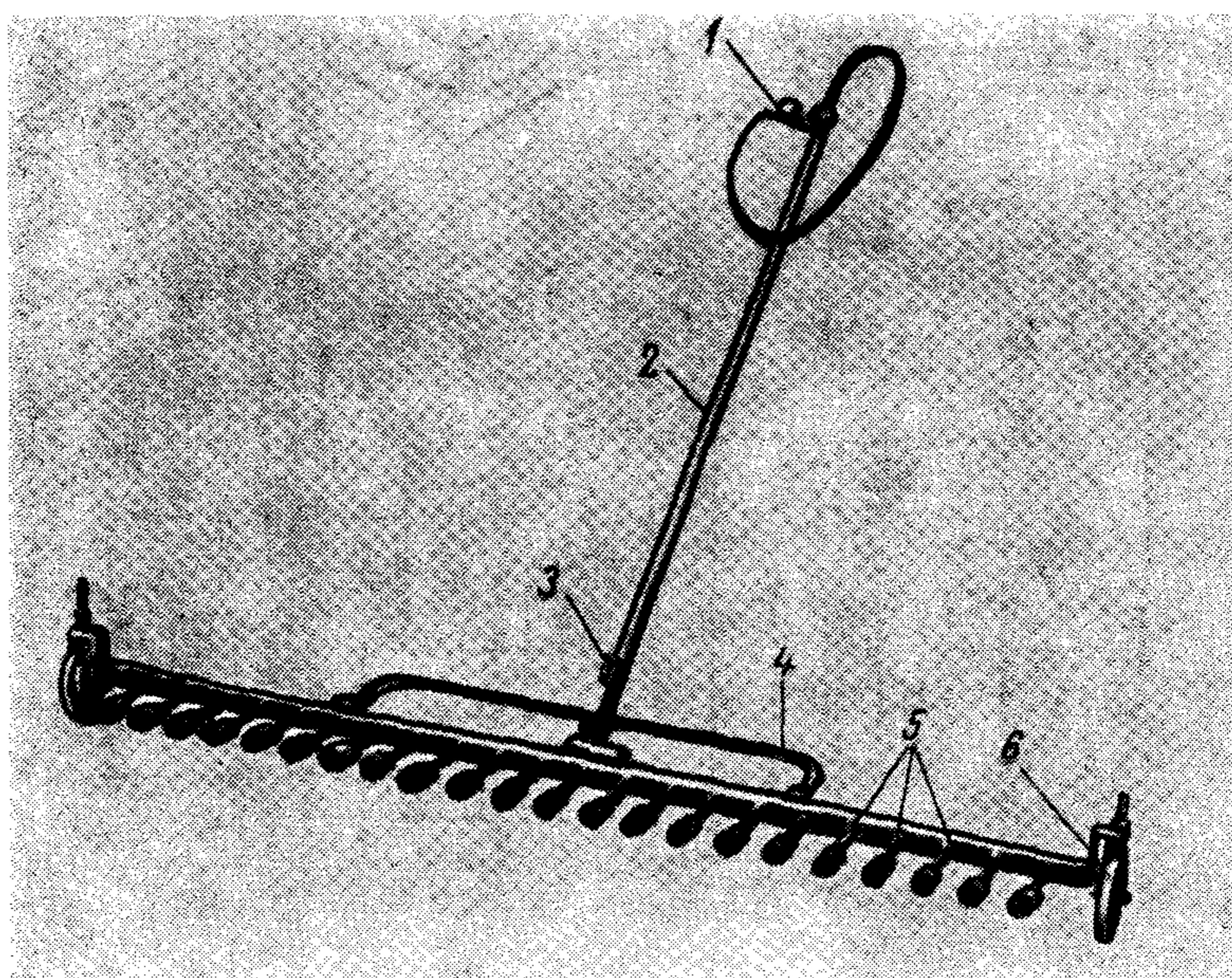
Рис. 13. Горелка воздушно-пропановая нагревательная линейная многофакельная (ГВПЛ):
