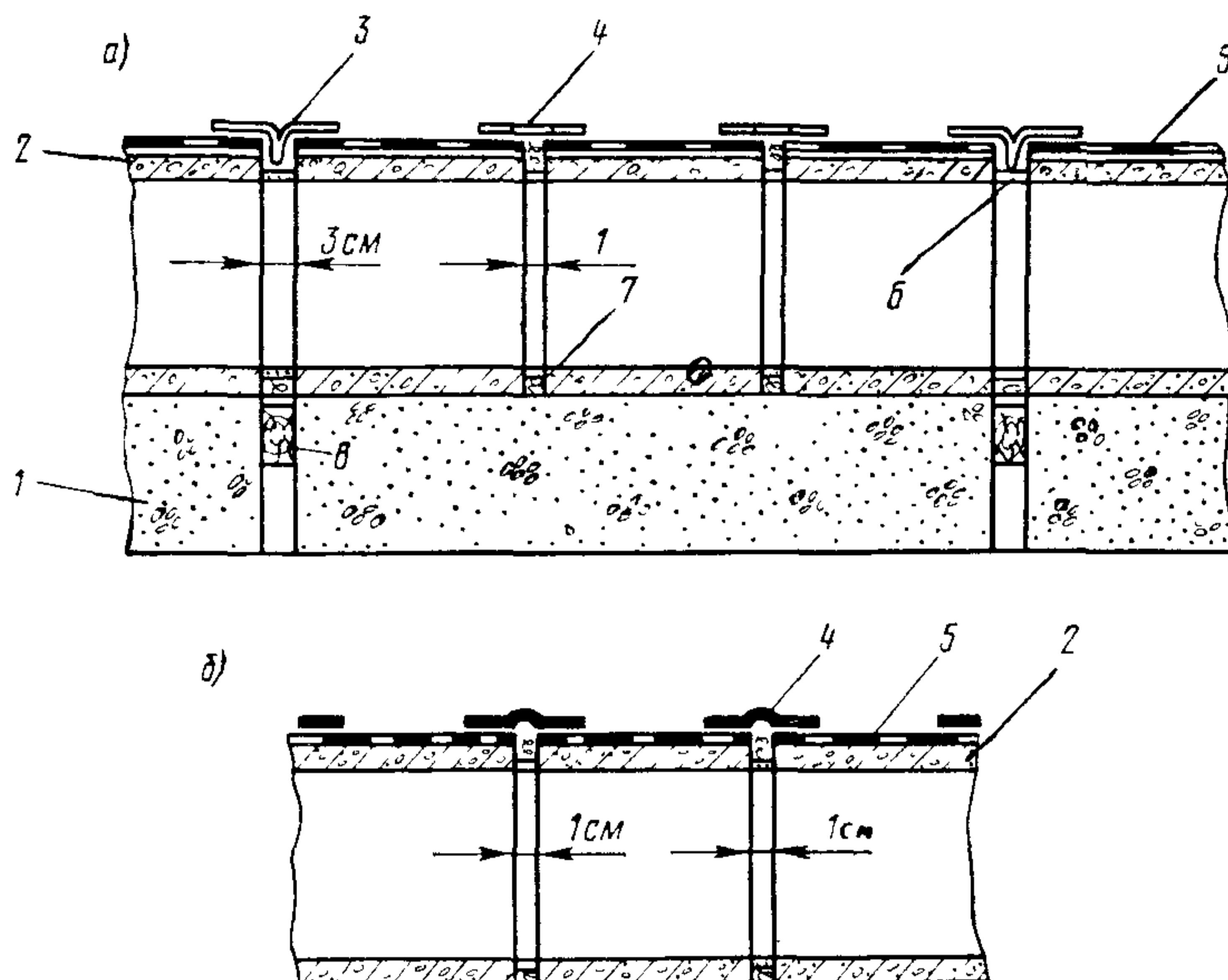
Рис. 24. Устройство гидроизоляции над стыками сборной круглой железобетонной водопропускной трубы:
