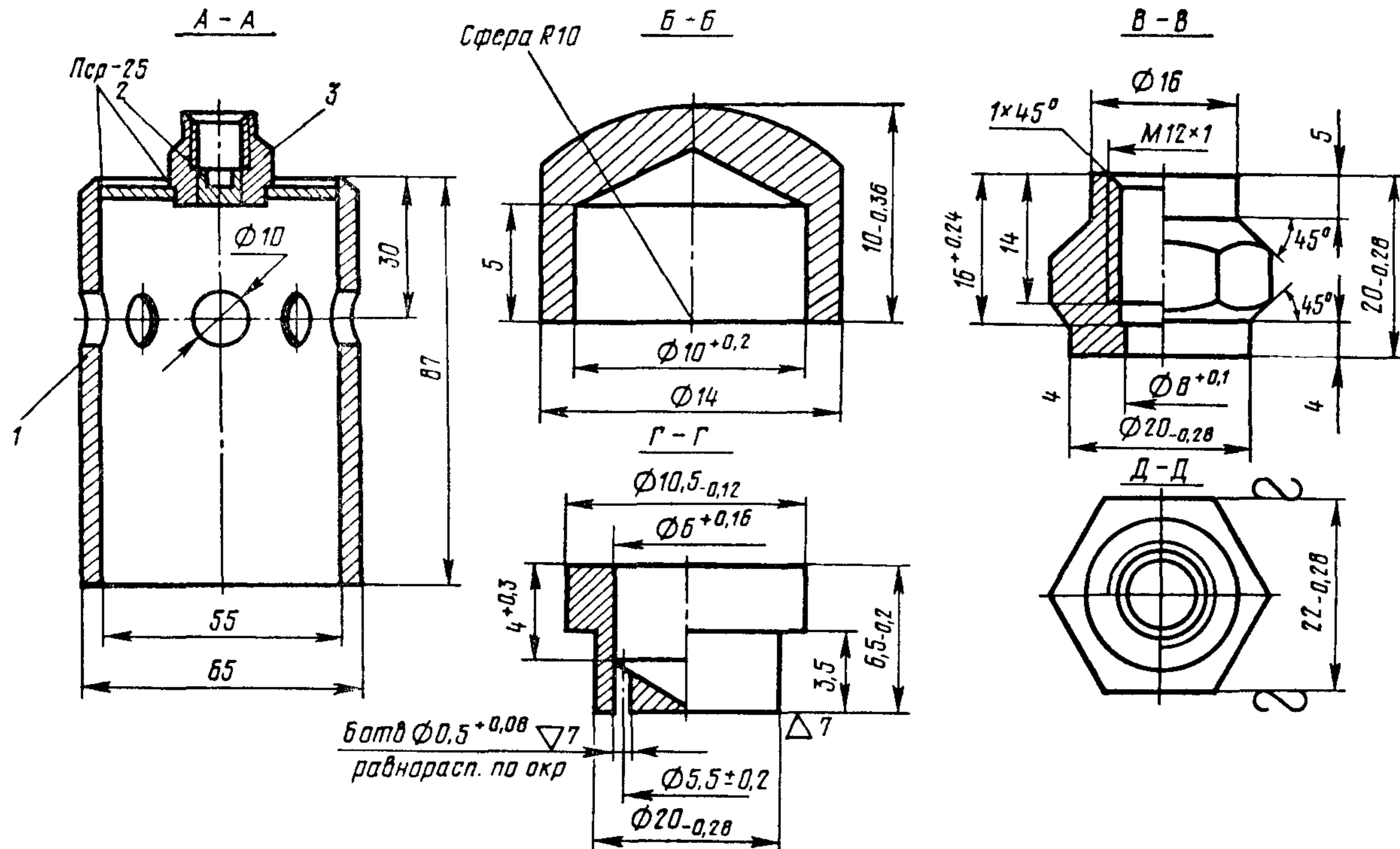
Рис. 12 Горелка воздушино-пропановая нагревательная (ГВПН):
