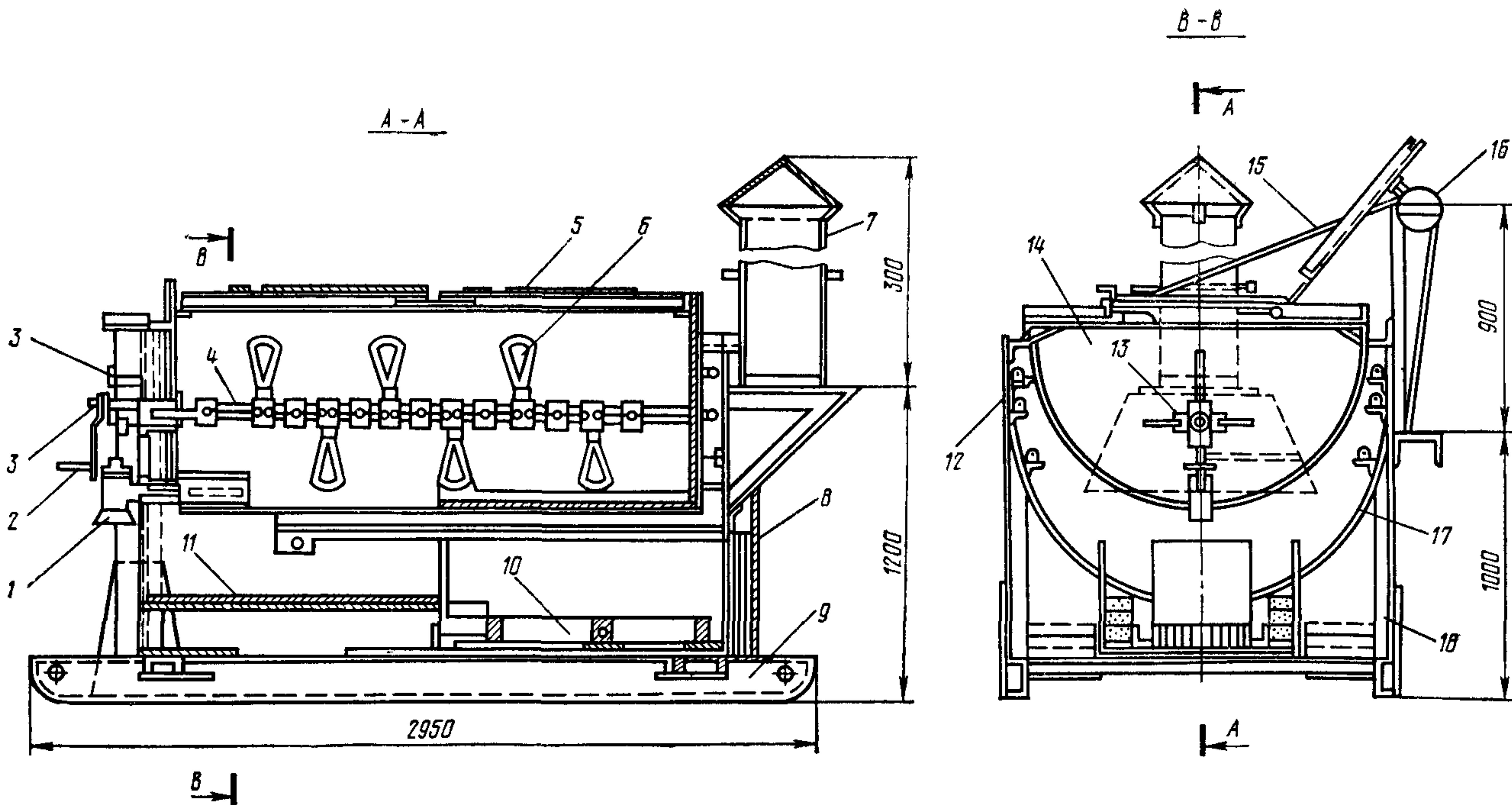
Рис. 1. Битумоварочный котел конструкции Союзспецстроя:
