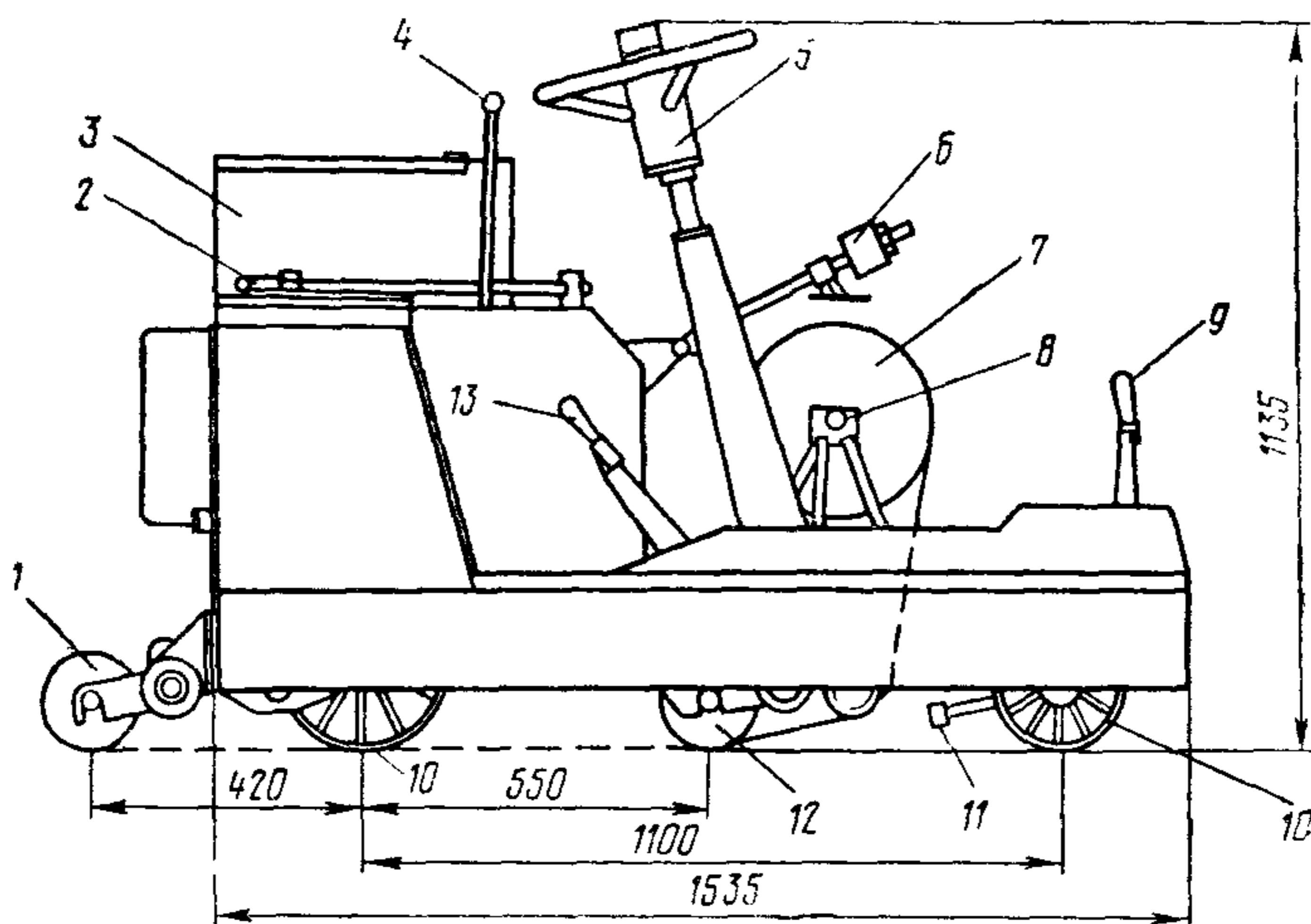
Рис. 14. Самоходный агрегат для безмастичной приклейки рулонных материалов:
