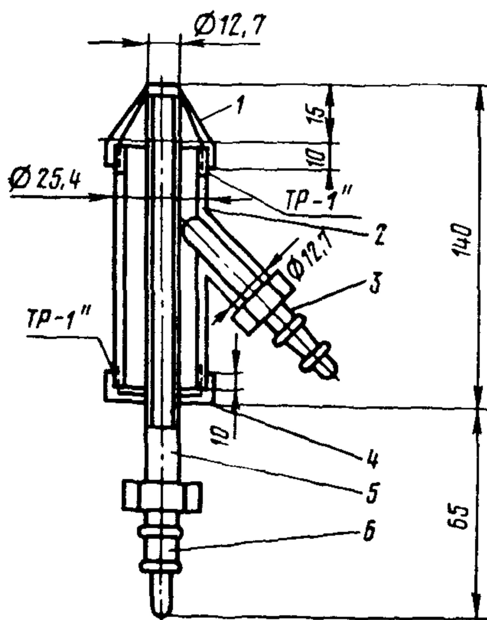
Рис. 3. Вакуум-форсунка для пневмоспыления тиоколовой грунтовки:
