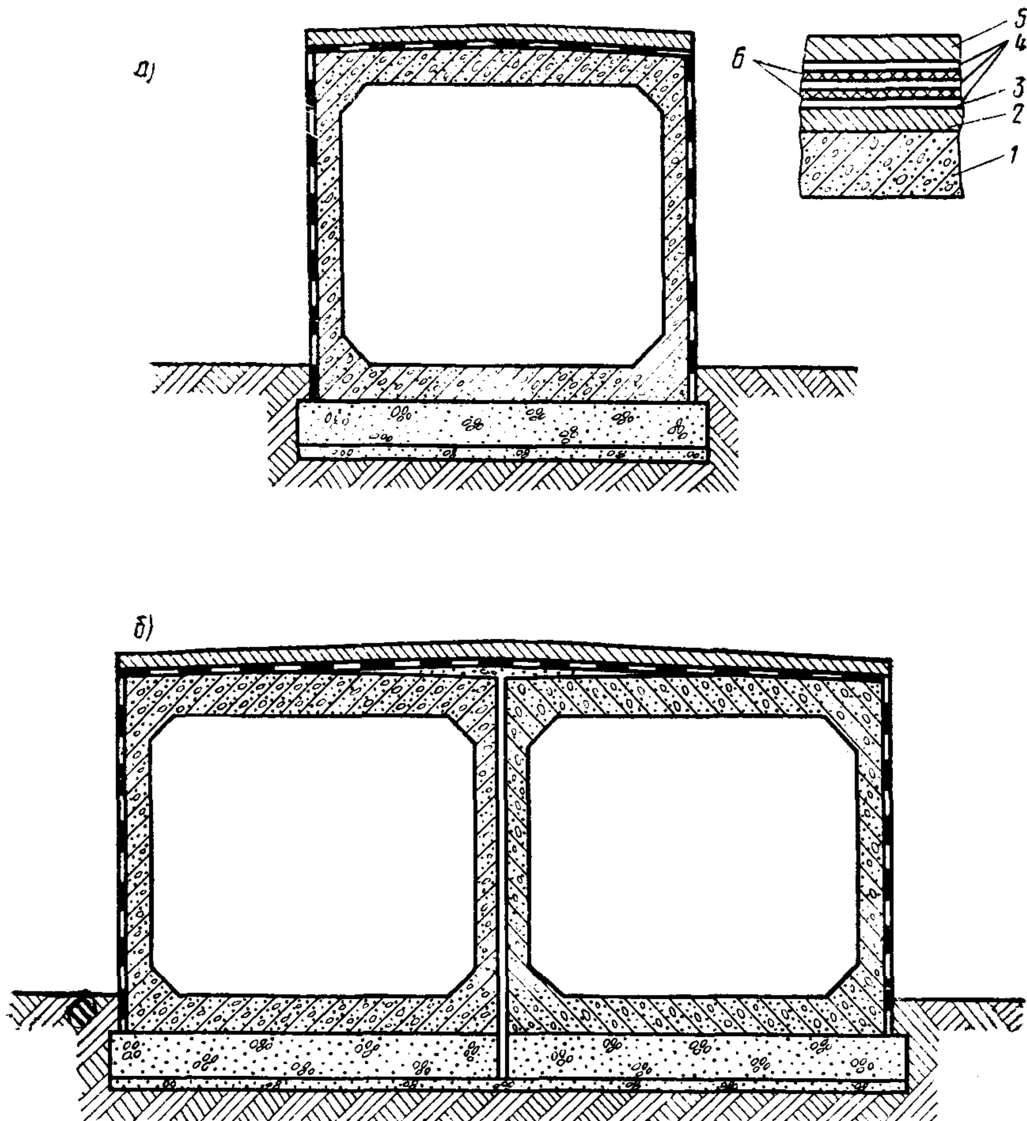
Рис. 21. Гидроизоляция типа БМ-1 (оклеочная) для сборных железобетонных прямоугольных водопропускных труб из беспаспортных звеньев под автомобильные дороги:
