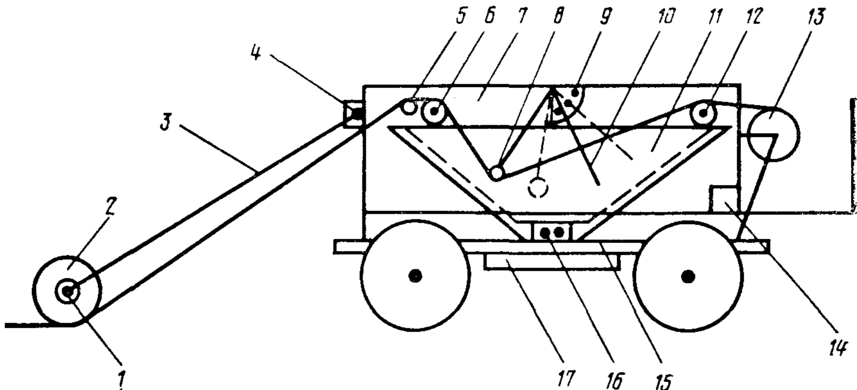
Агрегат для устройства битумной мастиичной армированной гидроизоляции:
