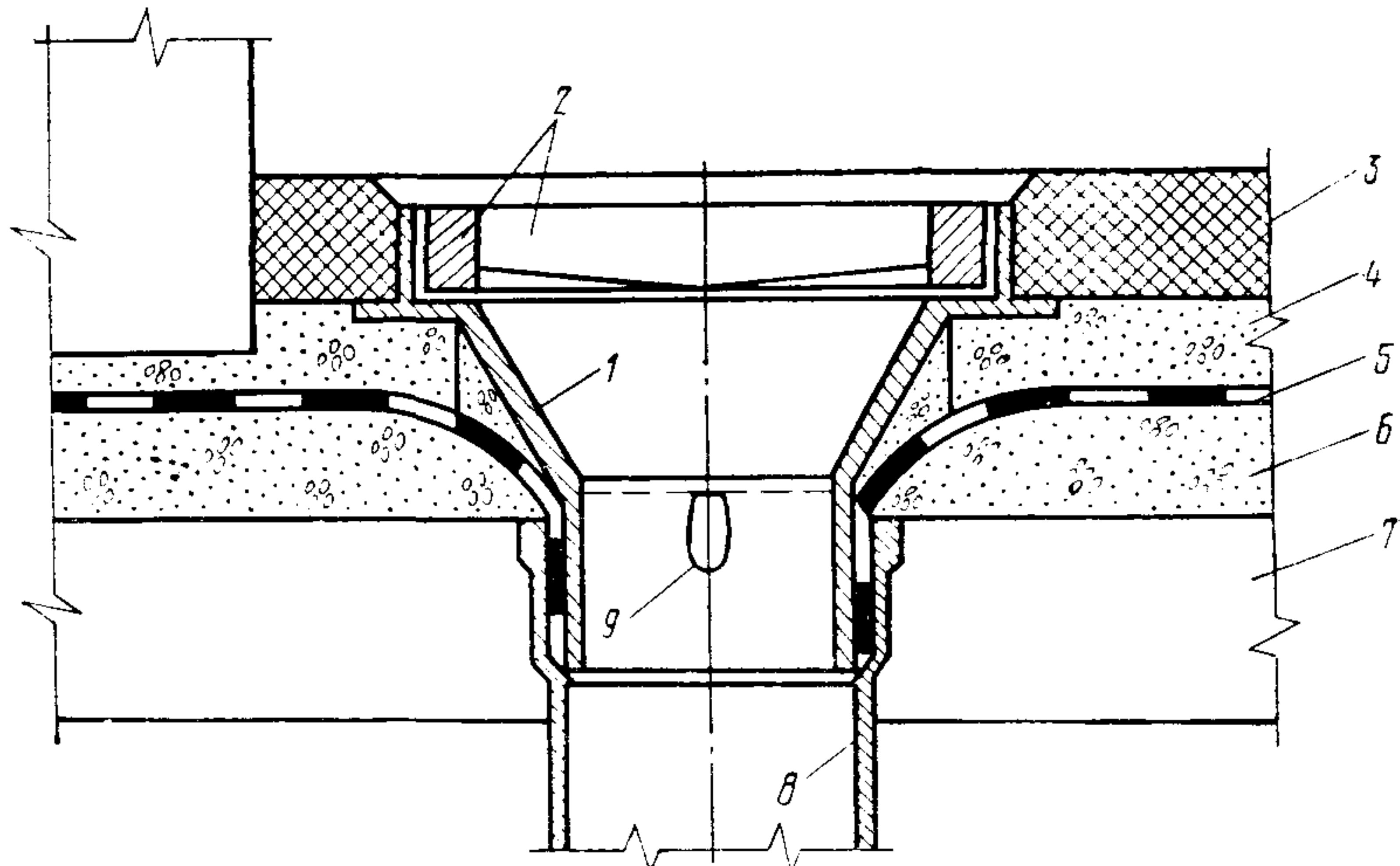
Рис. 15. Устройство сопряжения гидроизоляции с водоотводной трубкой на пролетных строениях автодорожных мостов:
