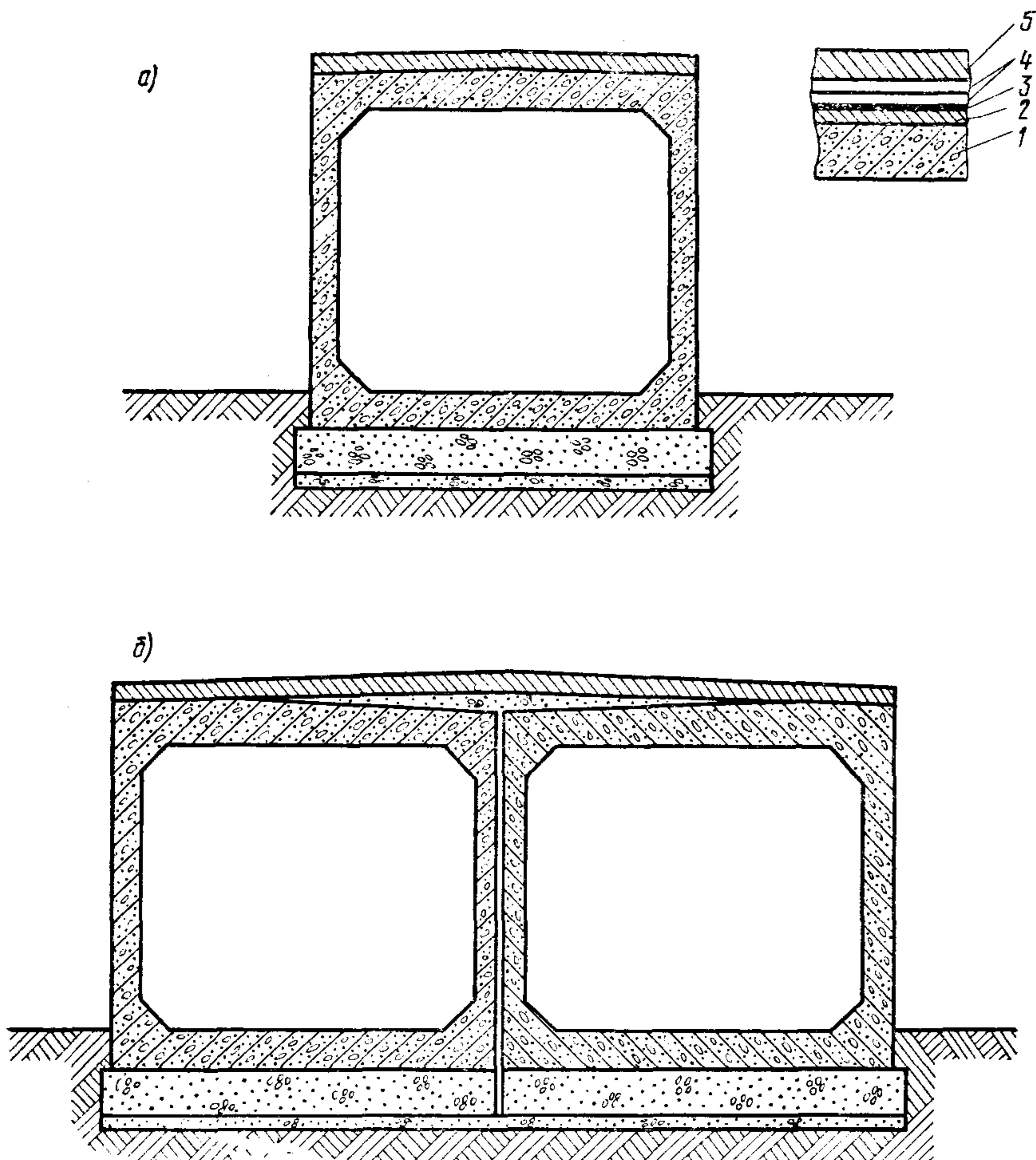
Рис. 20. Гидроизоляция типа БМ-3 (обмазочная) для сборных железобетонных прямоугольных водопропускных труб из звеньев первой категории качества под автомобильные дороги:
