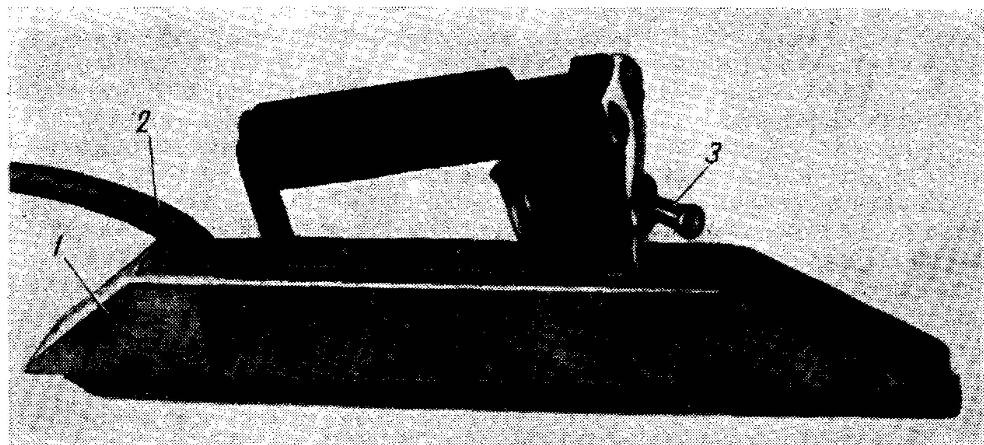
Импульсный полоз ИП-1 для сварки полиэтиленовой пленки:
