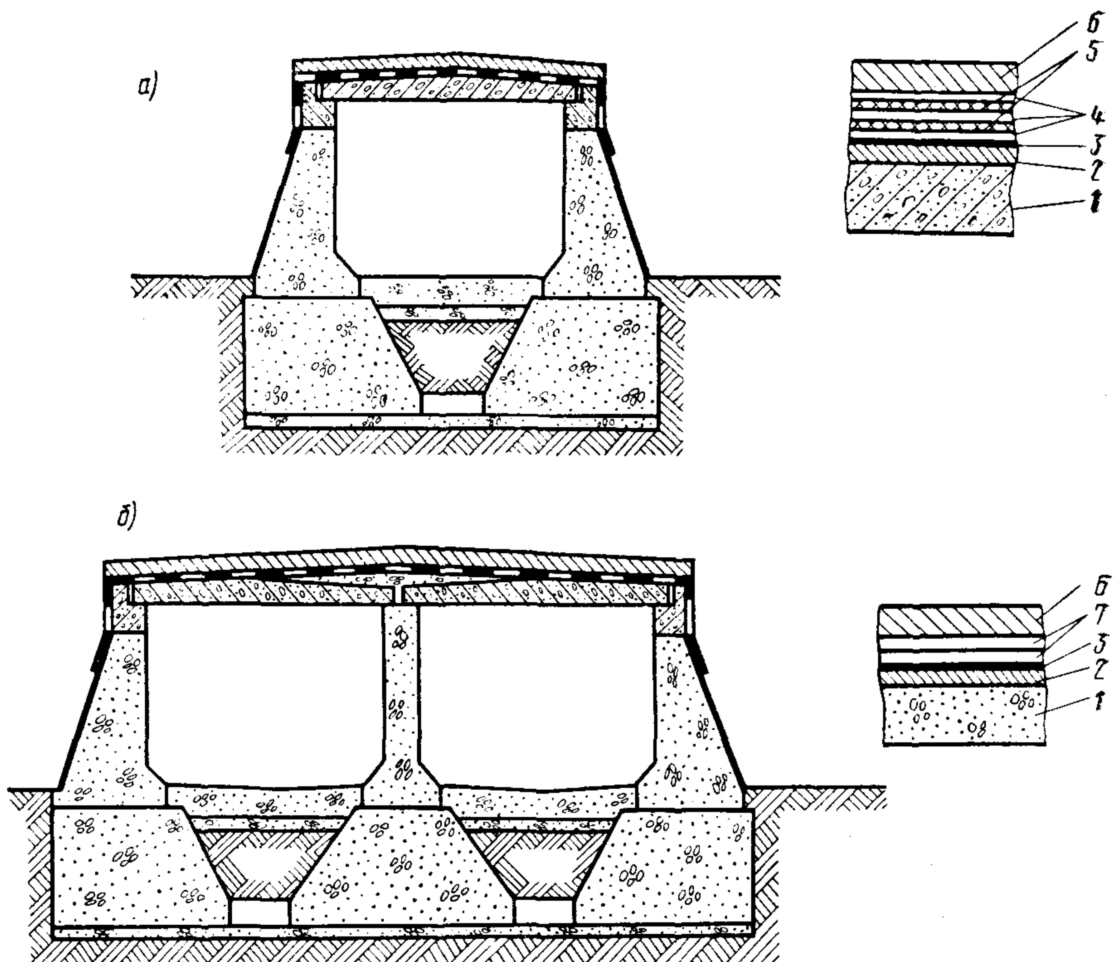
Рис. 22. Гидроизоляция сборных бетонных прямоугольных водопропускных труб типа БМ-1 (оклеочная) на поверхностях плит перекрытия и насадок и типа БМ-3 (обмазочная) на поверхностях стен и боковых гранях фундаментов:
