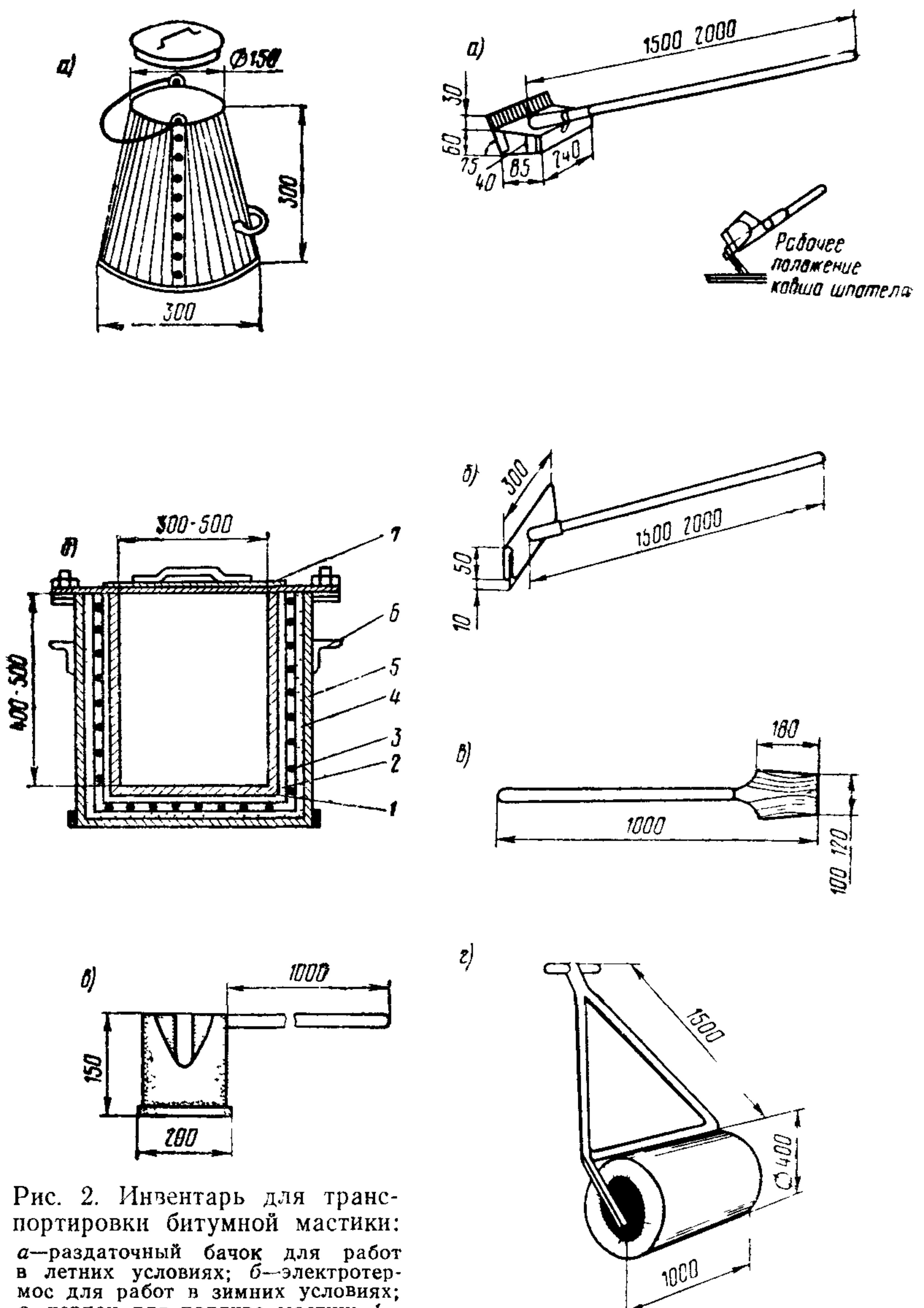
Рис. 2. Инвентарь для транспортировки битумной мастики:
