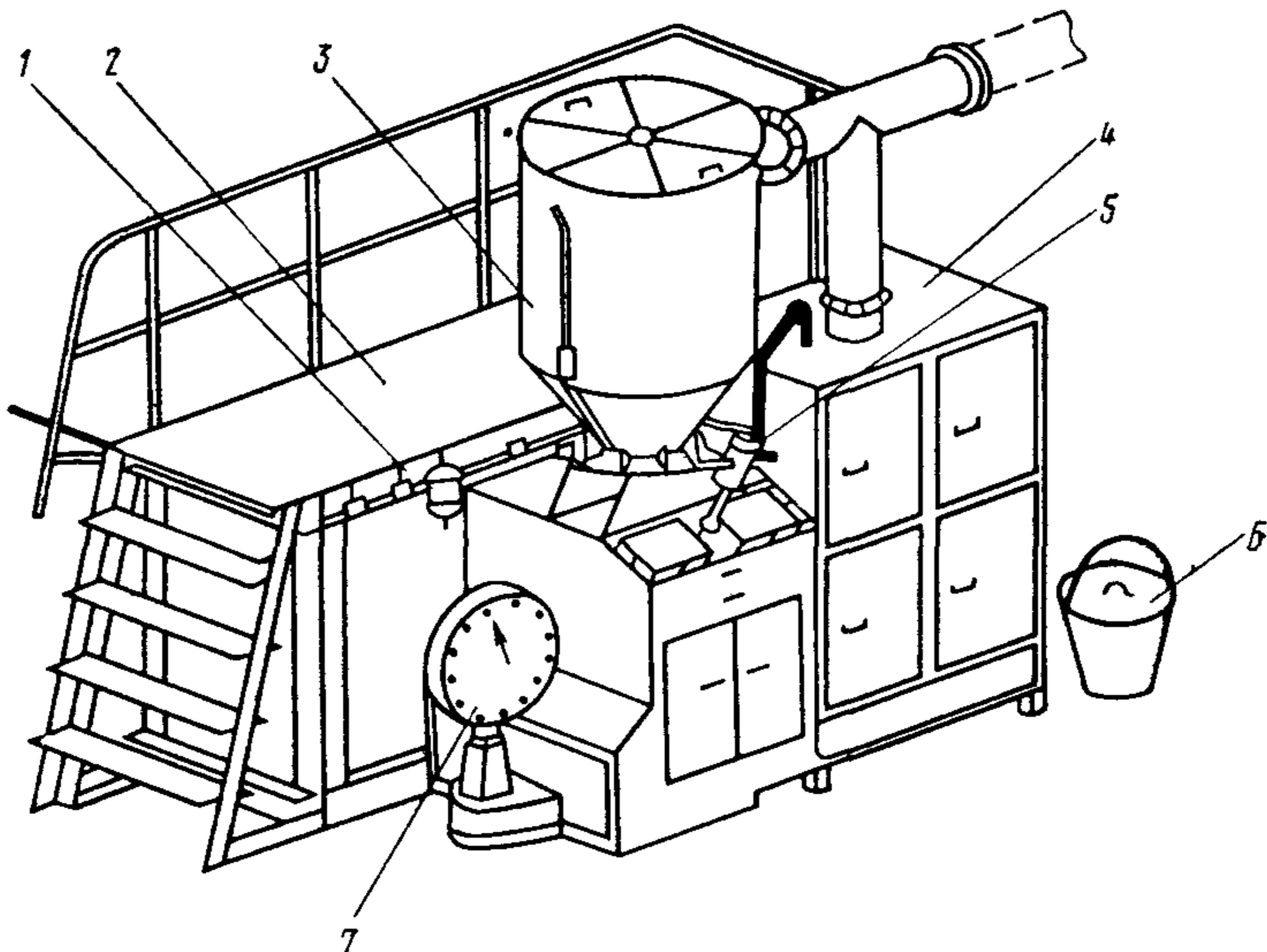
Установка для приготовления тиоколовых гидроизоляционных составов:
