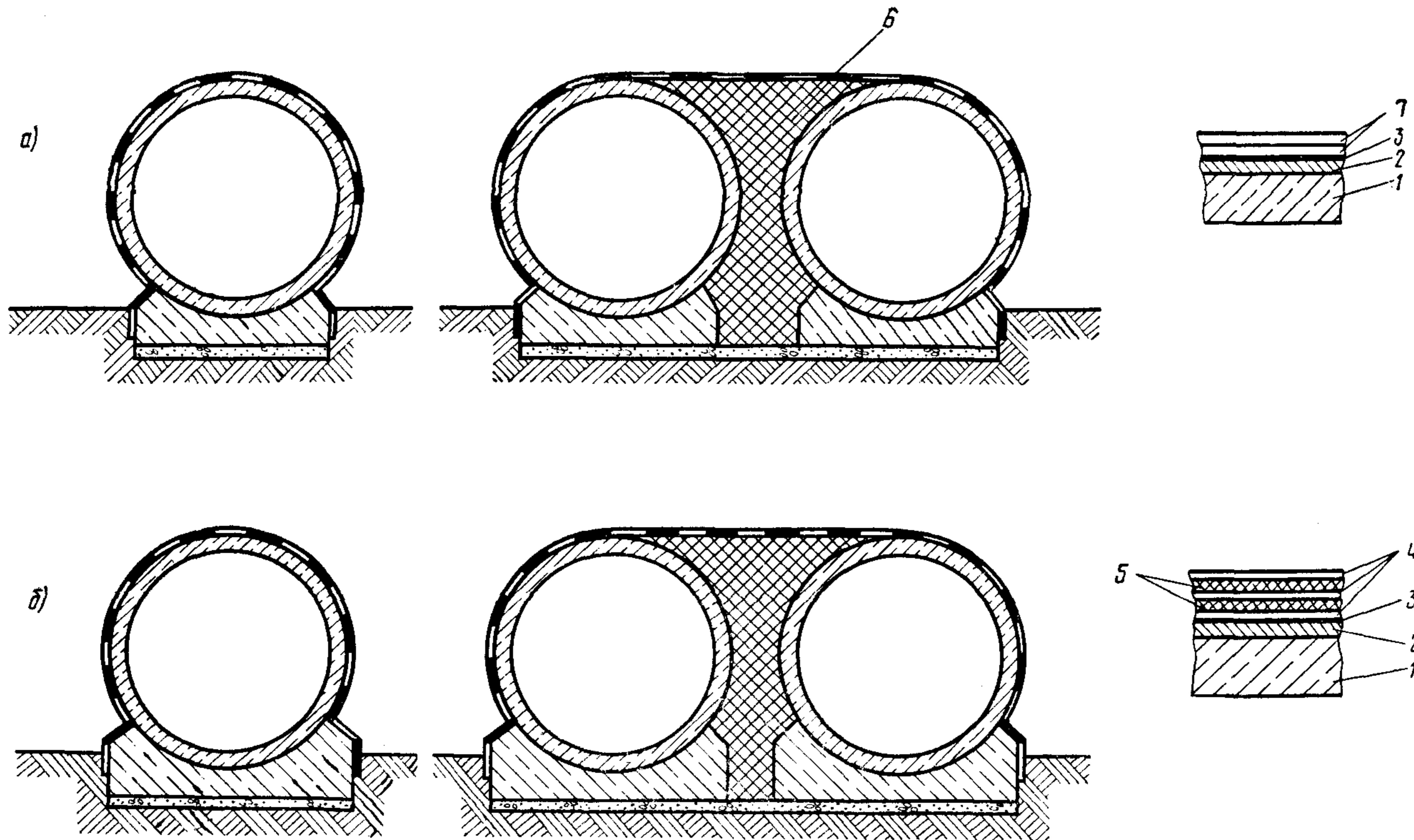
Рис. 23. Гидроизоляция сборных железобетонных круглых водопропускных труб под автомобильную дорогу:
