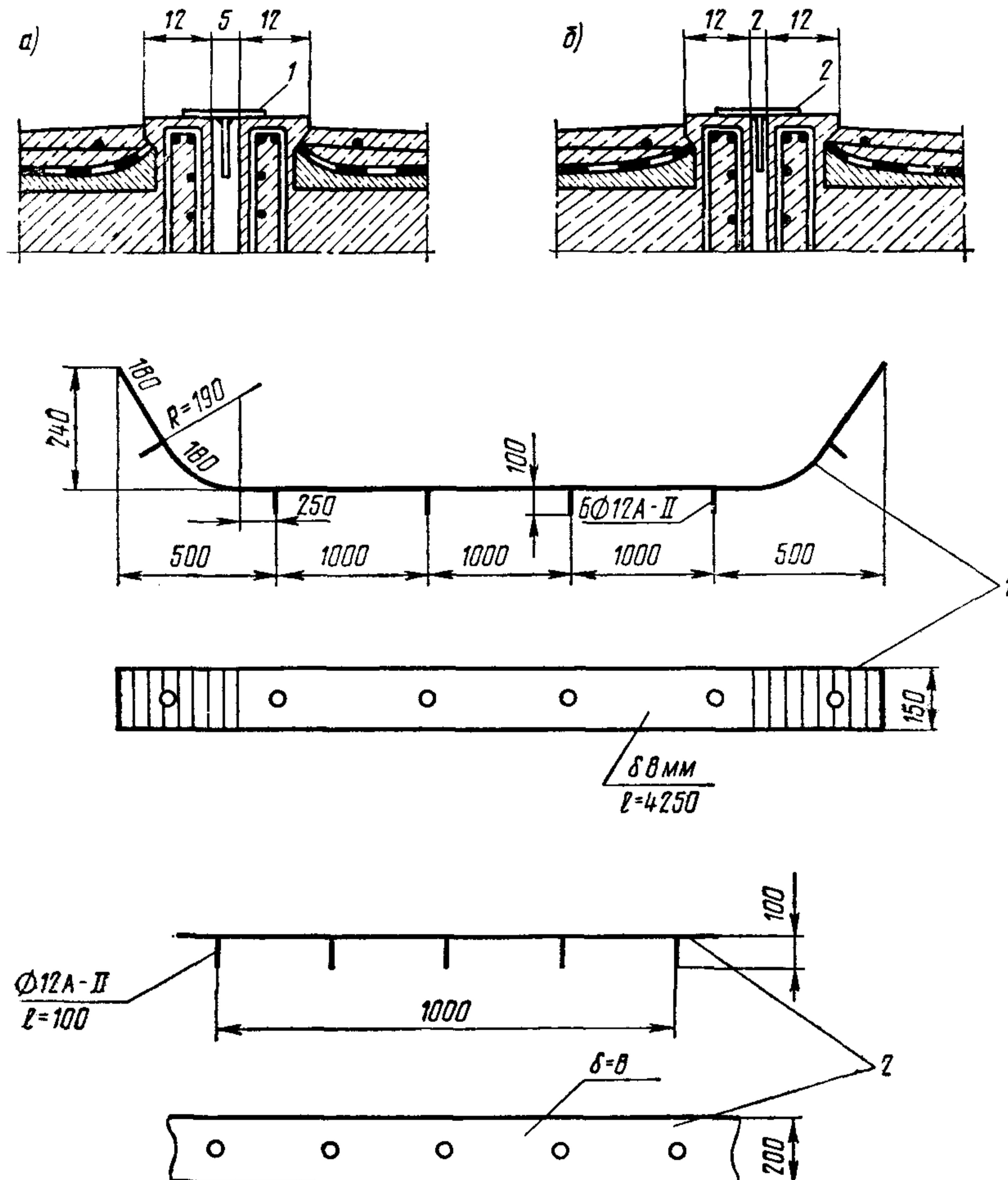
Рис. 11. Перекрытие деформационных швов железнодорожных пролетных строений:
