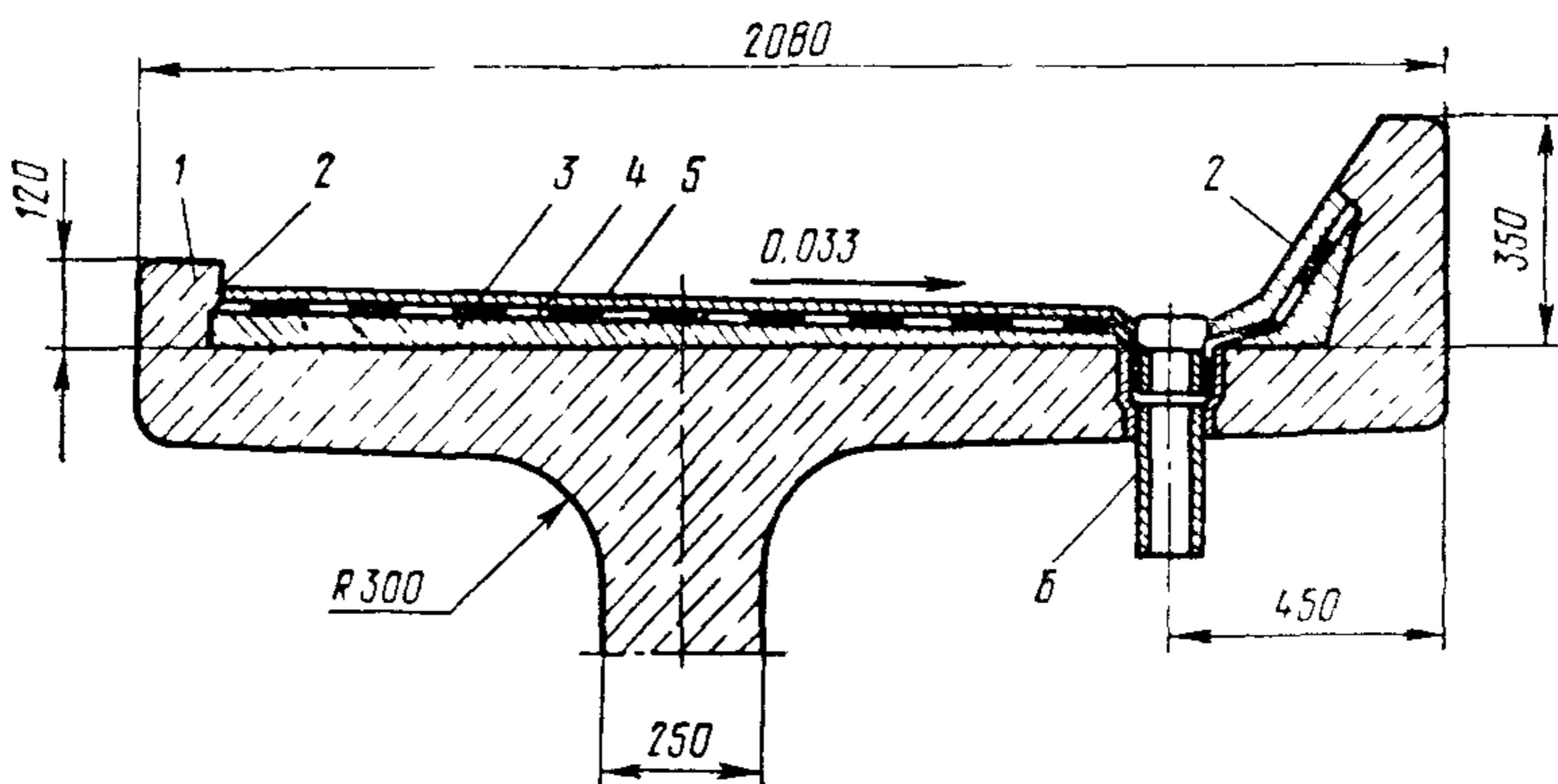
Рис. 1. Общий вид балластного корыта с гидроизоляцией и трубой для водоотвода:
