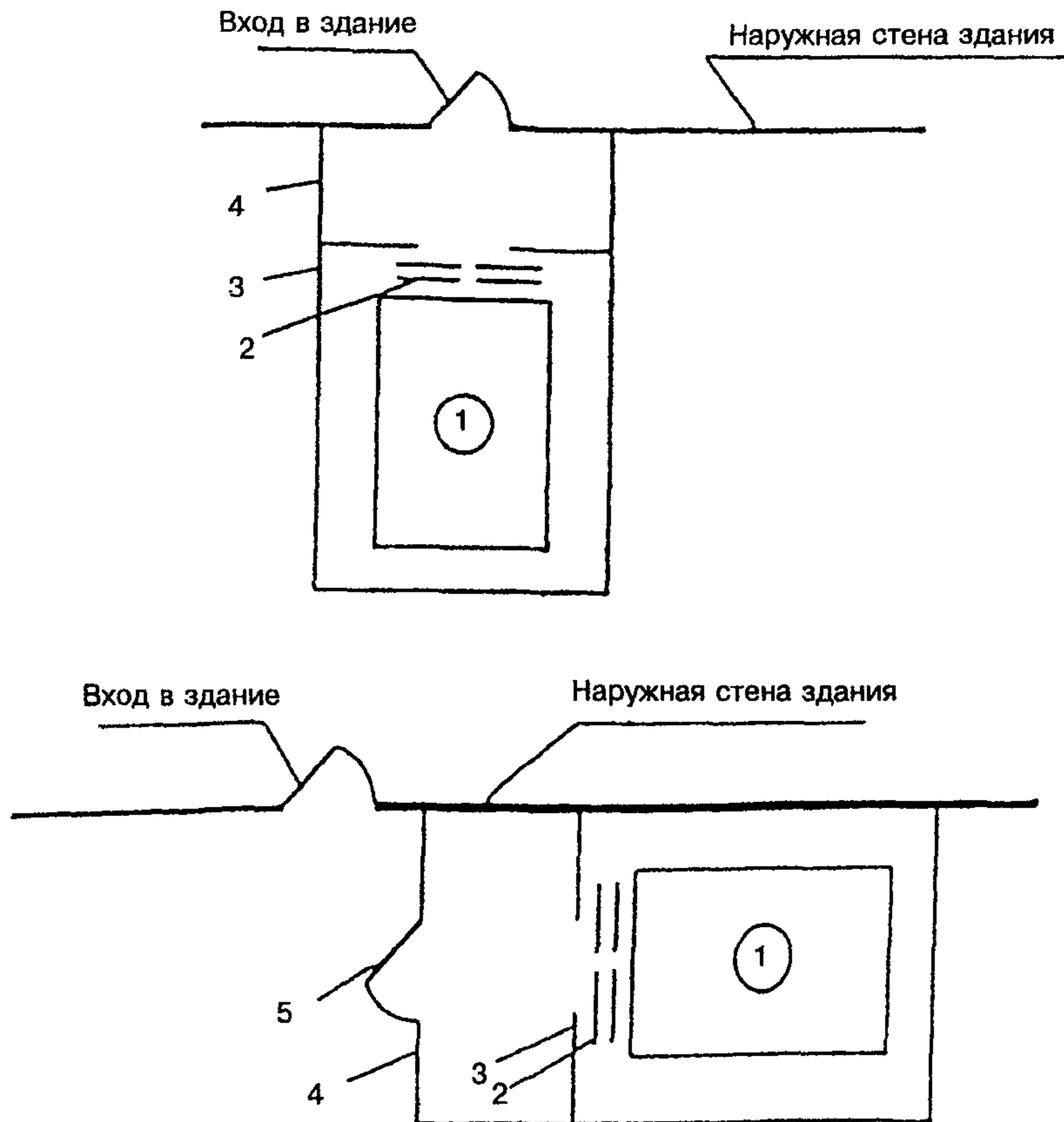
1 — лифт для пожарных; 2 — противопожарная дверь шахты лифта для пожарных с пределом огнестойкости EI 60; 3 — ограждающие конструкции шахты с пределом огнестойкости REI 120; 4 — противопожарные перегородки 1-го типа, ограждающие лифтовый холл (тамбур); 5 — противопожарная дверь 2-го типа лифтового холла (тамбура) в дымогазонепроницаемом исполнении
