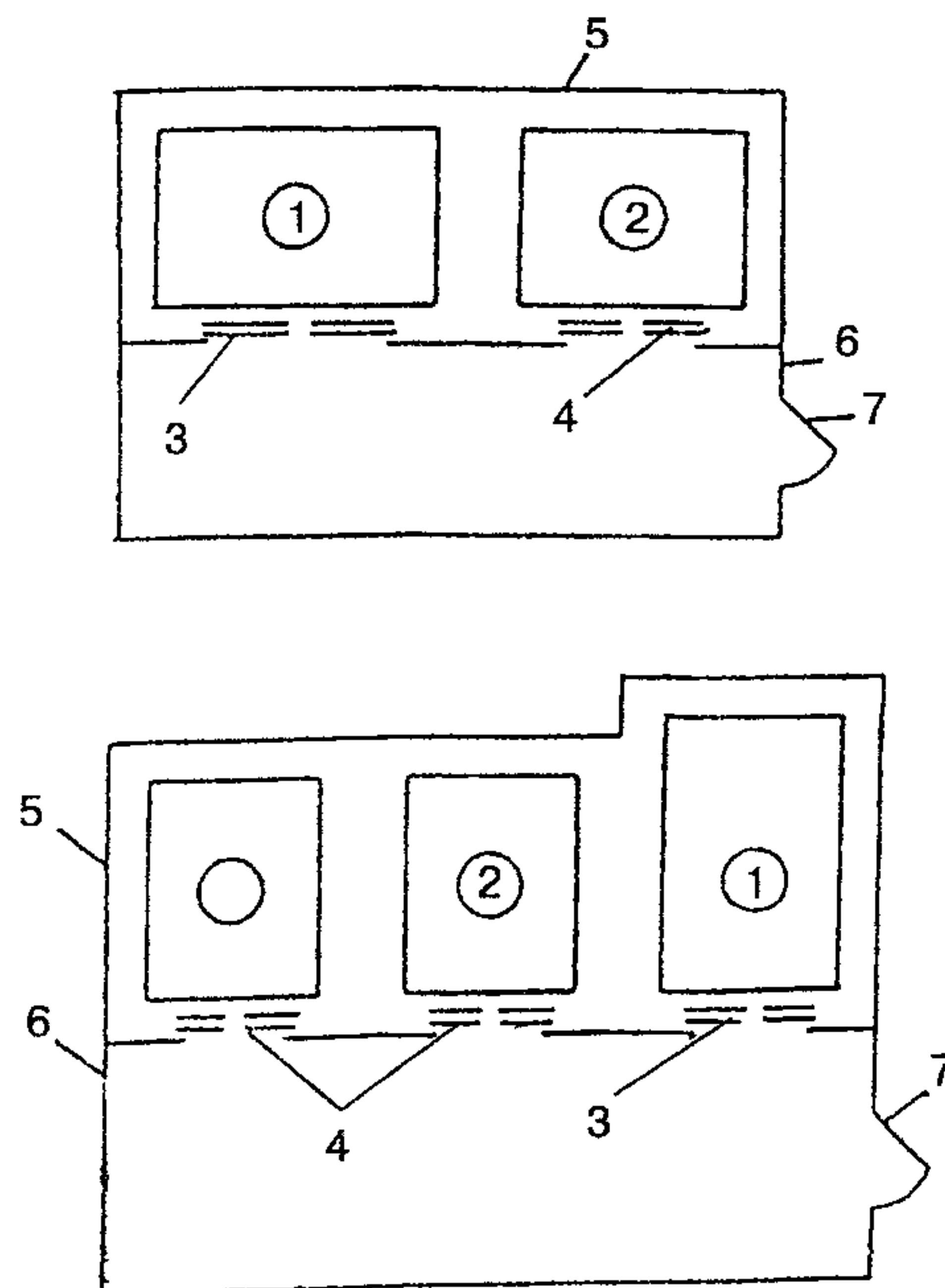
1 — лифт для пожарных; 2 — пассажирские лифты; 3 — противопожарная дверь шахты «лифта для пожарных» с пределом огнестойкости EI 60; 4 — противопожарная дверь шахты пассажирских лифтов с пределом огнестойкости EI 60; 5 — ограждающие конструкции общей шахты с пределом огнестойкости REI 120; 6 — противопожарные перегородки 1-го типа, ограждающие лифтовый холл (тамбур); 7 — противопожарная дверь 2-го типа лифтового холла (тамбура) в дымогазонепроницаемом исполнении
