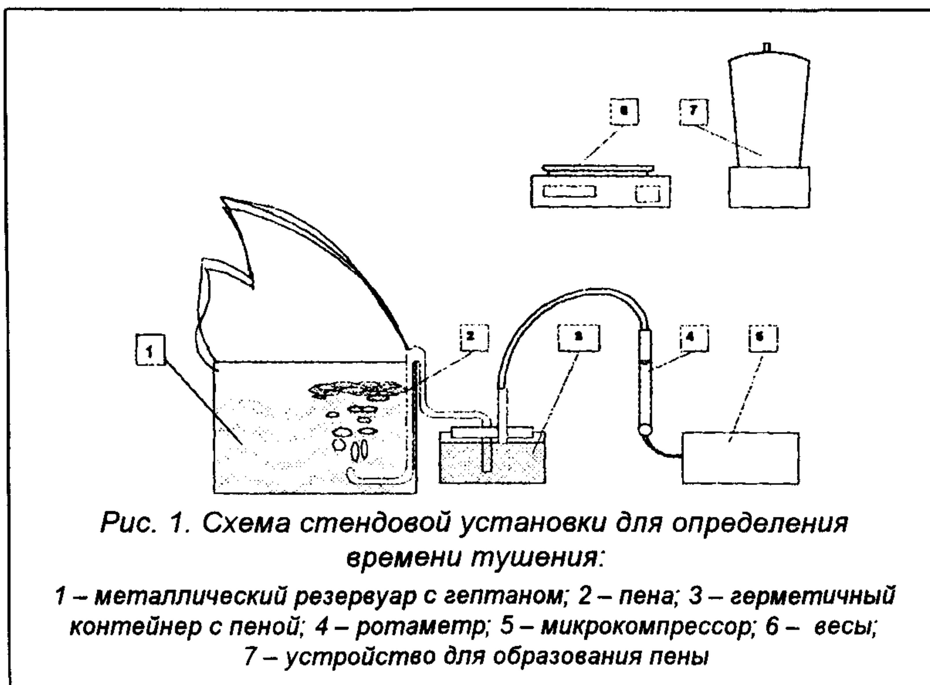
Рис. 1. Схема стендовой установки для определения времени тушения:
