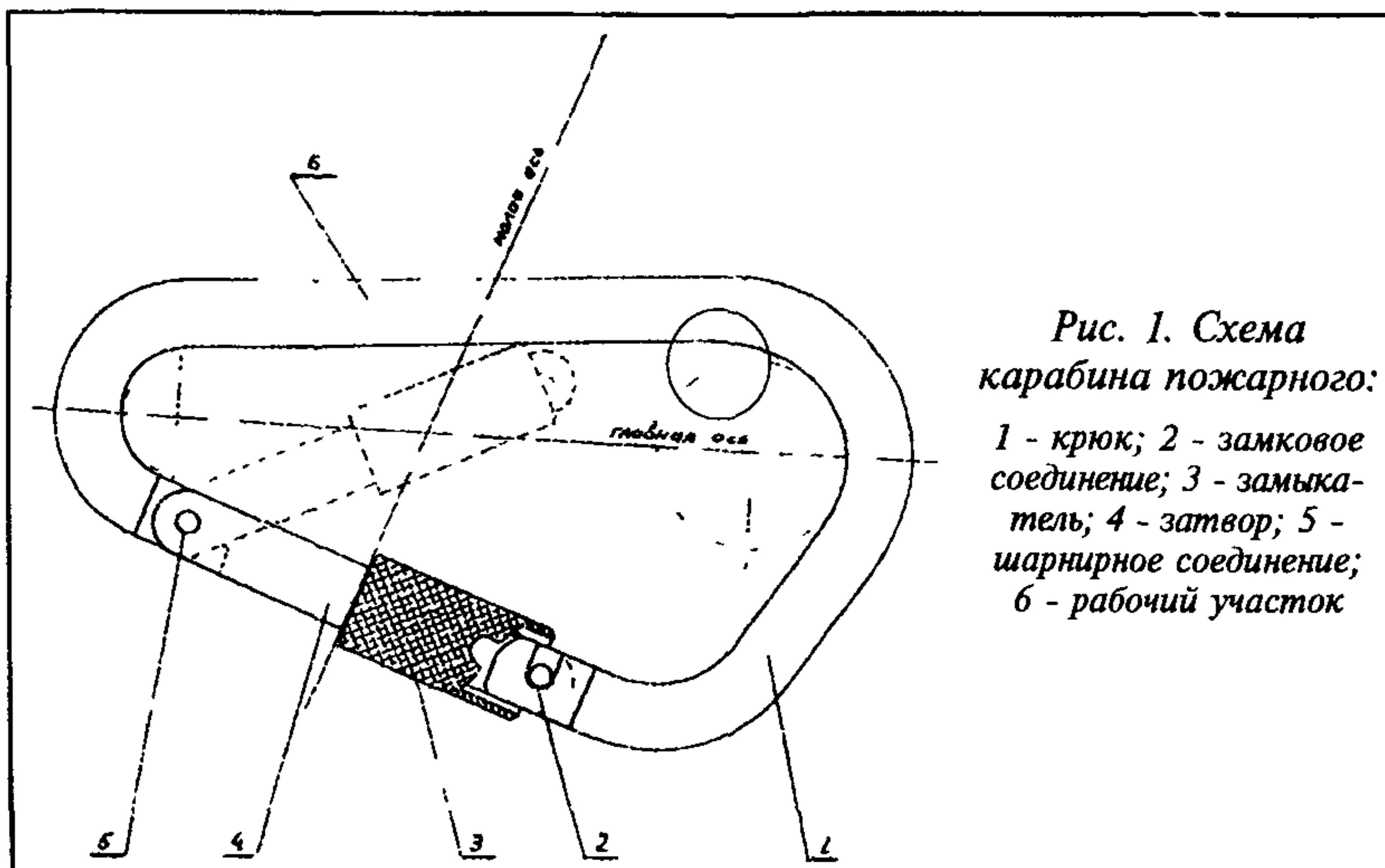
*Рис. 1. Схема карабина пожарного:*
