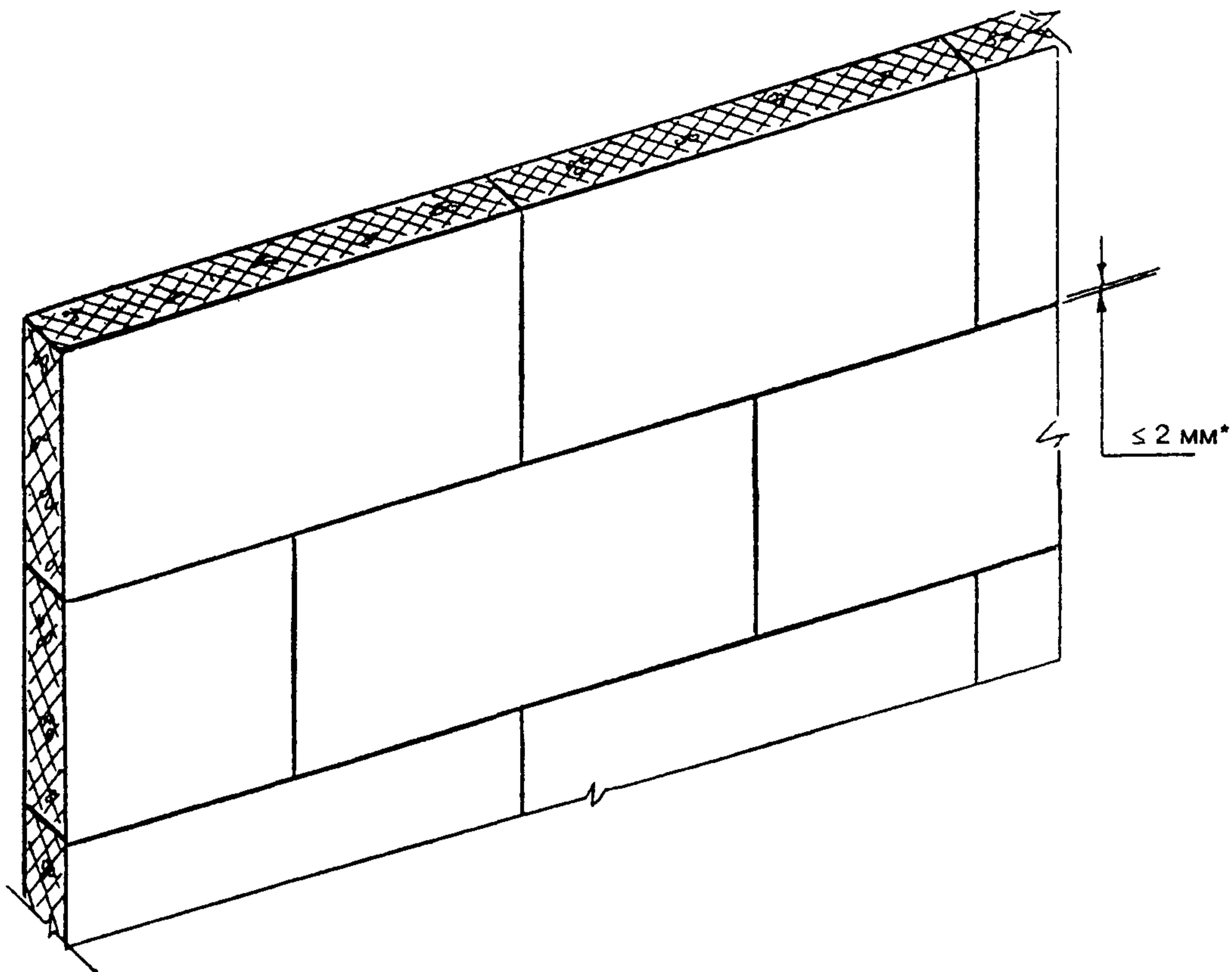
**Примечание —** Заполнение широких щелей между плитами утеплителя штукатурным (клеящим) составом не допускается.
