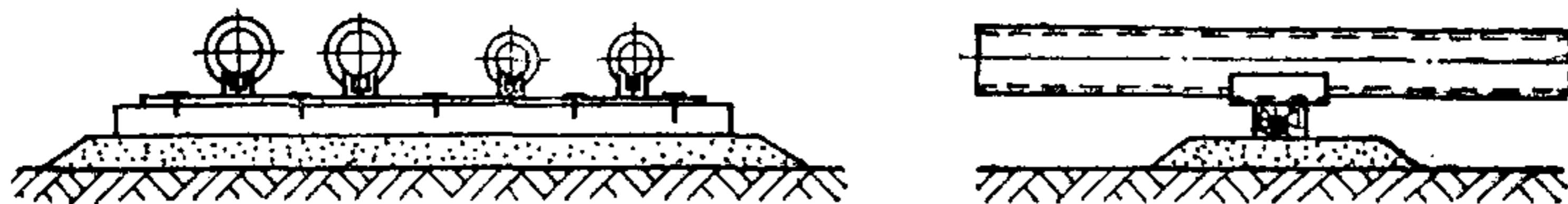
Рис. 2. Надземная прокладка трубопроводов на общих лежневых опорах
