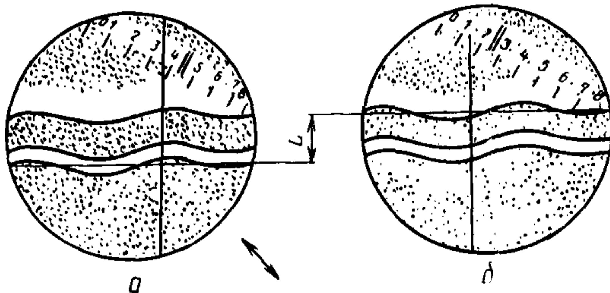
Примечание. Если световая полоса искривлена, то горизонтальную визирную нить окулярного микрометра устанавливают на глаз так, чтобы площади, заключенные между ней и линией, очерчивающей край световой полосы, были примерно равны.
