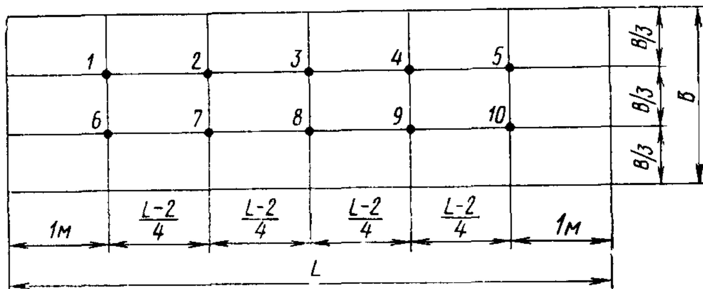
4.3. Отобранные разовые пробы кварцевого песка объединяют в общую пробу, тщательно перемешивают и методом квартования сокращают до средней пробы массой не менее 3 кг.
