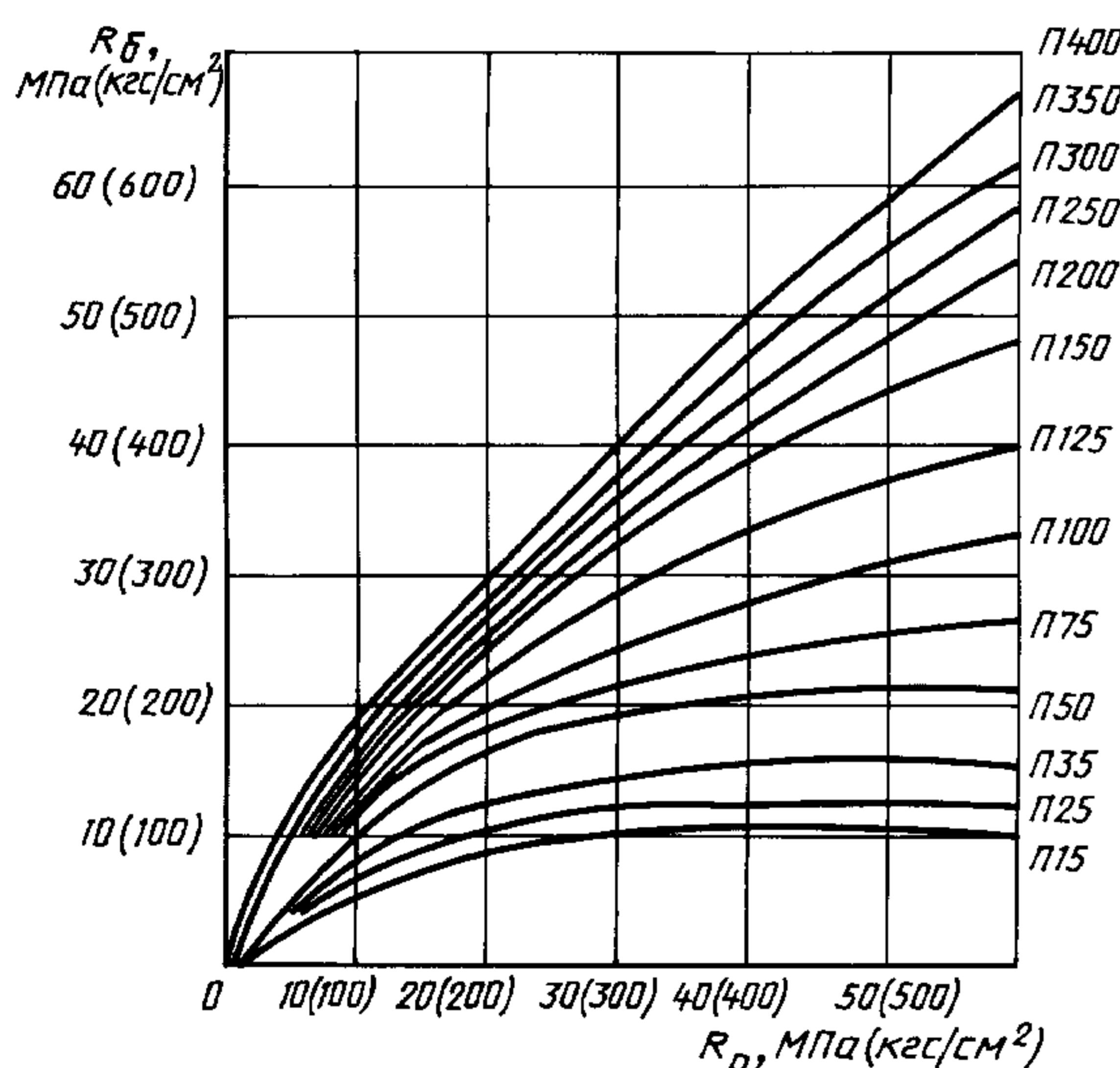
$R_b$  — прочность бетона;  $R_p$  — прочность раствора, отсекенного от бетона;  $\Pi$  — марочная прочность заполнителя
