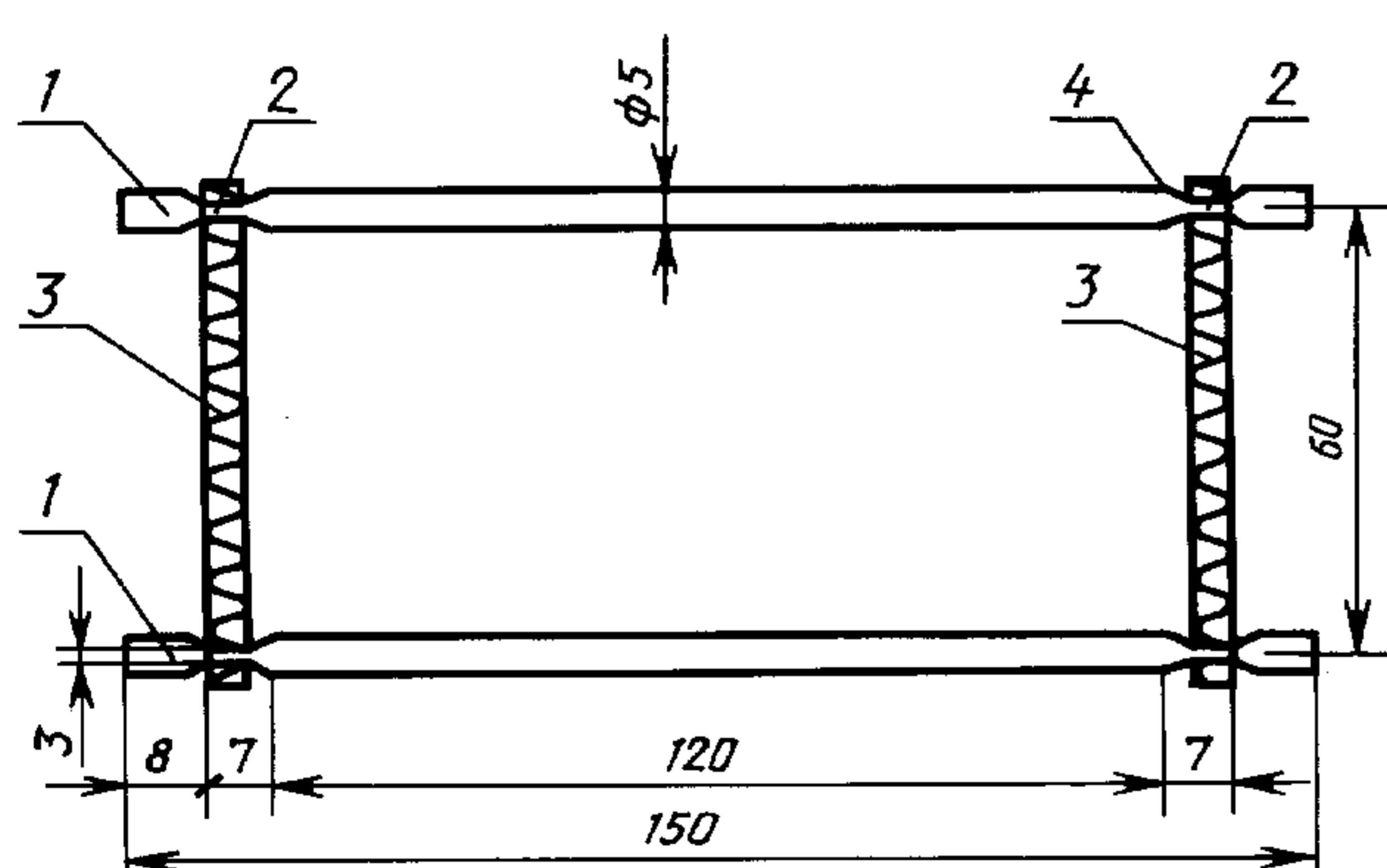
1 — металлические стержни диаметром 5 мм; 2 — места расточки стержней до диаметра 3 мм; 3 — резинка-продержка (или стальная пружина); 4 — места прошивки резинки
