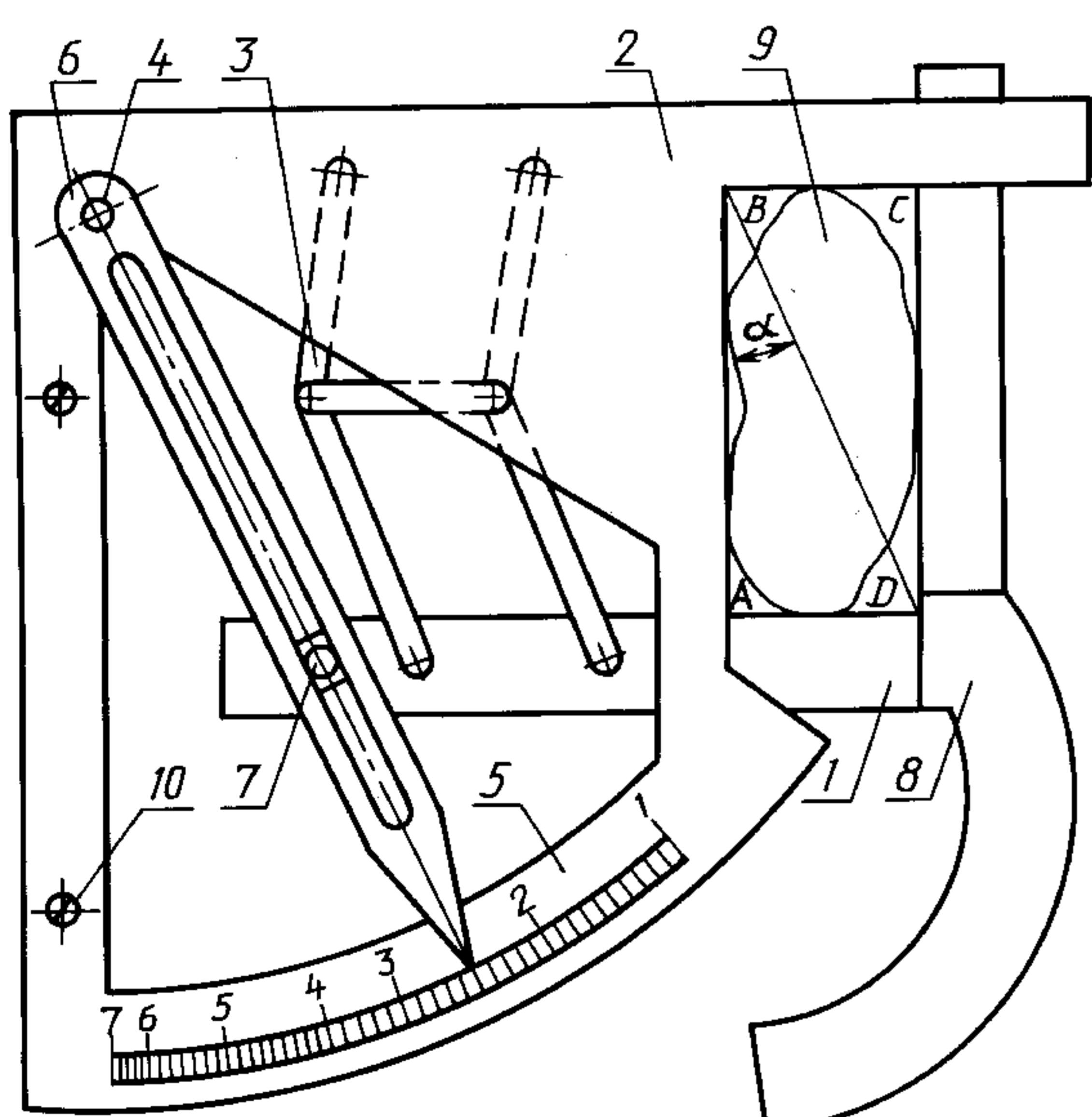
1 — подвижный уголник; 2 — неподвижный уголник; 3 — двойной шарнирный параллелограмм; 4 — кулиса-стрелка; 5 — шкала; 6 — ось поворота; 7 — ось ползуна; 8 — рукоятка; 9 — зерно щебня; 10 — инвентарный винт
