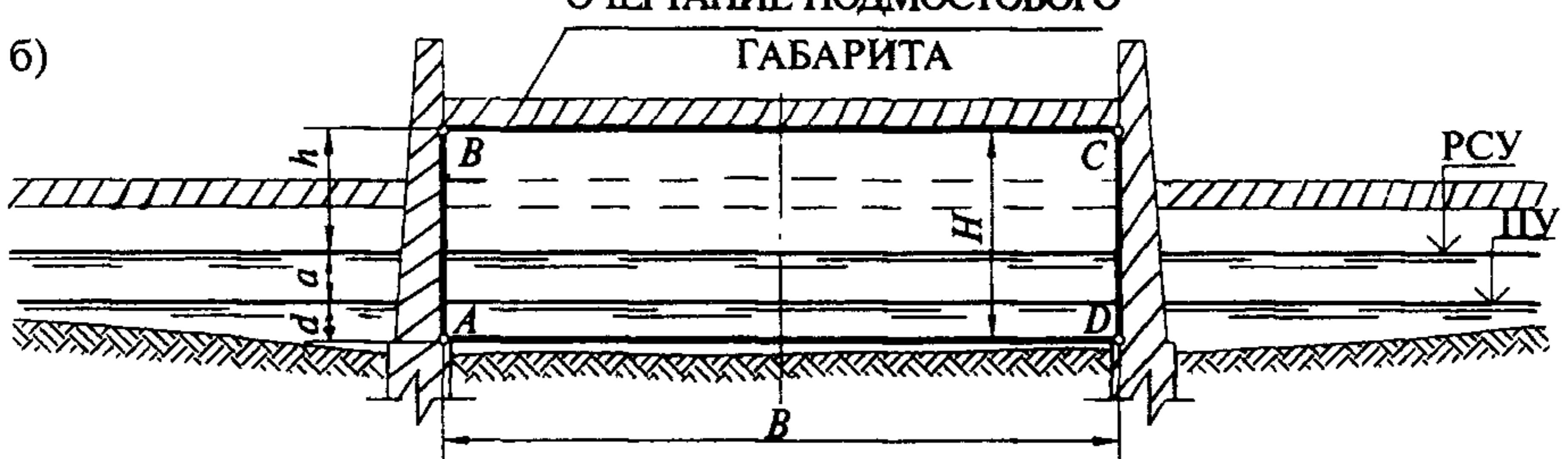
$ABCD$  — контур подмостового габарита;
