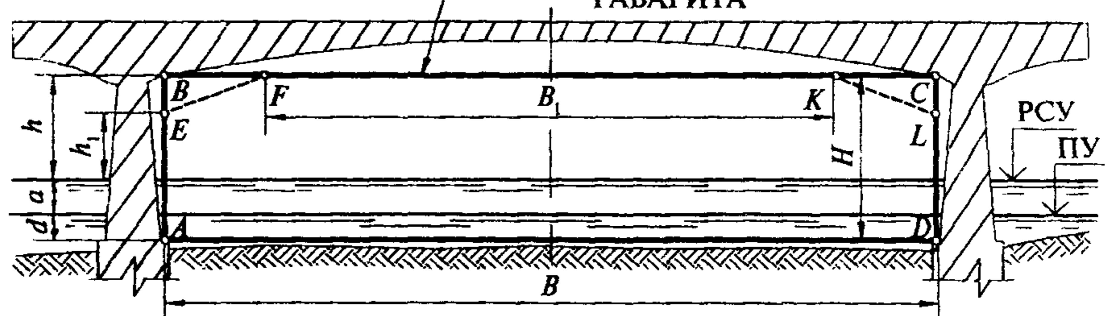
$ABCDA$  и  $AEFKLD$  — контуры подмостового габарита;
