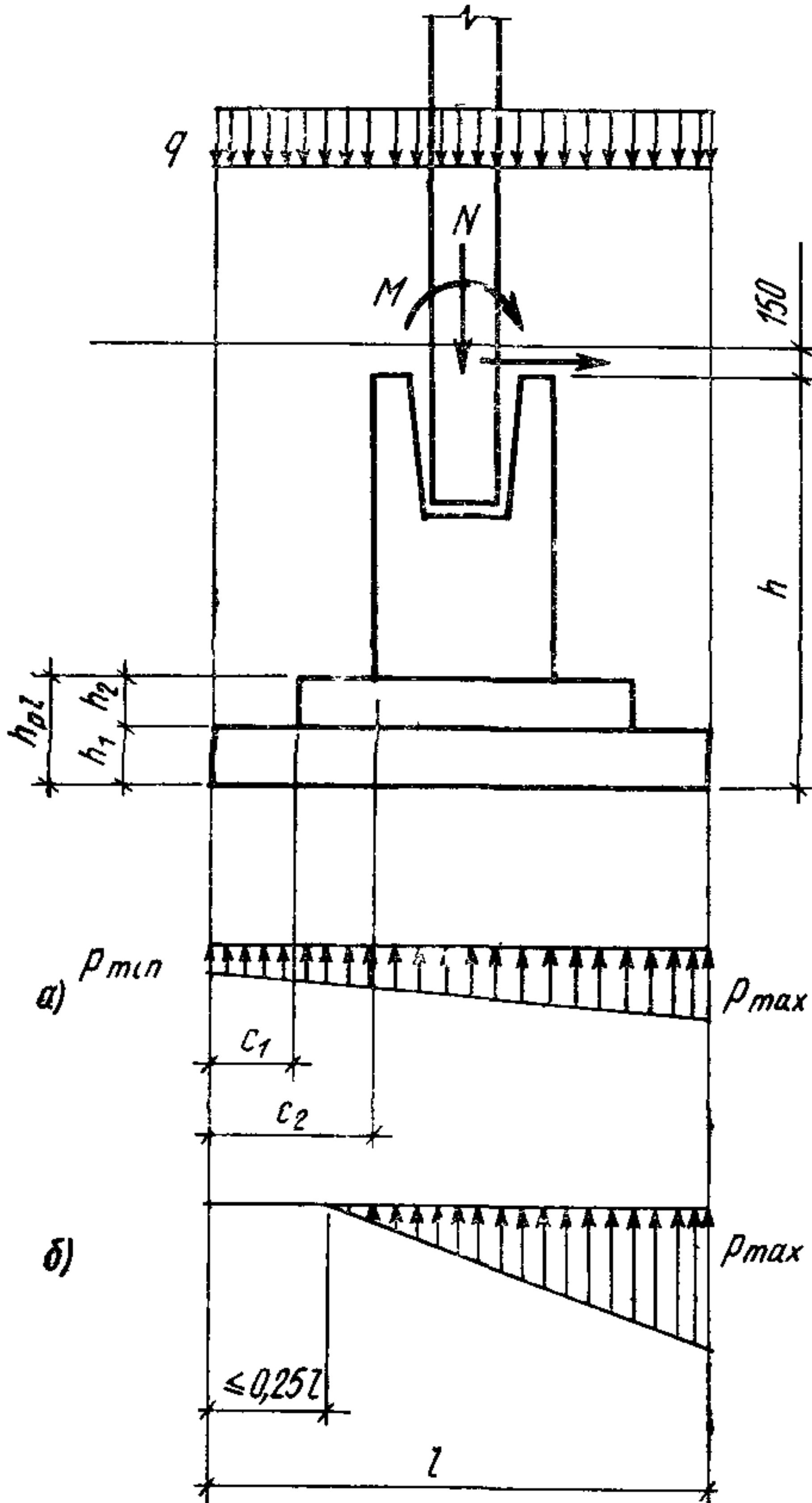
Черт. 17. Расчетные схемы и сечения при проверке прочности на обратный момент внешнецентрично нагруженного фундамента
