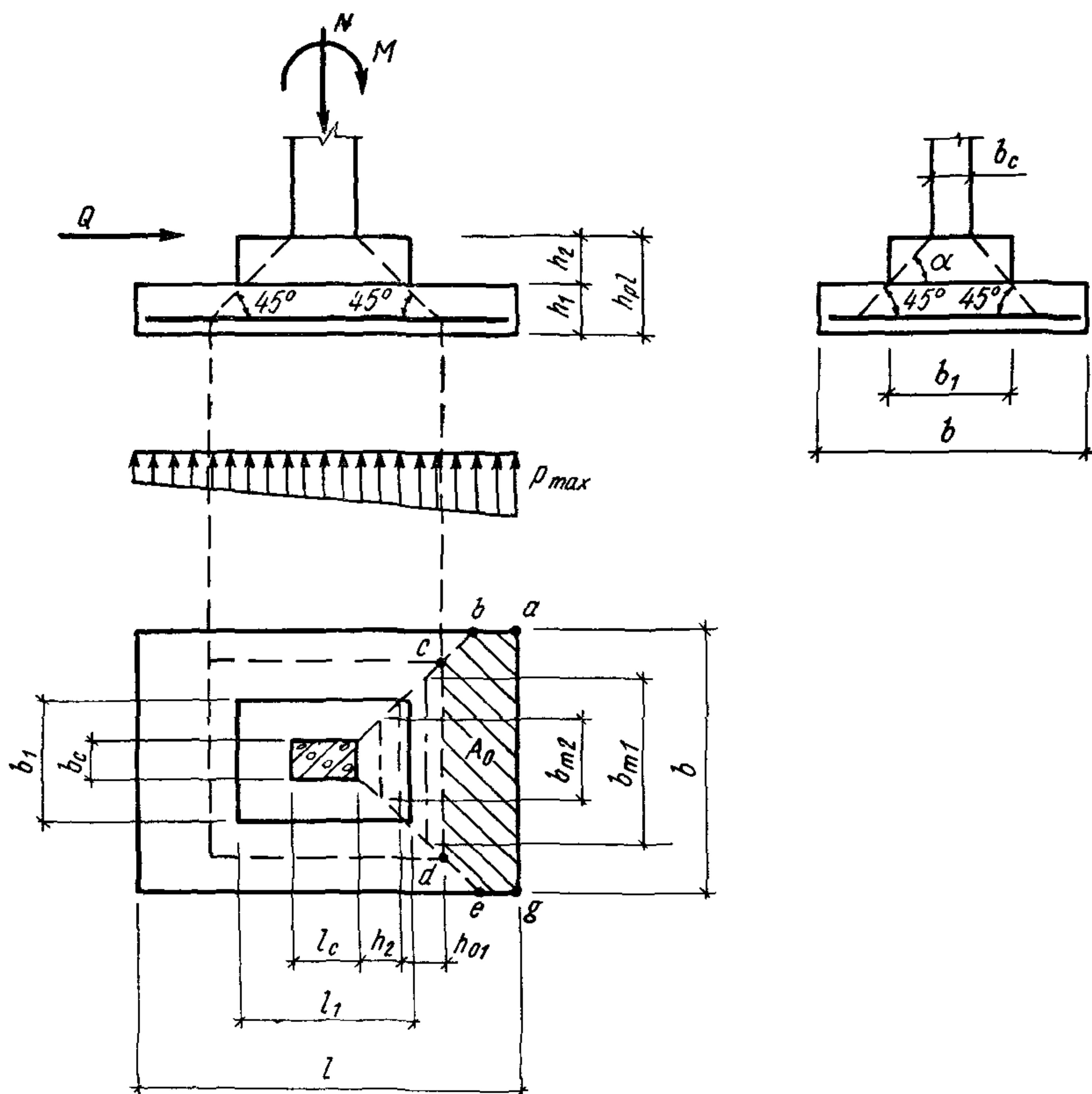
Черт. 13. Схема образования пирамиды продавливания в прямоугольных железобетонных фундаментах с верхней ступенью размерами, при которых одна из сторон ступени  $l_1 \geq l_c + 2h_2$ , а другая  $b_1 < b_c + 2h_2$
