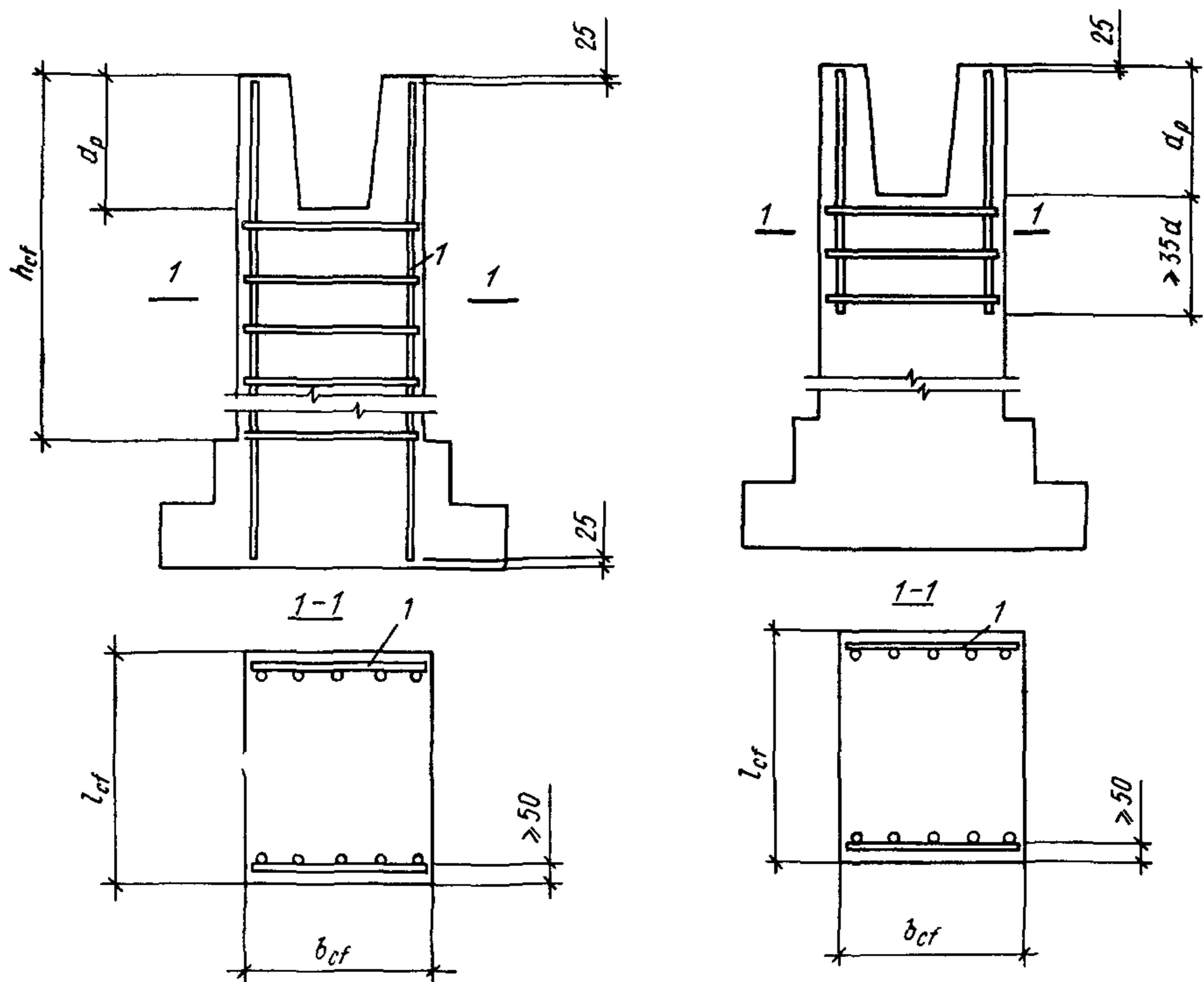
Черт. 29. Армирование железобетонного подколонника двумя сетками
