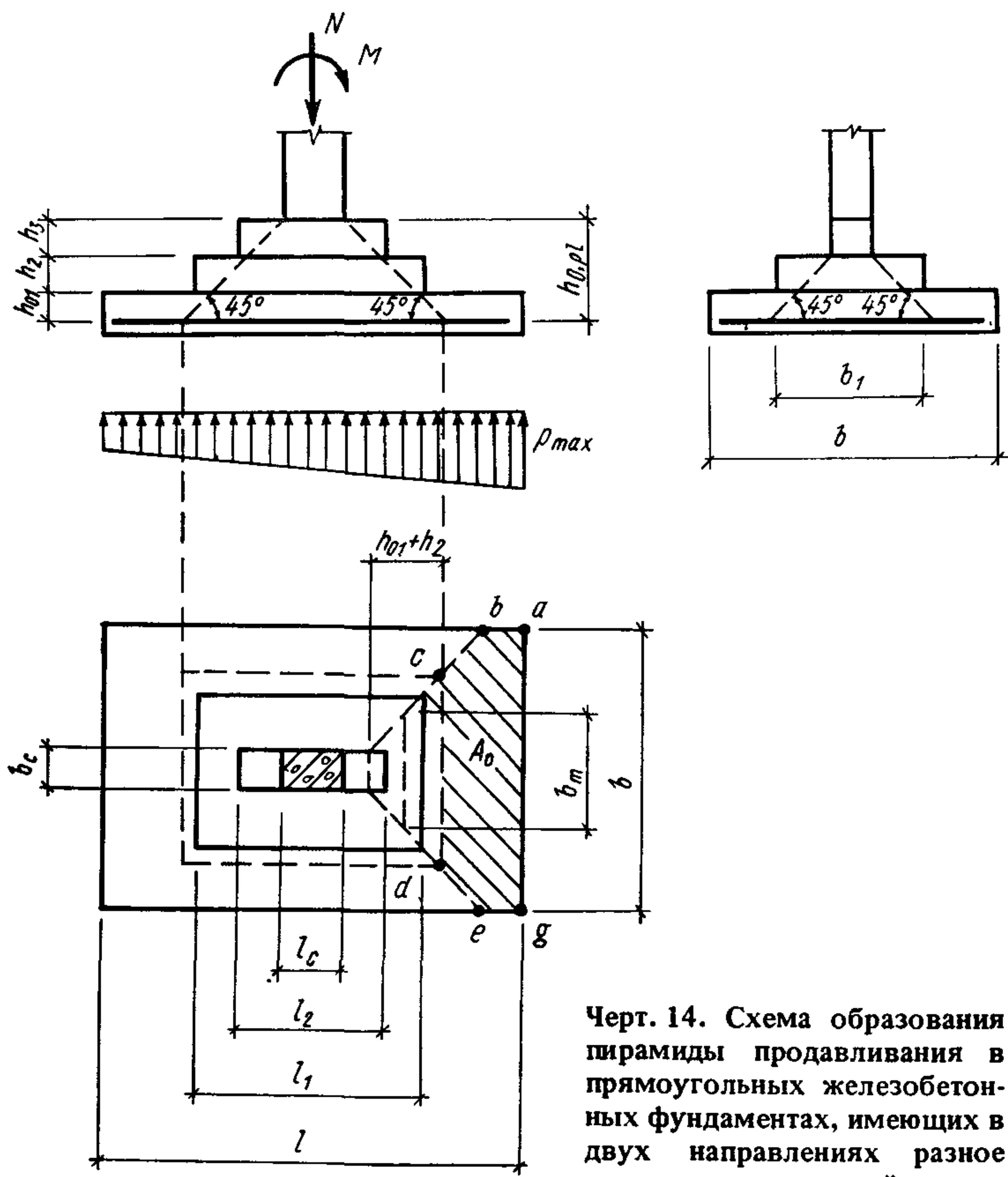
Черт. 14. Схема образования пирамиды продавливания в прямоугольных железобетонных фундаментах, имеющих в двух направлениях разное число ступеней
