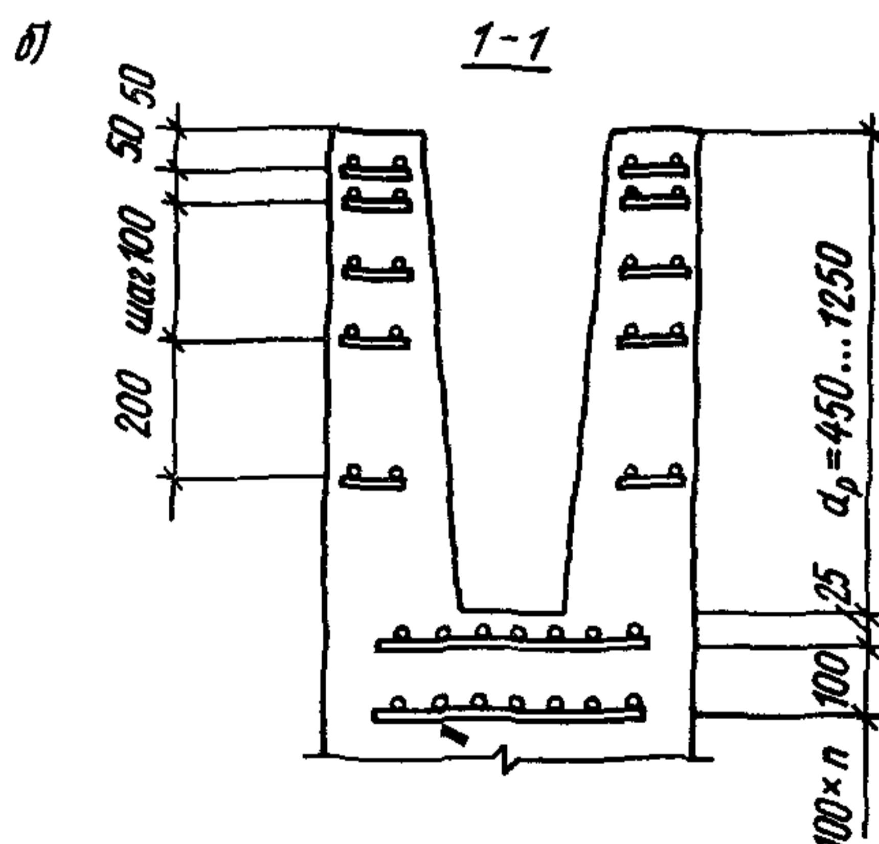
**4.27.** Толщина защитного слоя бетона для рабочей арматуры подколонника должна быть не менее 30 мм, а для подошвы фундамента при условии устройства под ним бетонной подготовки принимается равной 35 мм.
