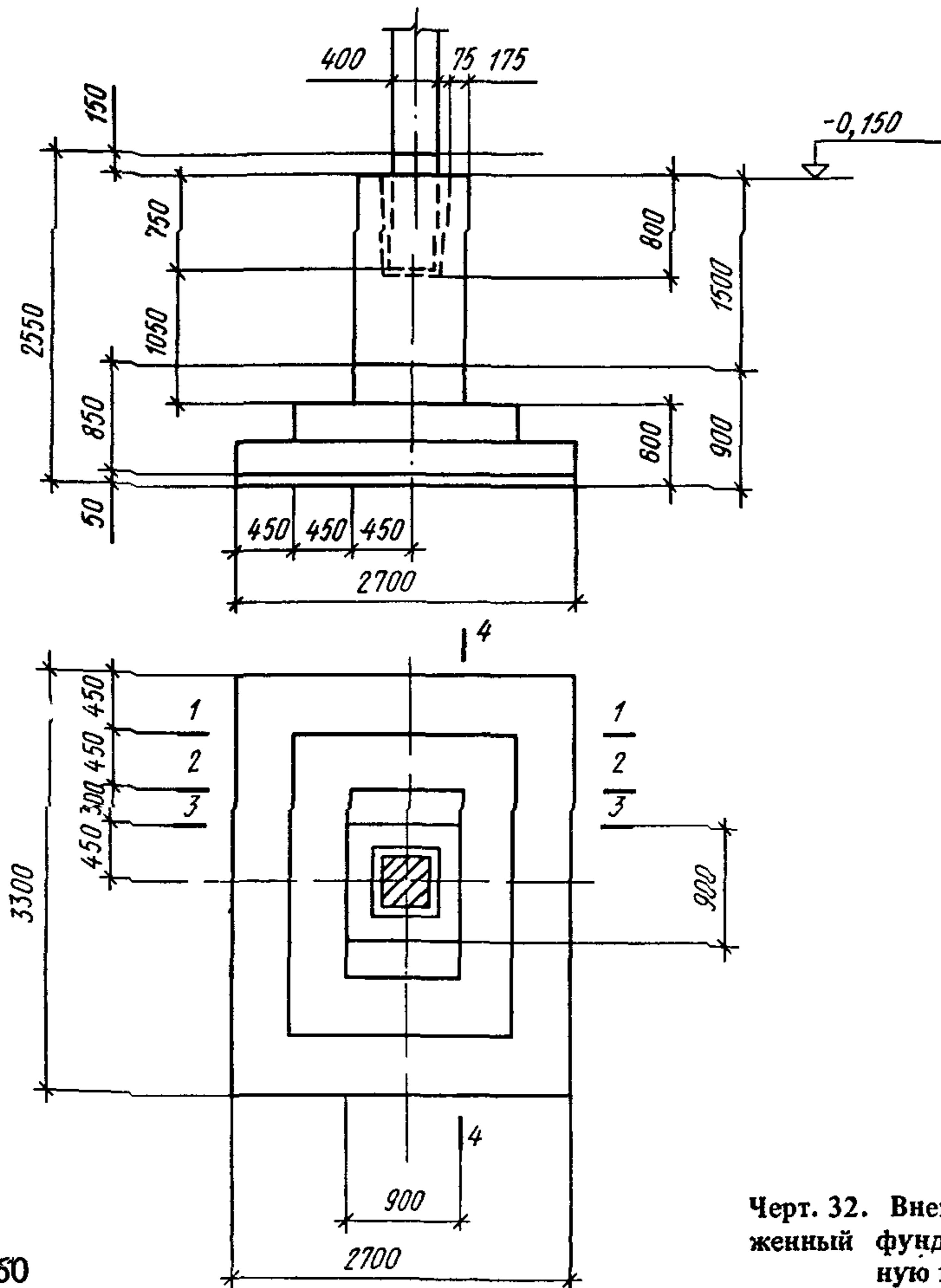
Черт. 32. Внеклентрически нагруженный фундамент под сборную колонну
