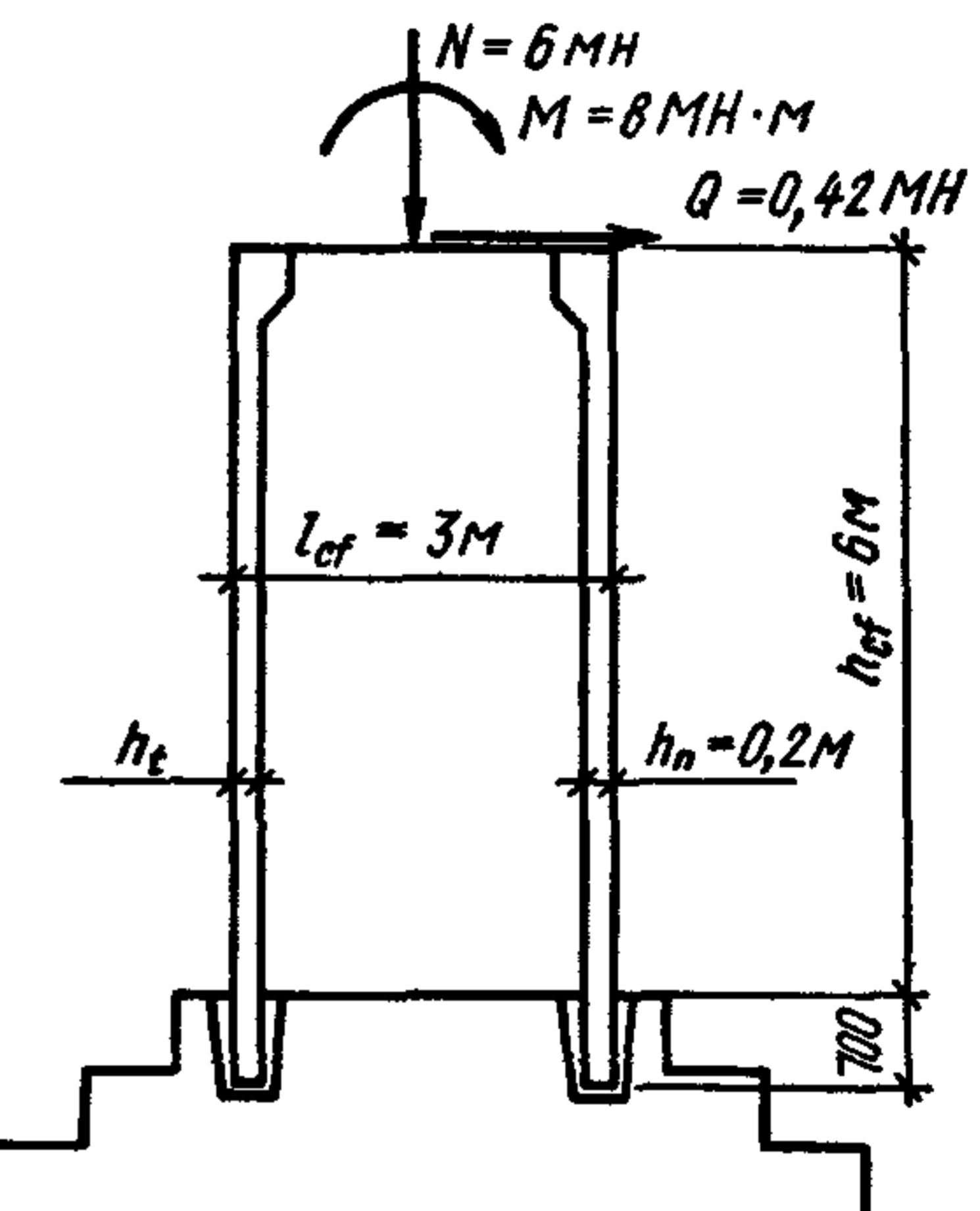
Расчетные нагрузки на уровне верха подколонника с учетом ветровых и крановых нагрузок:  $N = 6 \text{ МН (600 тс)}$ ,  $M = 8 \text{ МН} \cdot \text{м (800 тс} \cdot \text{м)}$ ,  $Q = 0,42 \text{ МН (42 тс)}$ . С учетом коэффициента надежности по назначению для сооружений II класса  $\gamma_n = 0,95$ :
