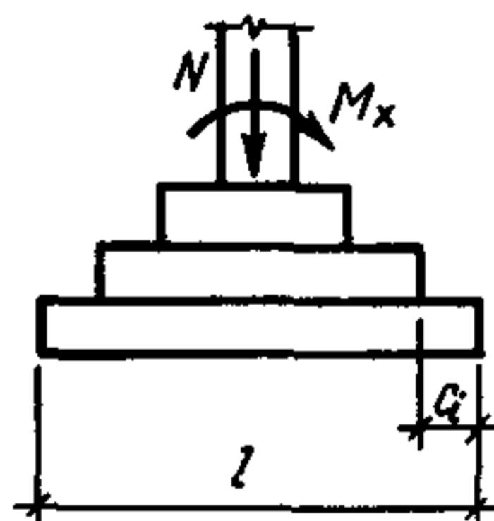
Черт. 18. Расчетные схемы для определения арматуры внецентренно нагруженного фундамента
