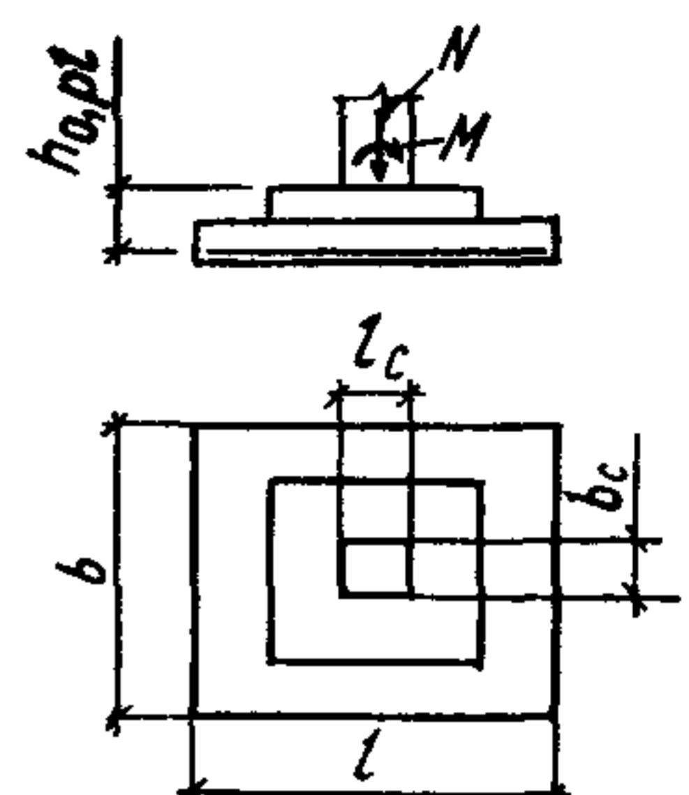
Порядок определения высоты фундамента  $H_0$  показан стрелками на графике: по найденным значениям  $A_3 = 11$  м и  $\gamma_{b2} R_{bt}/p = 3,0$ ,
