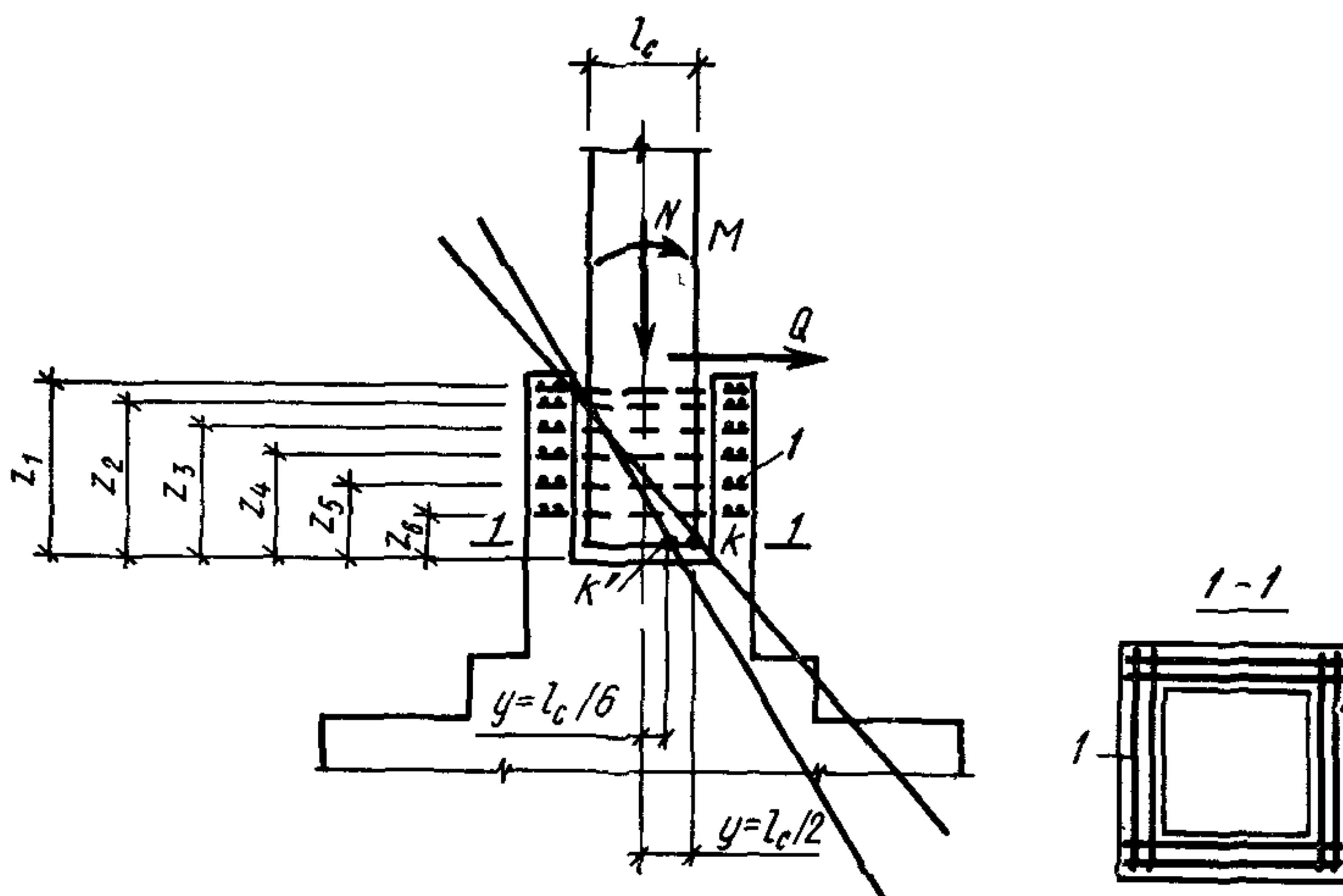
Черт. 21. Расчетная схема стаканной части подколонника
