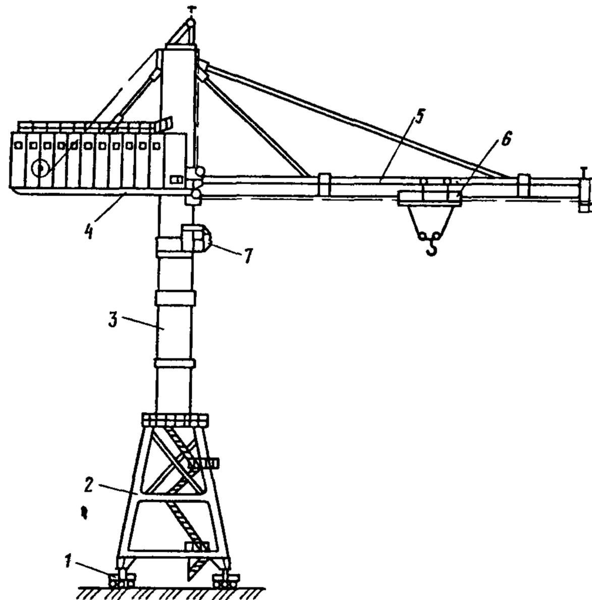
**Рис. 7. Кран башенный трубчатой конструкции**
