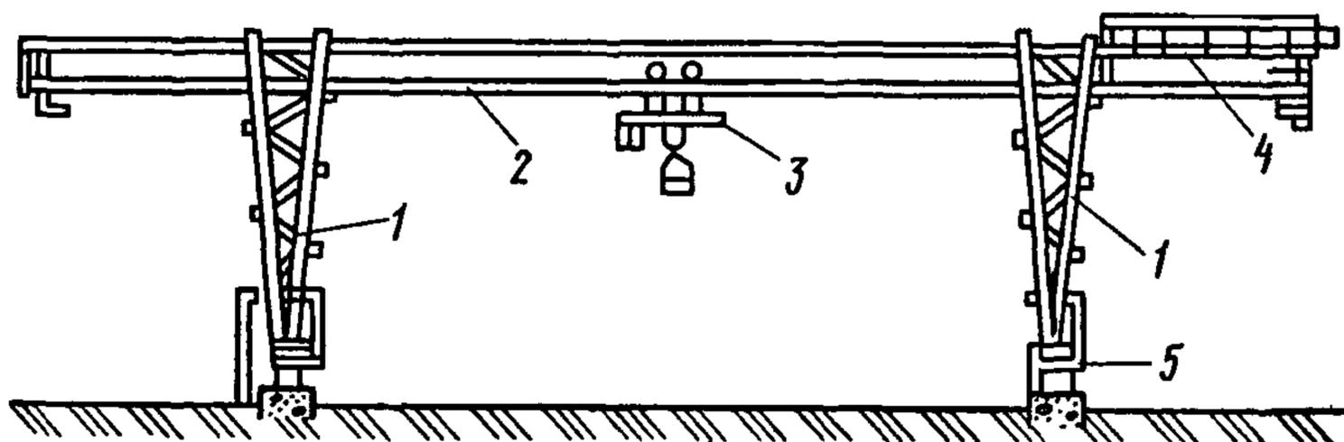
Рис. 10. Кран-перегрузатель трубчатой конструкции
