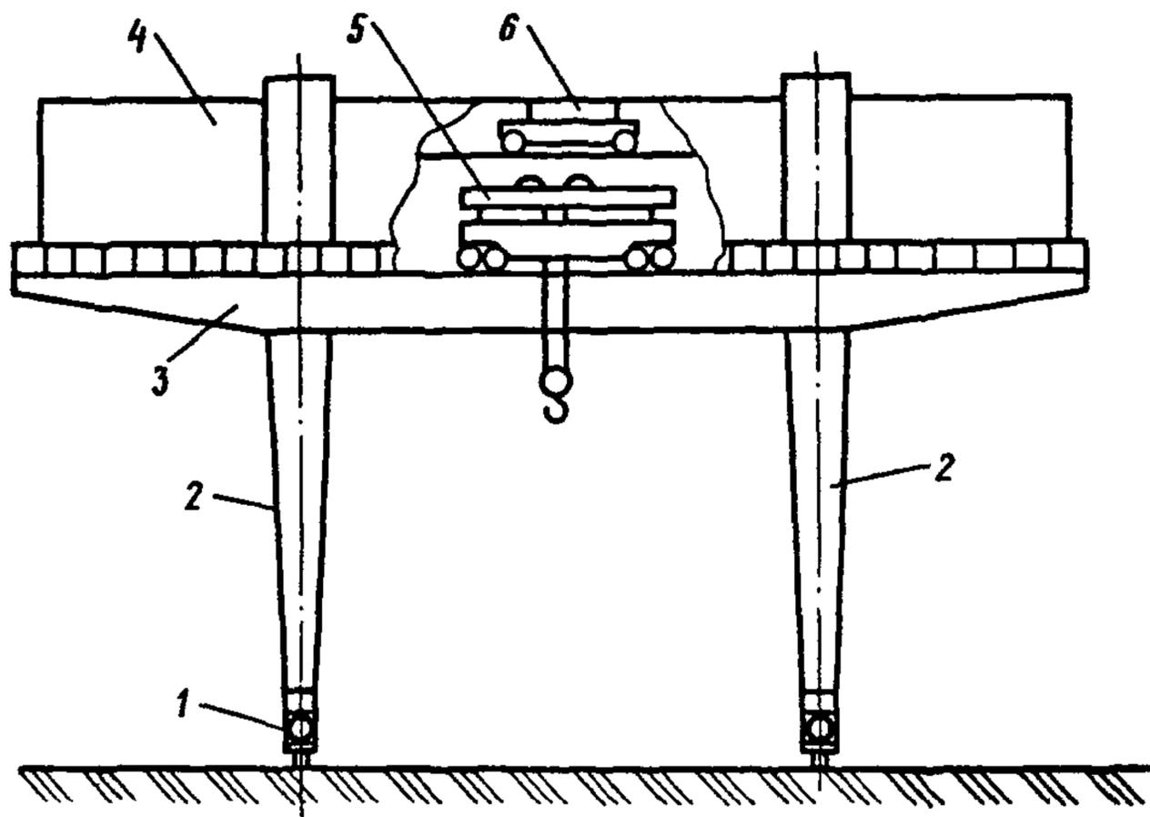
Рис. 4. Кран козловой гидротехнический
