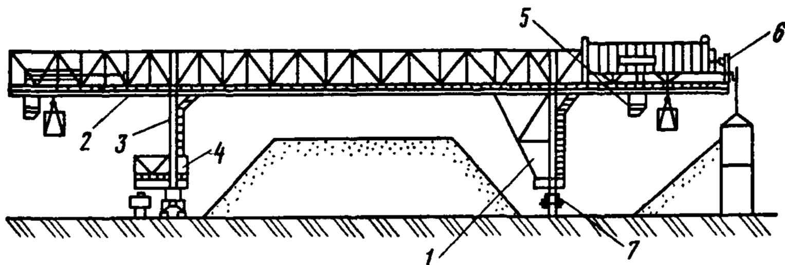
Рис. 9. Кран-перегрузатель коробчатой конструкции
