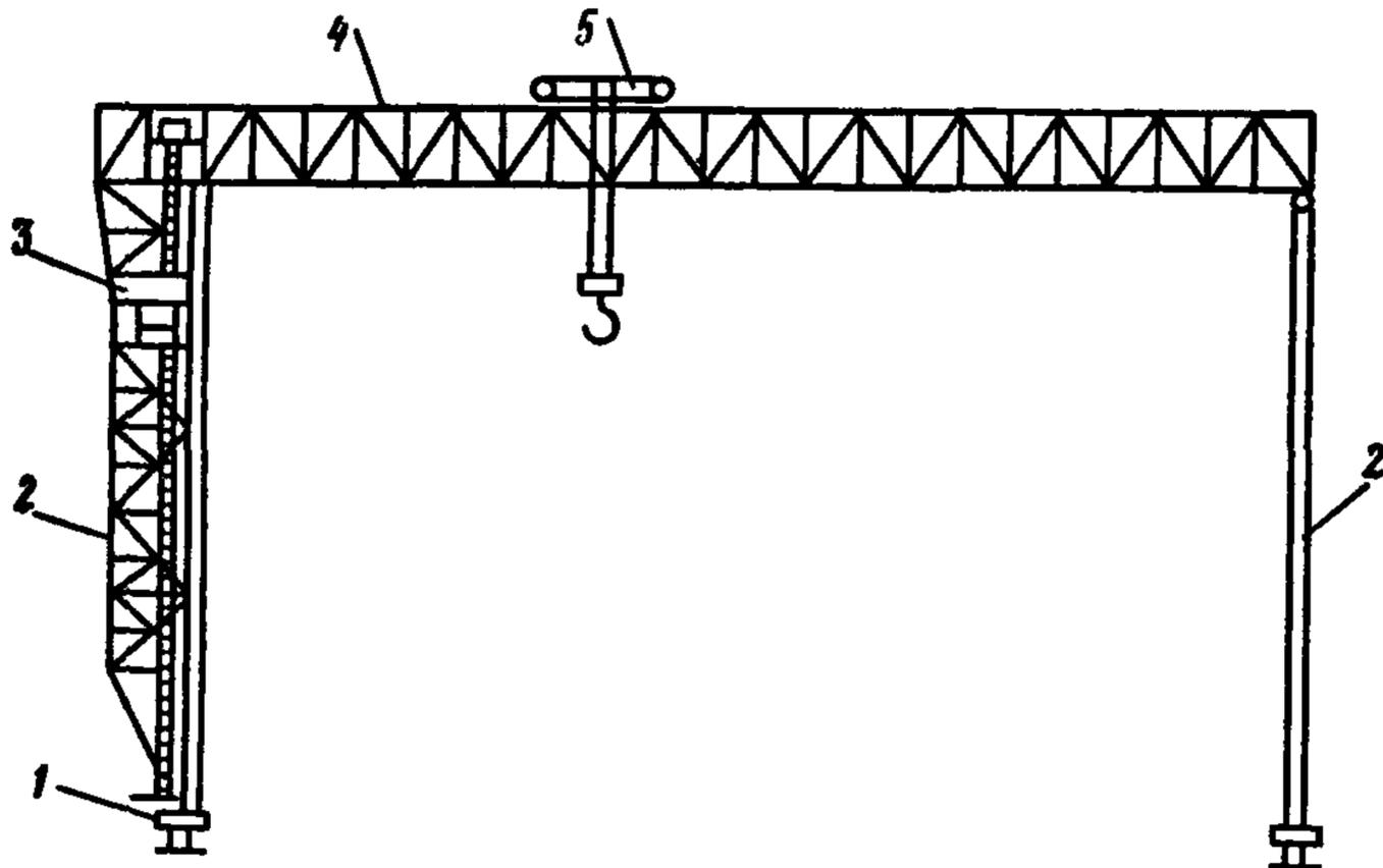
Рис. 2. Кран козловой общего назначения
