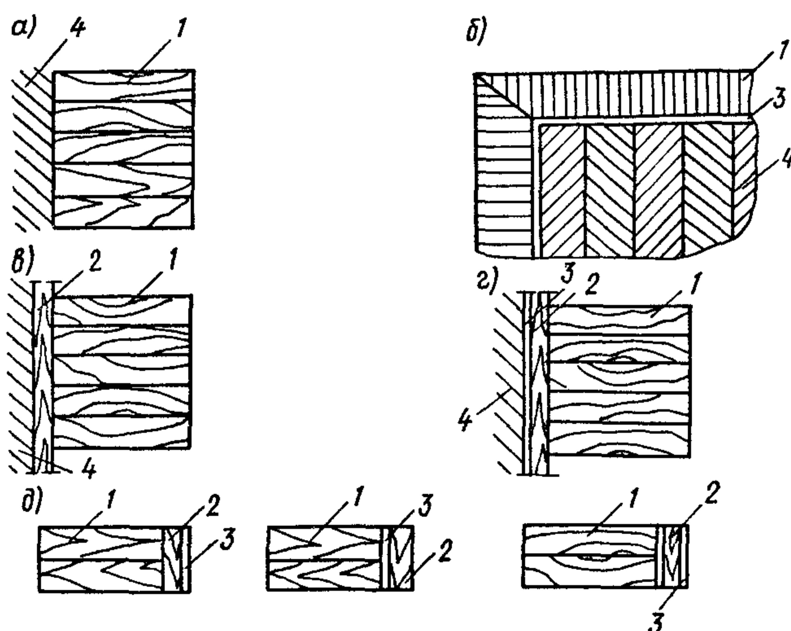
*a* – без окантовки; *б* – с окантовкой в одну жилку; *в* – с линейкой из одного продольного ряда планок; *д* – с линейкой из одного продольного ряда планок и жилок;
