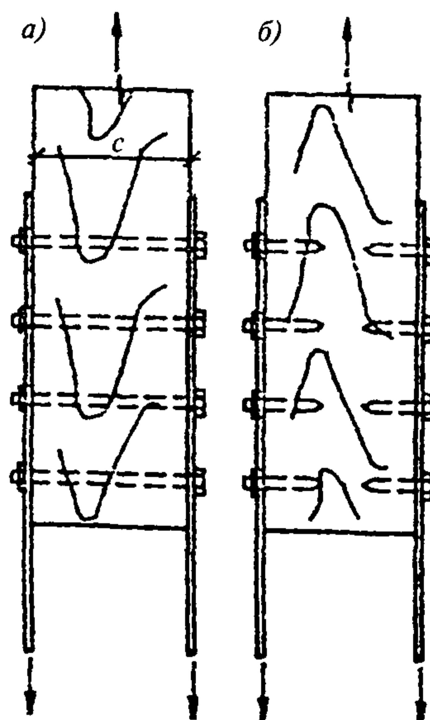
Рис. 9. Нагельные соединения со стальными накладками
