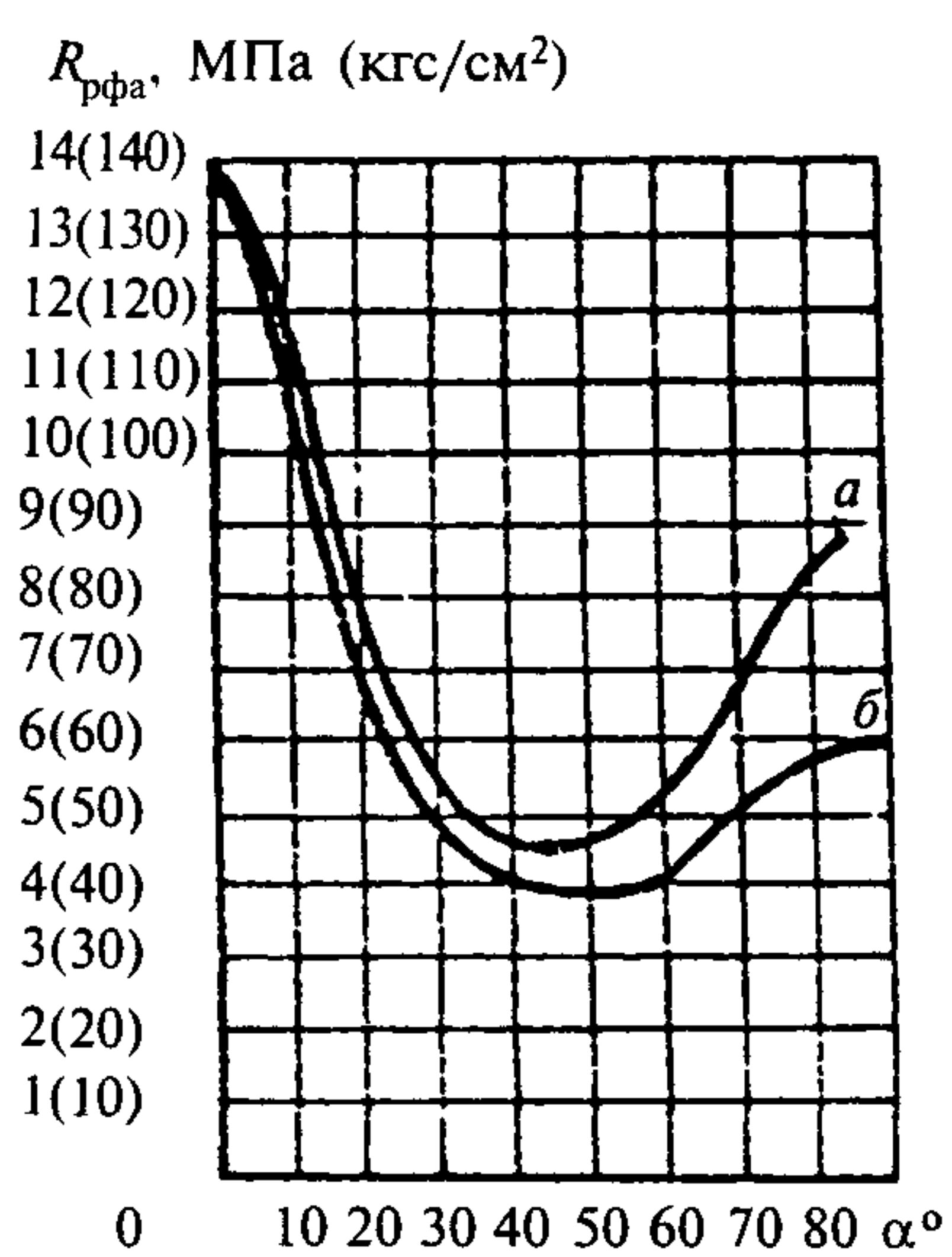
Рис. 1. Графики для определения расчетных сопротивлений при растяжении под углом  $\alpha$  к волокнам наружных слоев березовой фанеры марки ФСФ
