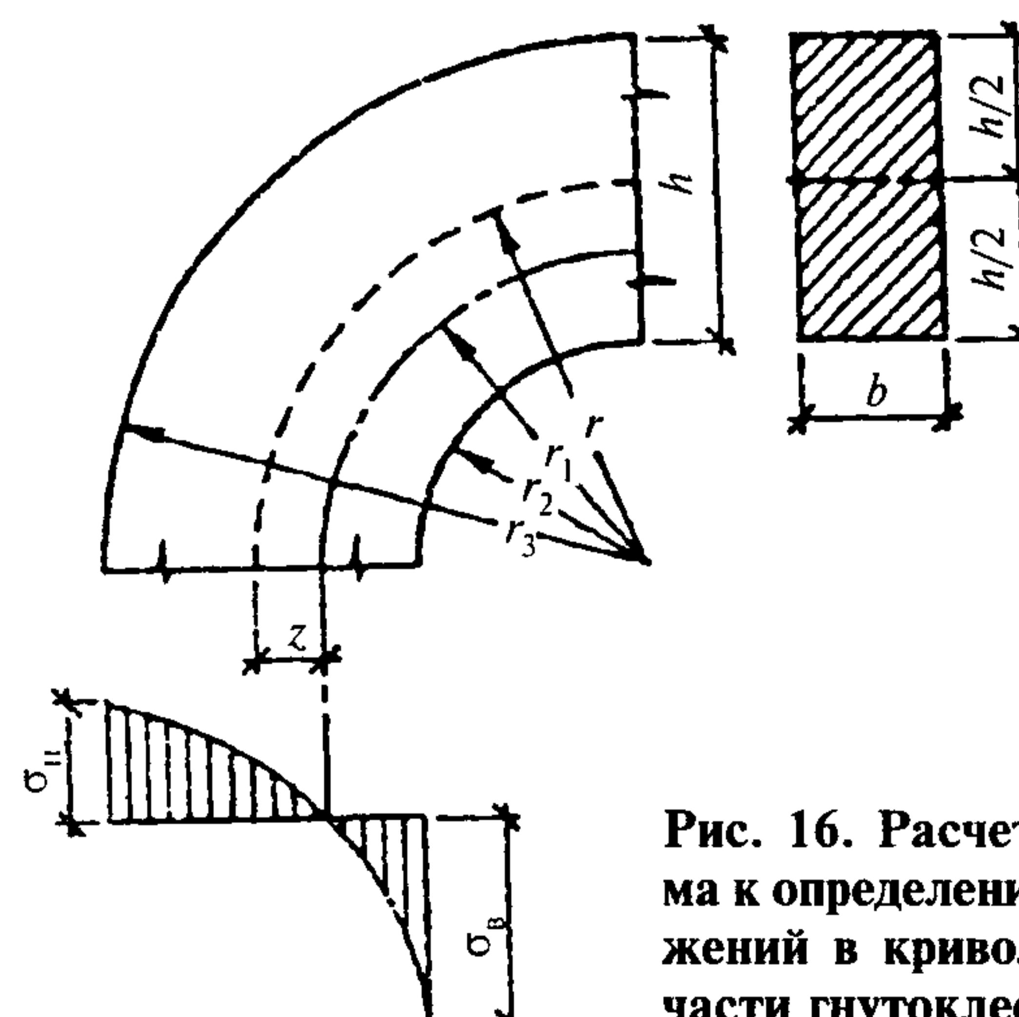
Рис. 16. Расчетная схема к определению напряжений в криволинейной части гнутоклеенных рам
