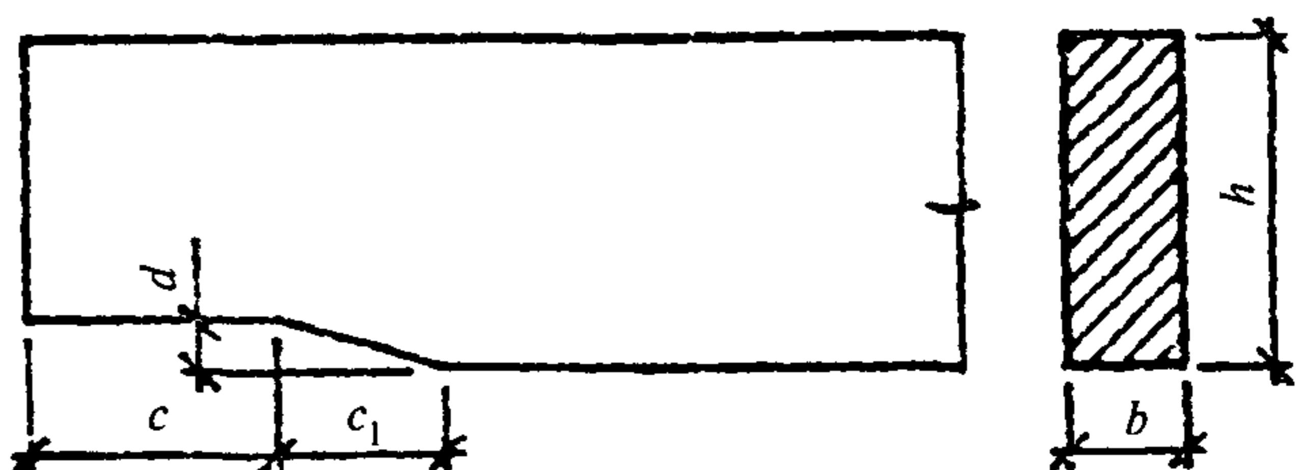
Рис. 15. Скошенная подрезка конца балки
