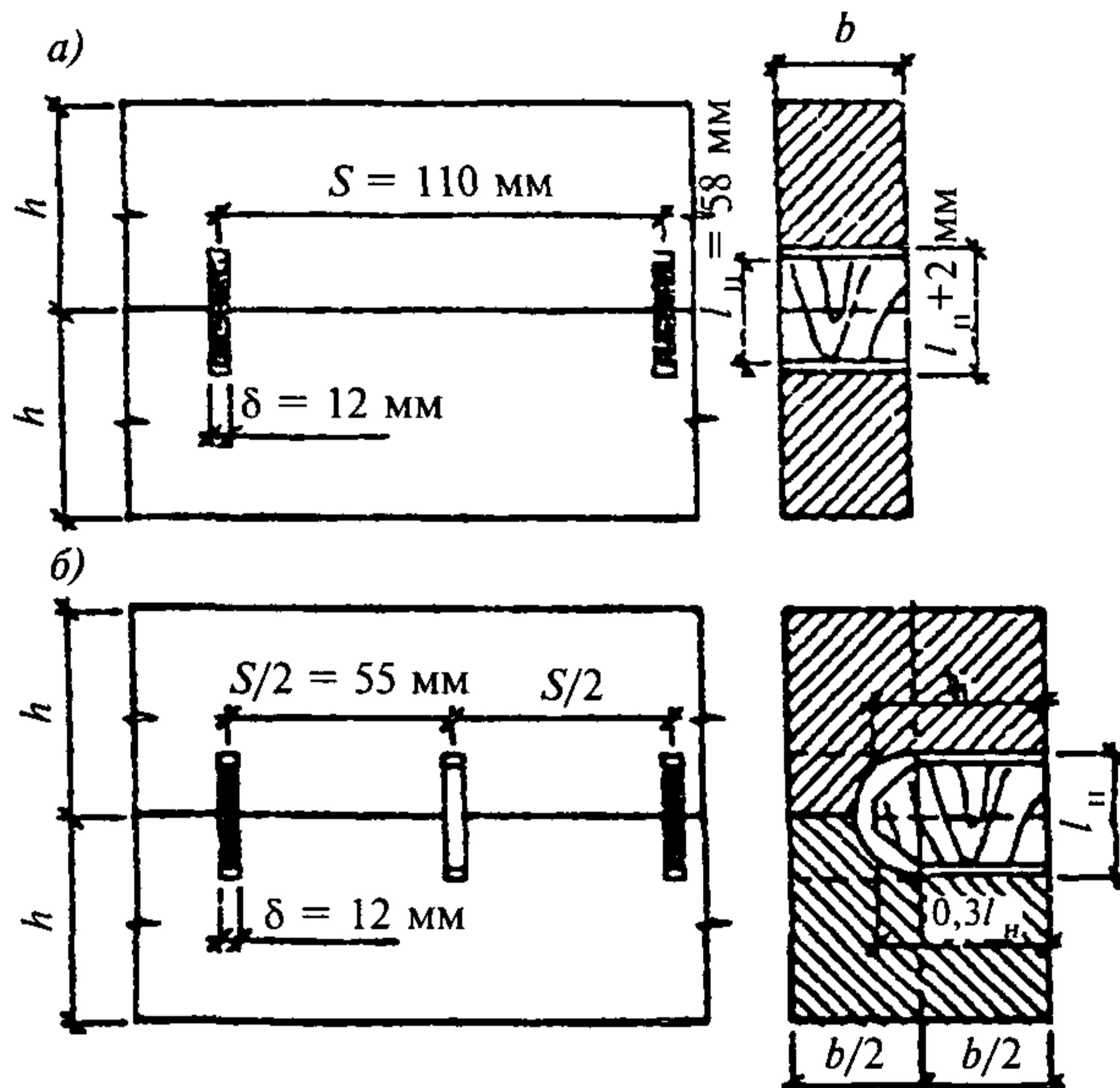
Рис. 13. Соединение на пластинчатых нагелях
