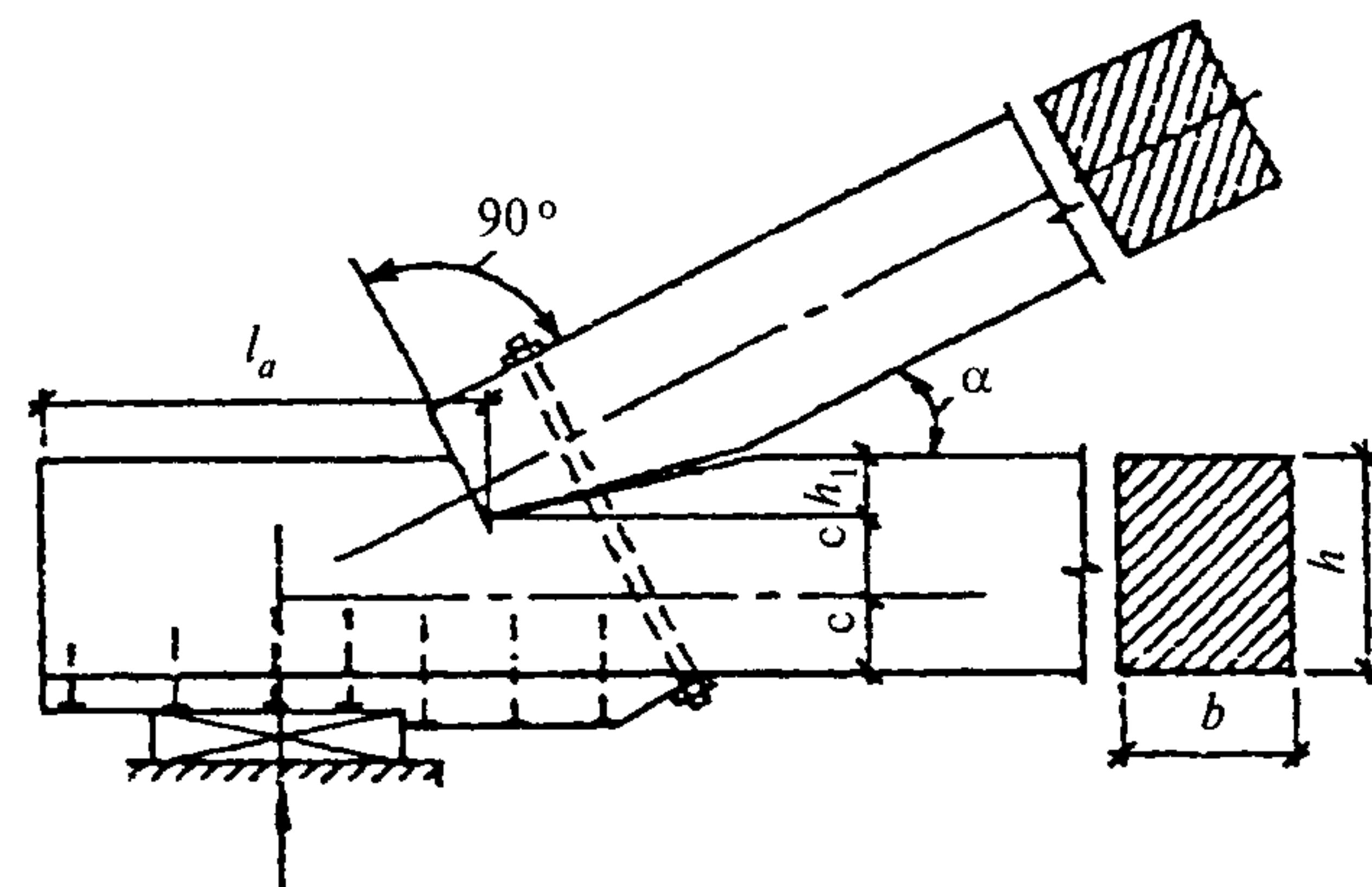
Рис. 7. Лобовая врубка с одним зубом
