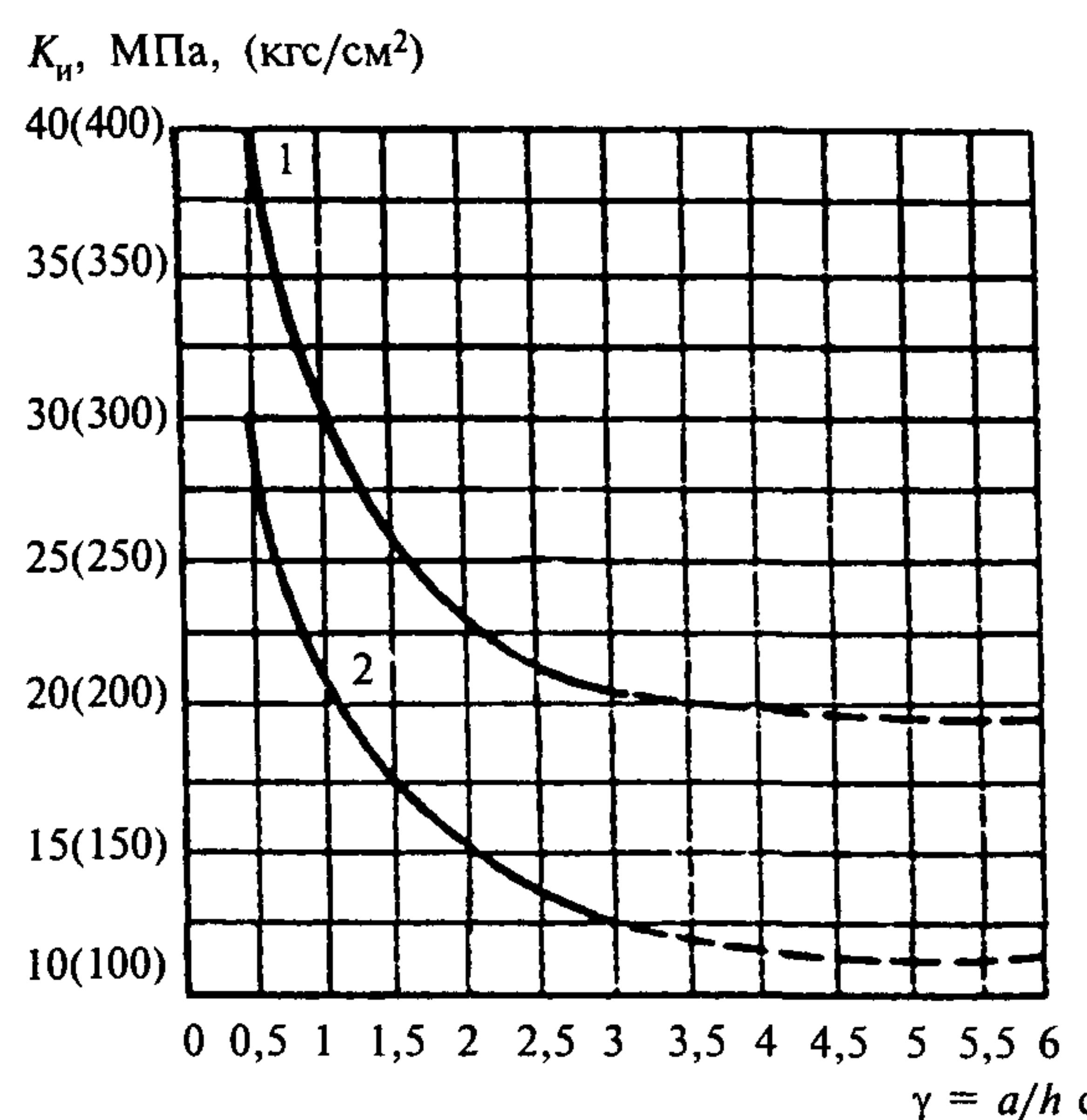
Рис. 2. Графики для определения коэффициента  $k_i$  при расположении волокон в наружных слоях фанеры вдоль пролета
