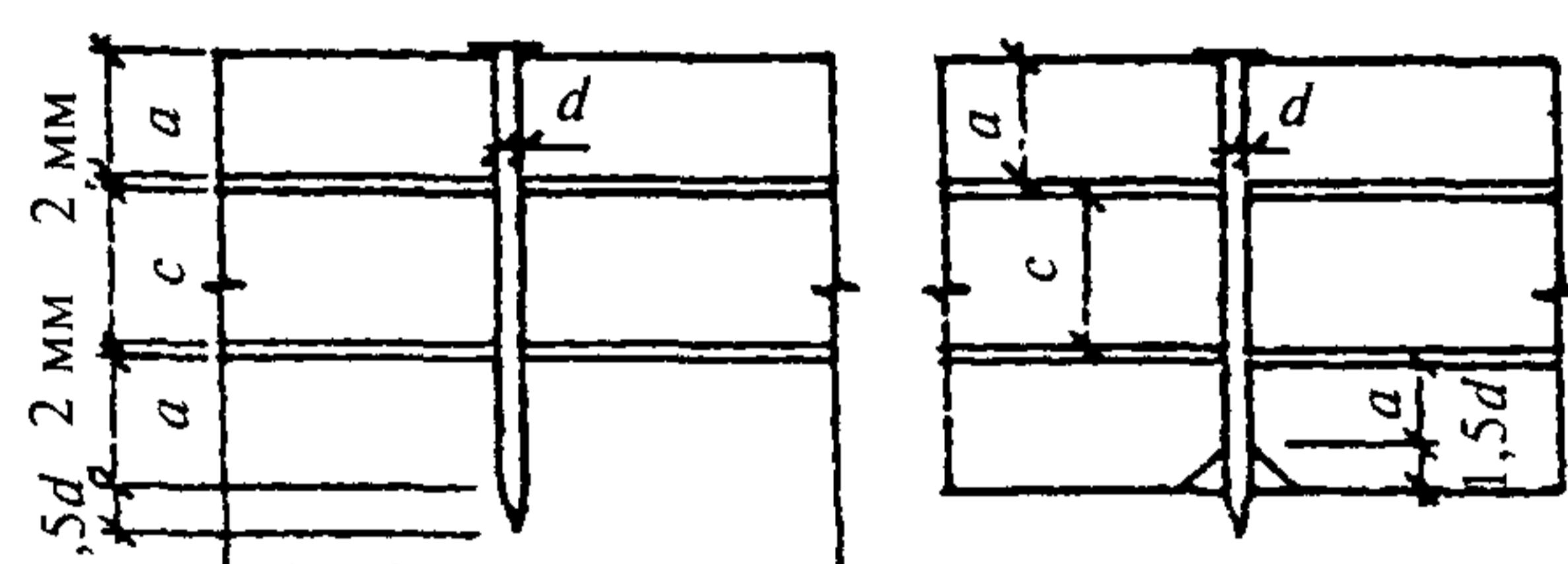
Рис. 11. Определение расчетной длины защемления конца гвоздя
