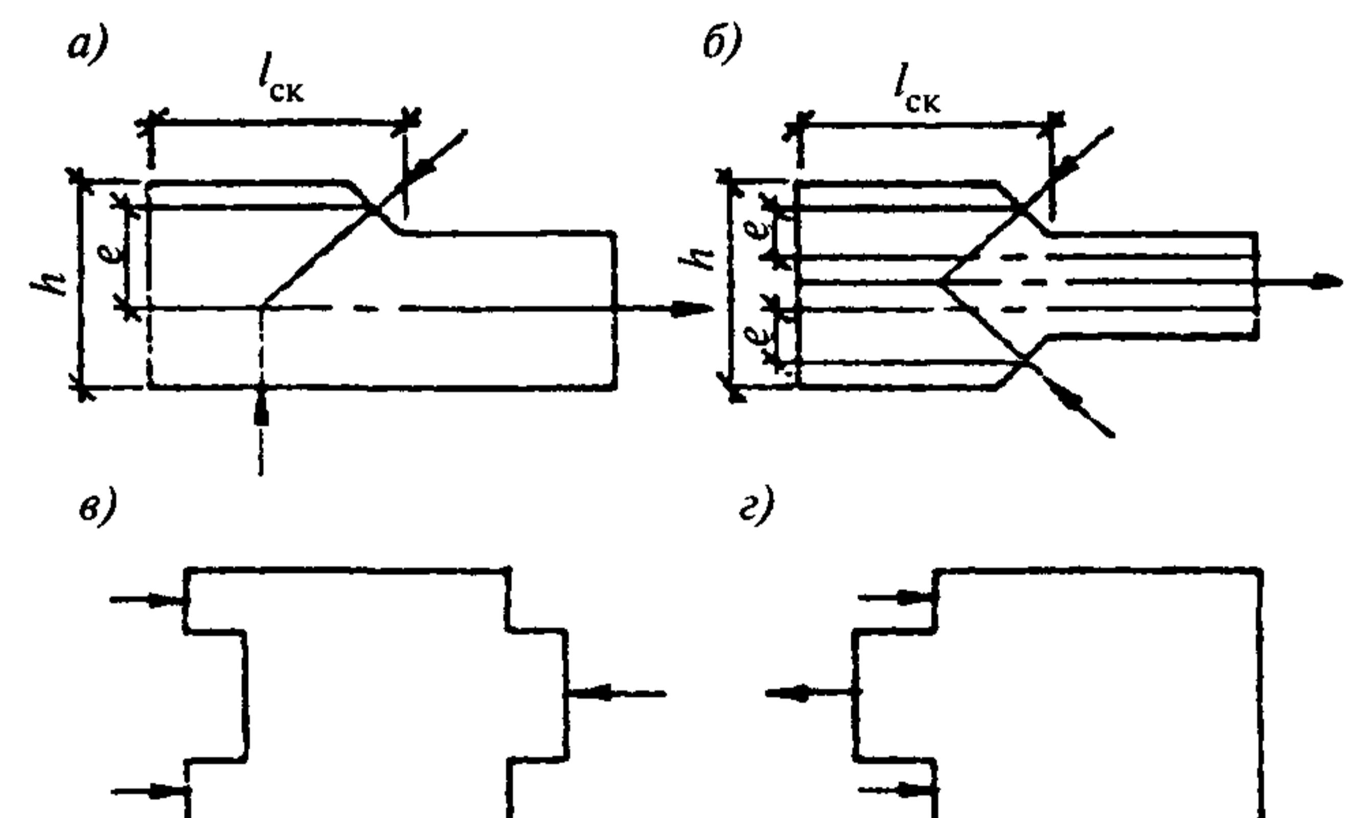
Рис. 5. Врезки в элементах соединений
