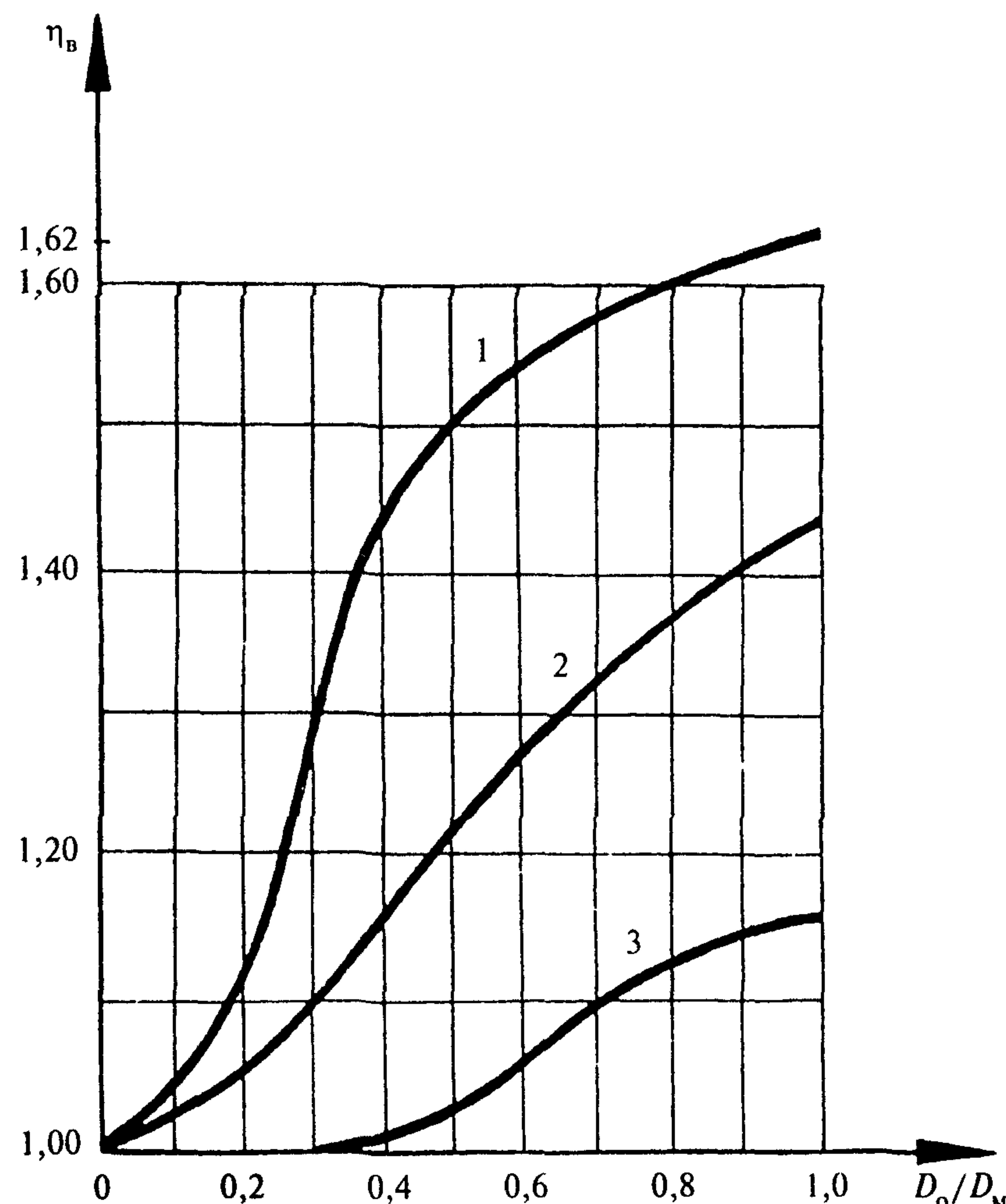
1 — для сварных без усиливающих накладок, 2 — для штампованных и штампосварных;
