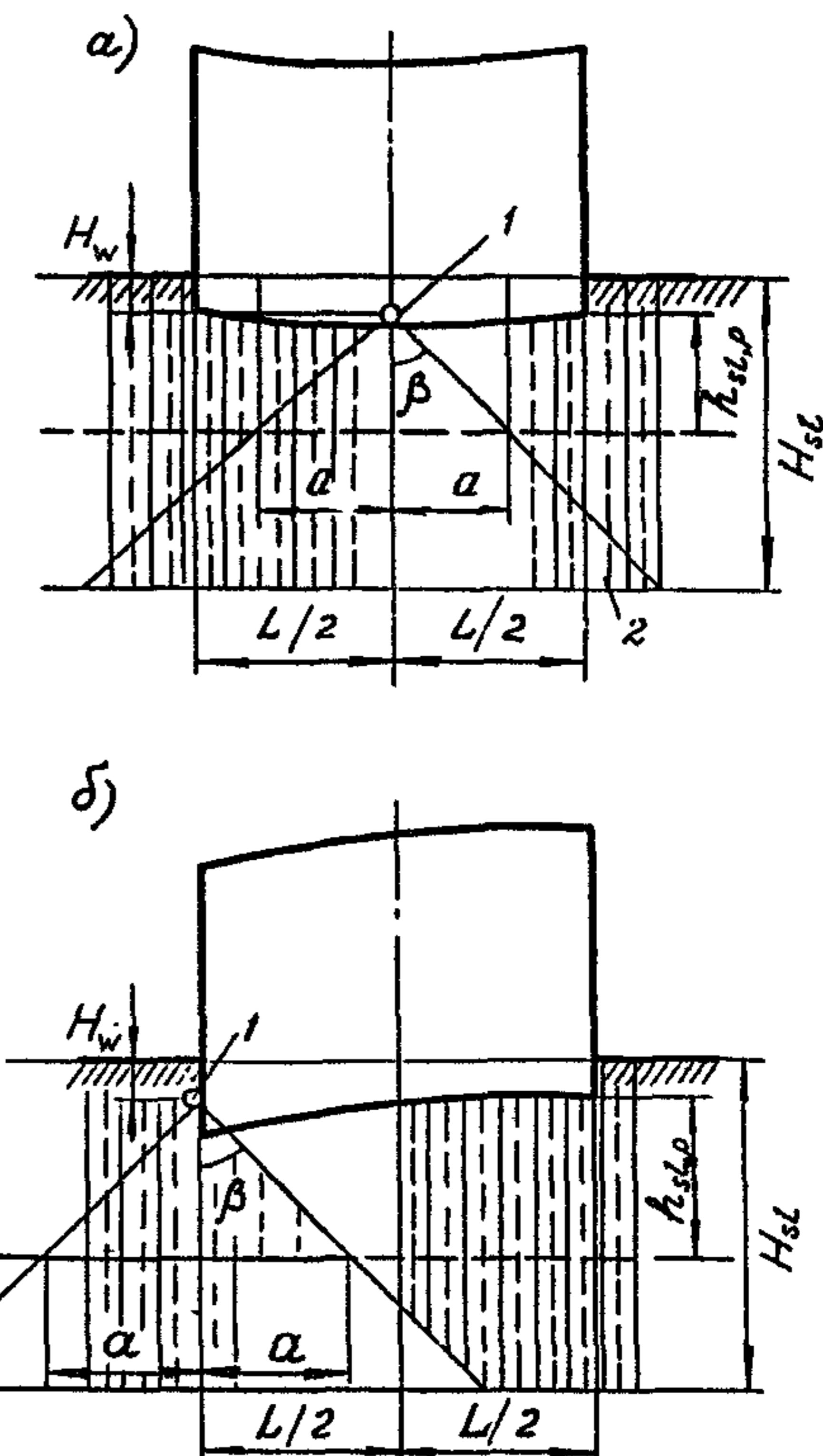
Черт. 3. Схемы вертикальных перемещений основания здания (сооружения) при просадке грунтов от внешней нагрузки
