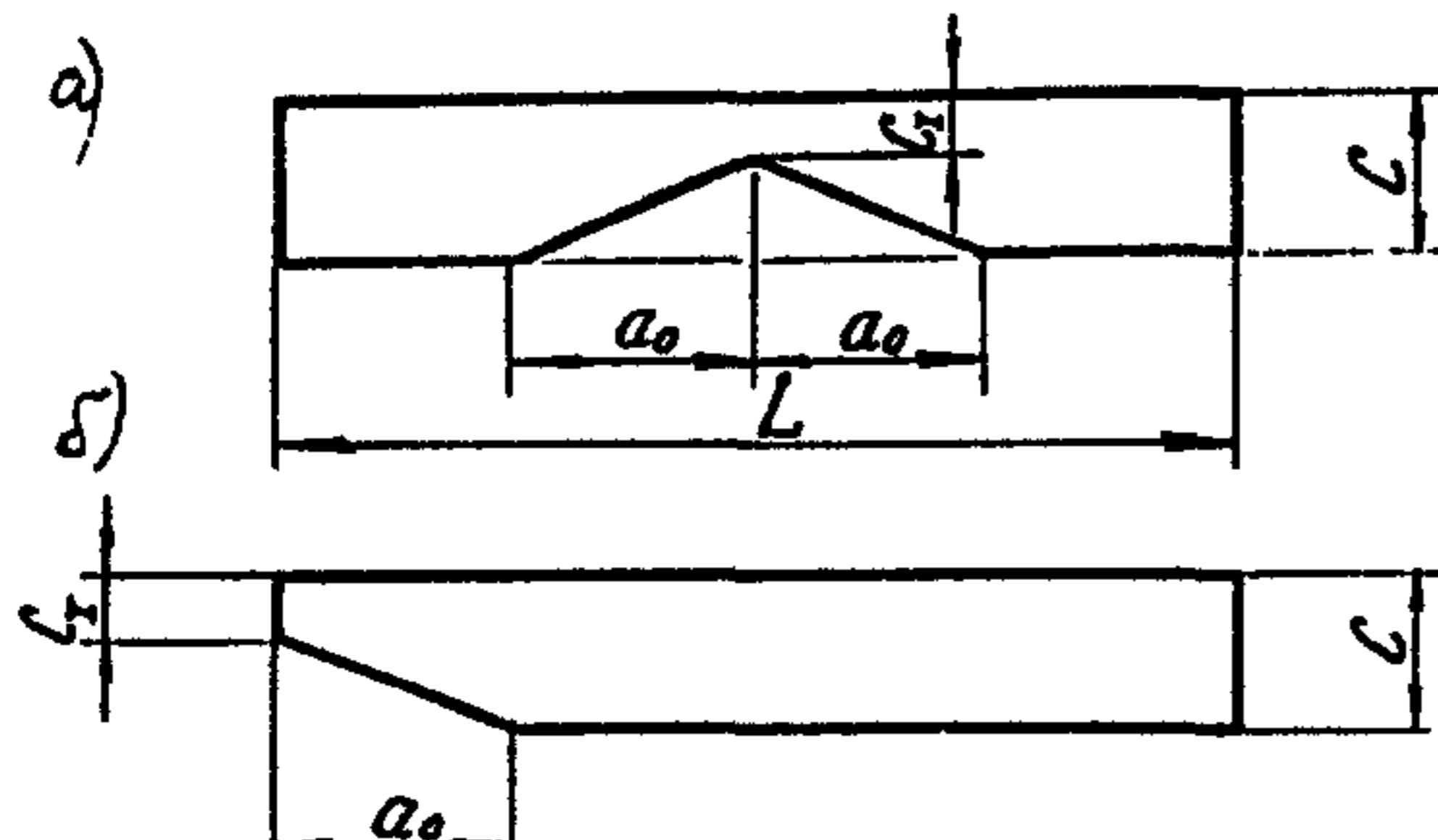
Черт. 5. Схемы изменения жесткости основания в грунтовых условиях I типа по просадочности
