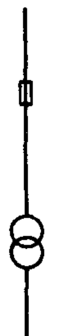
2. БЛОК (ЛИНИЯ-ТРАНСФОРМАТОР) С ПРЕДОХРАНИТЕЛЕМ 35 кВ
