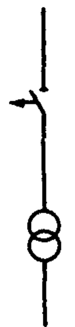
3. БЛОК (ЛИНИЯ-ТРАНСФОРМАТОР) С ОТДЕЛИТЕЛЕМ 35+220 кВ
