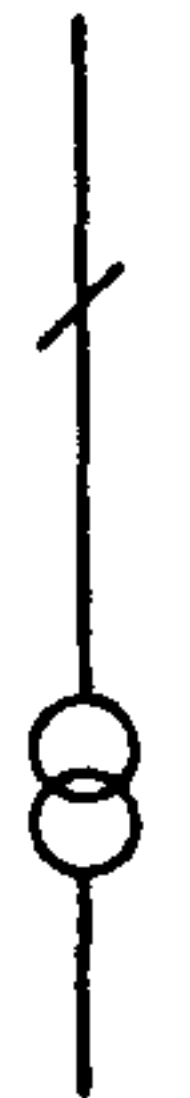
1. БЛОК (ЛИНИЯ-ТРАНСФОРМАТОР) С РАЗЪЕДИНИТЕЛЕМ 35-330 кВ
