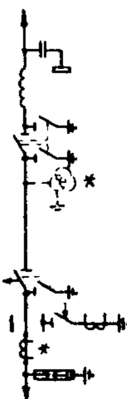
МОСТИК С ОТДЕЛИТЕЛЯМИ В ЦЕ- ПЯХ ТРАНСФОРМАТОРОВ И ДОПОЛ- НИТЕЛЬНОЙ ЛИНИЕЙ, ПРИСОЕДИ- НЕННОЙ ЧЕРЕЗ ДВА ВЫКЛЮЧАТЕЛЯ
