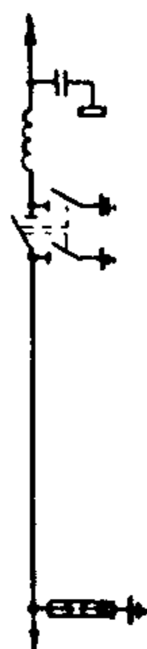
МОСТИК С ВЫКЛЮЧАТЕЛЕМ В ПЕРЕМЫЧКЕ И ОТДЕЛИТЕ- ЛЯМИ В ЦЕПЯХ ТРАНСФОР- МАТОРОВ
