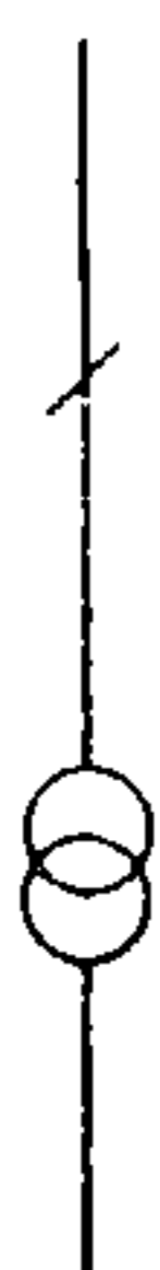
I. БЛОК (ЛИНИЯ-ТРАНСФОРМАТОР С РАЗЪЕДИНИТЕЛЕМ)
