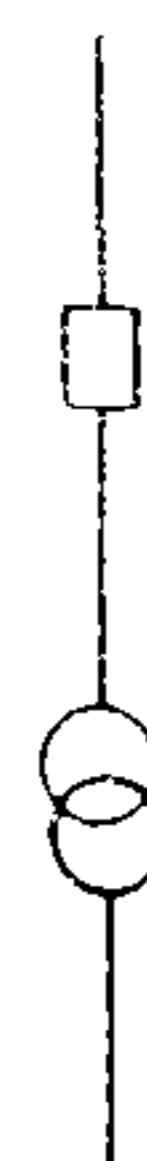
3Н. БЛОК (ЛИНИЯ-ТРАНСФОРМАТОР С ВЫКЛЮЧАТЕЛЕМ)
