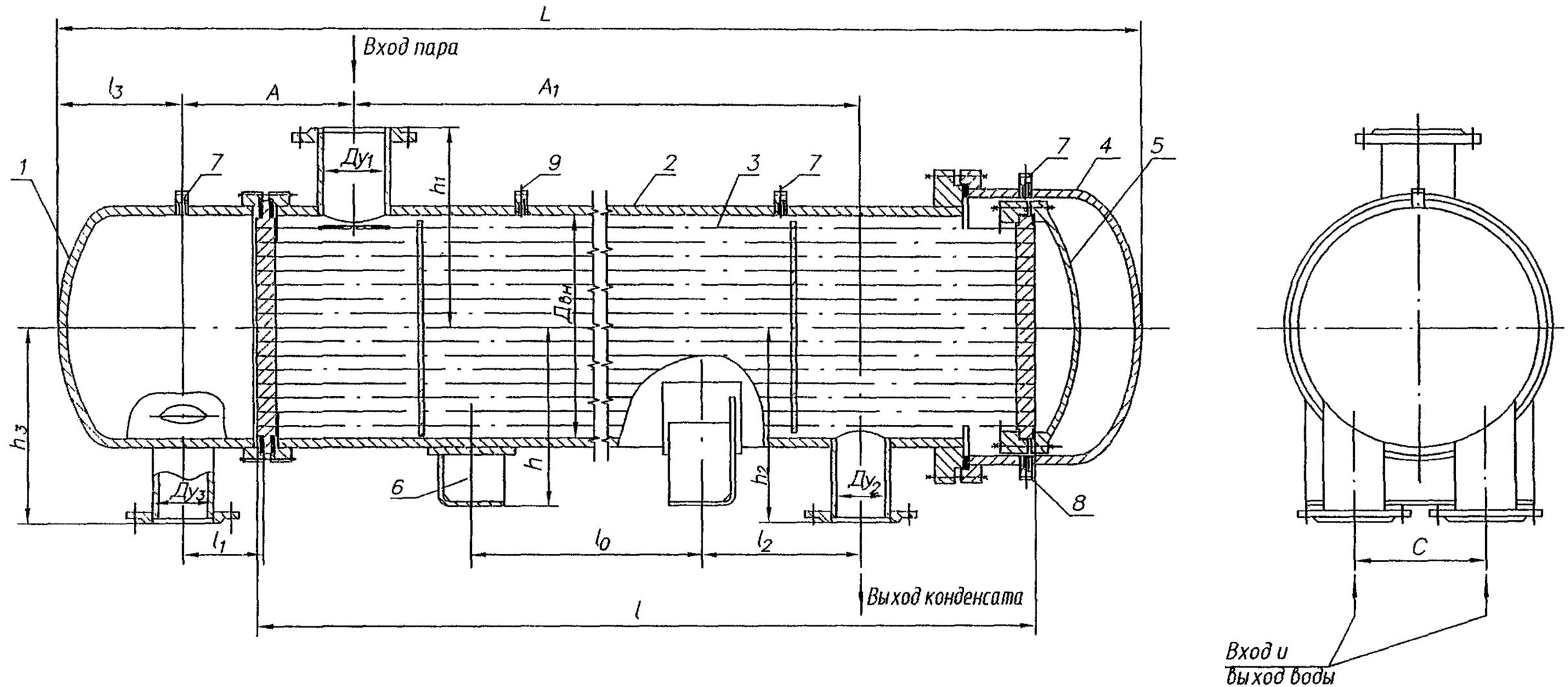
1 - камера распределительная, 2 - кожух, 3 - труба теплообменная, 4 - крышка кожуха, 5 - крышка плавающей головки, 6 - опора, 7 - воздушник Ду 15мм, 8 - дренаж Ду 15мм, 9 - для манометра Ду 10 мм
