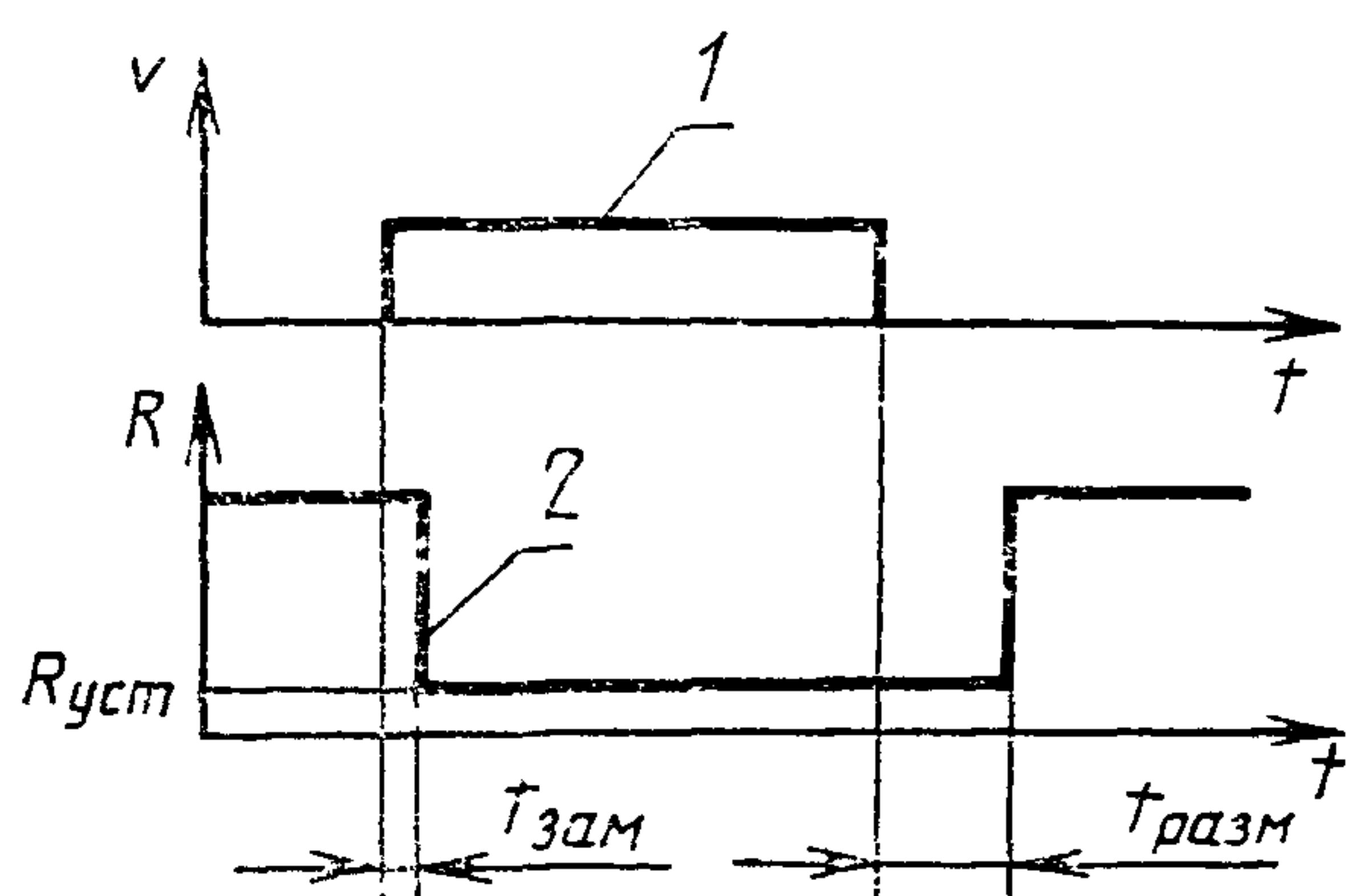
1—временная диаграмма управляющего импульса в измерительной катушке; 2—временная диаграмма сопротивления ртутного геркона при коммутации;  $R_{\text{уст}}$ —установившееся значение сопротивления ртутного геркона;  $t_{\text{зам}}$ —время замыкания;  $t_{\text{разм}}$ —время размыкания
