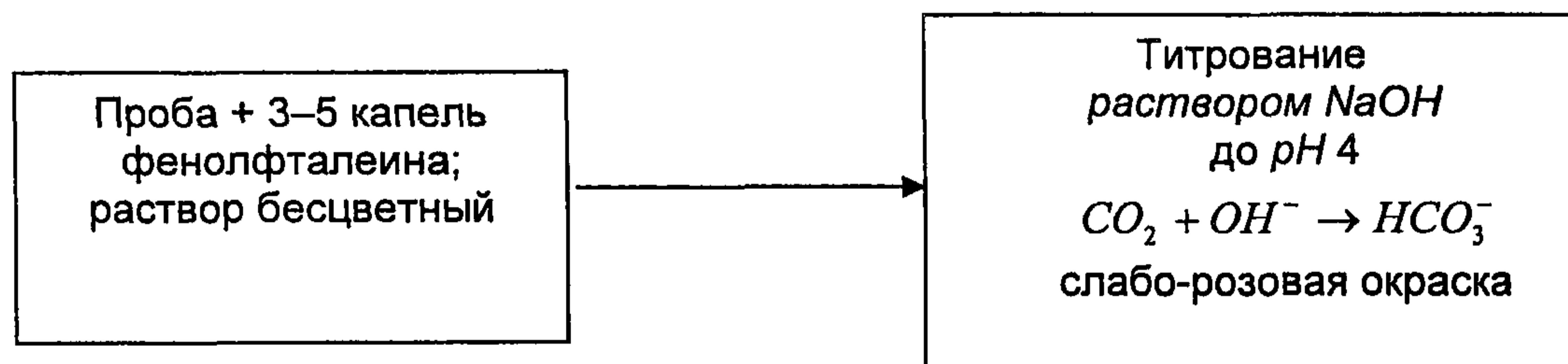
Рисунок 3 – Схема определения свободной угольной кислоты
