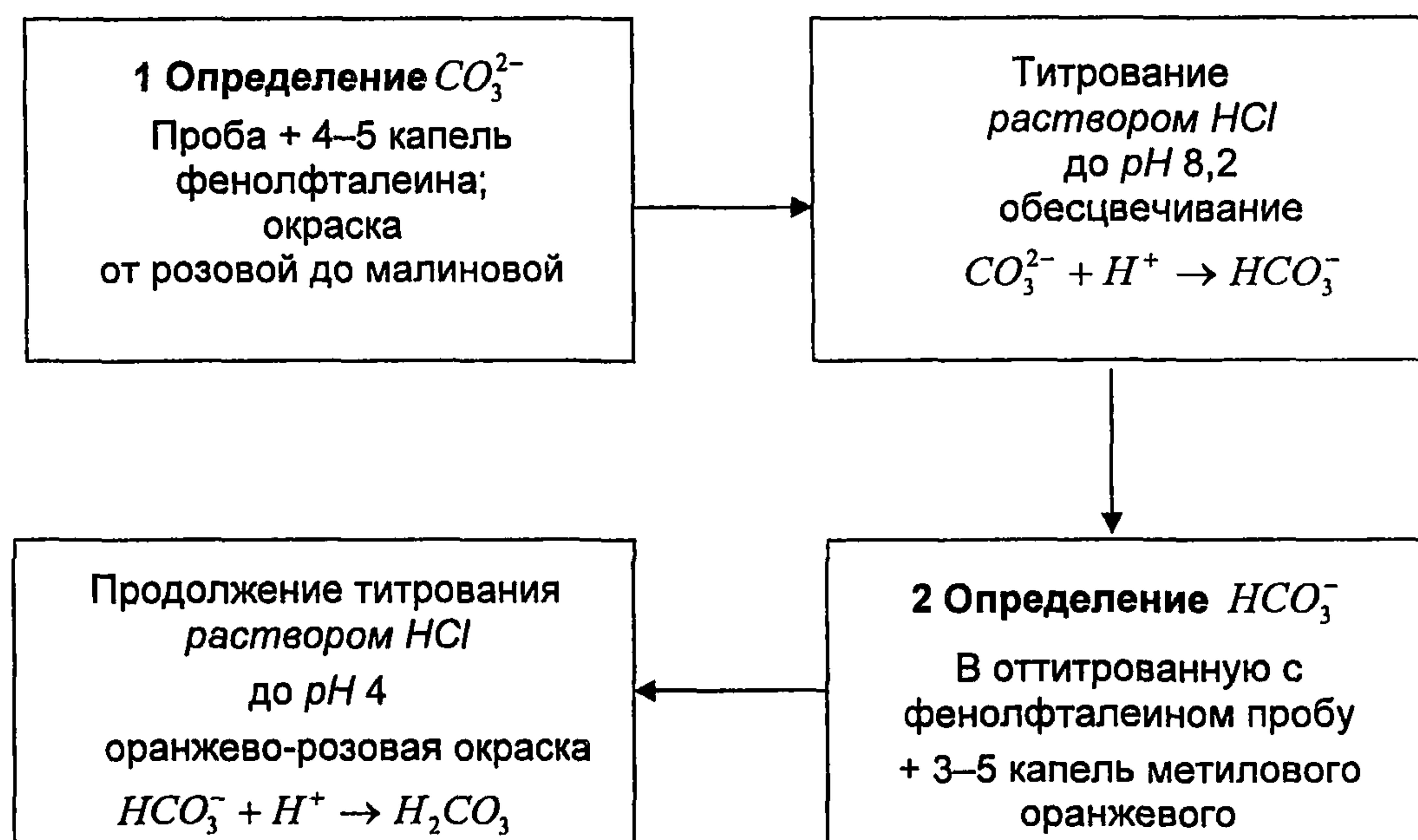
Рисунок 2 – Схема последовательного определения карбонат- и гидрокарбонат-ионов
