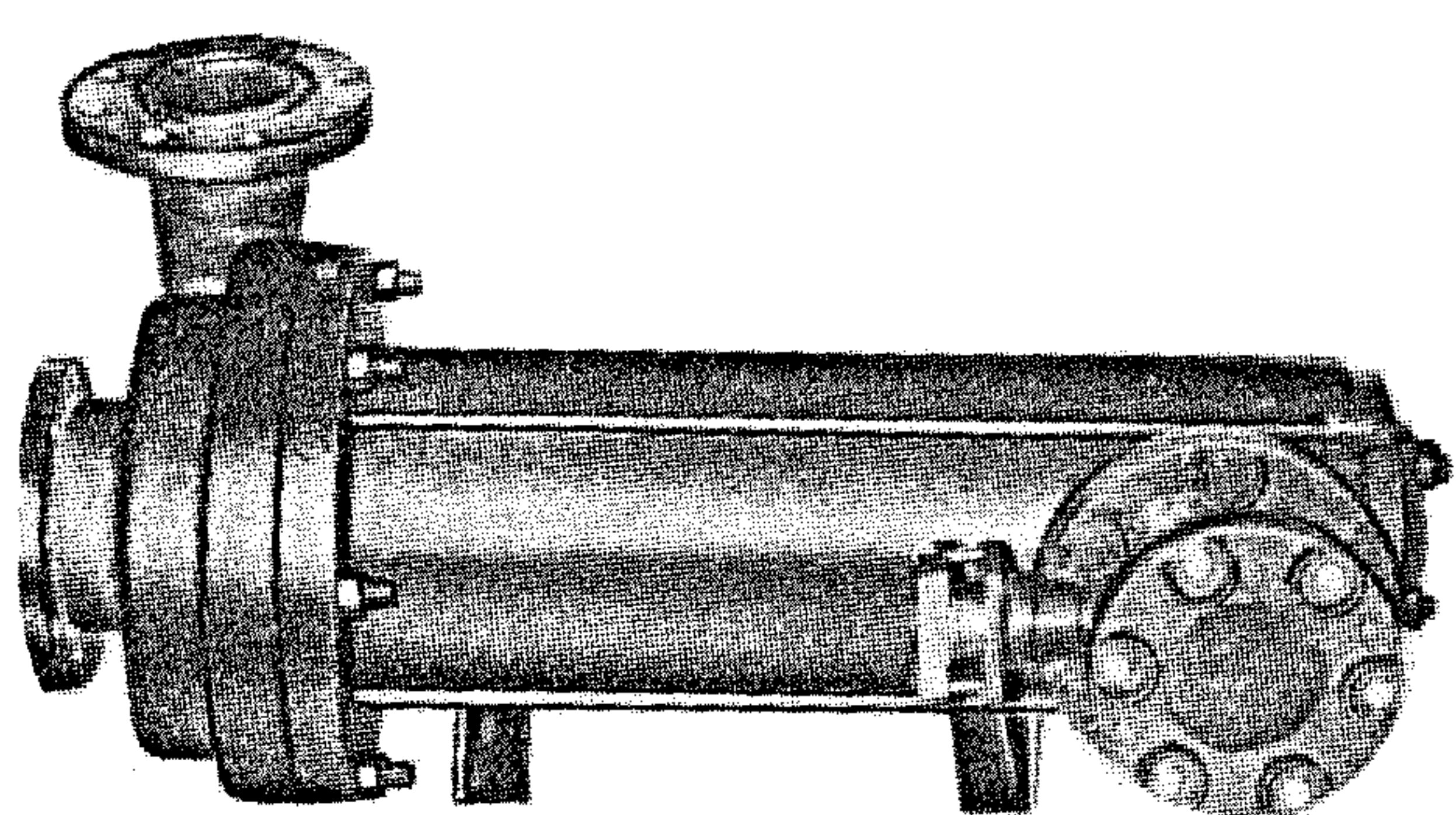
Предназначены для перекачивания в стационарных условиях агрессивных, токсичных и легковоспламеняющихся жидкостей температурой от  $-10$  до  $+50^{\circ}\text{C}$ , плотностью не более  $1100 \text{ кг}/\text{м}^3$ , массовой концентрацией твердых неабразивных включений до 20%, размером частиц не более 5 мм (из них 85% размером до 0,1 мм и 10% размером до 1 мм).
