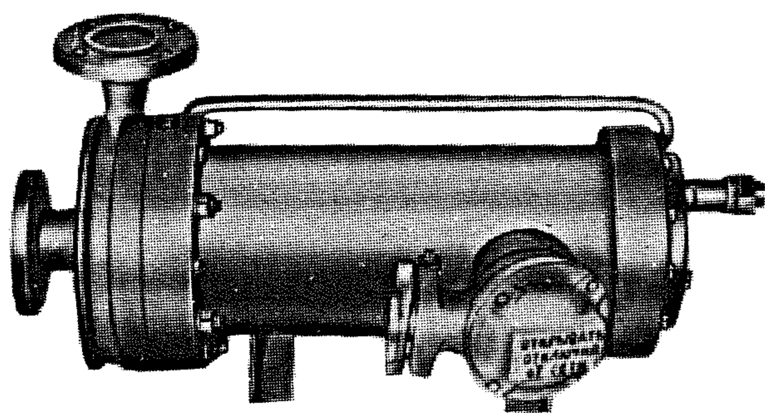
Предназначен для перекачивания в холодильных установках промысловых судов жидкого аммиака (ГОСТ 6221—75) температурой от  $-45$  до  $+25^{\circ}\text{C}$ , с примесью масла ХА-30 (ГОСТ 5546—66) не более 4% по объему, с наличием неабразивных включений массовой концентрацией не более 0,2%, размером частиц до 0,2 мм.
