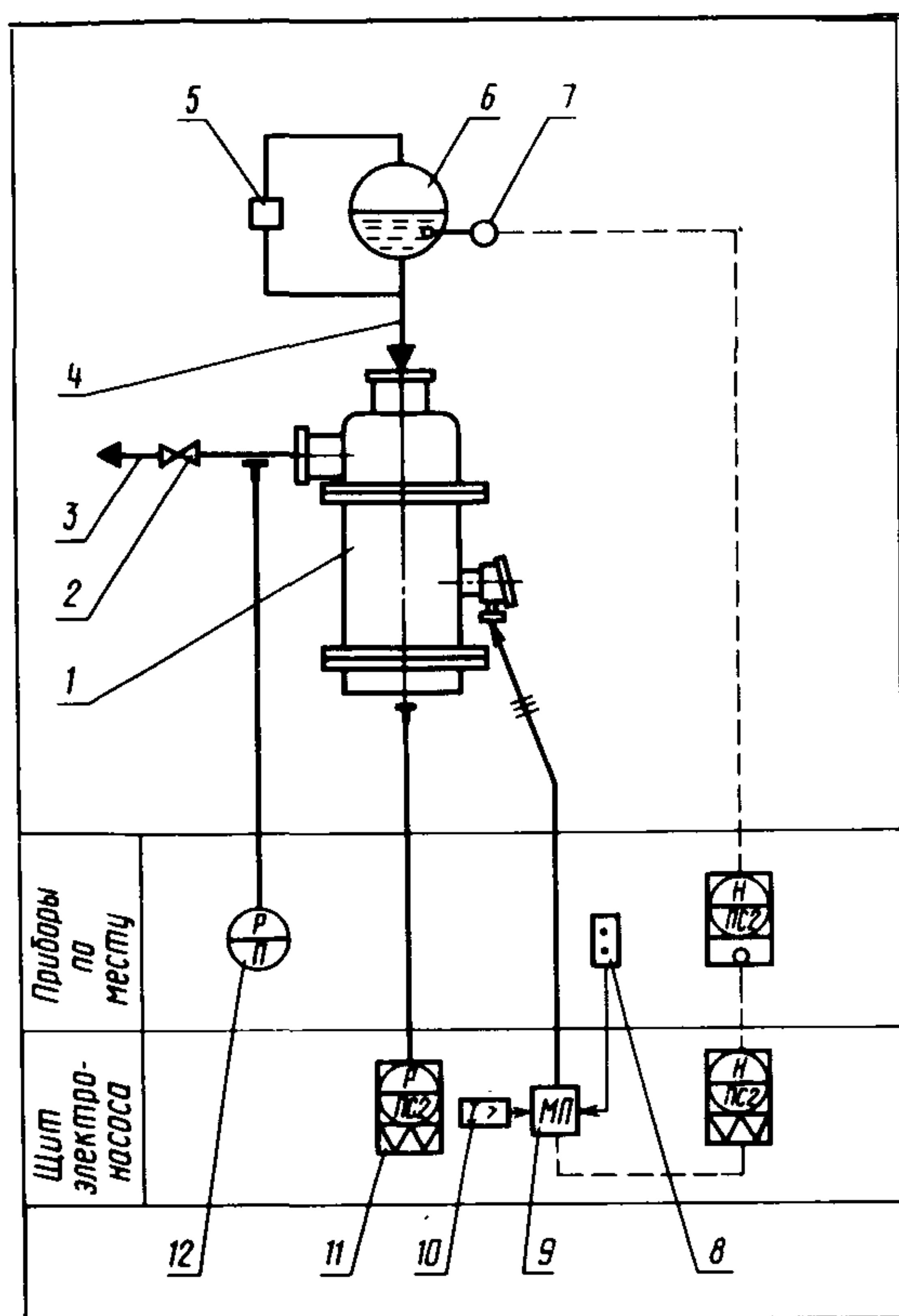
Общая схема автоматизации электронасосов типа БЭН-Ж:
