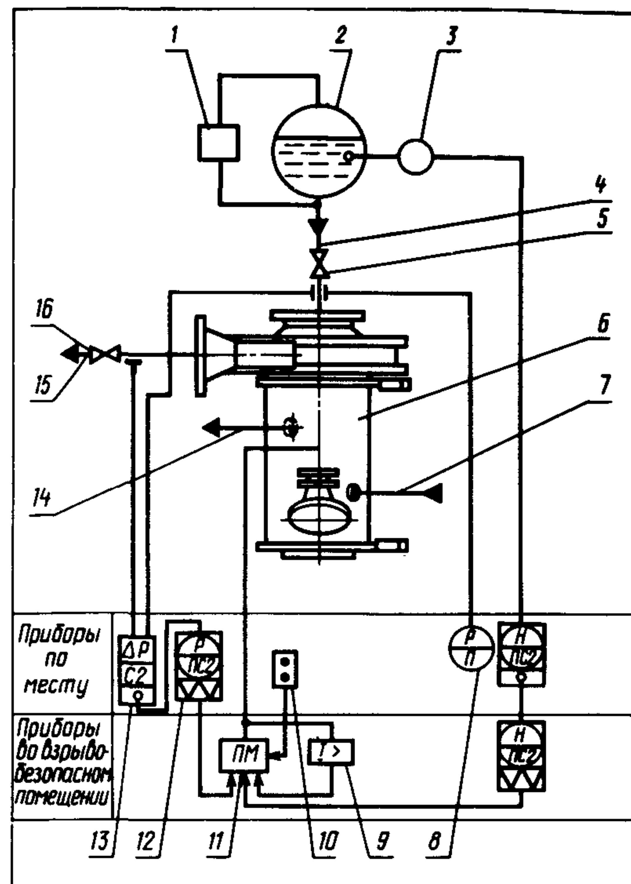
Общая схема автоматизации электронасосов типа 1БЭН:
