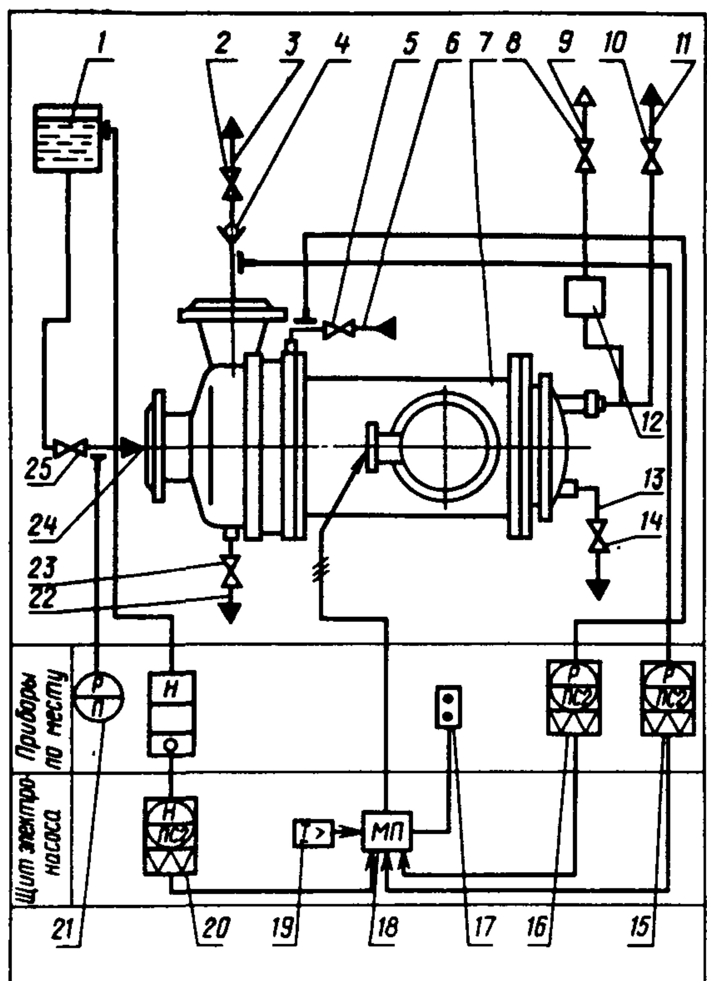
Общая схема автоматизации электронасоса:
