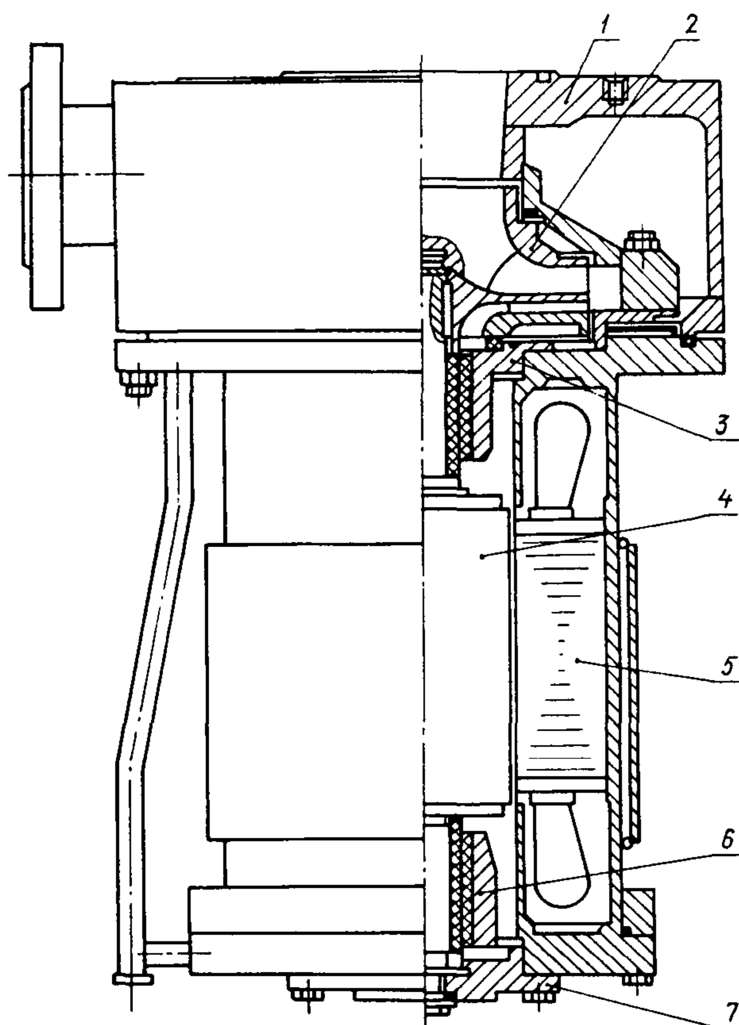
**Разрез электронасоса типа БЭН-Ж:**
