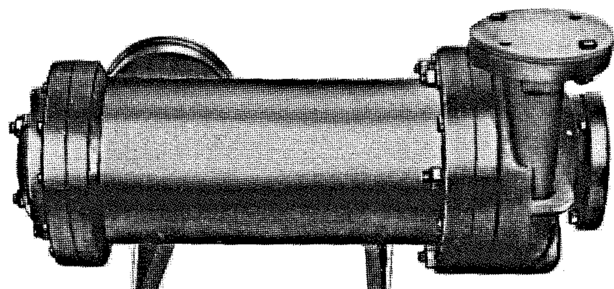
Предназначен для перекачивания в стационарных условиях агрессивных и легковоспламеняющихся жидкостей плотностью до  $1300 \text{ кг}/\text{м}^3$ , температурой от 0 до  $10^\circ\text{C}$ , содержащих твердые неабразивные включения массовой концентрацией до 15%, размером частиц не более 0,1 мм.
