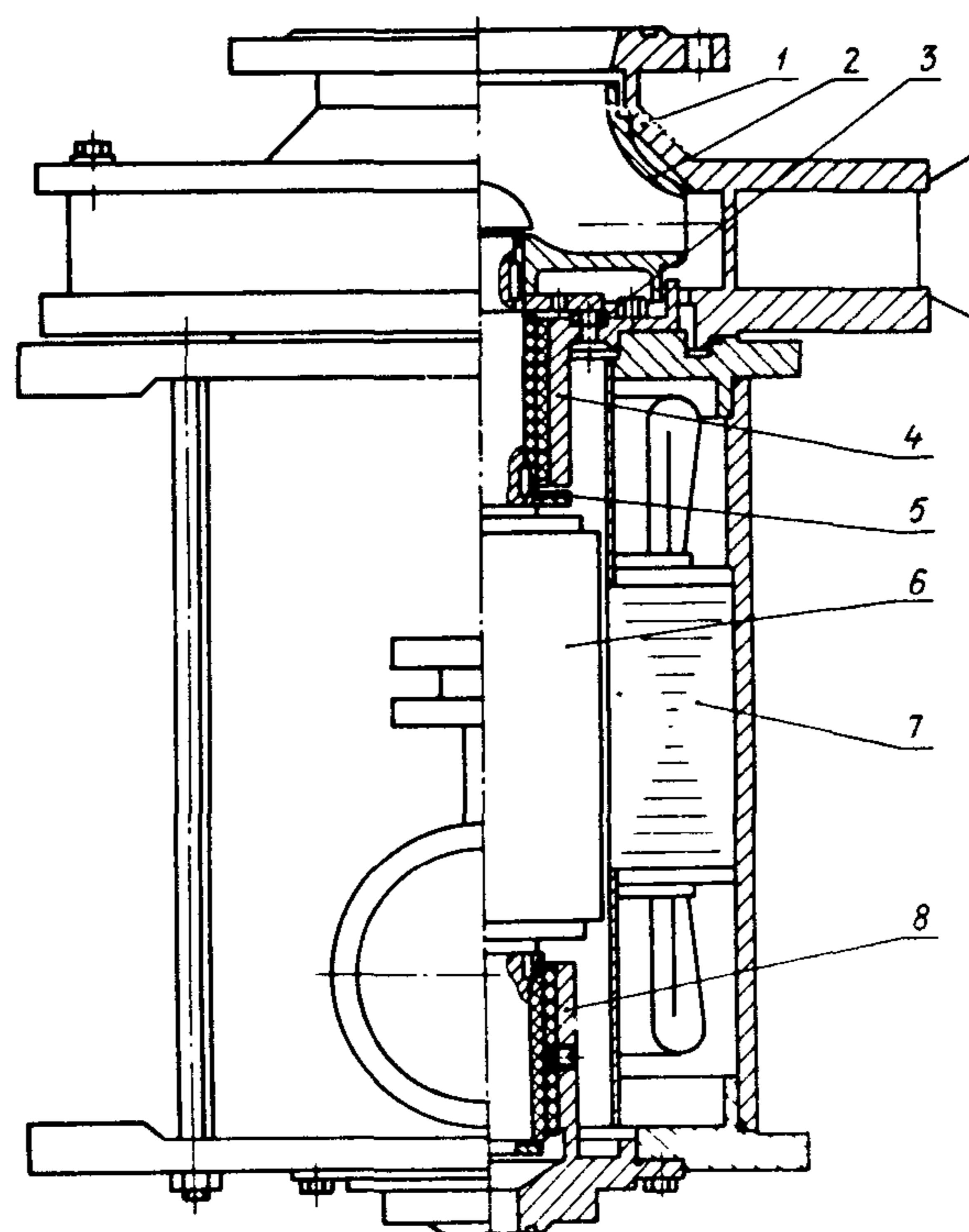
**Разрез электронасоса типа 1БЭН:**
