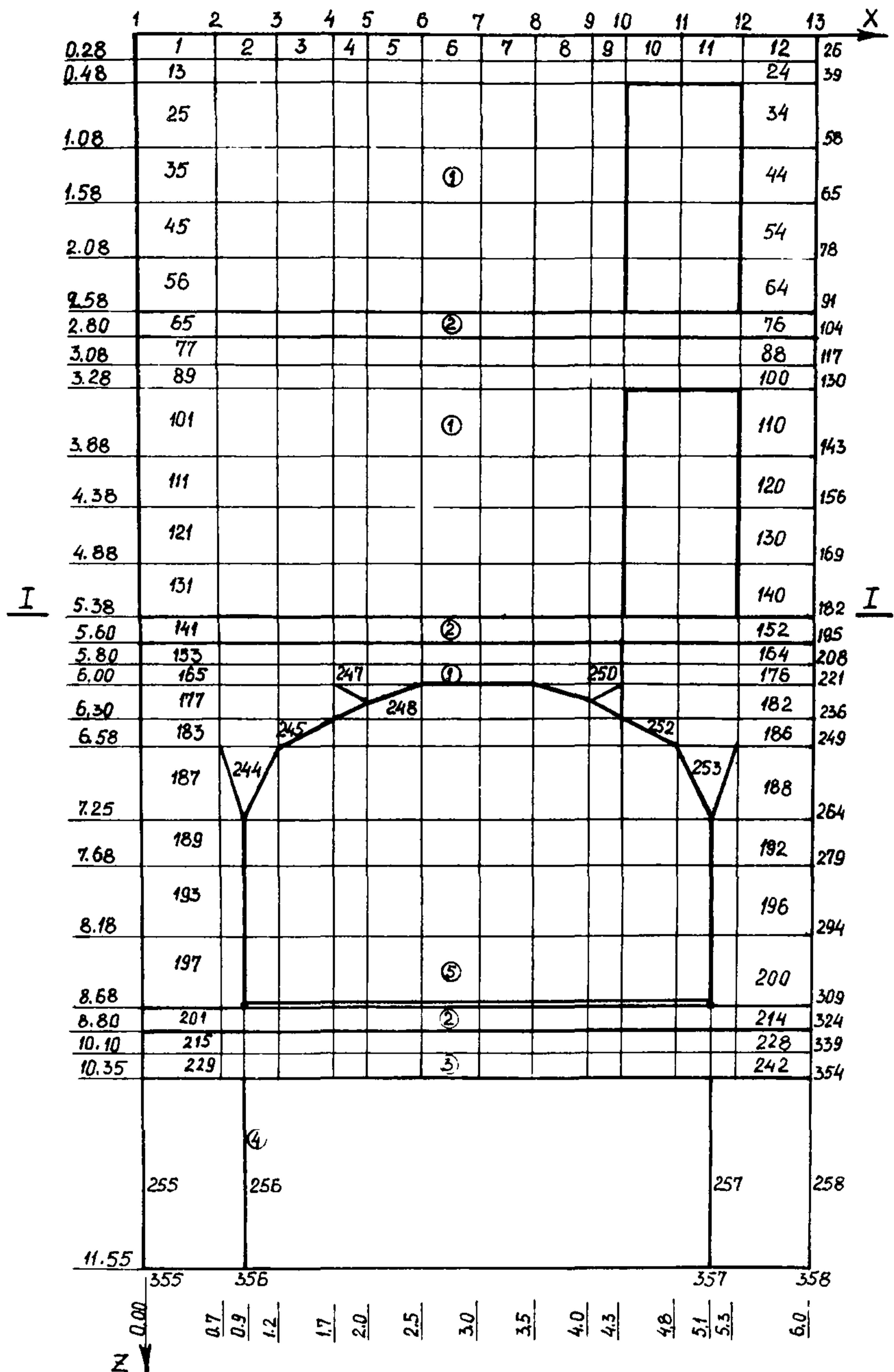
Рис. 3. Плоская расчетная схема диафрагмы МКЭ
