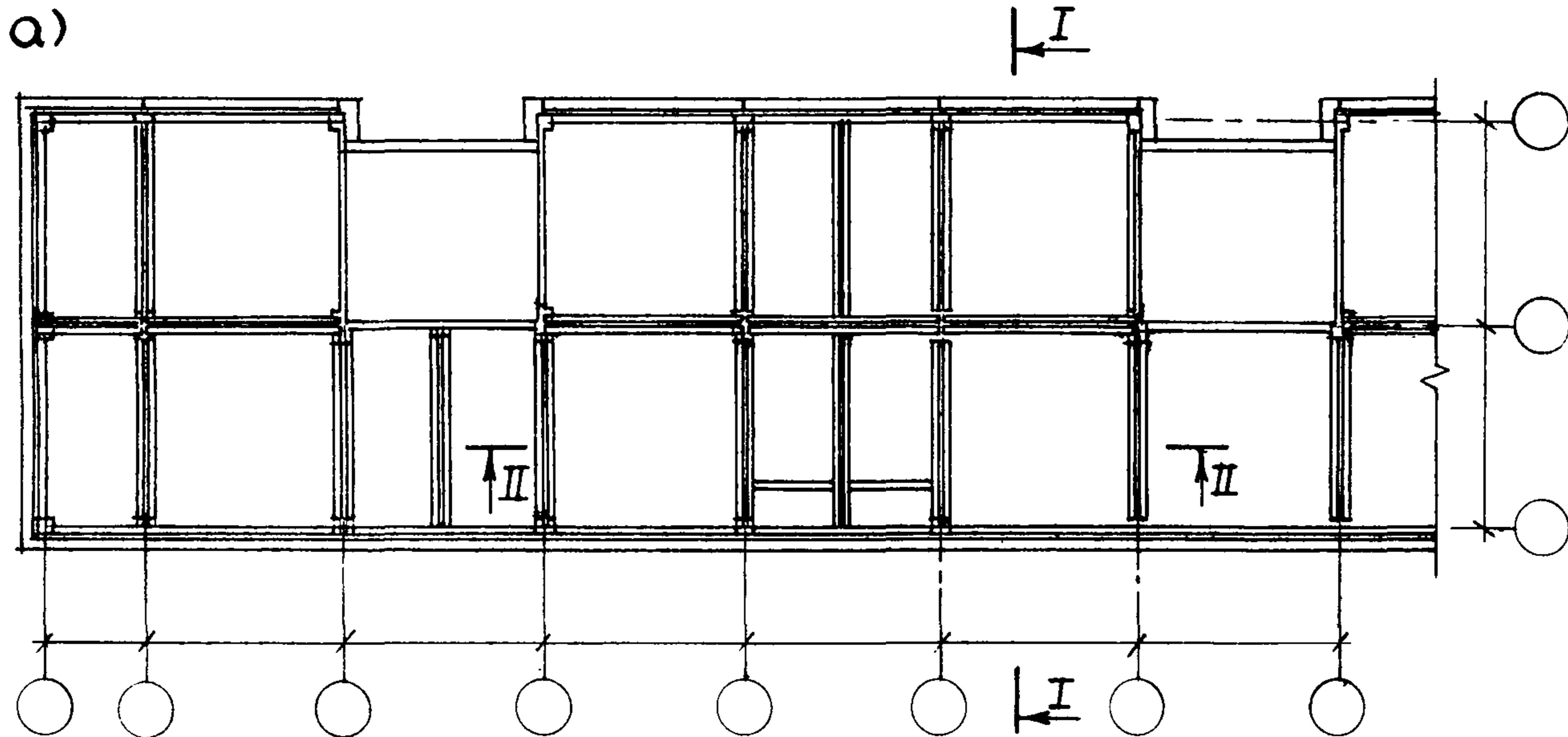
Рис. 11. Сборное каркасное решение здания со смешанным шагом колонн:
