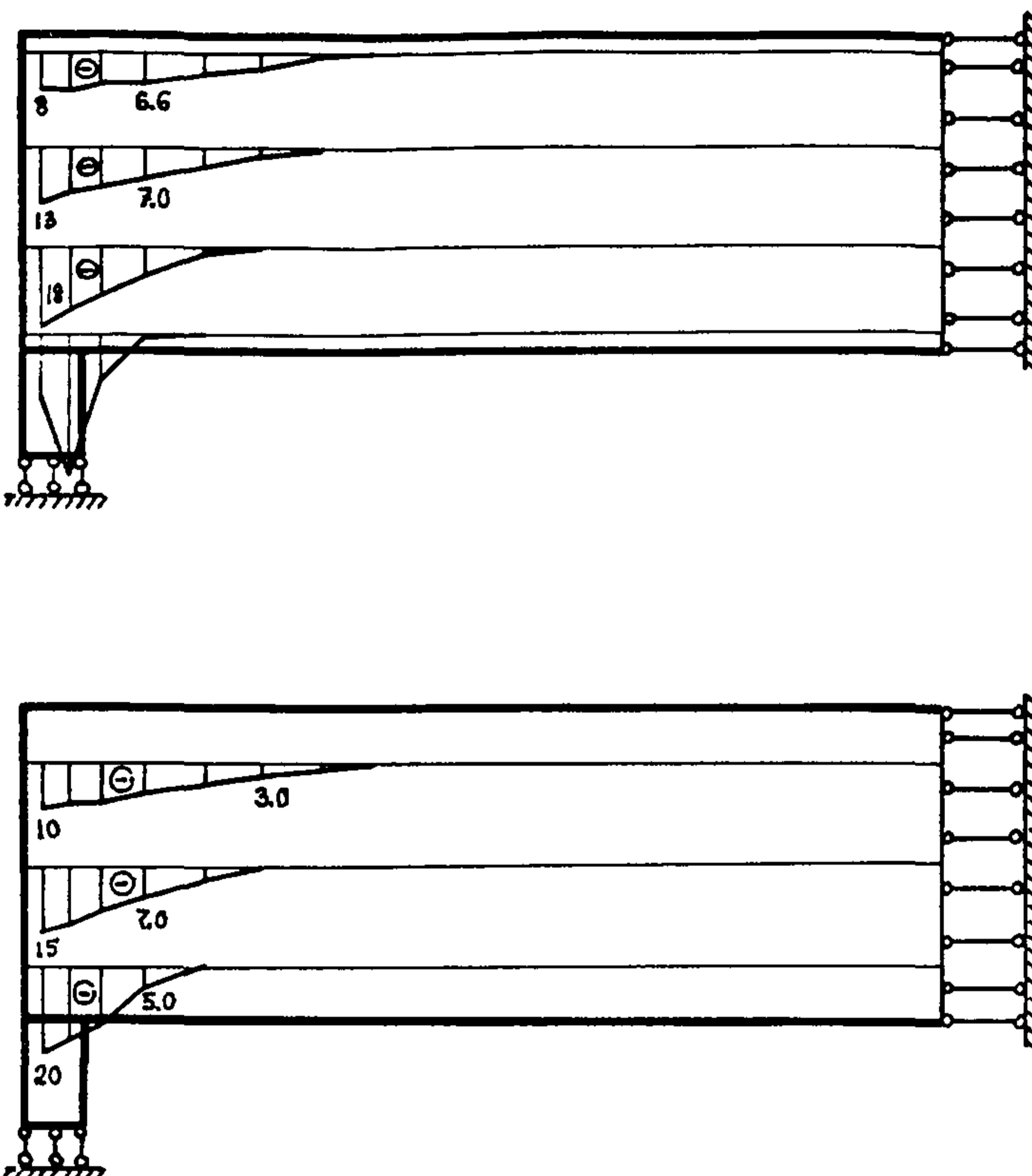
Рис. П.6. Эпюры нормальных напряжений  $\sigma_y$  на шаге перед разрушением ( $N = 4,44 \text{ МН}$ )
