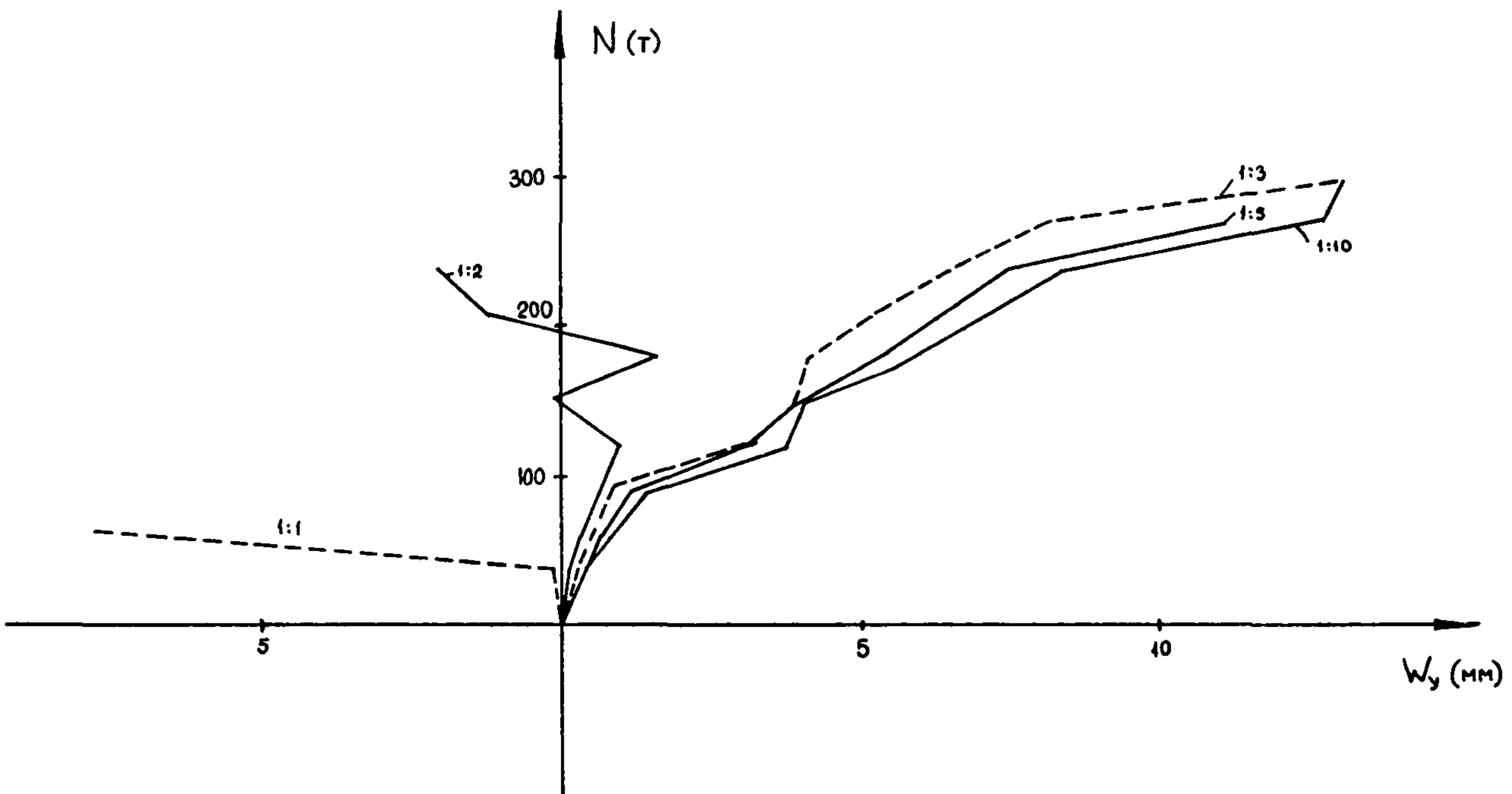
Рис. П.14. Графики максимальных прогибов для различных соотношений  $T/N$
