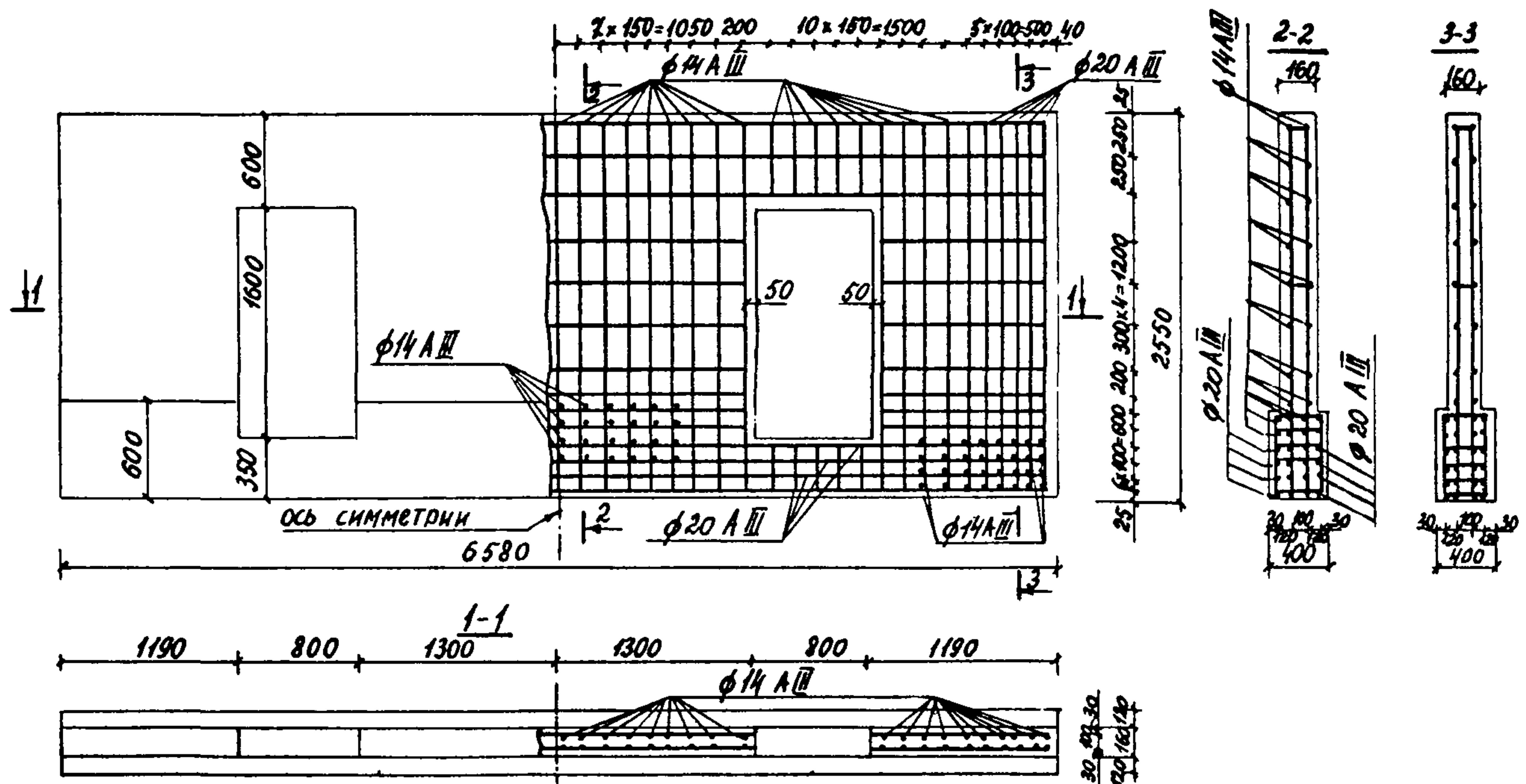
Рис. 18. Армирование главной балки-стенки при смешанном шаге колонн
