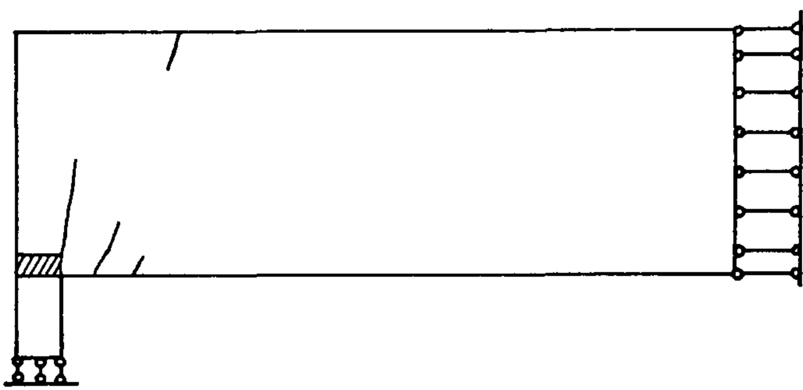
Рис. П.3. Схема трещинообразования и разрушения ригеля
