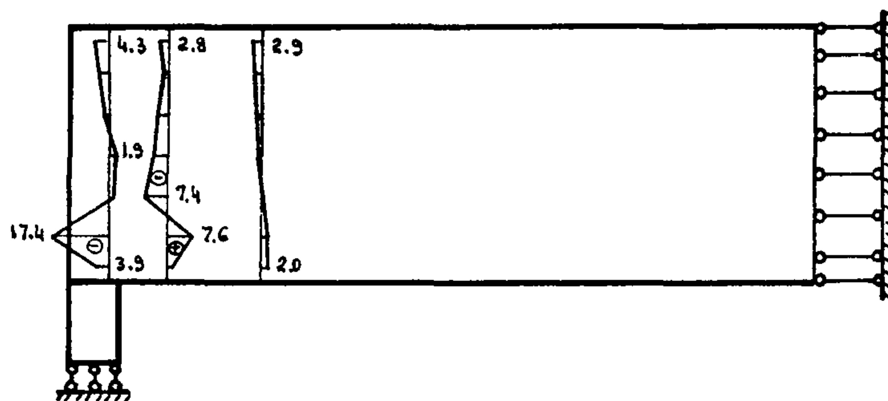
Рис. П.13. Эпюры касательных напряжений  $\tau_{xy}$  на шаге перед разрушением ( $N = 4,44 \text{ МН}$  и  $T = 1,11 \text{ МН}$ )
