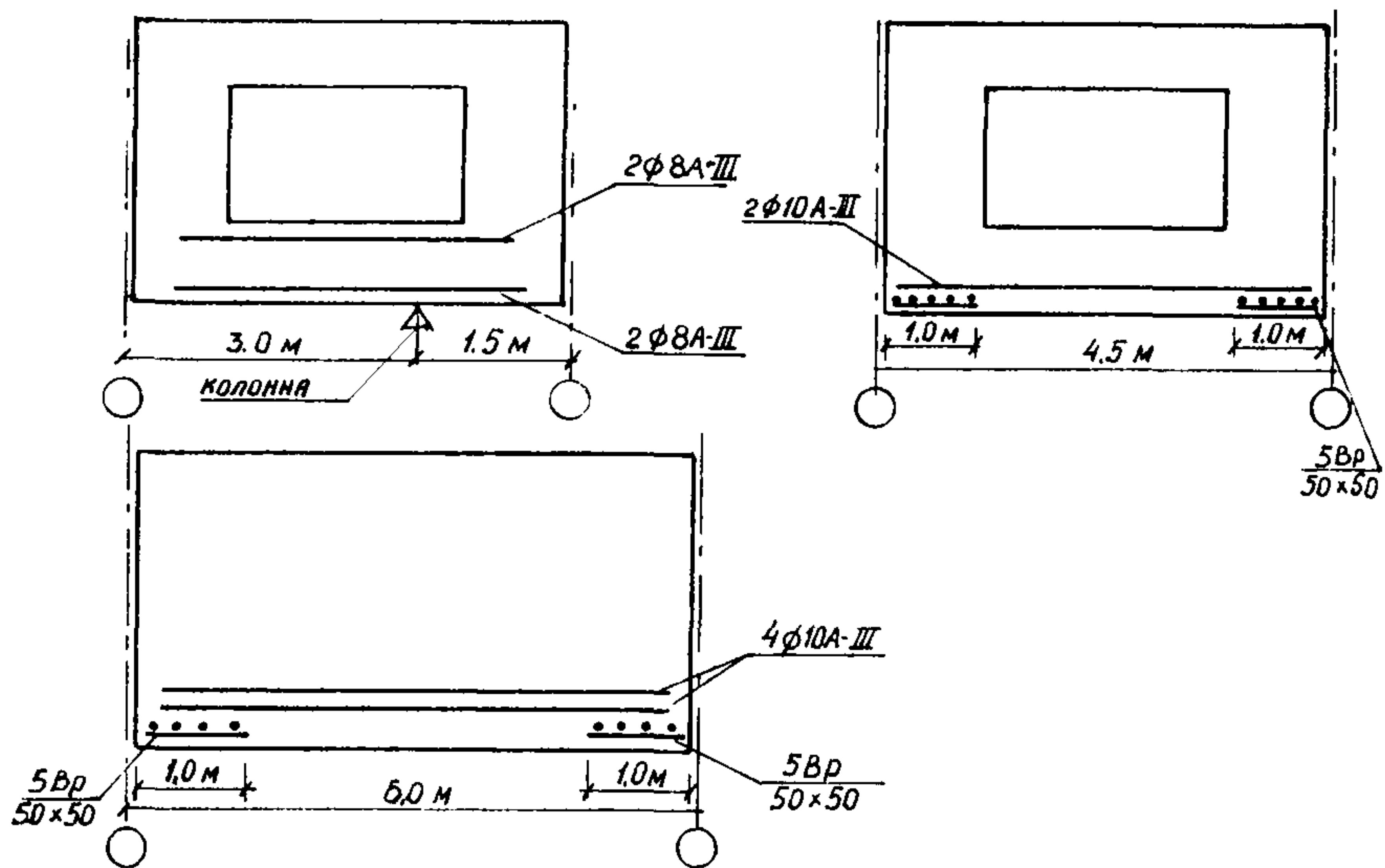
Рис. 19. Армирование внутренних стеновых панелей (а) и наружных стен (б) первого жилого этажа
