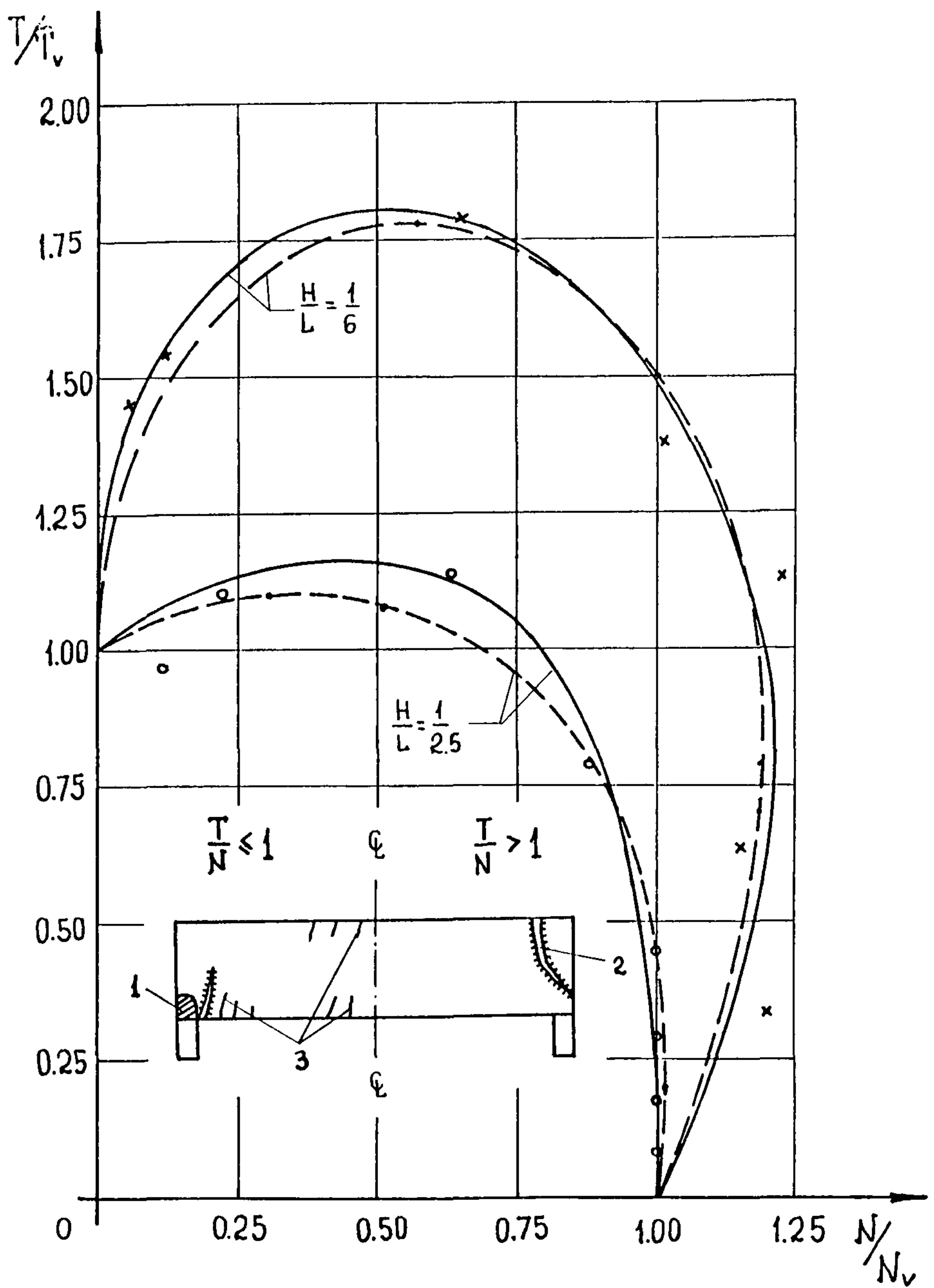
Рис. 16. График зависимости  $T$  от  $N$  при  $H/L = 1/6$  и  $H/L = 1/2.5$
