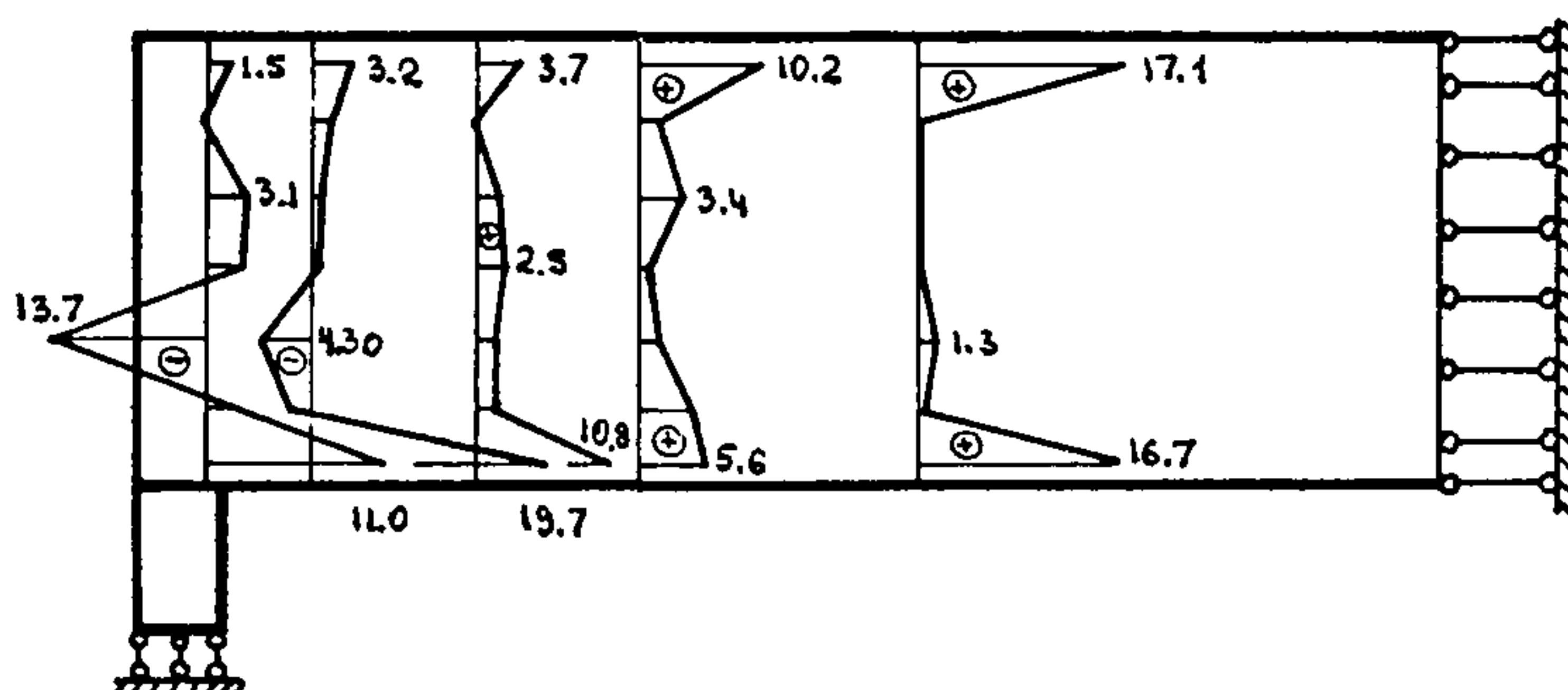
Рис. П.12. Эпюры нормальных напряжений  $\sigma_x$  на шаге перед разрушением ( $N = 4,44 \text{ МН}$  и  $T = 1,11 \text{ МН}$ )
