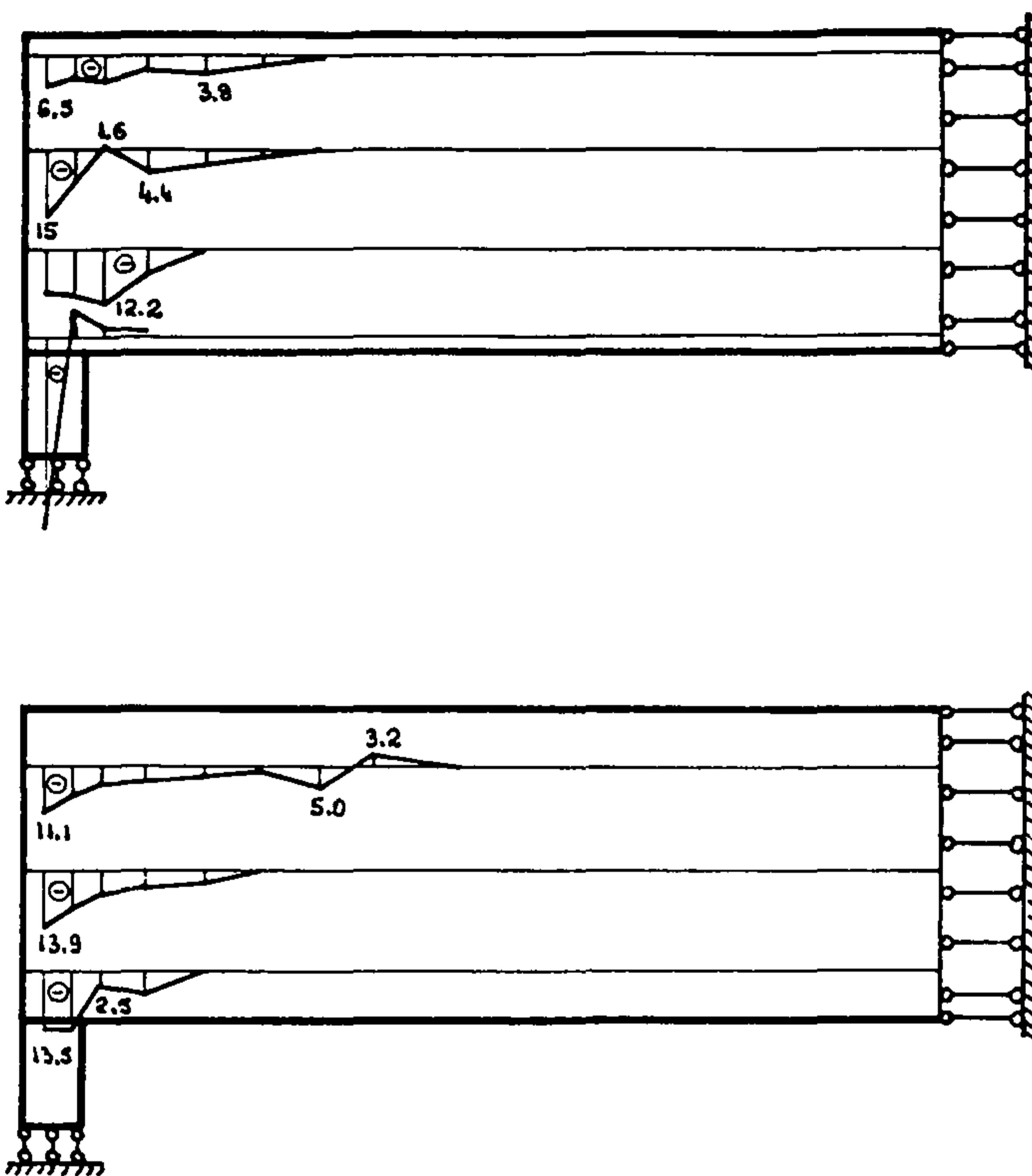
Рис.П.11. Эпюры нормальных напряжений  $\sigma_y$  на шаге перед разрушением ( $N = 4,44 \text{ МН}$  и  $T = 1,11 \text{ МН}$ )
