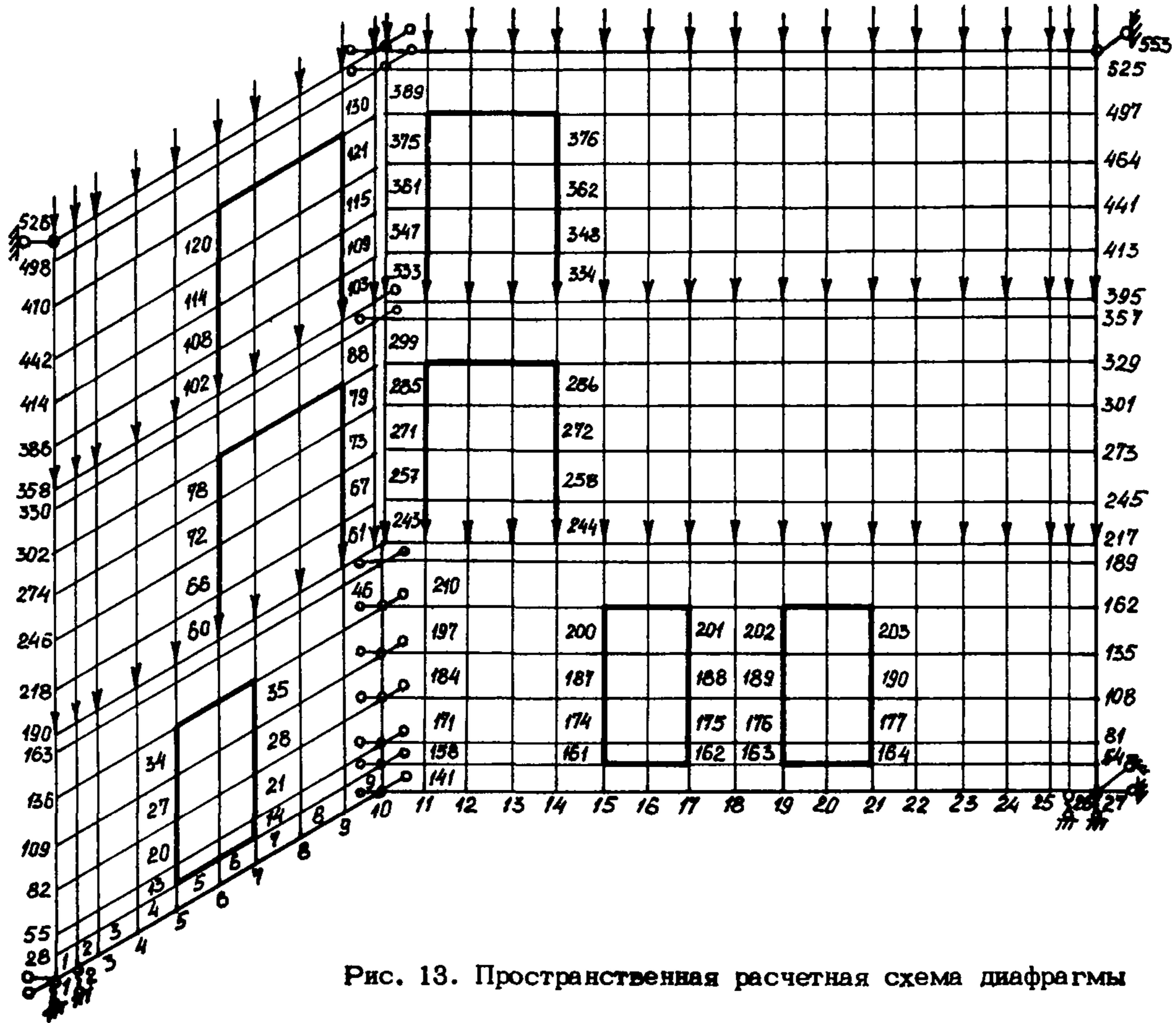
Рис. 13. Пространственная расчетная схема диафрагмы
