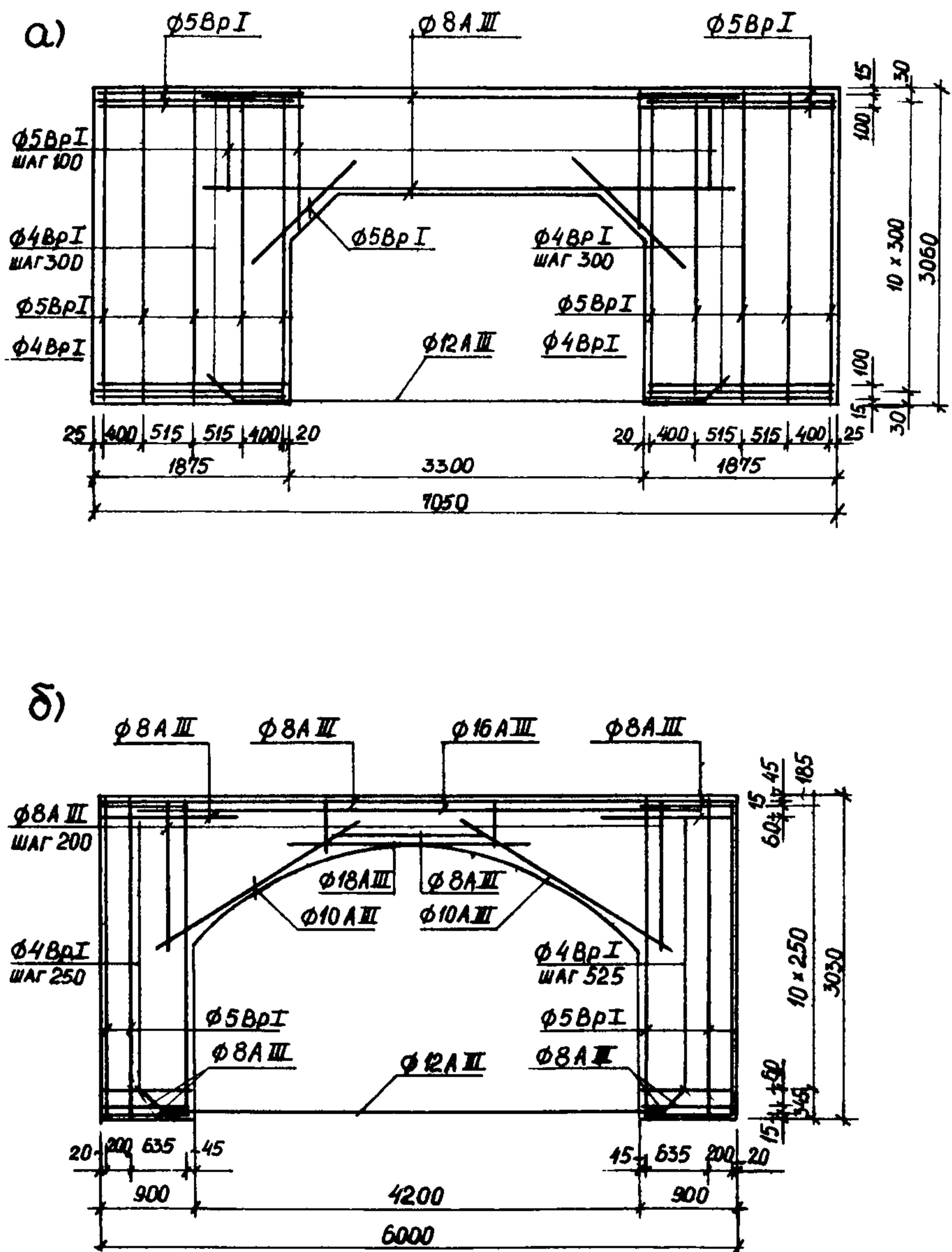
Рис. 8. Армирование панели 1-го этажа:
