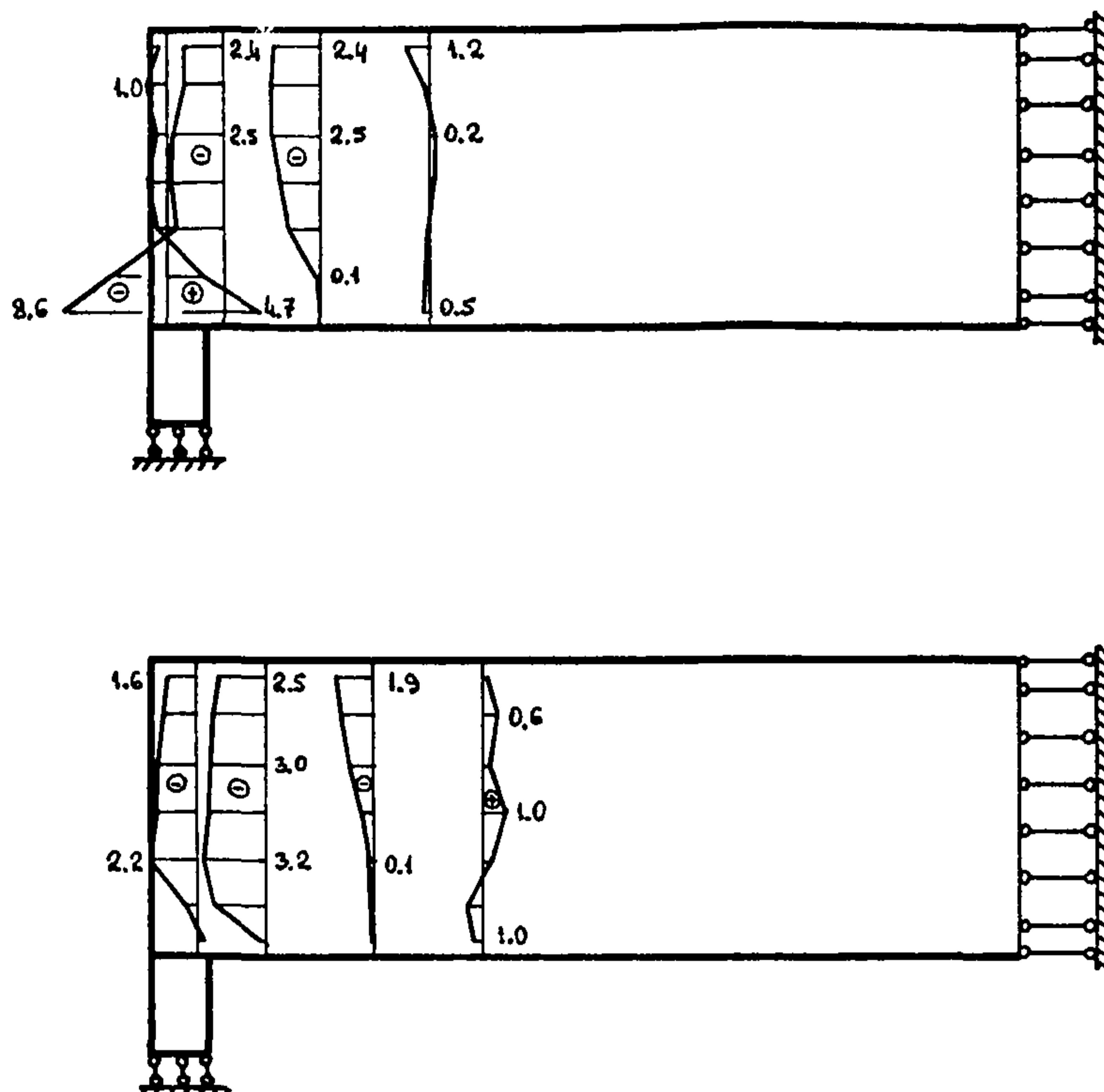
Рис. П.7. Эпюры касательных напряжений  $T_{xy}$  на шаге перед разрушением ( $N = 4,44 \text{ МН}$ )
