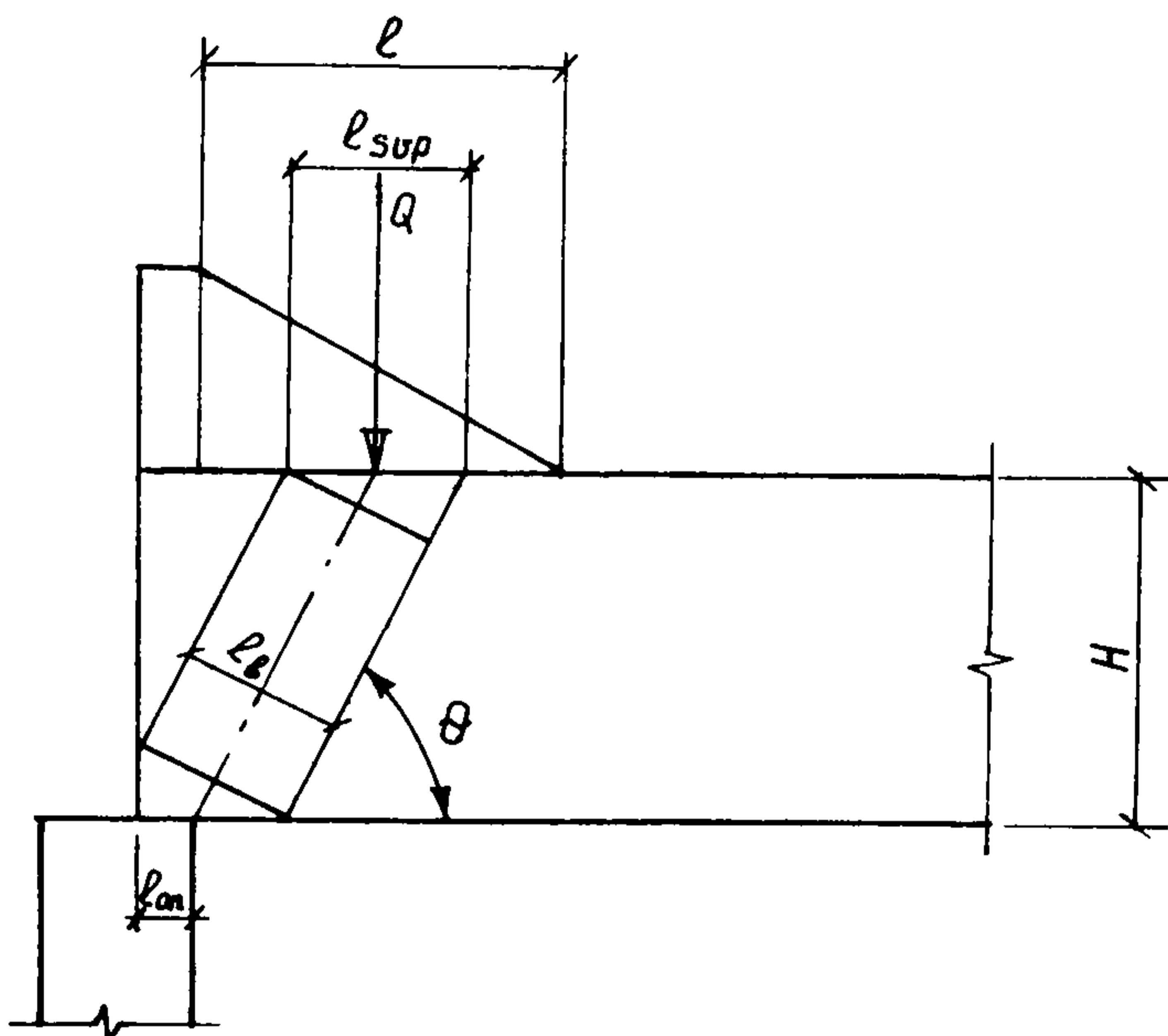
Рис. 14. Расчетная модель для приближенного метода расчета
