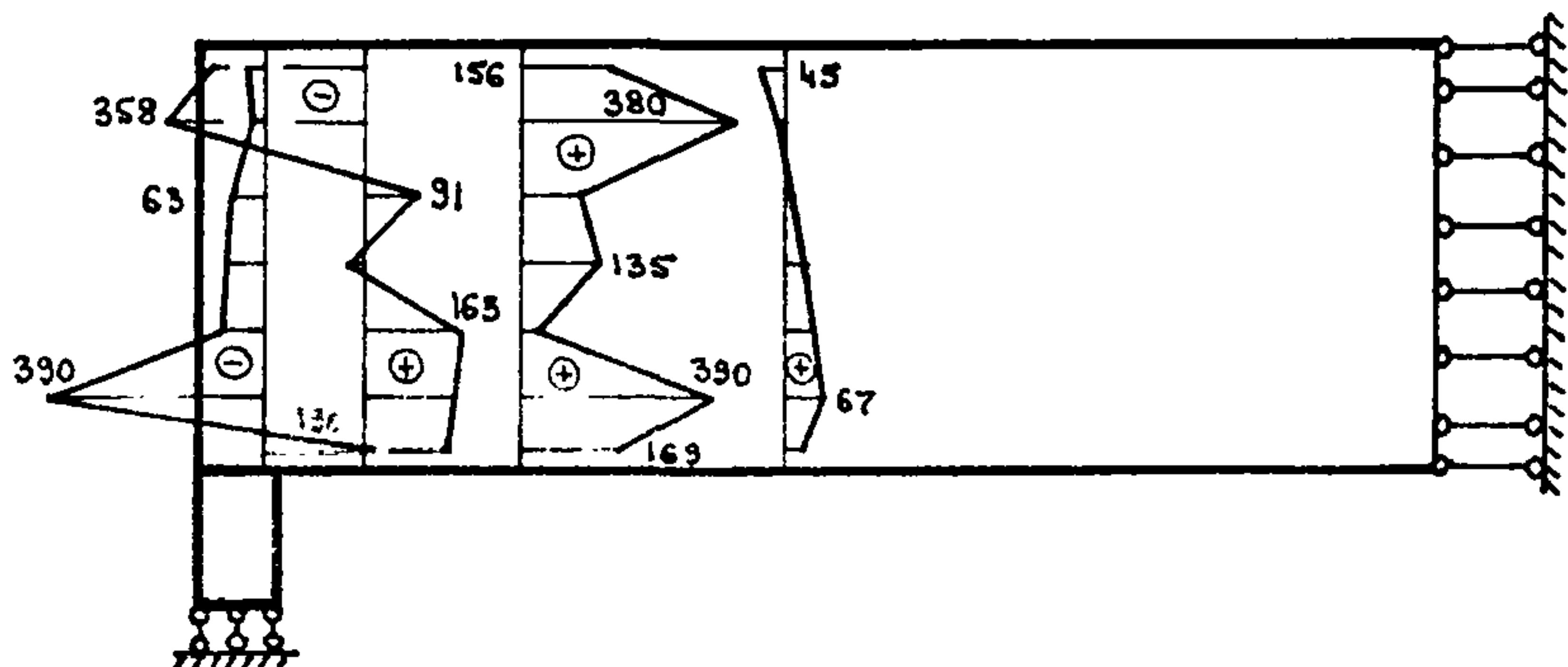
Рис. П.10. Эпюры напряжений  $\sigma_{sy}$  в вертикальной арматуре (хомутах) на шаге перед разрушением ( $N = 4,44 \text{ МН}$  и  $T = 1,11 \text{ МН}$ )
