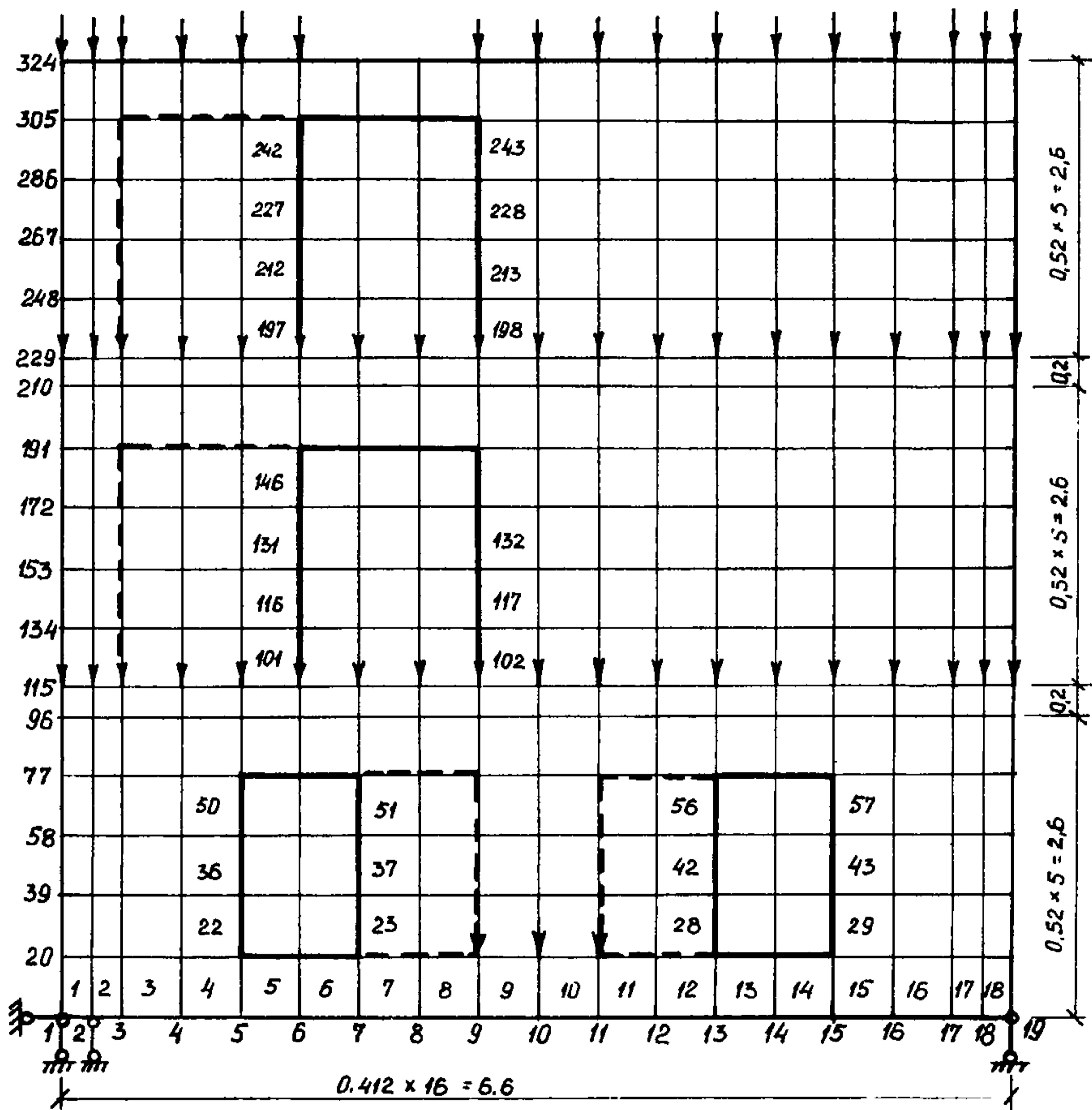
Рис. 12. Плоская расчетная схема диафрагмы
