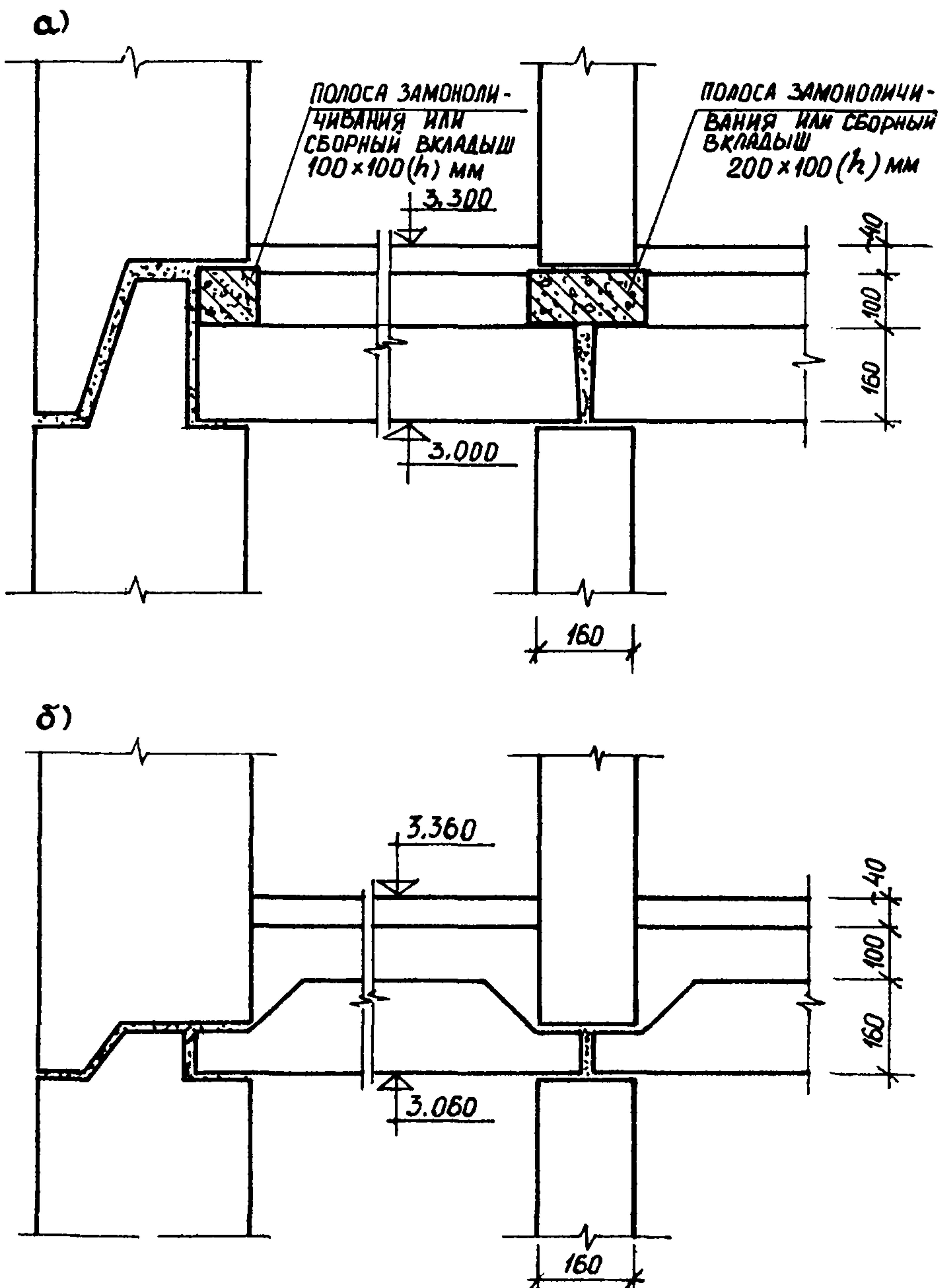
Рис. 2. Узлы сопряжений перекрытий, обладающих повышенной звукоизоляцией, с внутренними и наружными стенами:
