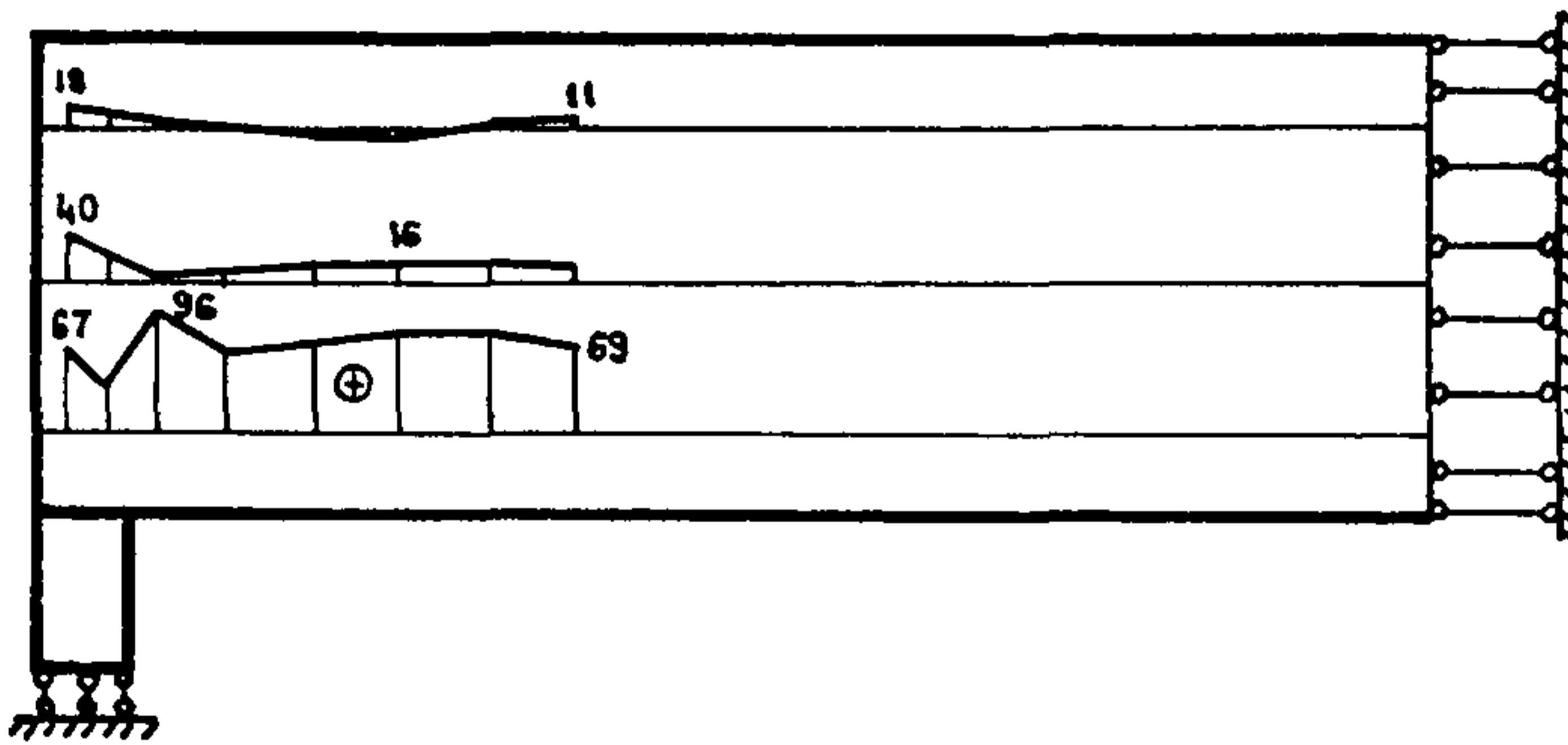
Рис. П.4. Эпюры растягивающих напряжений  $\sigma_{sx}$  в горизонтальной арматуре на шаге перед разрушением ( $N = 4,44 \text{ МН}$ )
