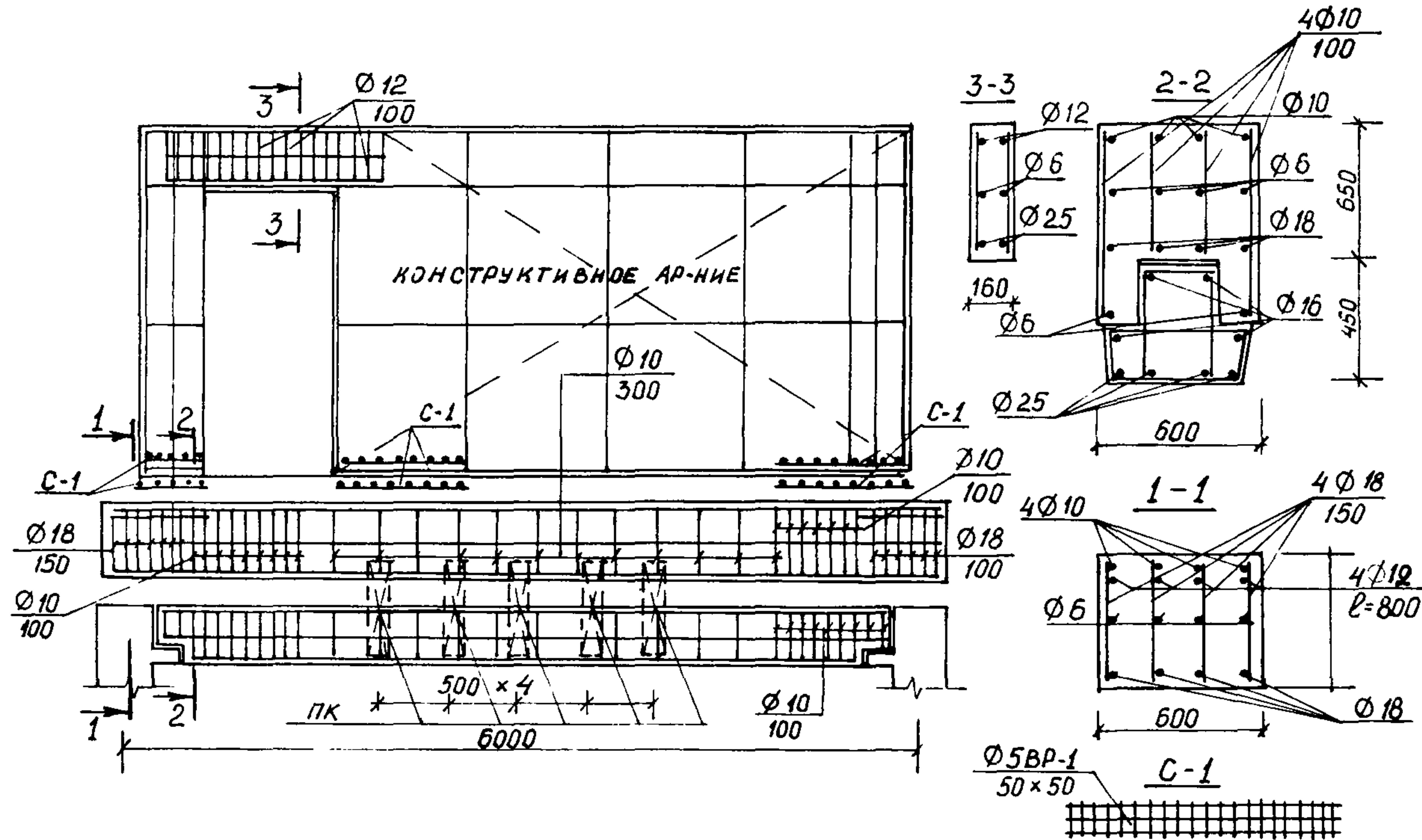
Рис. 15. Армирование балок и стен при малом шаге колонн
