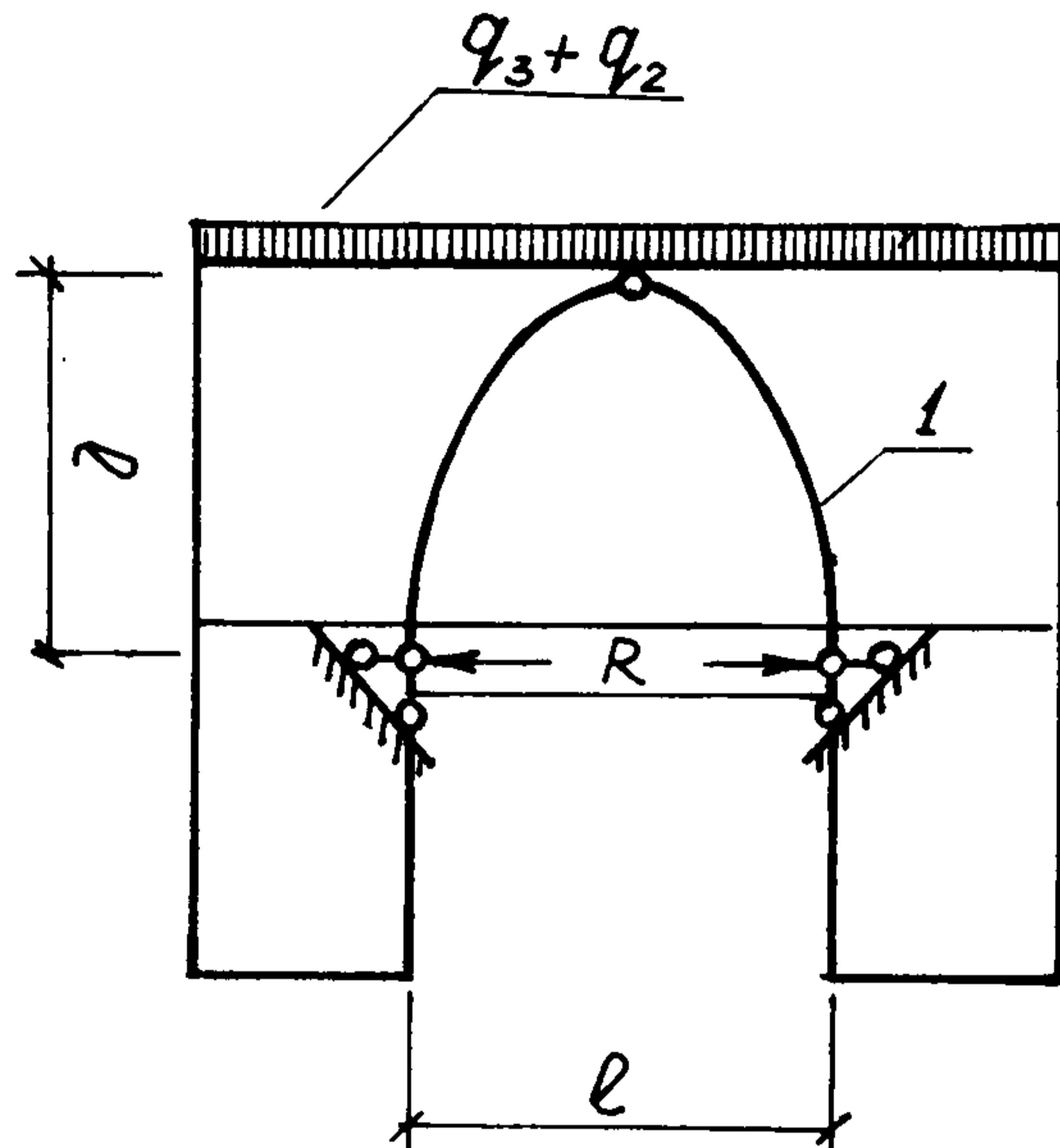
Рис. 5. Условная арка для определения расстояния в перемычке панели 1-го нежилого этажа
