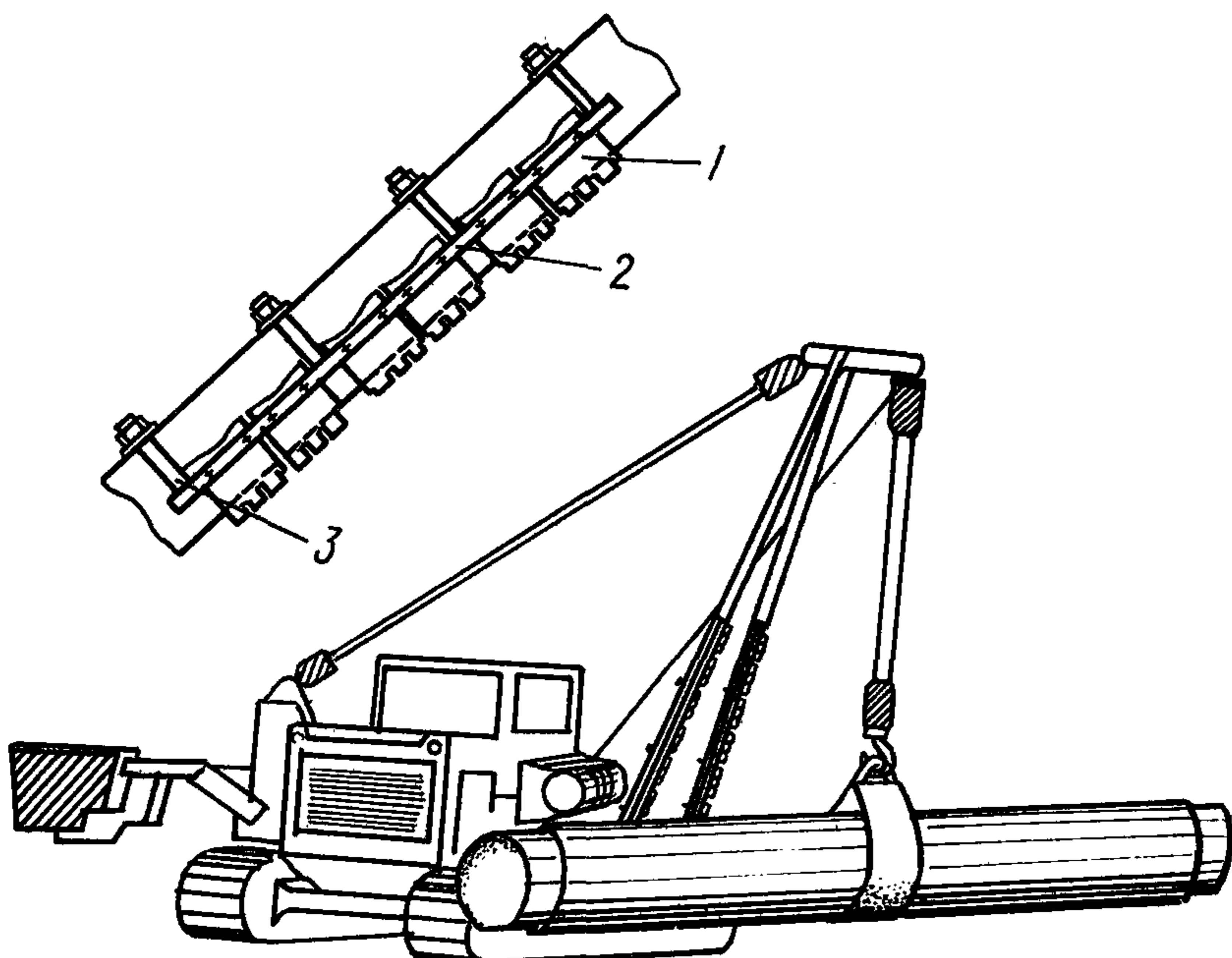
Рис. I9. Схема облицовки стрелы крана-трубоукладчика:
