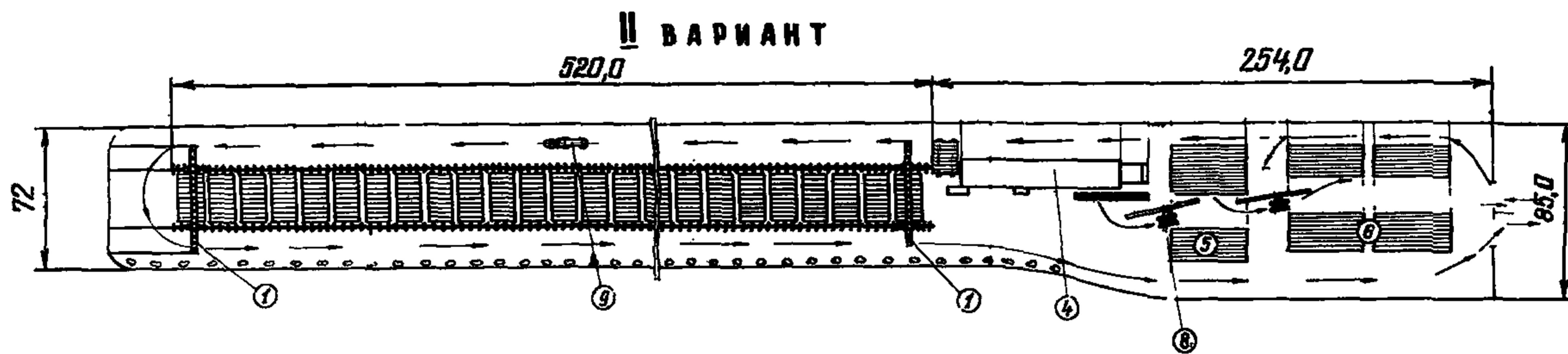
Рис.9. Схема организации складирования базисного высокорядного склада при трубосварочной базе:
