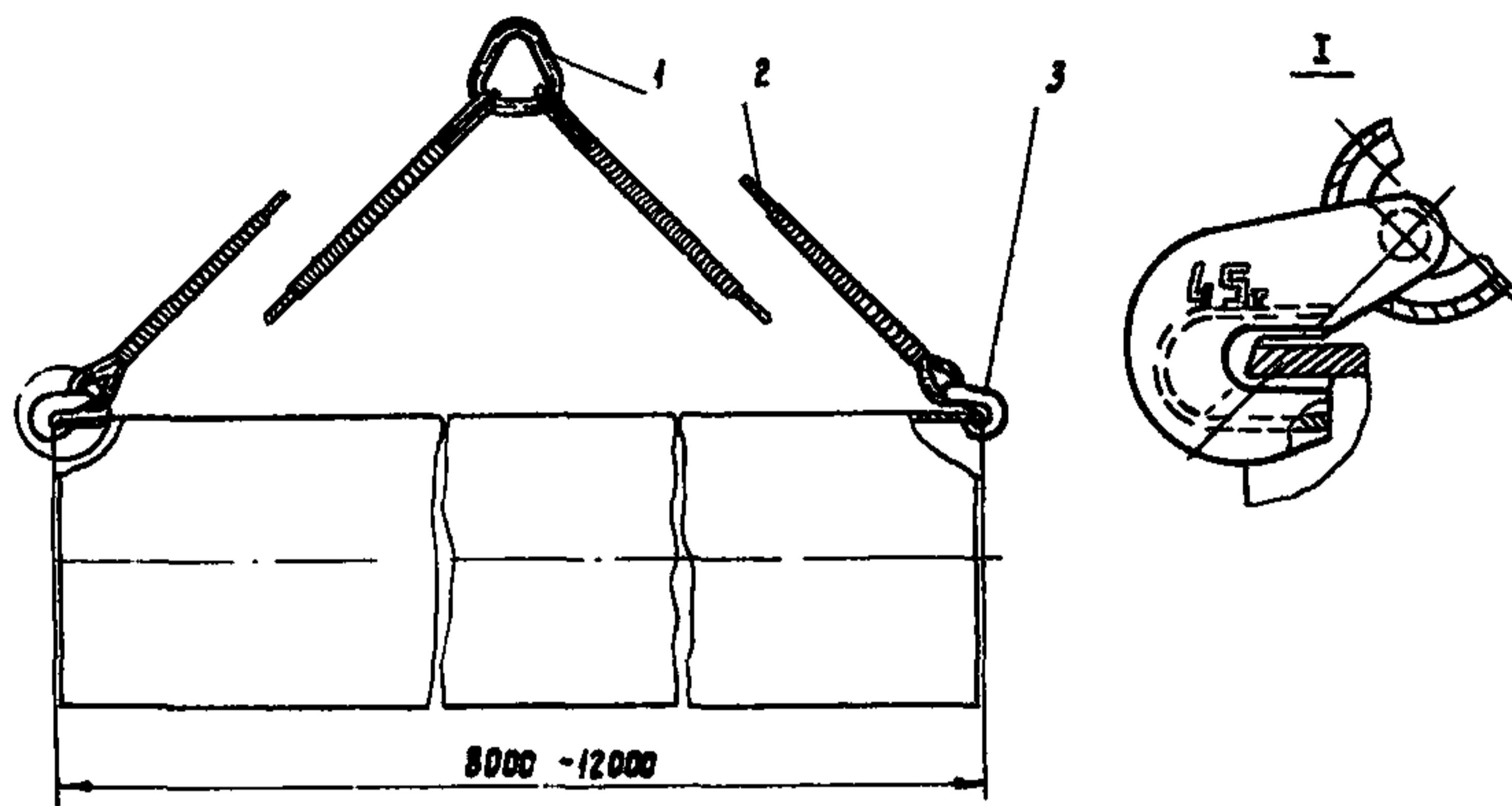
Рис.2. Захват торцевой ЗТ-1422:
