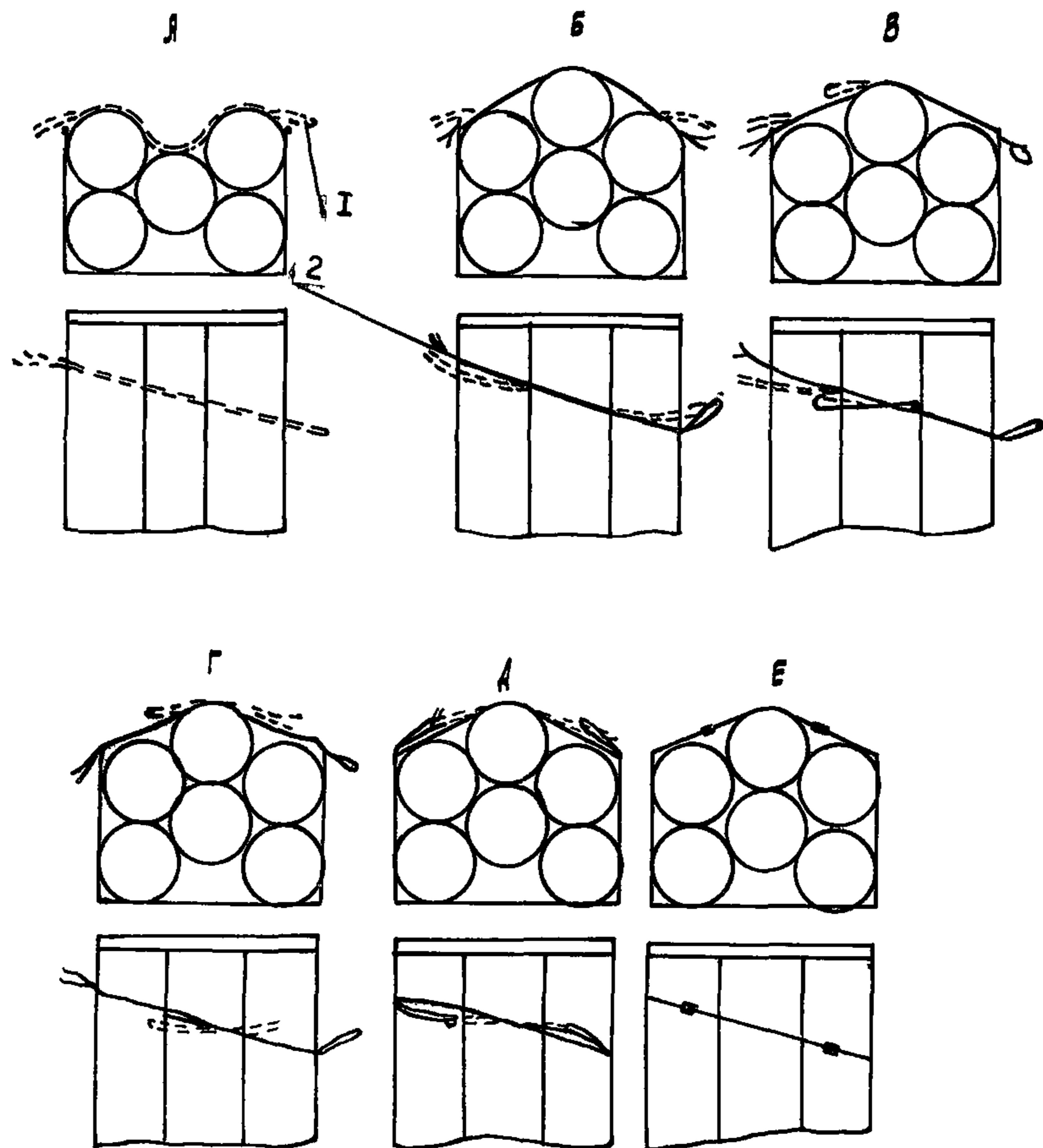
Рис.28. Последовательность увязки труб:
