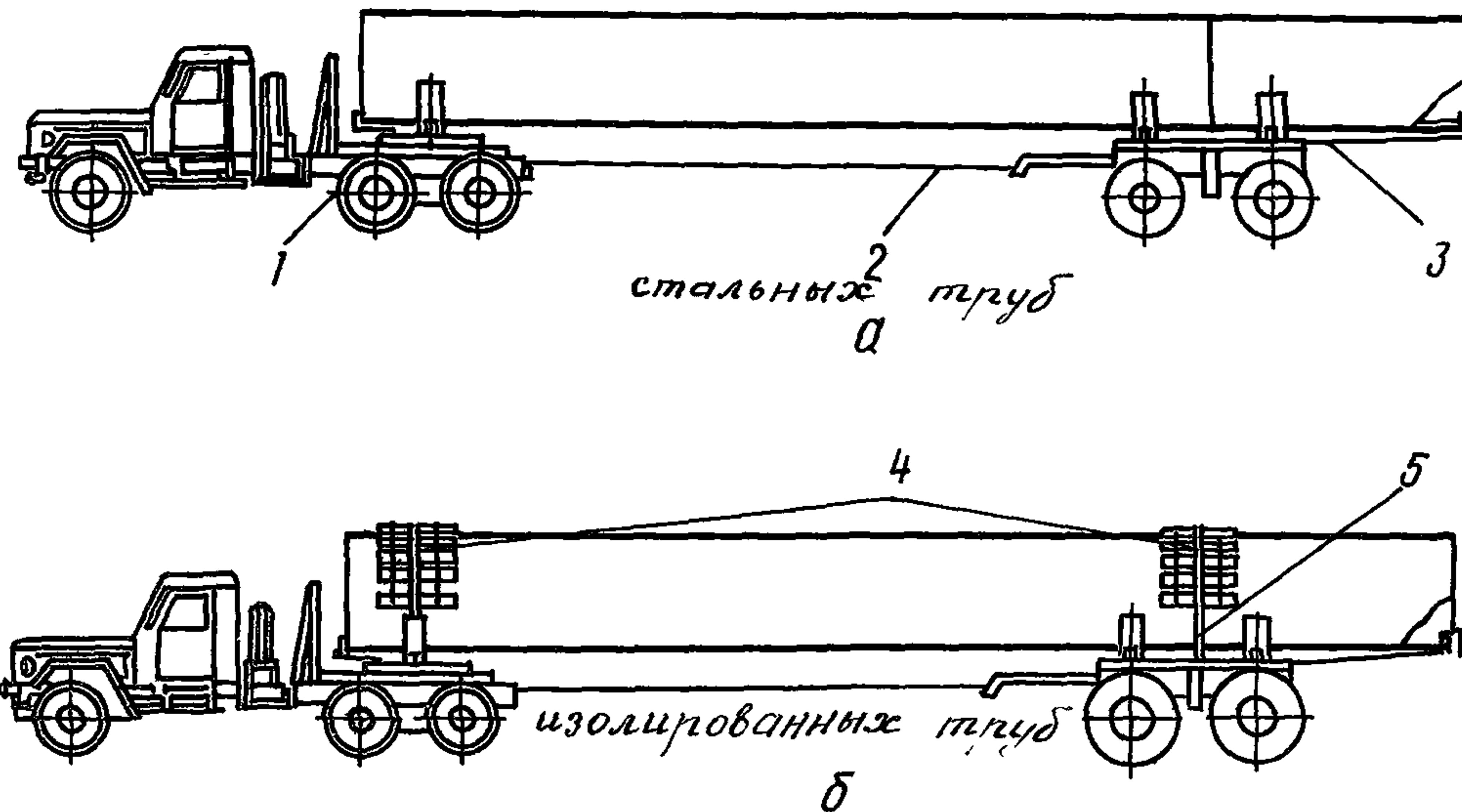
Рис.24. Схема увязки труб на трубопроводах:
