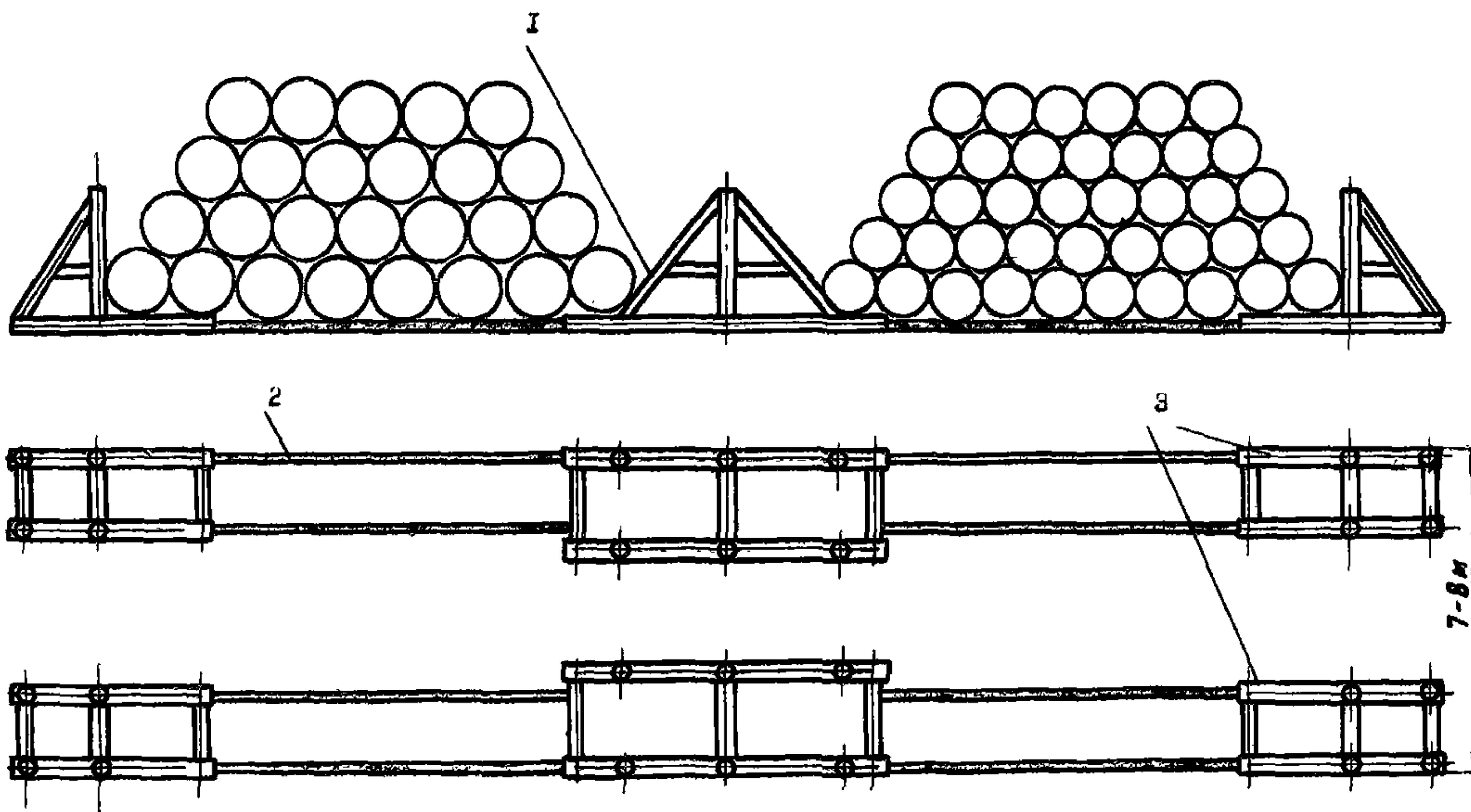
Рис. I5. Схема штабеля труб разных диаметров с применением опорных разделительных стоек:
