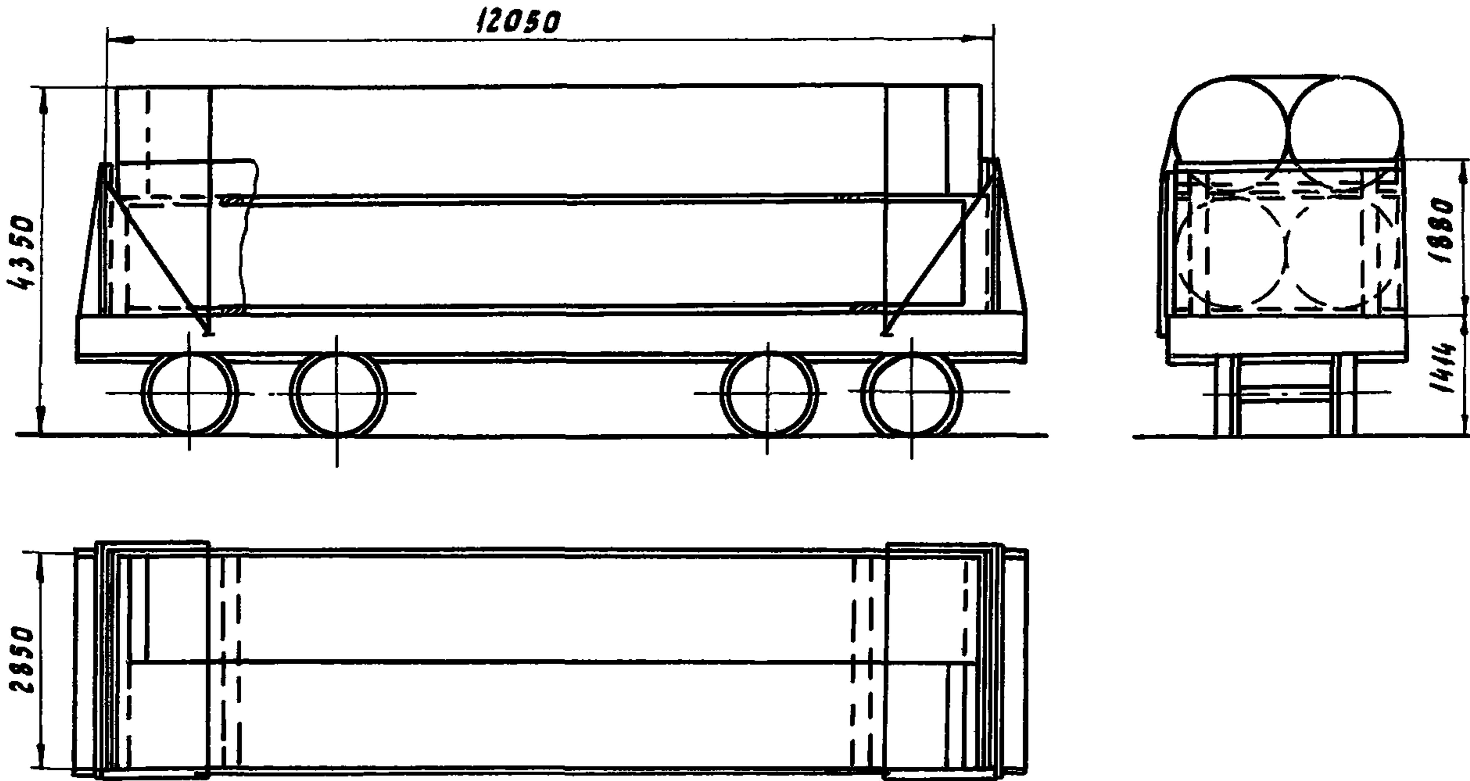
Рис.31. Схема размещения и крепления труб диаметром 1420 мм
