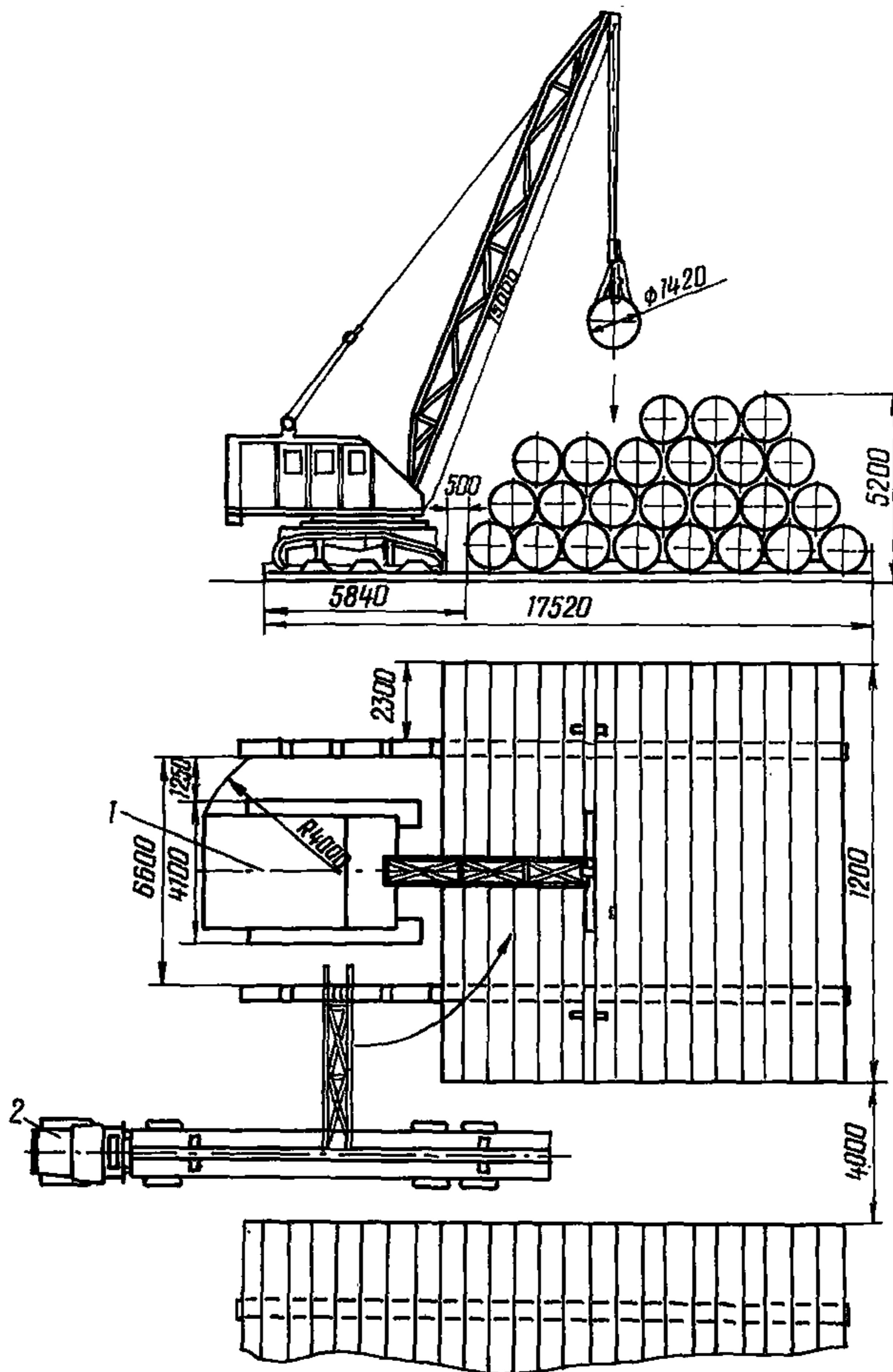
Рис.12. Схема складирования труб на стеллаже СР-142I с помощью гусеничного крана СКГ-40:
