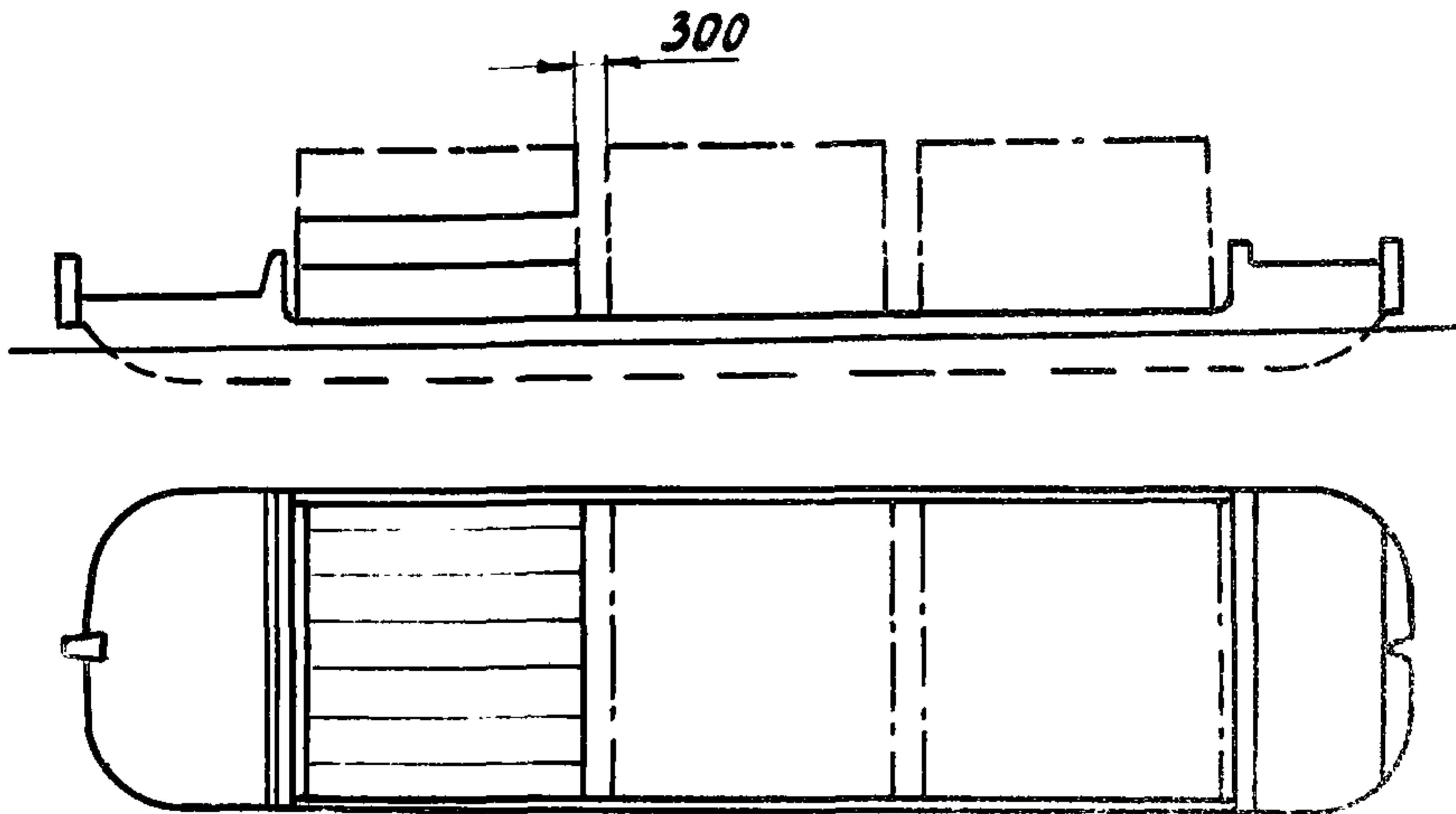
Рис.36. Схема продольного расположения труб
