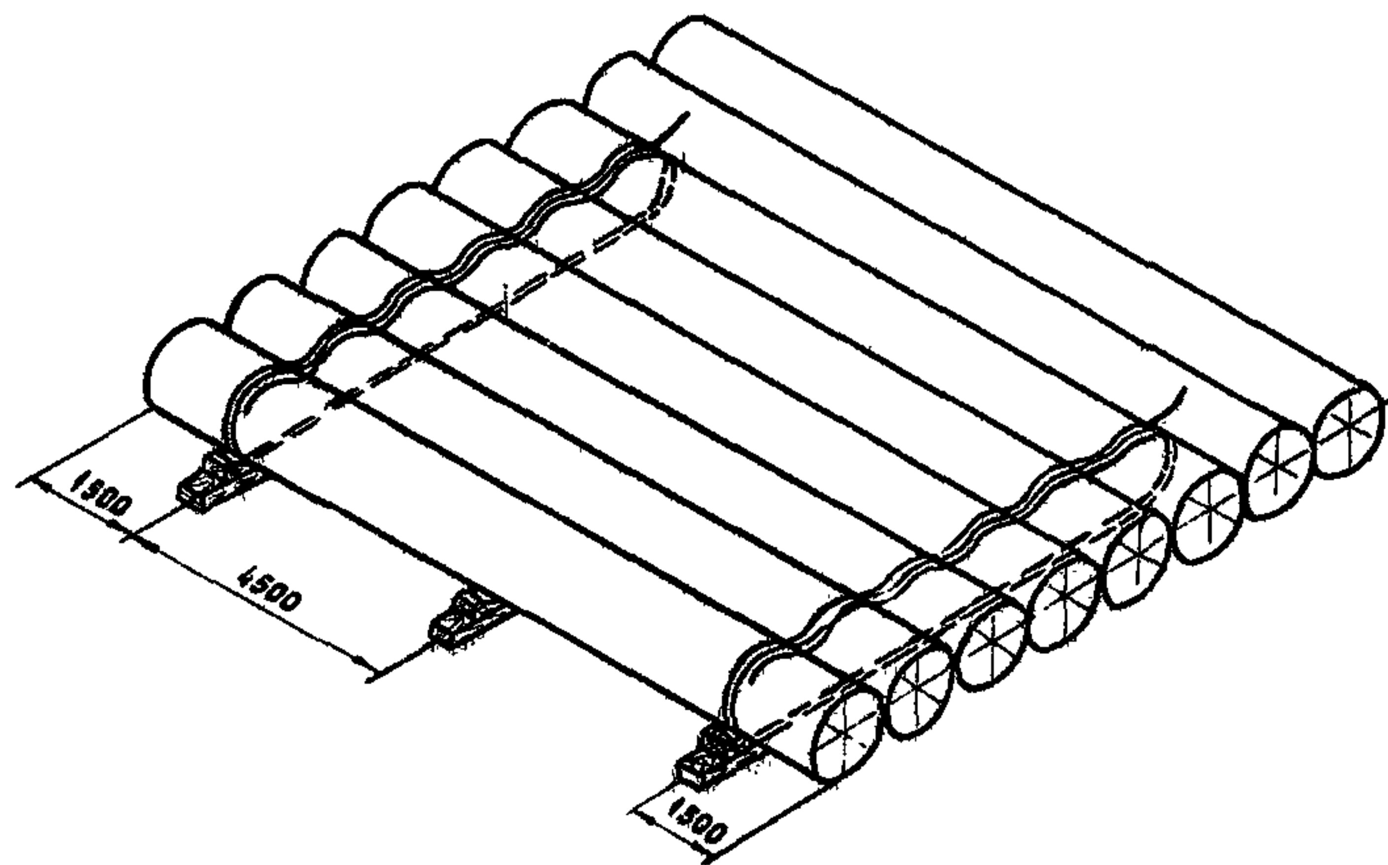
Рис.17. Схема наружной увязки труб
