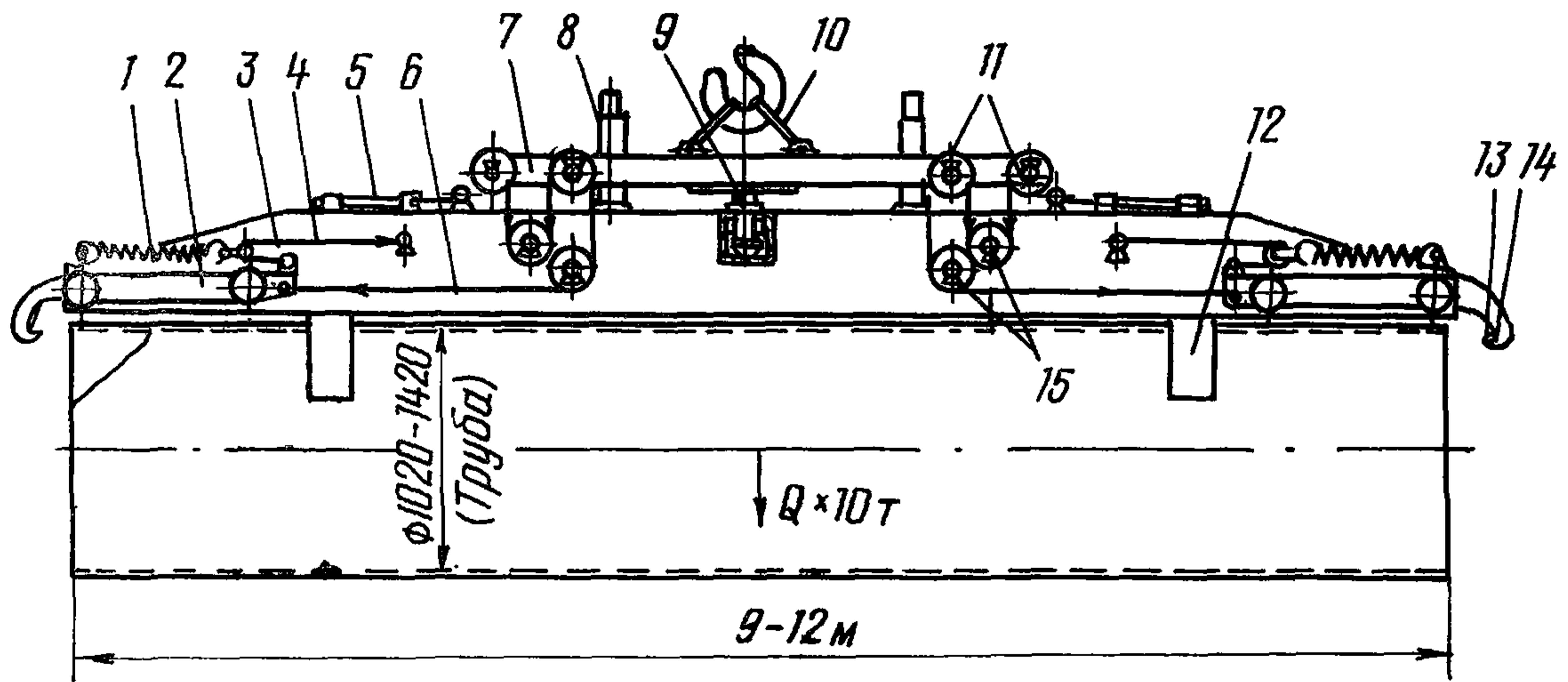
Рис.6. Конструктивная схема захвата трубного автоматического ЗТА-102:
