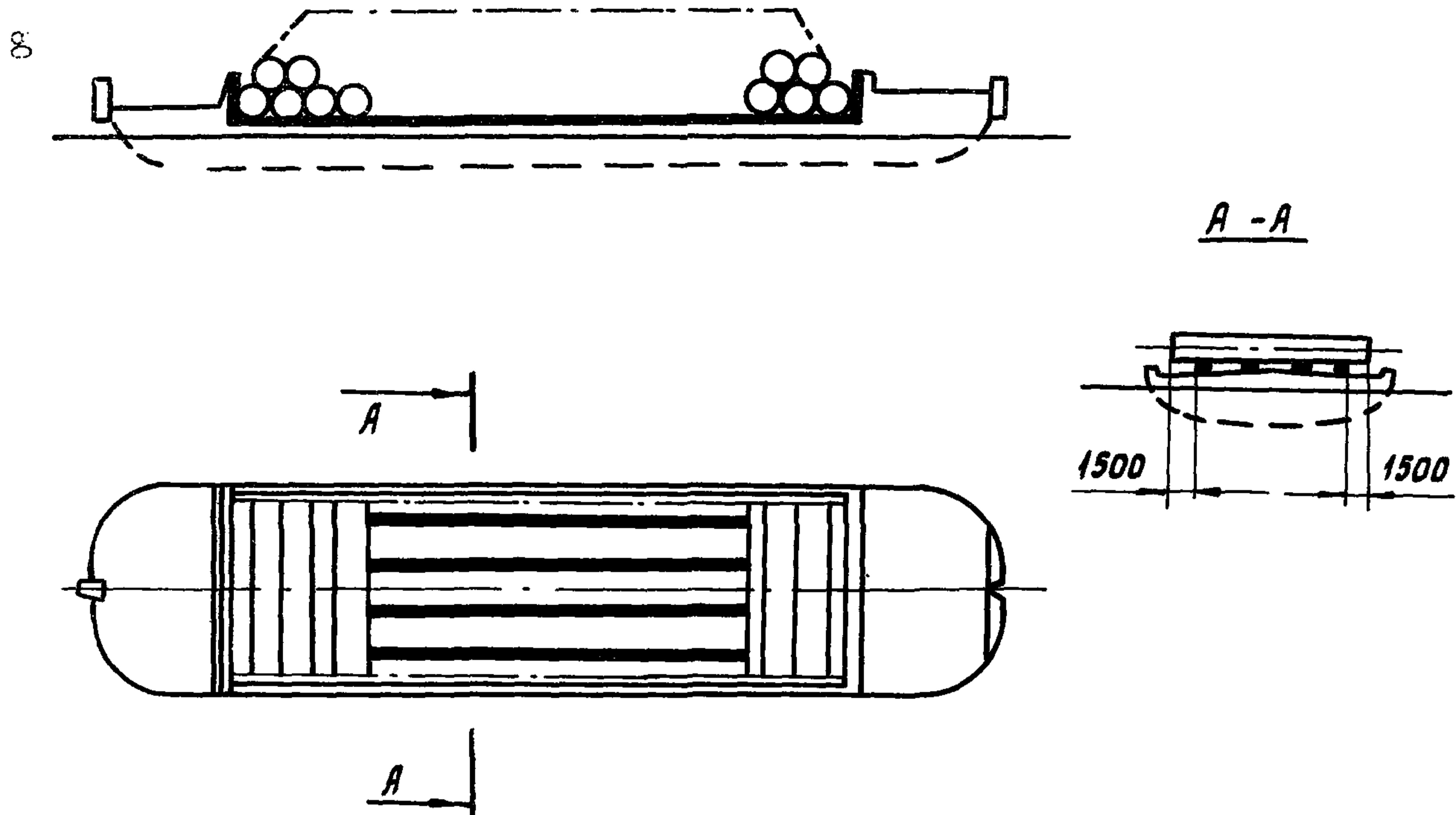
Рис.35. Схема размещения труб диаметром 1420 мм с заводским изоляционным покрытием на судах речного флота
