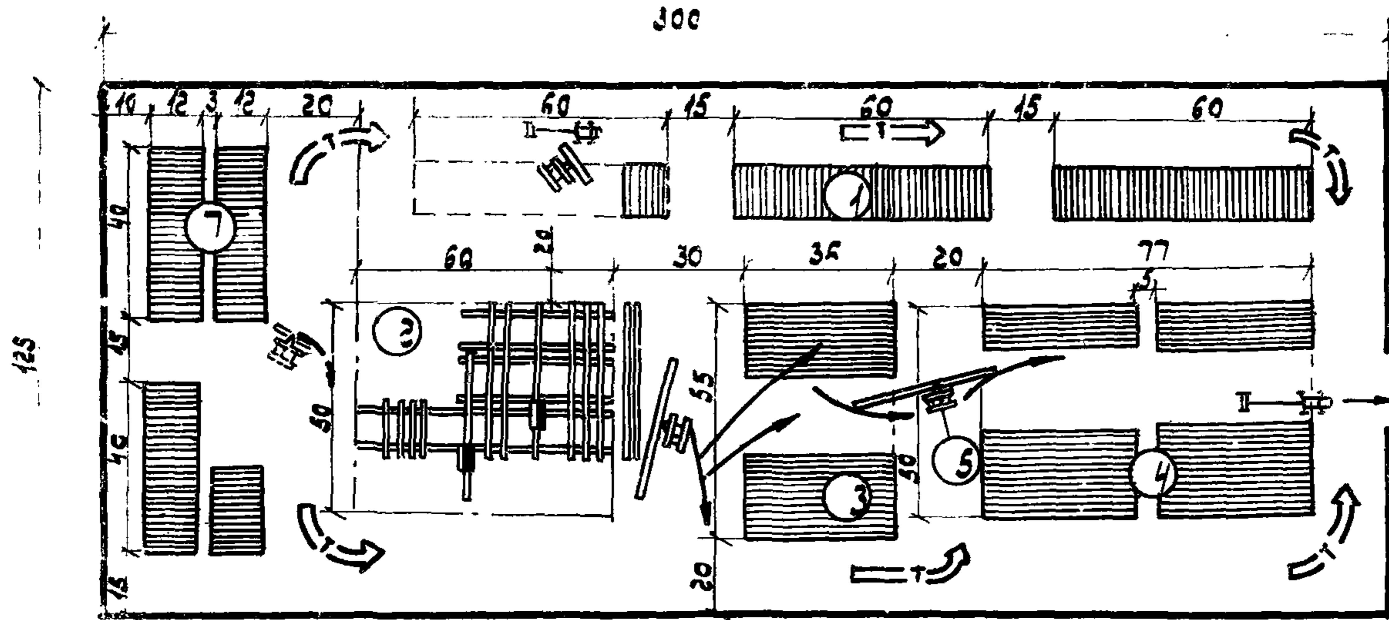
Рис. I8. Организация складирования труб и секций труб на трубосварочной базе. Низкорядный склад:
