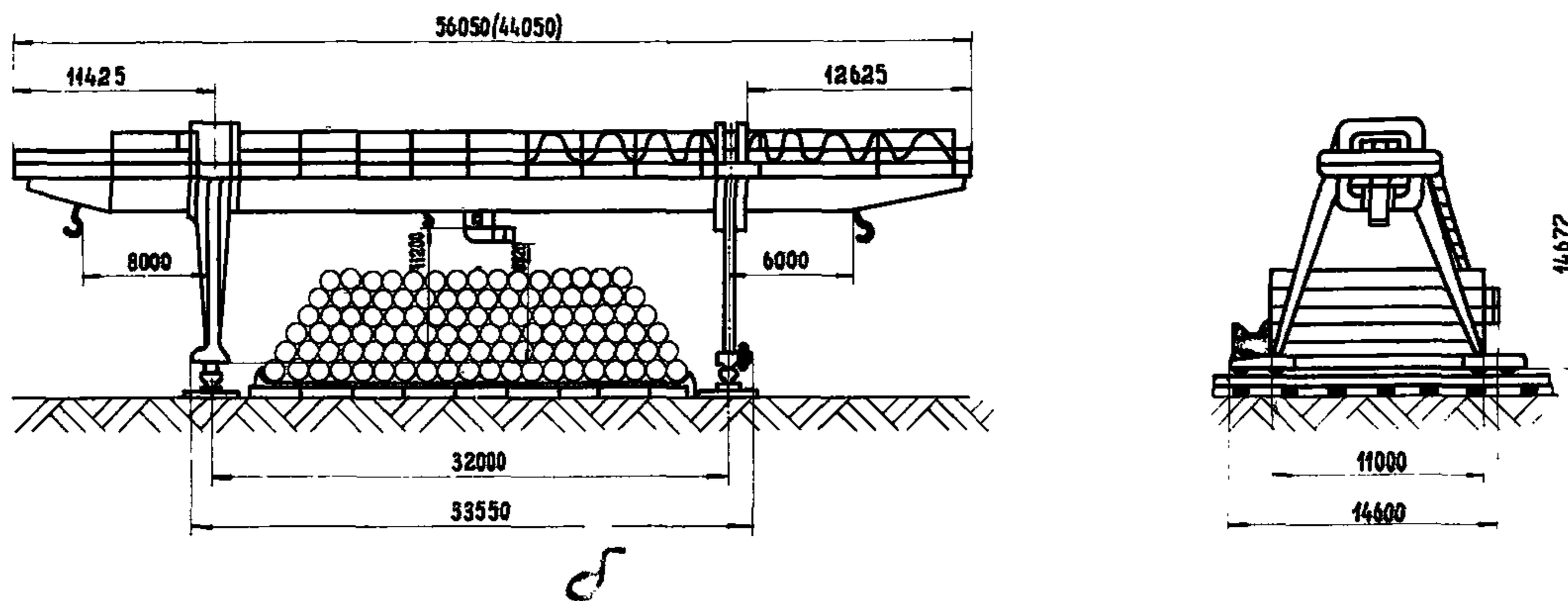
Рис.10. Поперечный разрез базисного высокорядного склада при трубопроводной базе:
