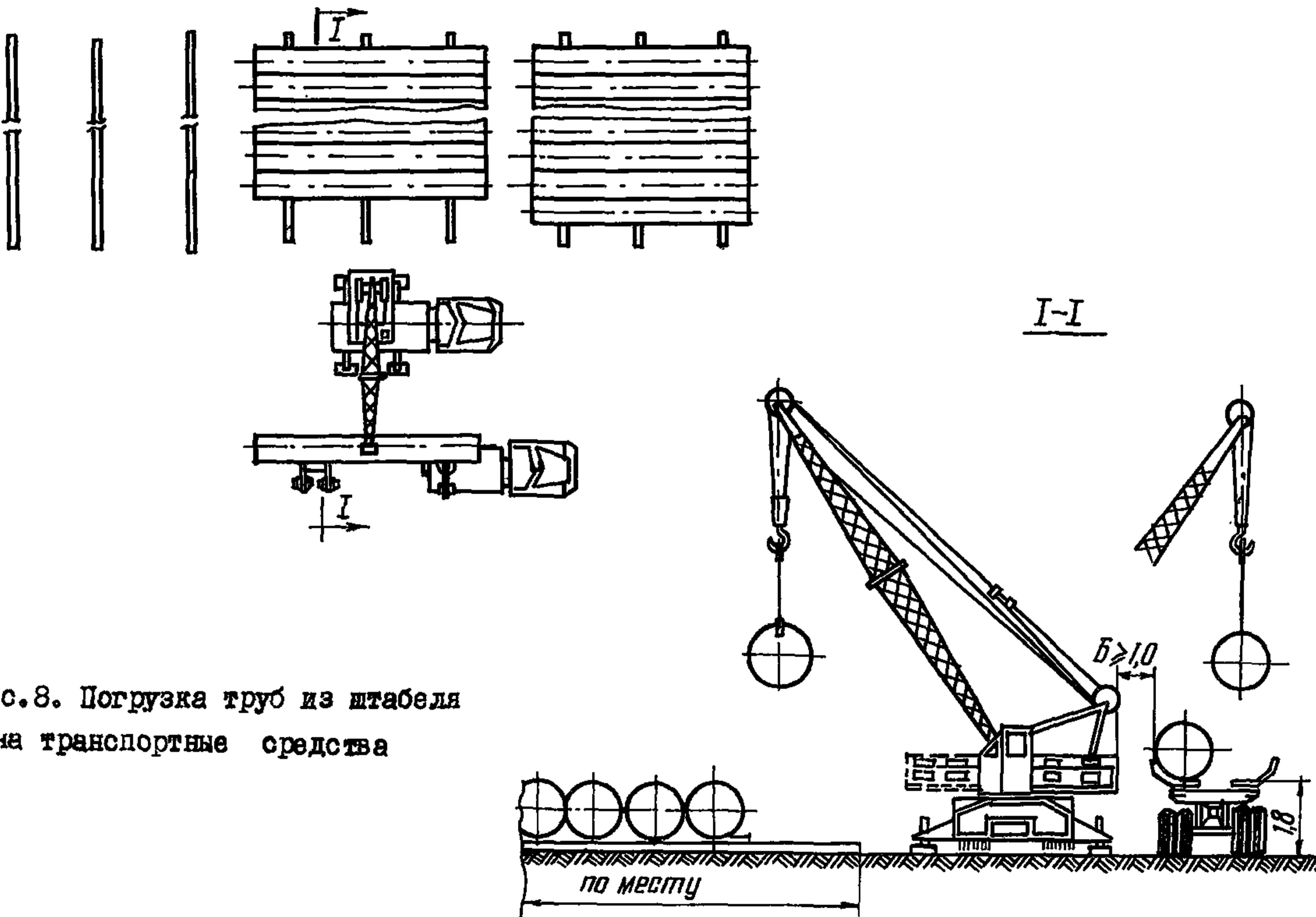
Рис.8. Погрузка труб из штабеля
