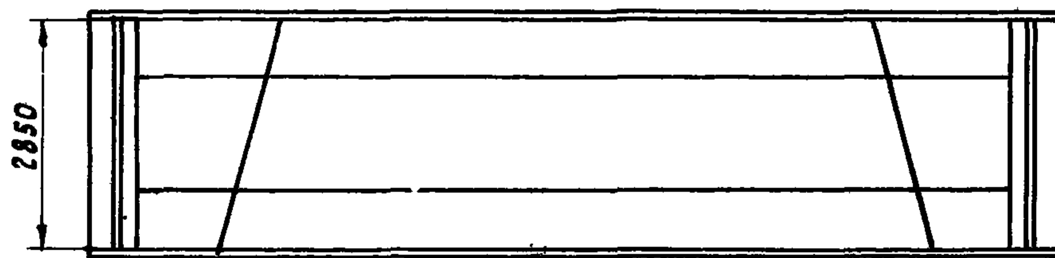
Рис.30. Схема размещения и крепления труб диаметром I220 мм
