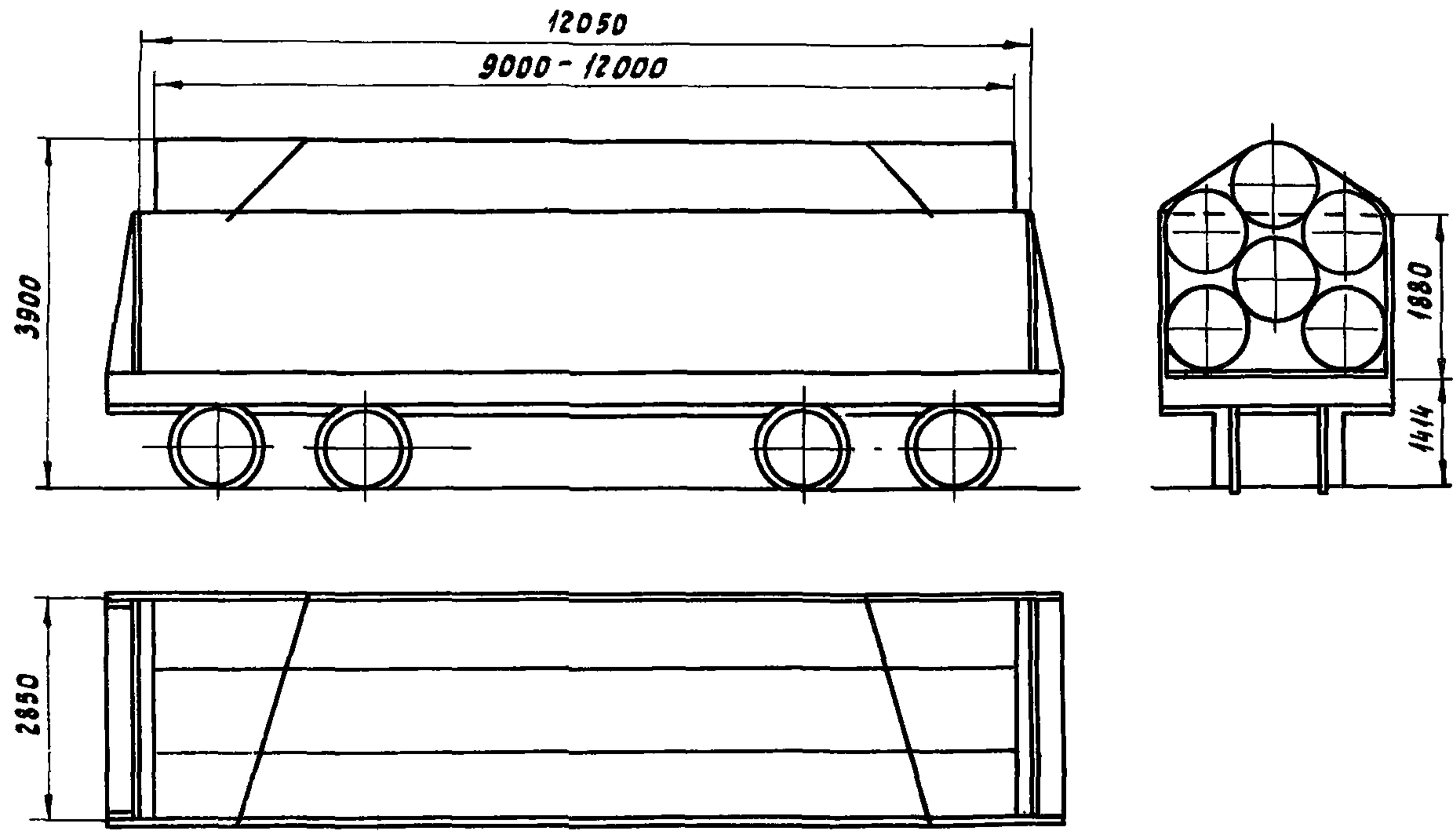
Рис.27. Схема размещения и крепления труб диаметром 1020 мм
