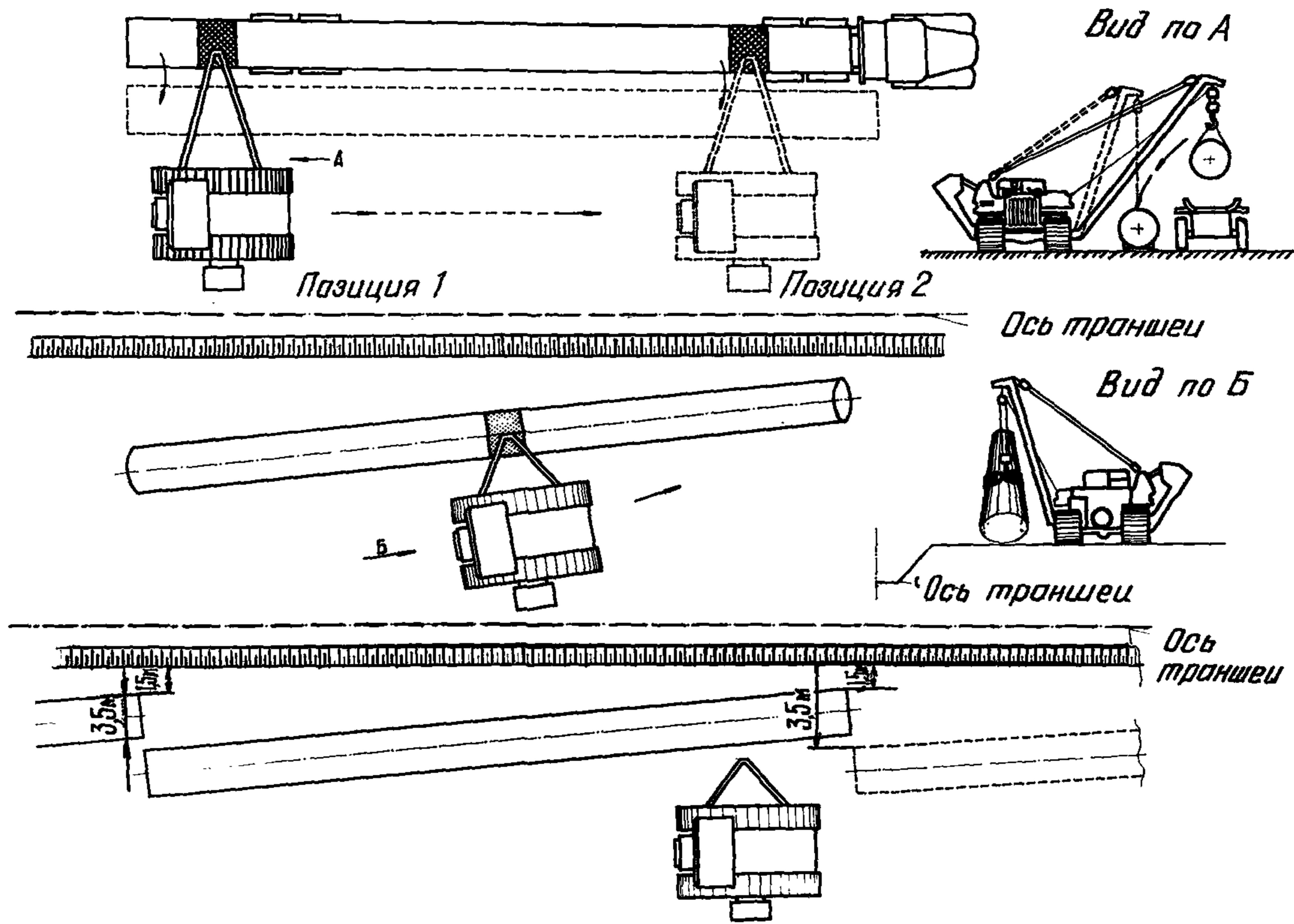
Рис.23. Схема разгрузки изолированных секций труб
