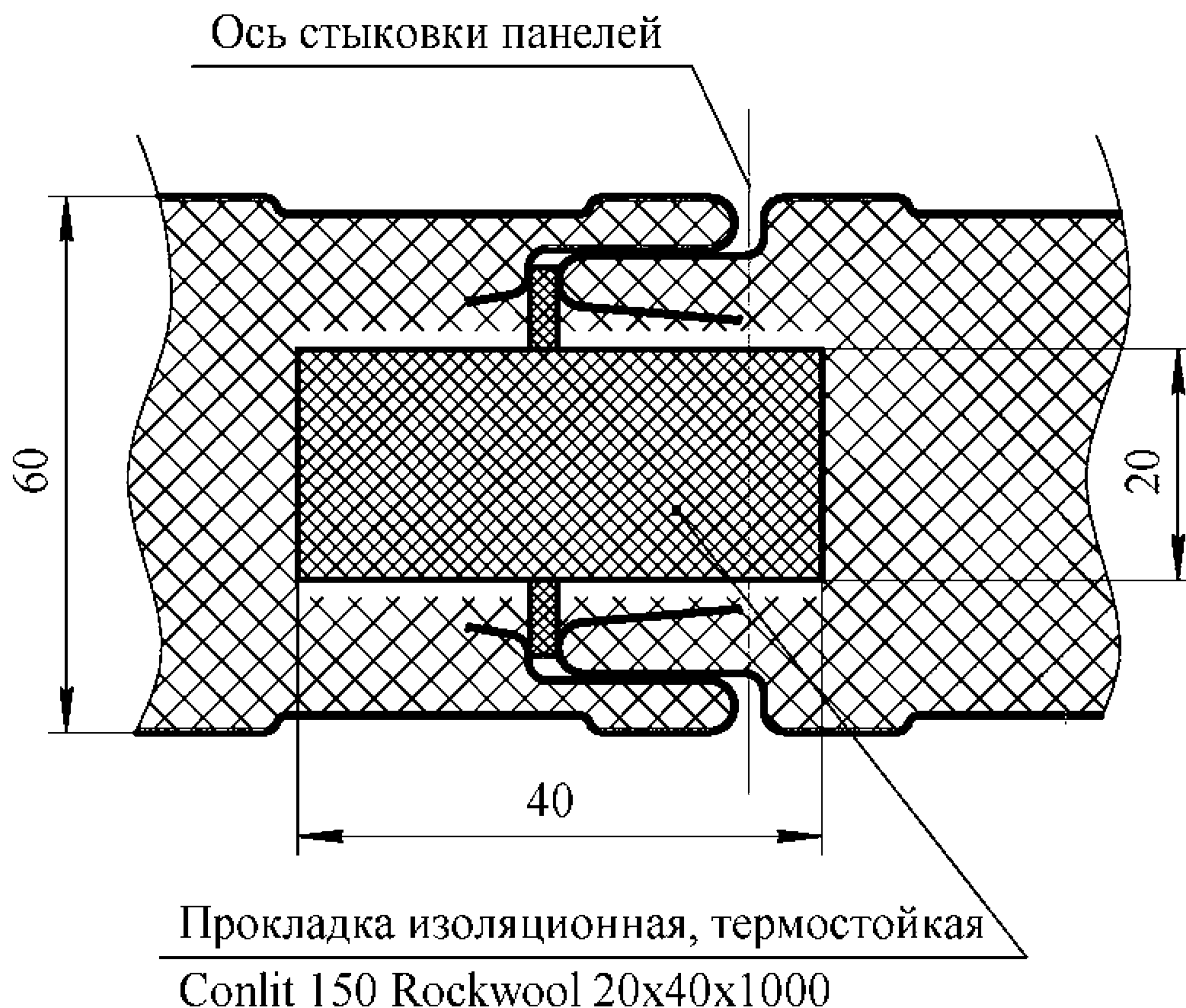
Рисунок 7 – Укладка термостойкой прокладки в стык стеновых панелей
