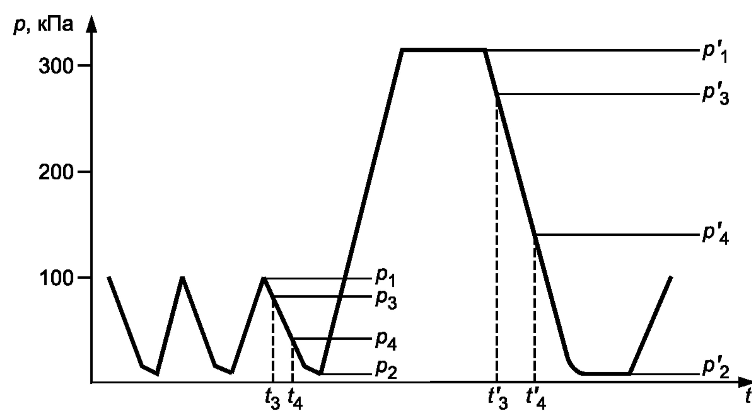
Рисунок А.1 — Определение скорости изменения давления
