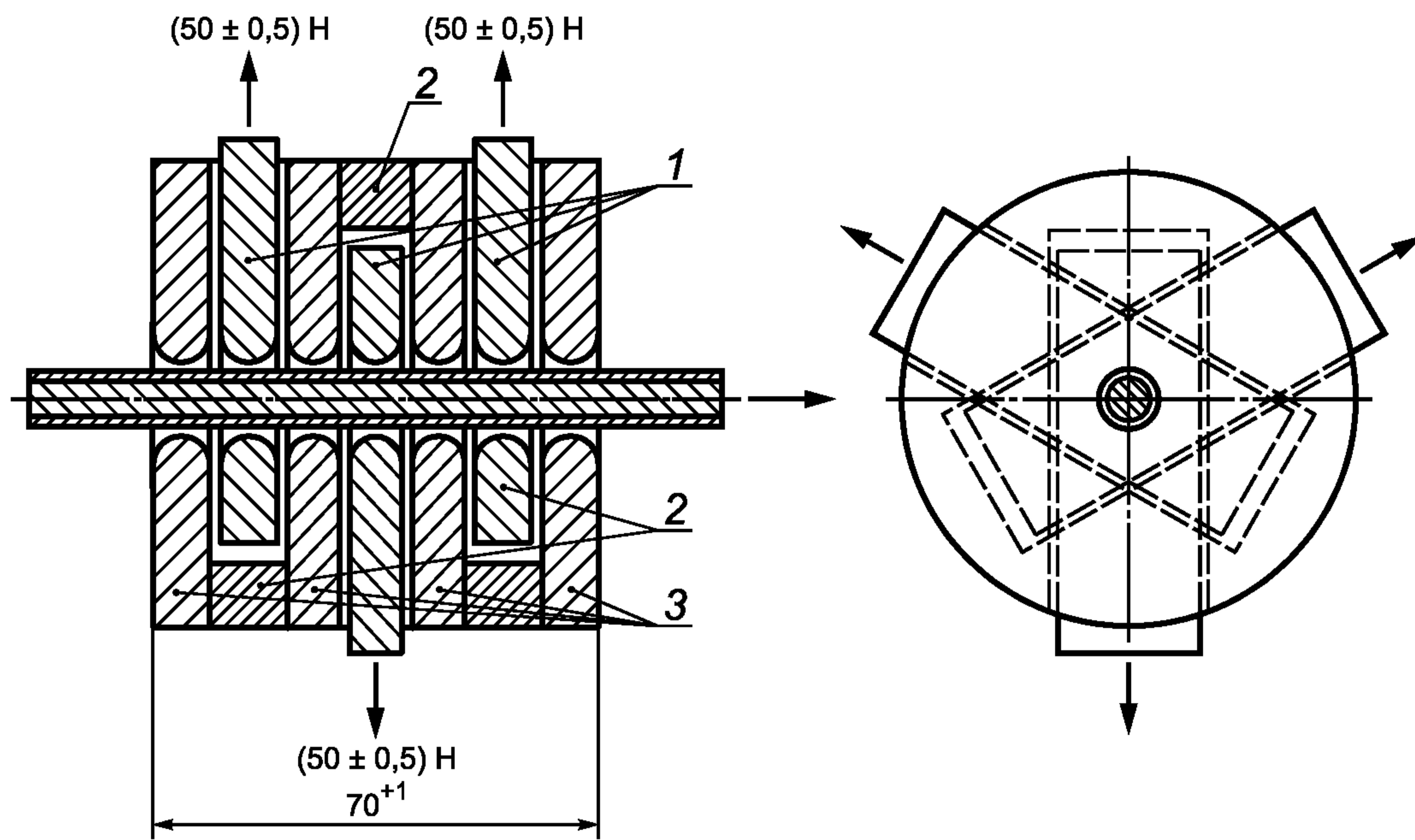
1 — движущиеся пластины; 2 — пространство; 3 — закрепленные пластины
