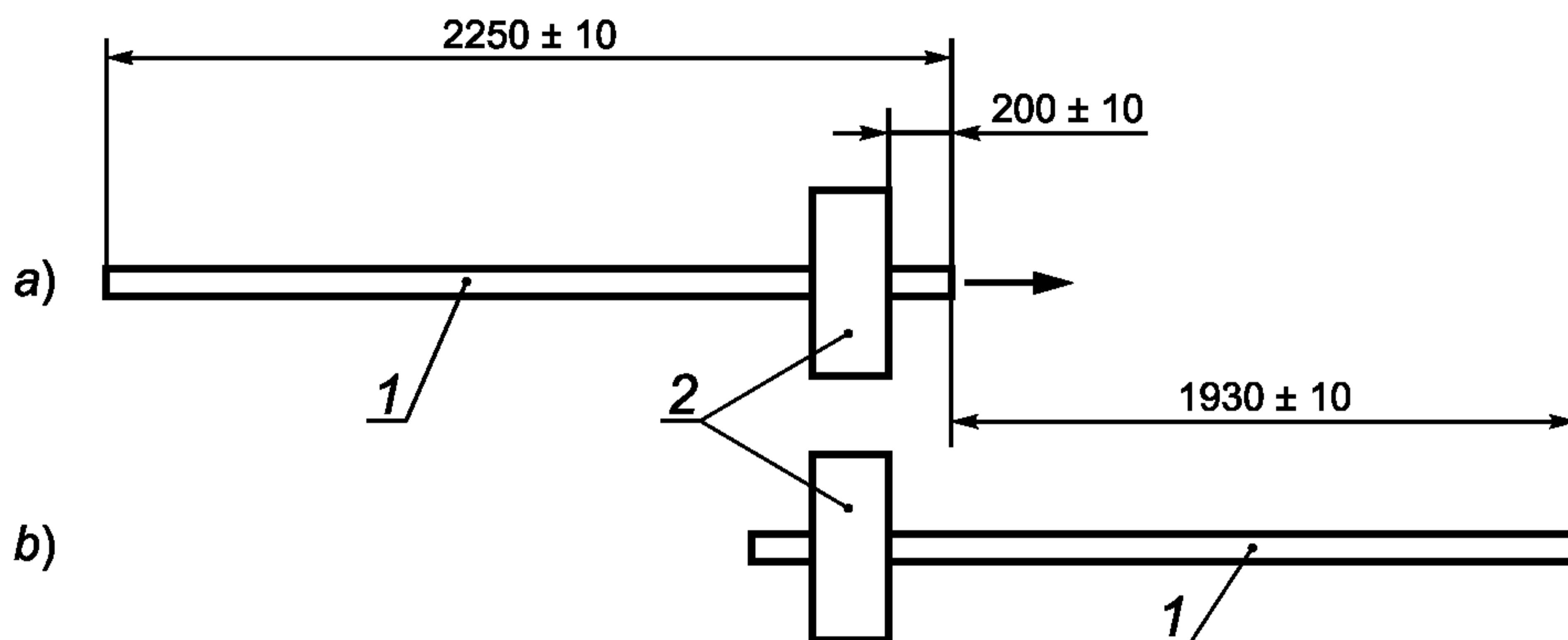
a) — расположение образца до испытания; b) — расположение образца после испытания;
