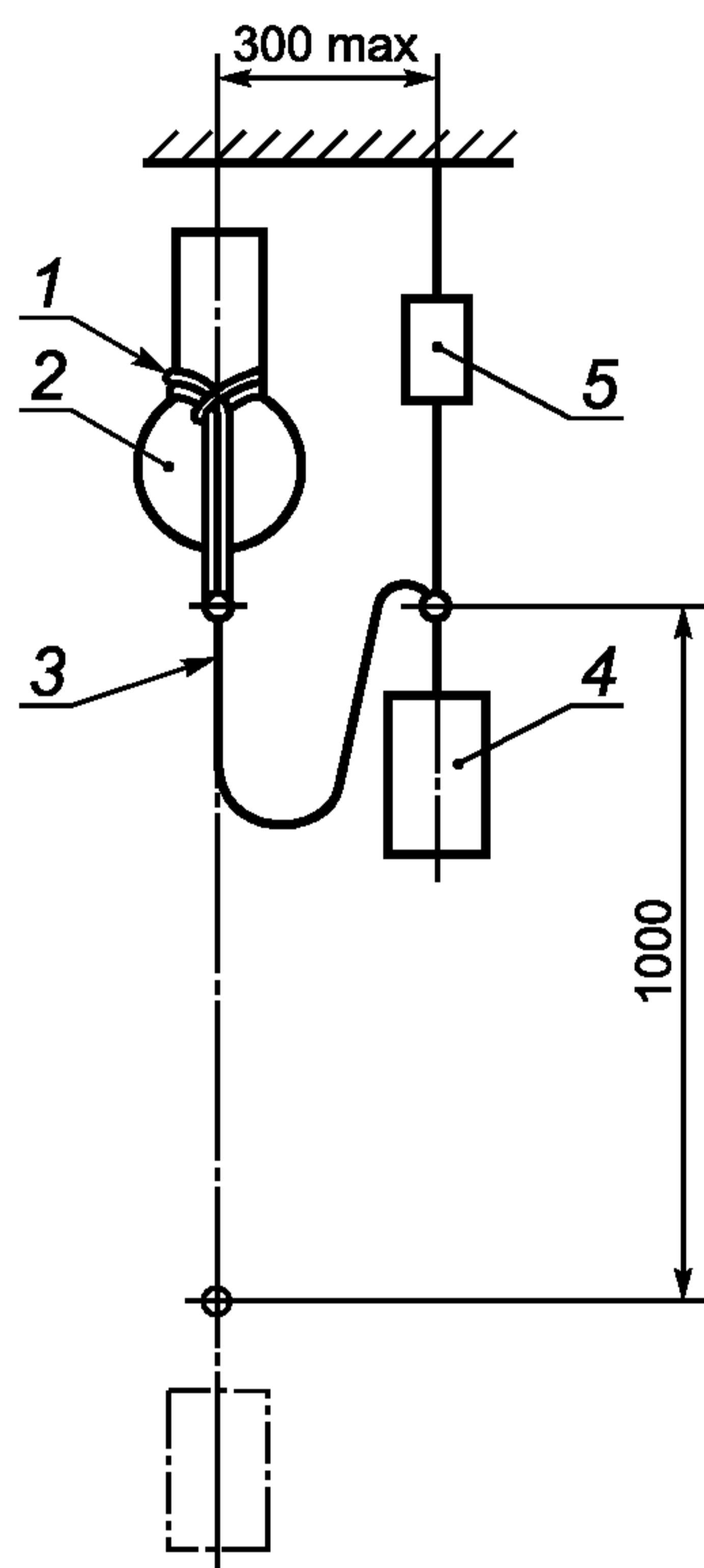
1 — спасательная петля; 2 — тест-форма; 3 — испытательная стропа; 4 — испытательная масса;
