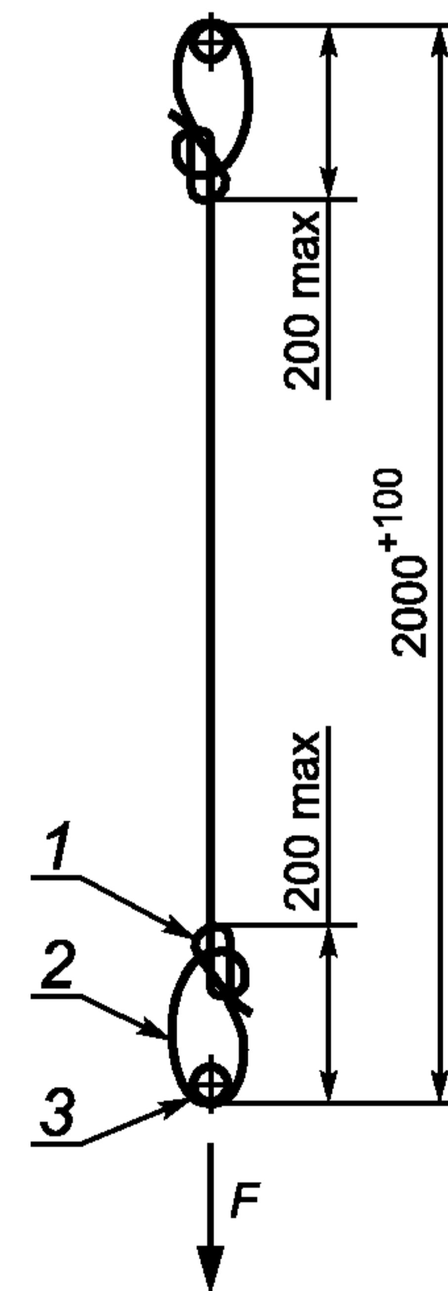
Рисунок 6 — Испытательная стропа для проверки прочности динамической нагрузкой
