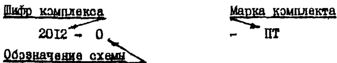
3.4. Обозначение принципиально-технологической схемы части комплекса состоит из шифра комплекса, обозначения части комплекта, обозначения схемы и марки комплекта:
