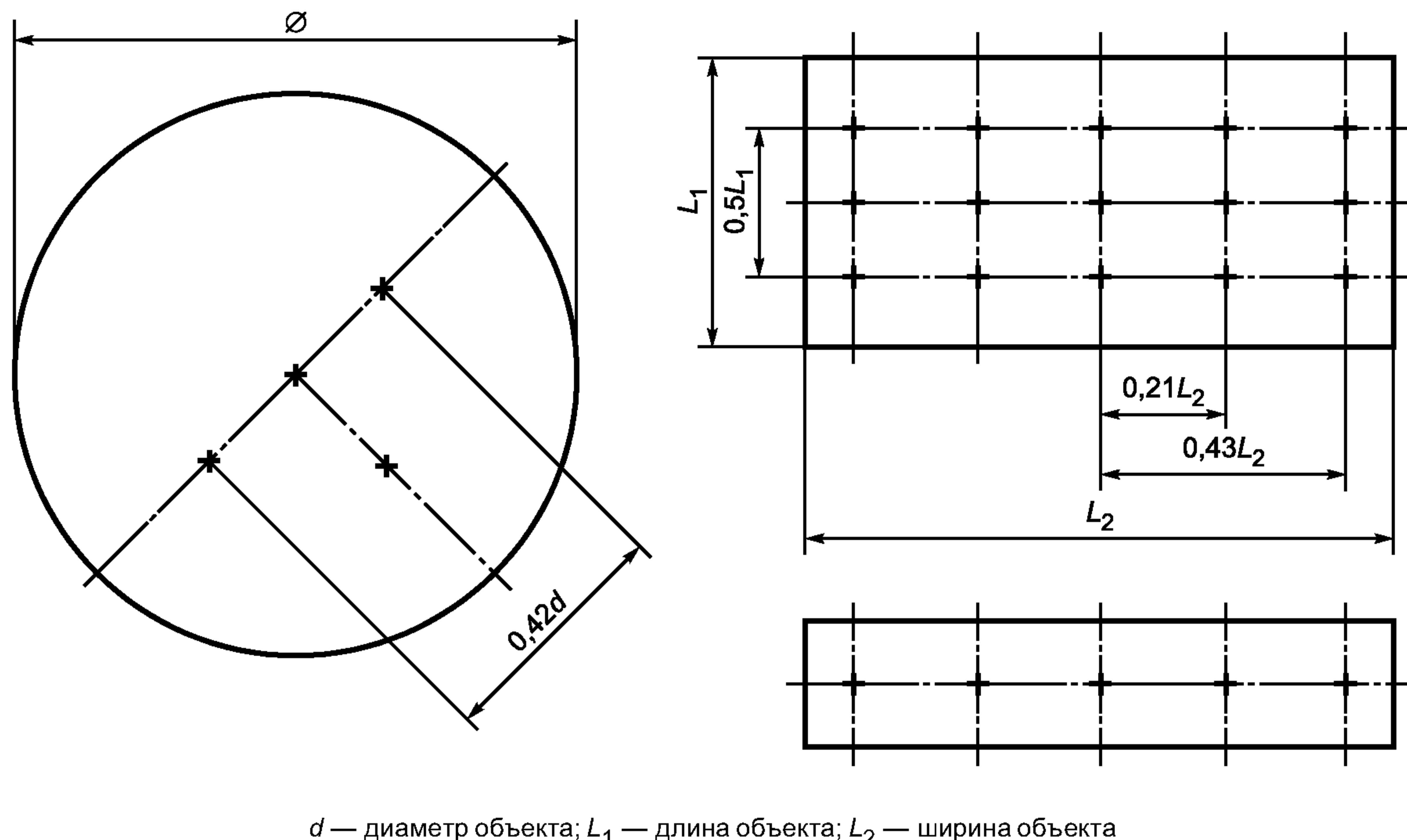
Рисунок 4 — Размещение датчиков для измерения температуры
