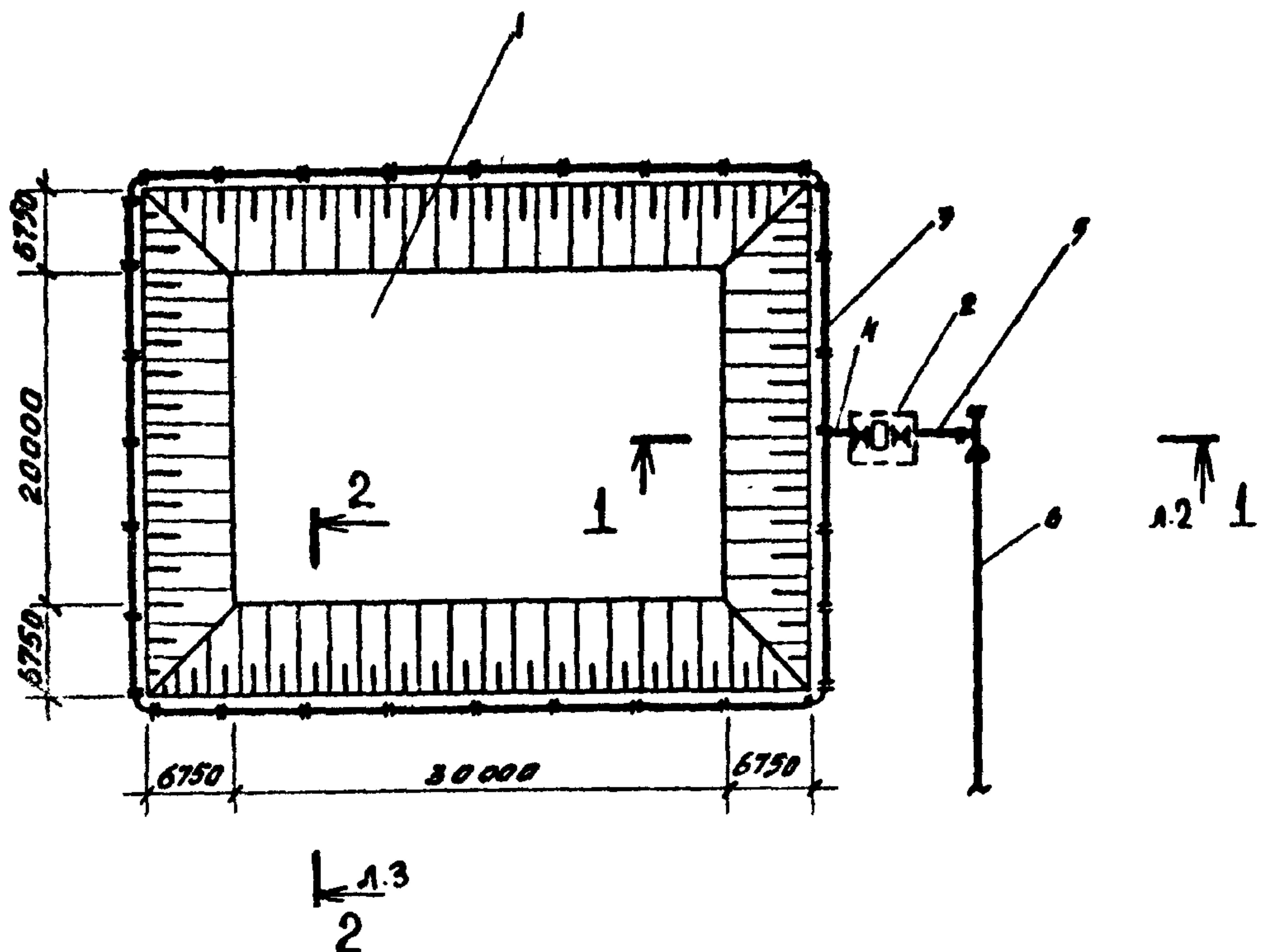
1 - котлован; 2 - установка ЛИУ-3; 3 - водосборный коллектор  $\phi = 150\text{мм}$ ; 4 - всасывающий рукав  $\phi = 150\text{мм}$ ;
