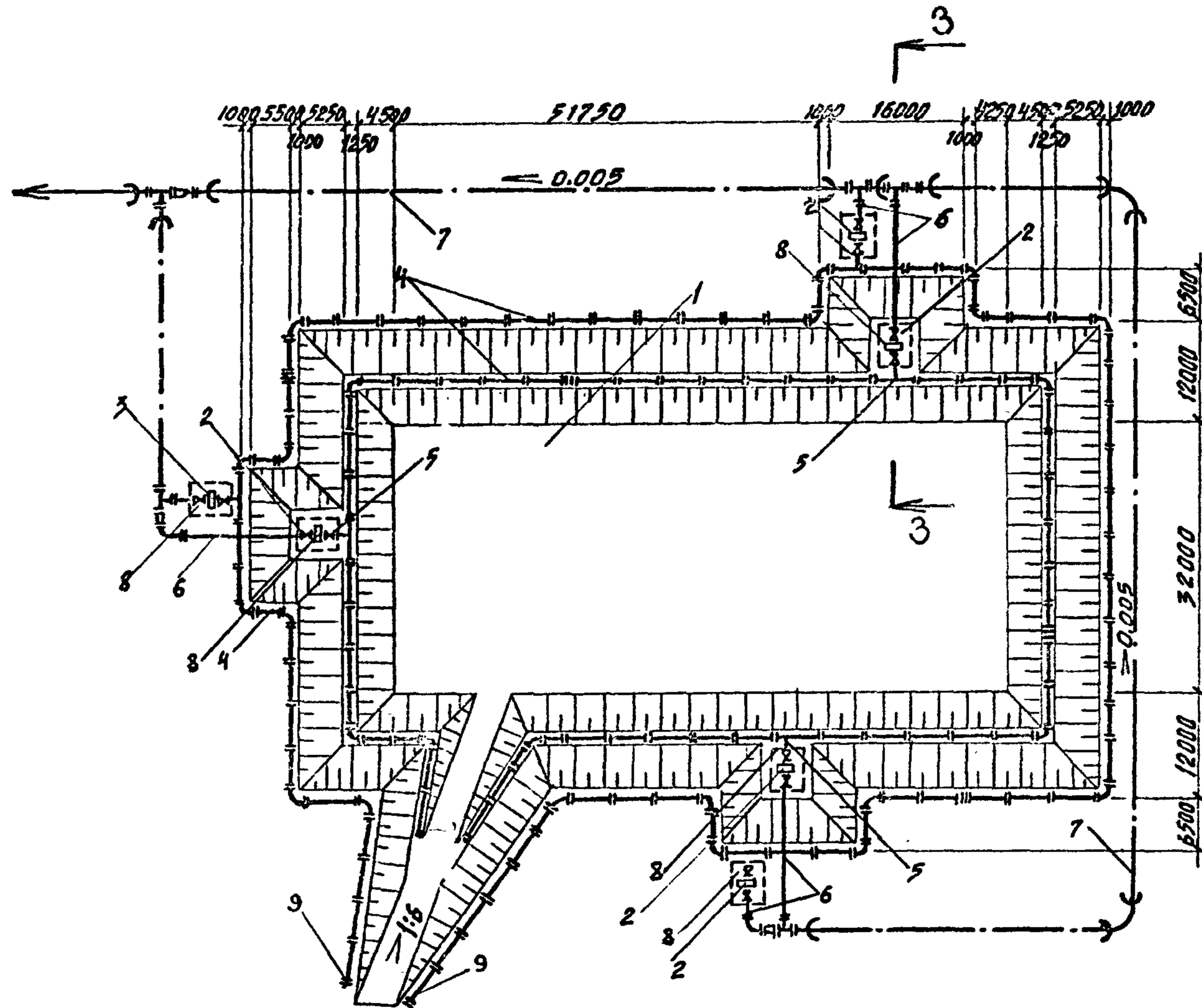
1-котлован, 2-установка ЛИУ-5, 3-установка ЛИУ-3, 4-водосборный коллектор, 5-сбрасывающий рукав, 6-напорная линия Ø 150 мм, 7-сбросная линия из труб Ø 300; 8-будка, 9-заглушка.
