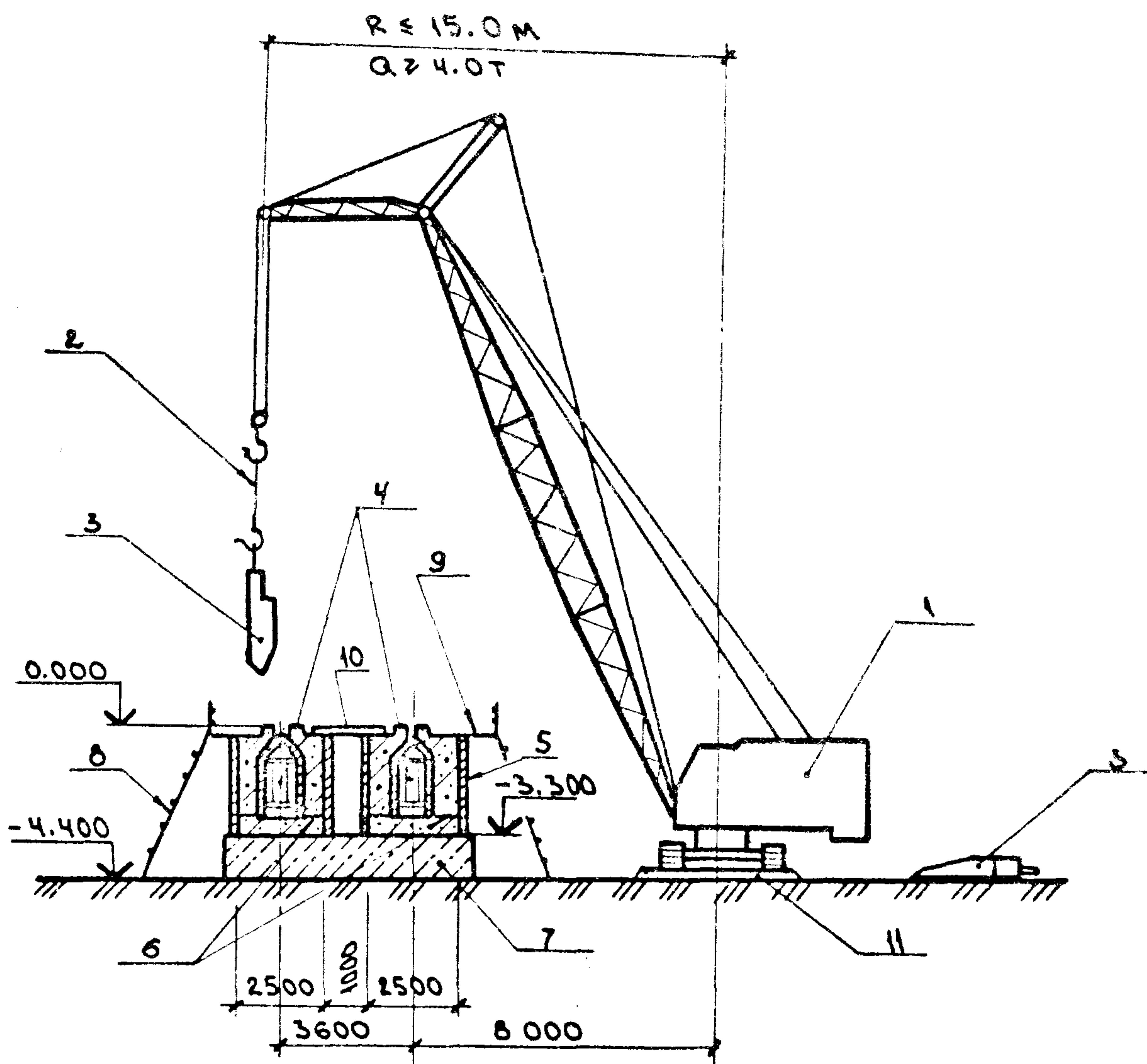
1 - гусеничный кран; 2 - строп 2СК; 3 - бункер с бетоном; 4 - опалубка катушая; 5 - щиты опалубки инвентарные; 6 - рабочий шов; 7 - подбетонка; 8 - лестница приставная; 9 - площадка навесная; 10 - настил деревянный; 11 - временная автодорога.
