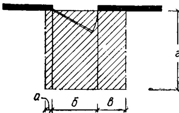
Рис. 1. Площади зон открывания распашных дверей, которыми должны пользоваться неможные и колясочники
