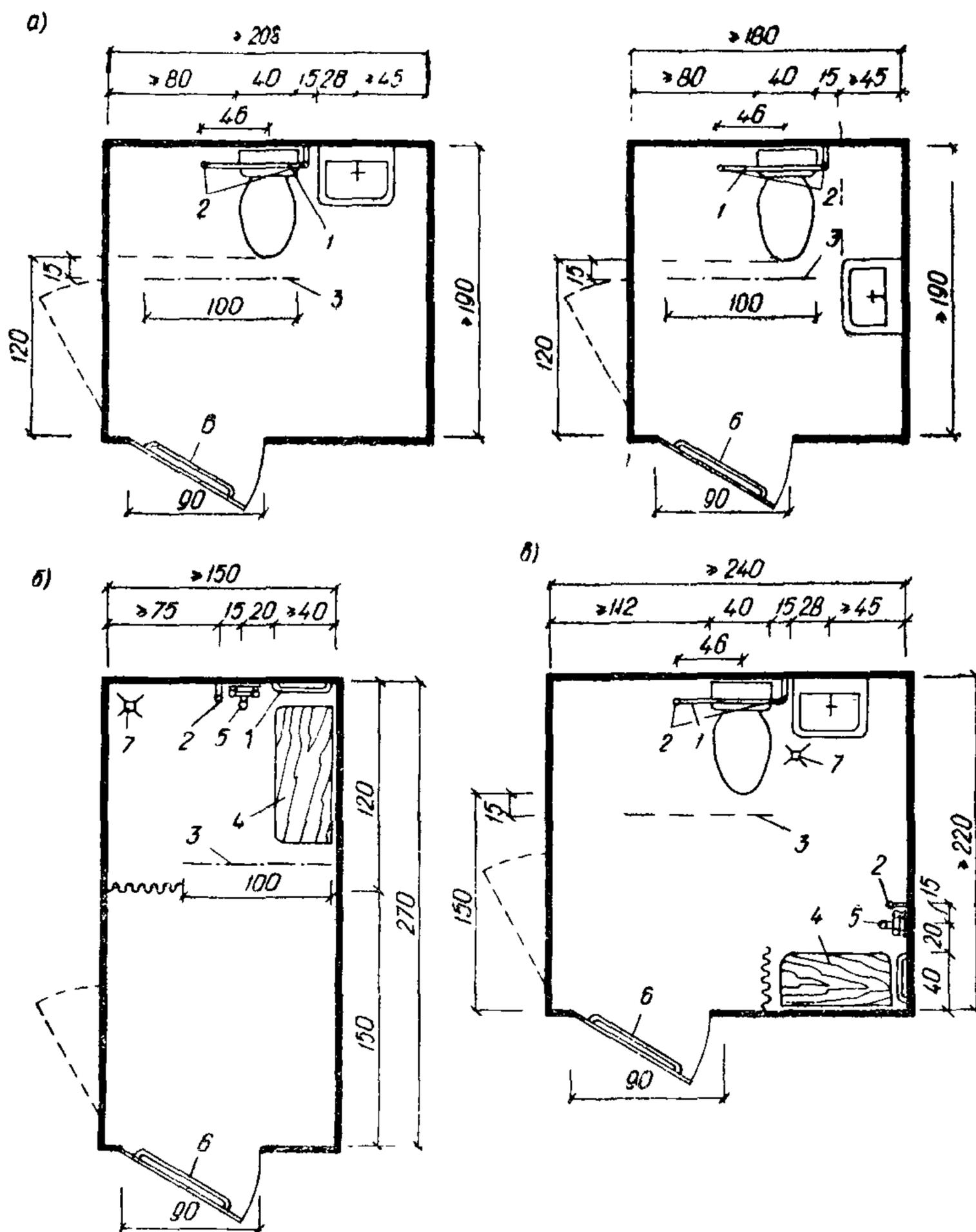
Рис. 4. Минимальные размеры санитарных узлов для колясочников (см) и расстановка в них оборудования
