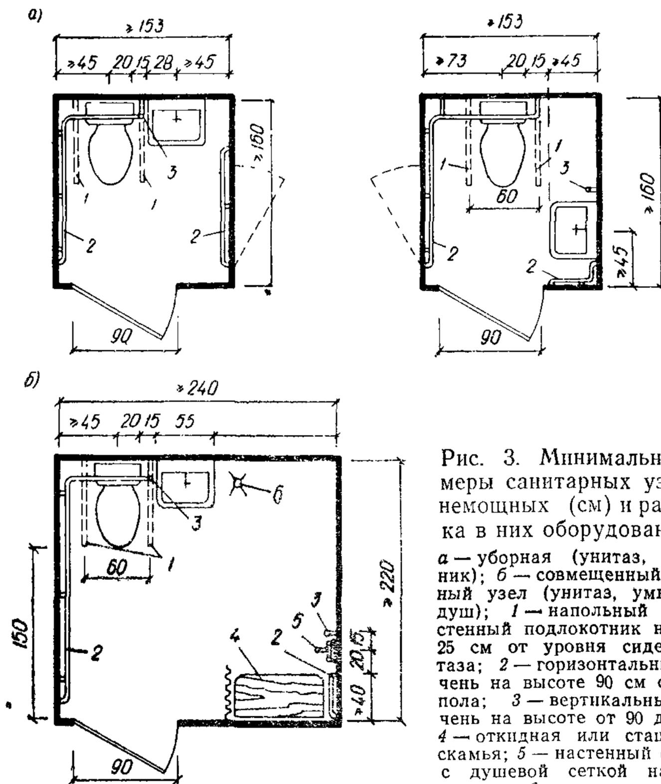
Рис. 3. Минимальные размеры санитарных узлов для немощных (см) и расстановка в них оборудования
