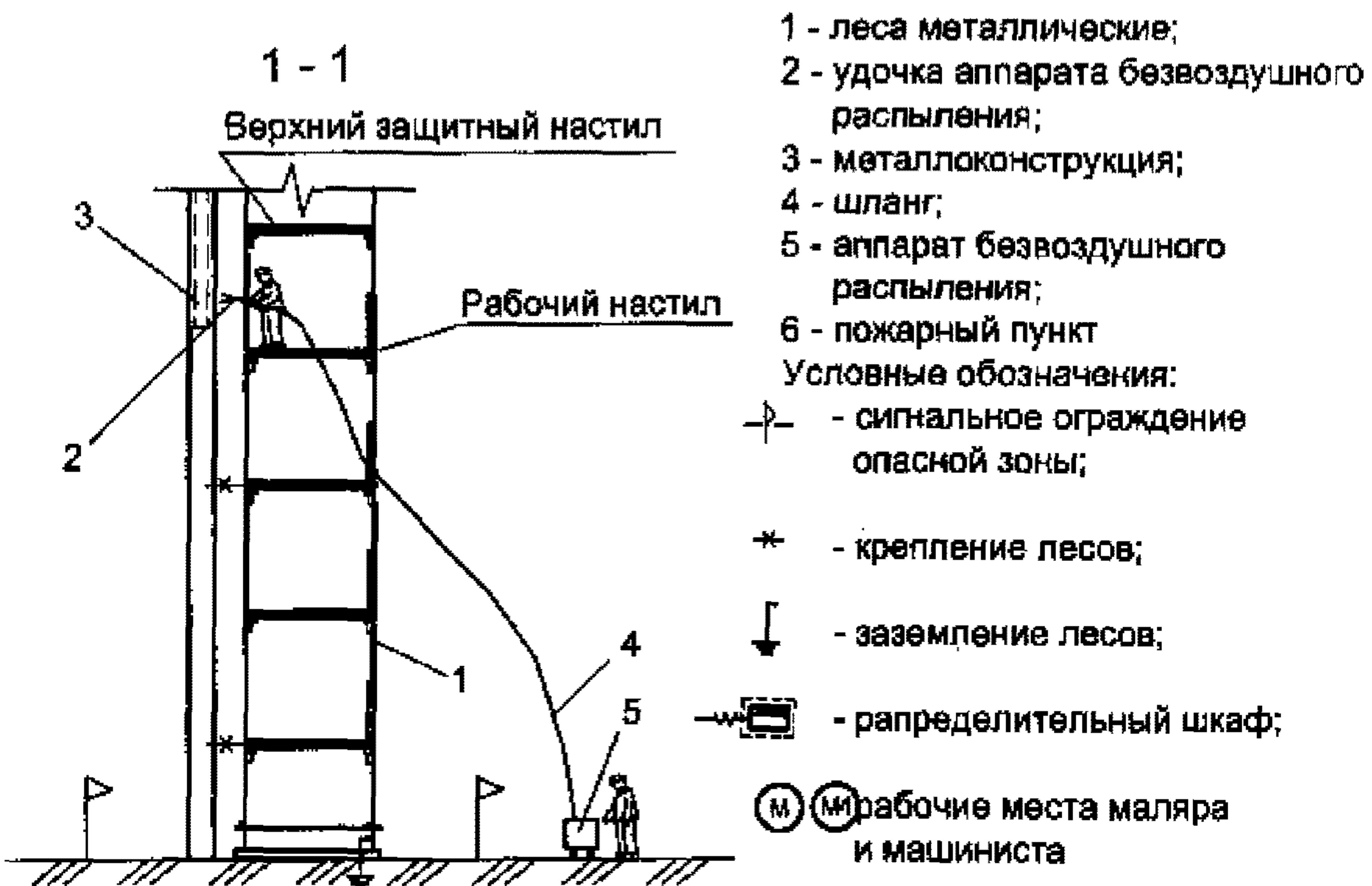
**Рисунок 1 - Схема организации рабочих мест при выполнении работ по нанесению огнезащитного состава или покровной эмали механизированным способом на стальные конструкции с металлических лесов**
