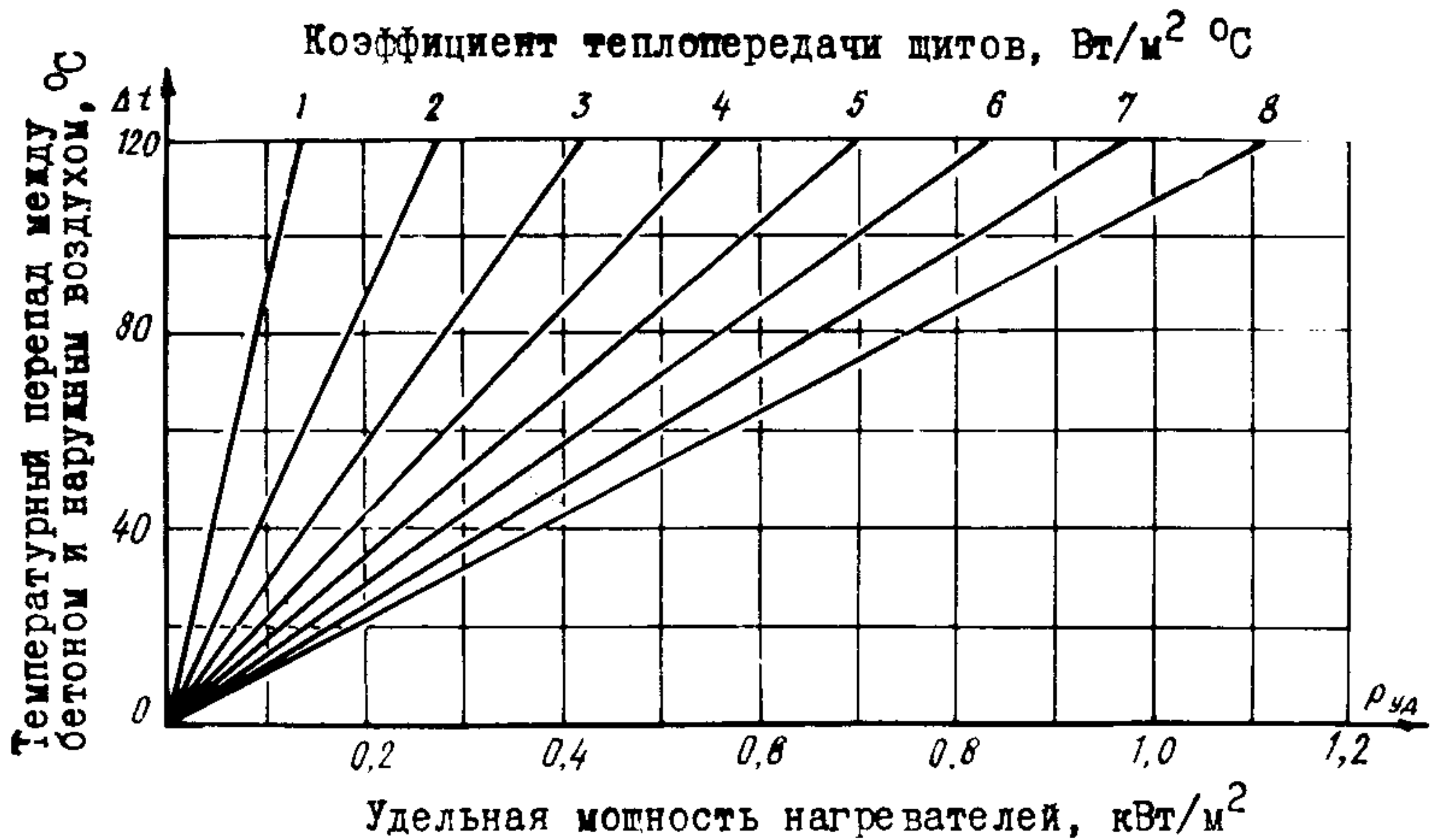
Рис.16. Номограмма для определения удельной мощности нагревателей ТОЦ на стадии изотермического прогрета и "регулируемого термоса"
