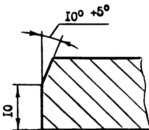
Рис. 2 Параметры разделки стыка
