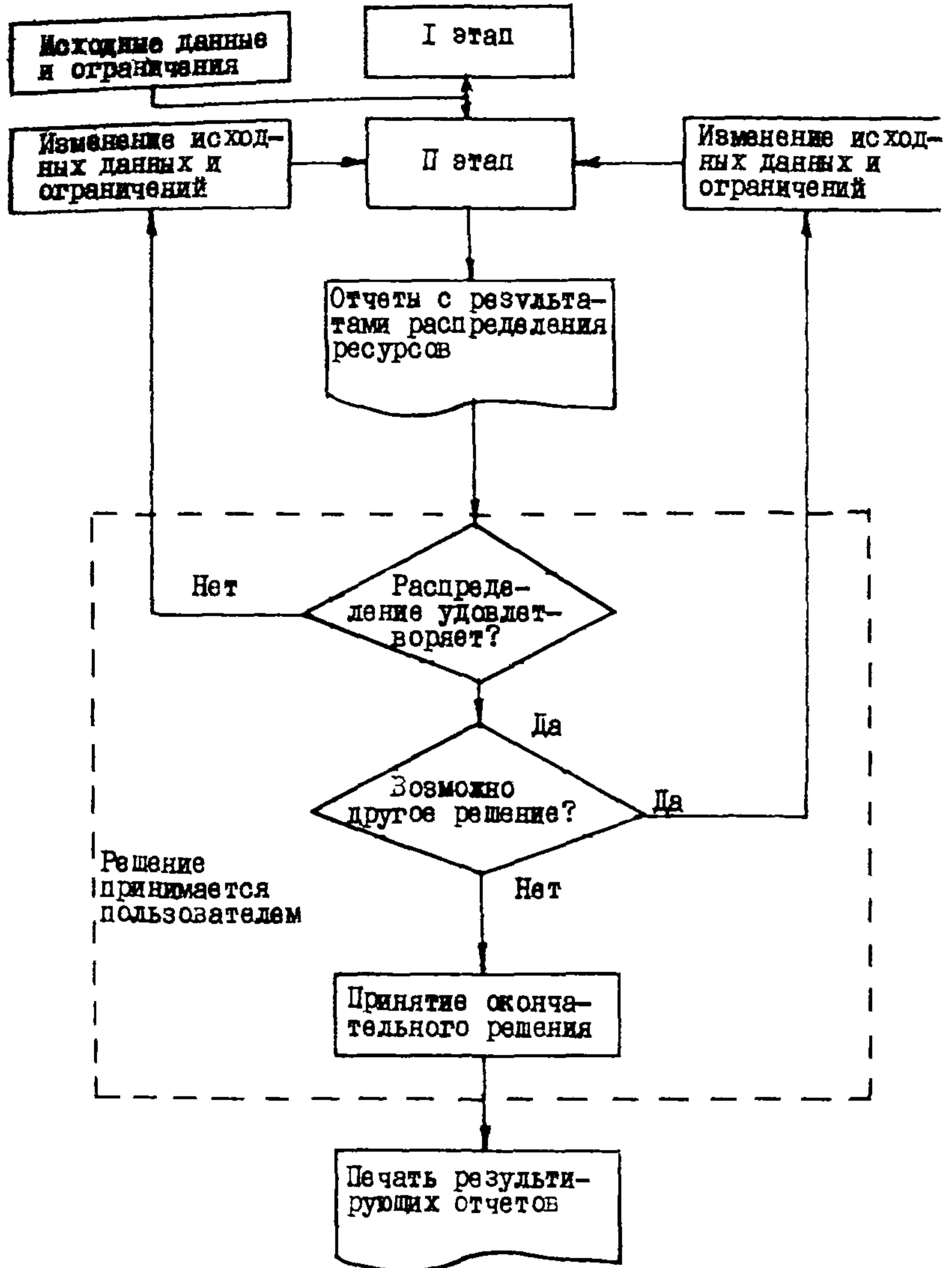
Рис.3. Принцип работы системы
