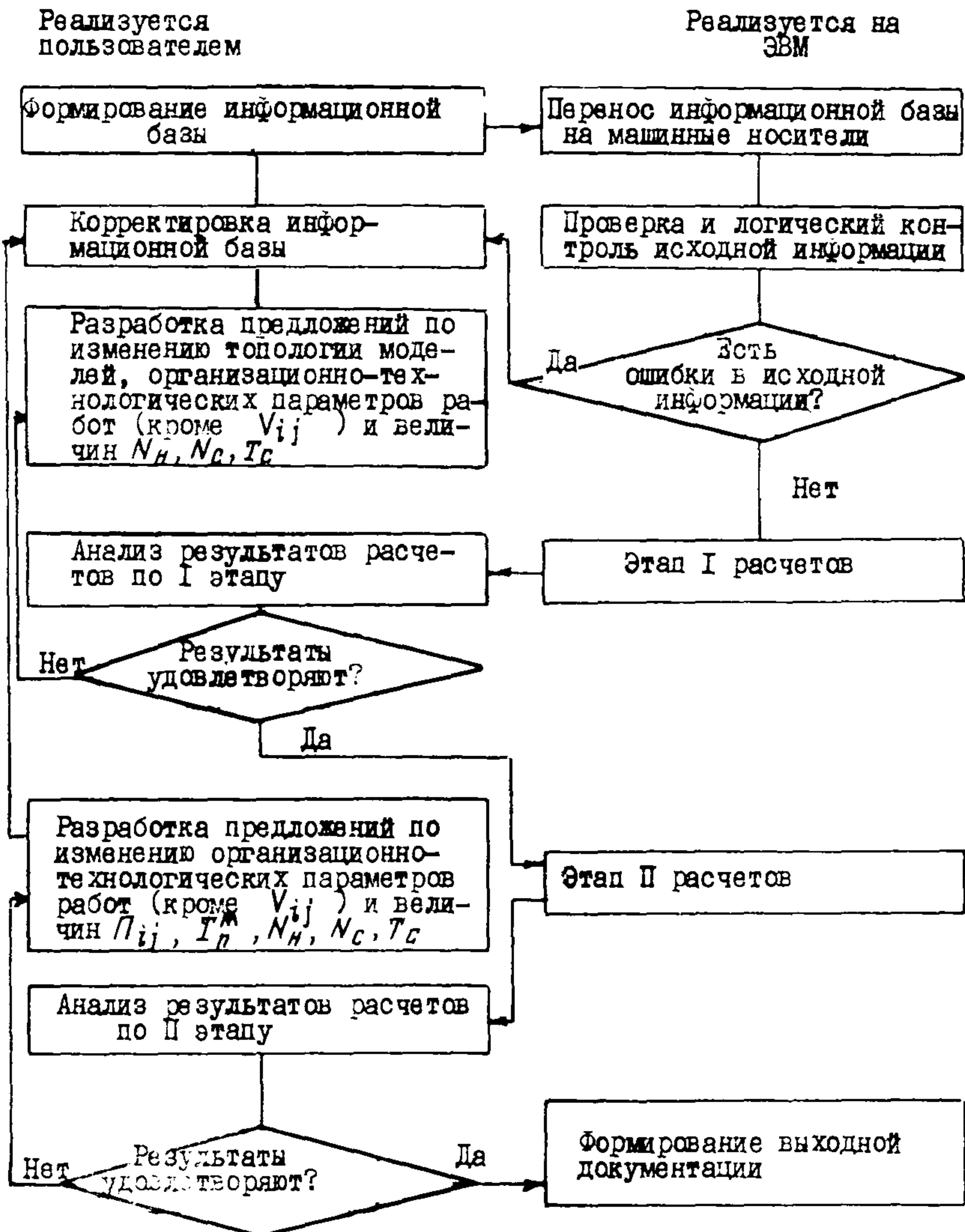
Рис.6. Блок-схема формирования календарного плана производства строительно-монтажных работ на ЭВМ
