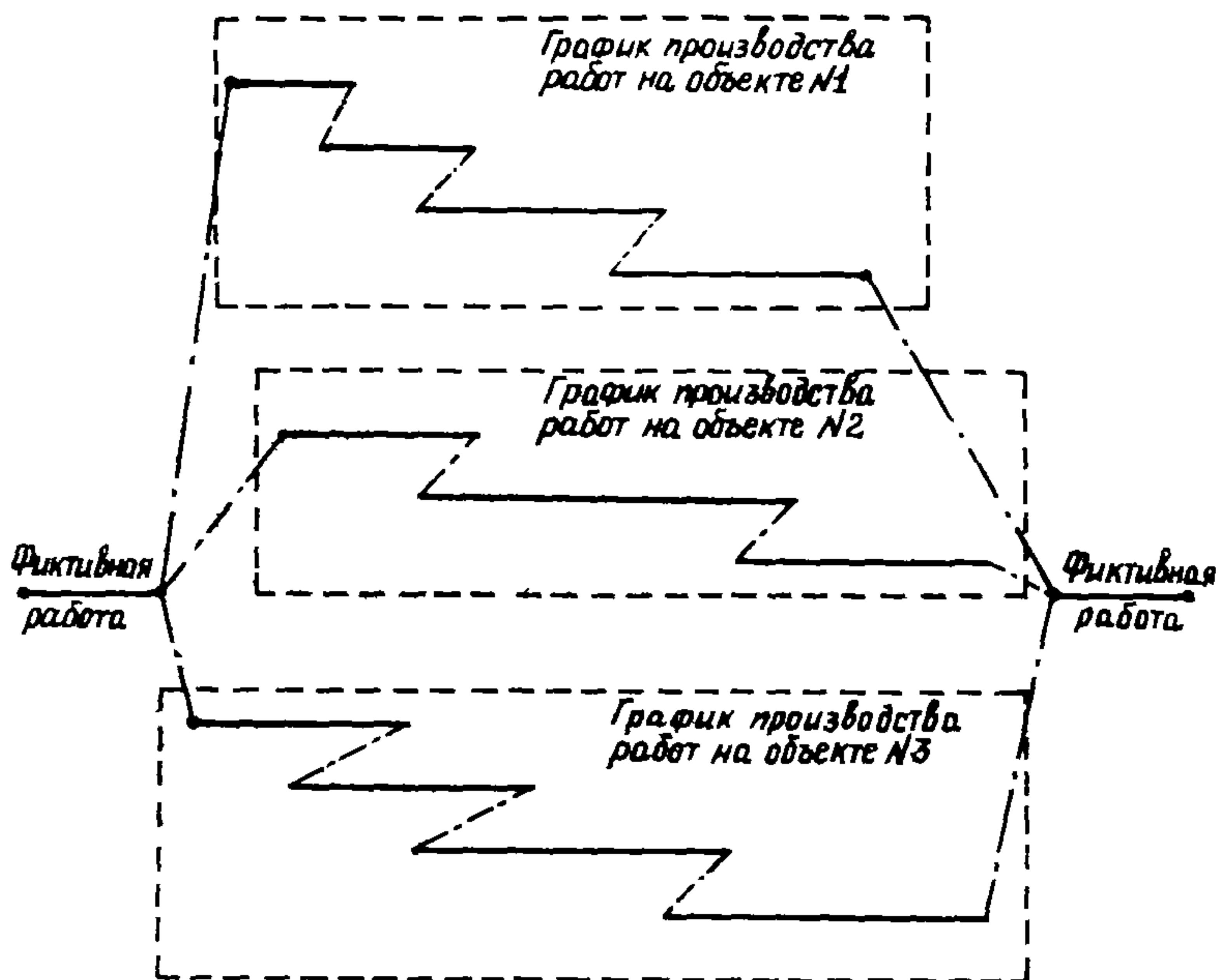
Рис.7. Пример агрегирования графиков выполнения работ на объекте
