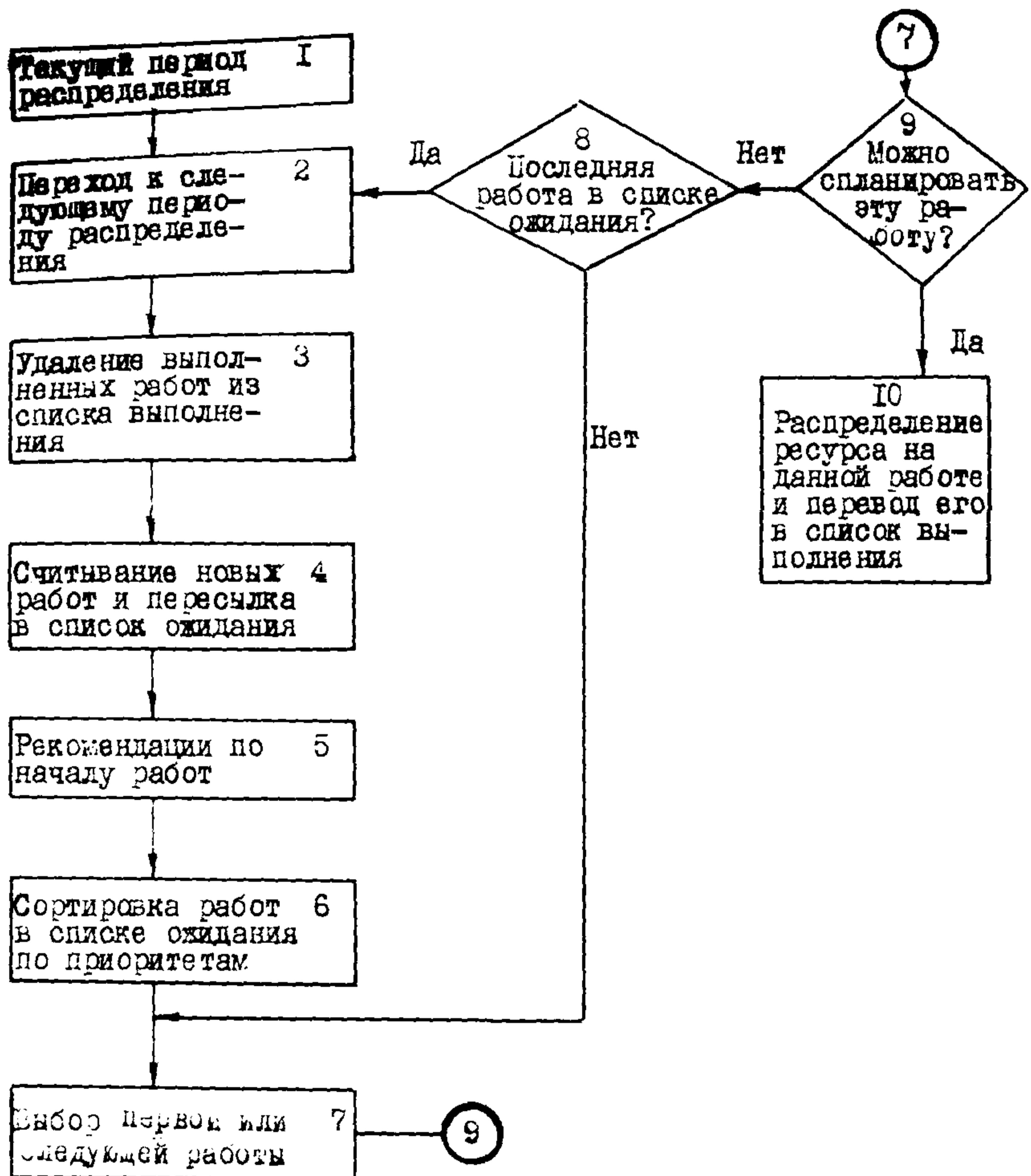
Рис.4. Блок-схема распределения ресурсов
