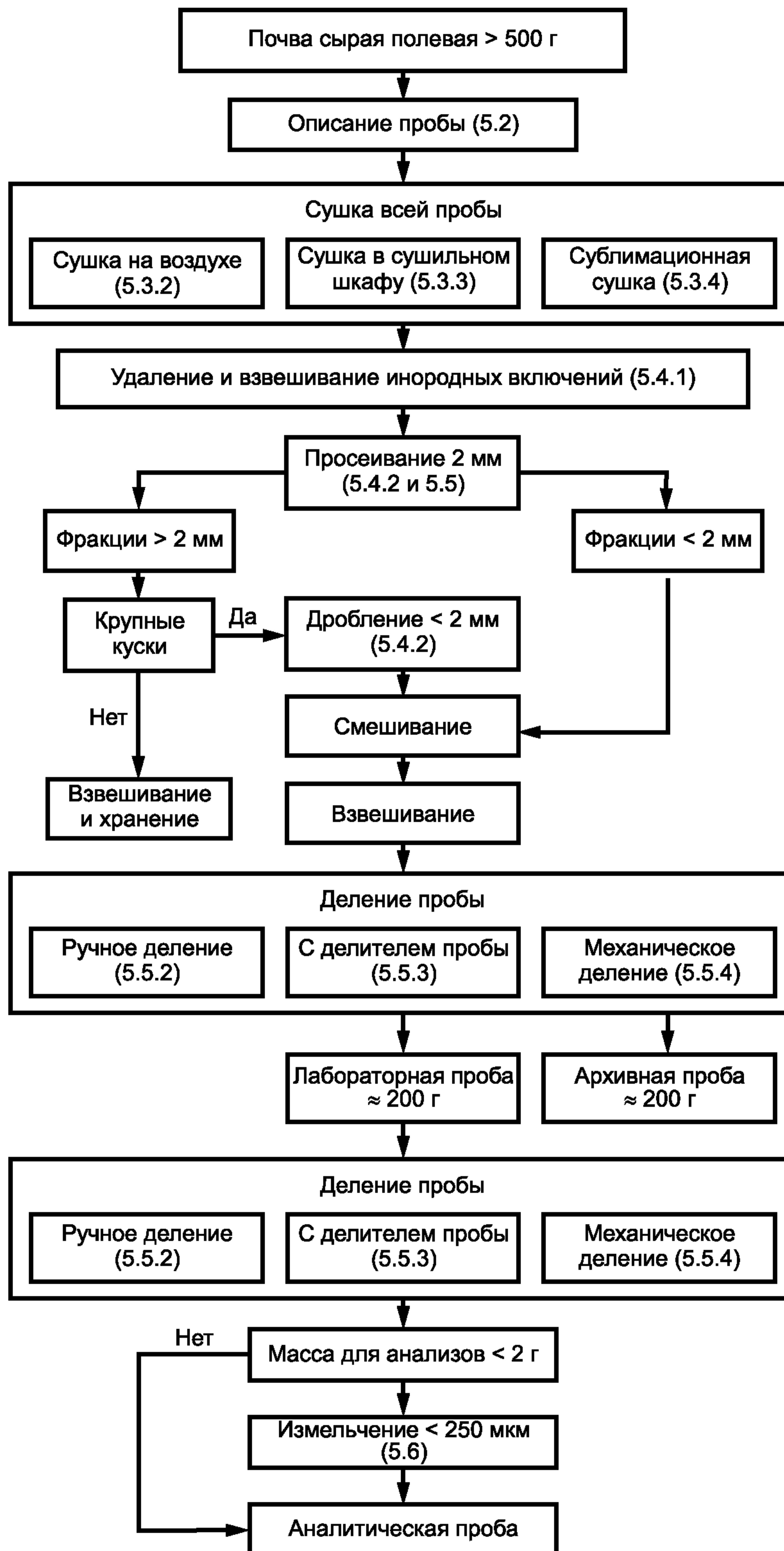
Рисунок 1 — Схема предварительной подготовки проб
