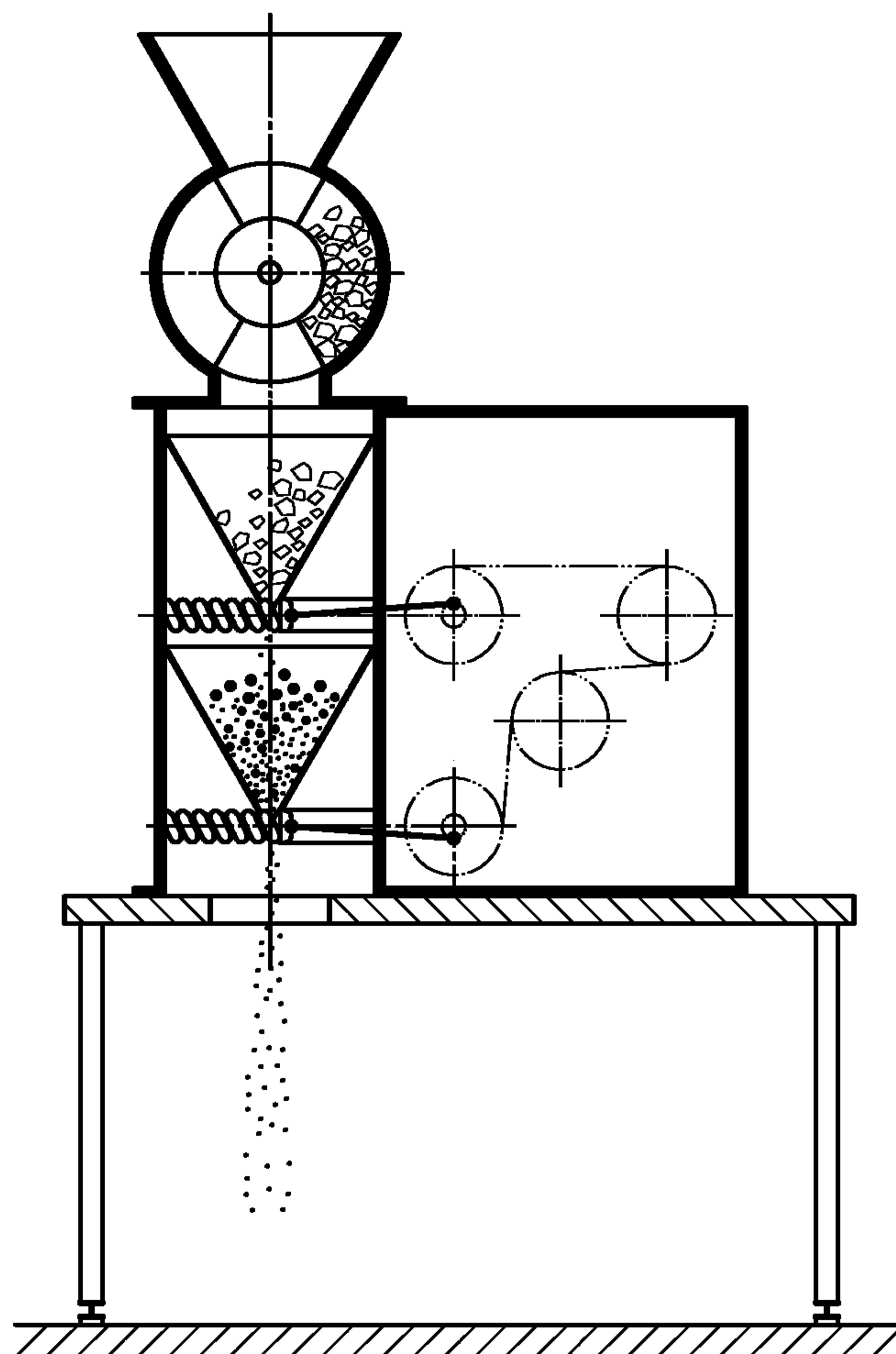
Рисунок A.1 — Пример механической дробилки для почвы
