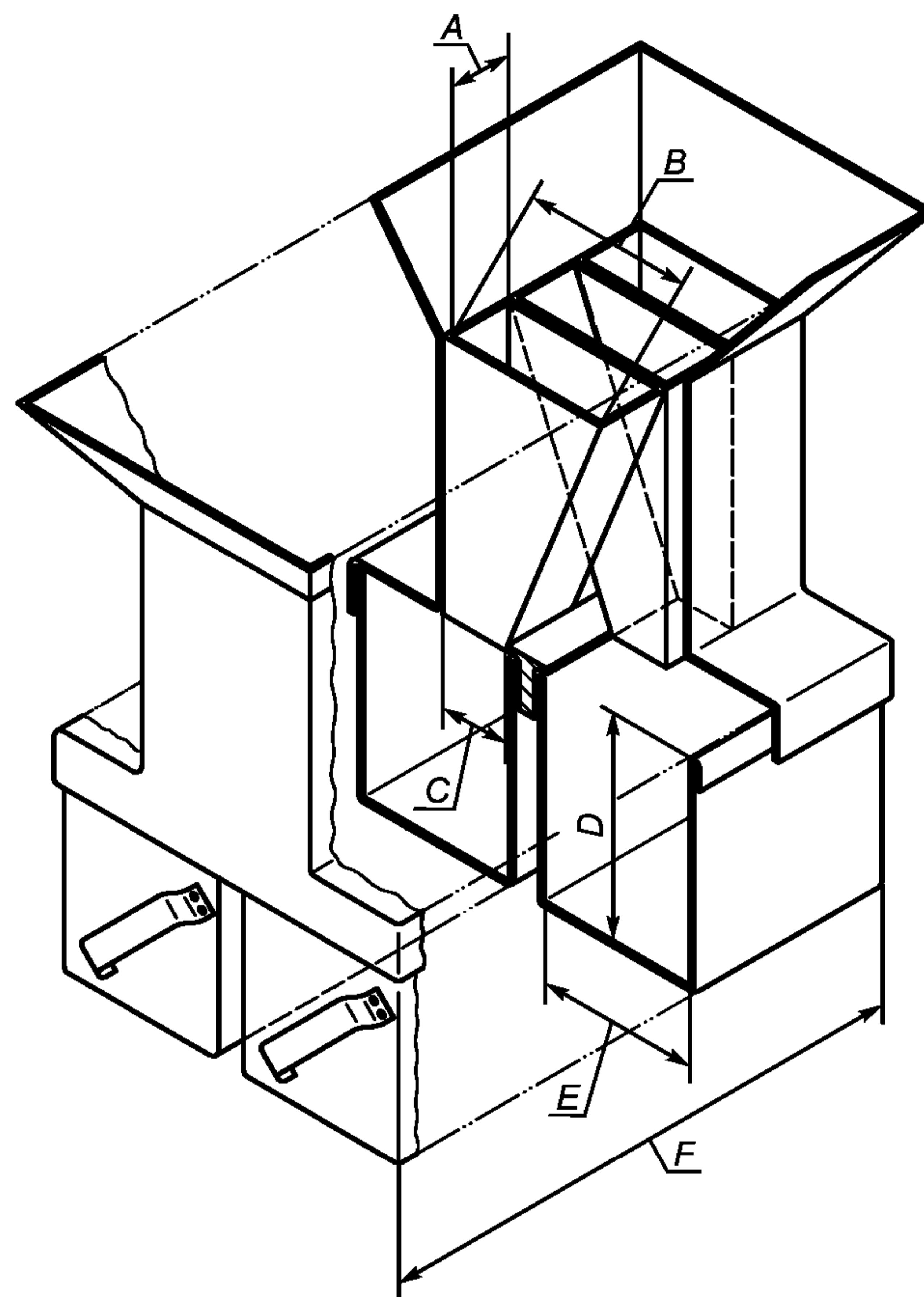
Рисунок А.2 — Пример механического делителя пробы
