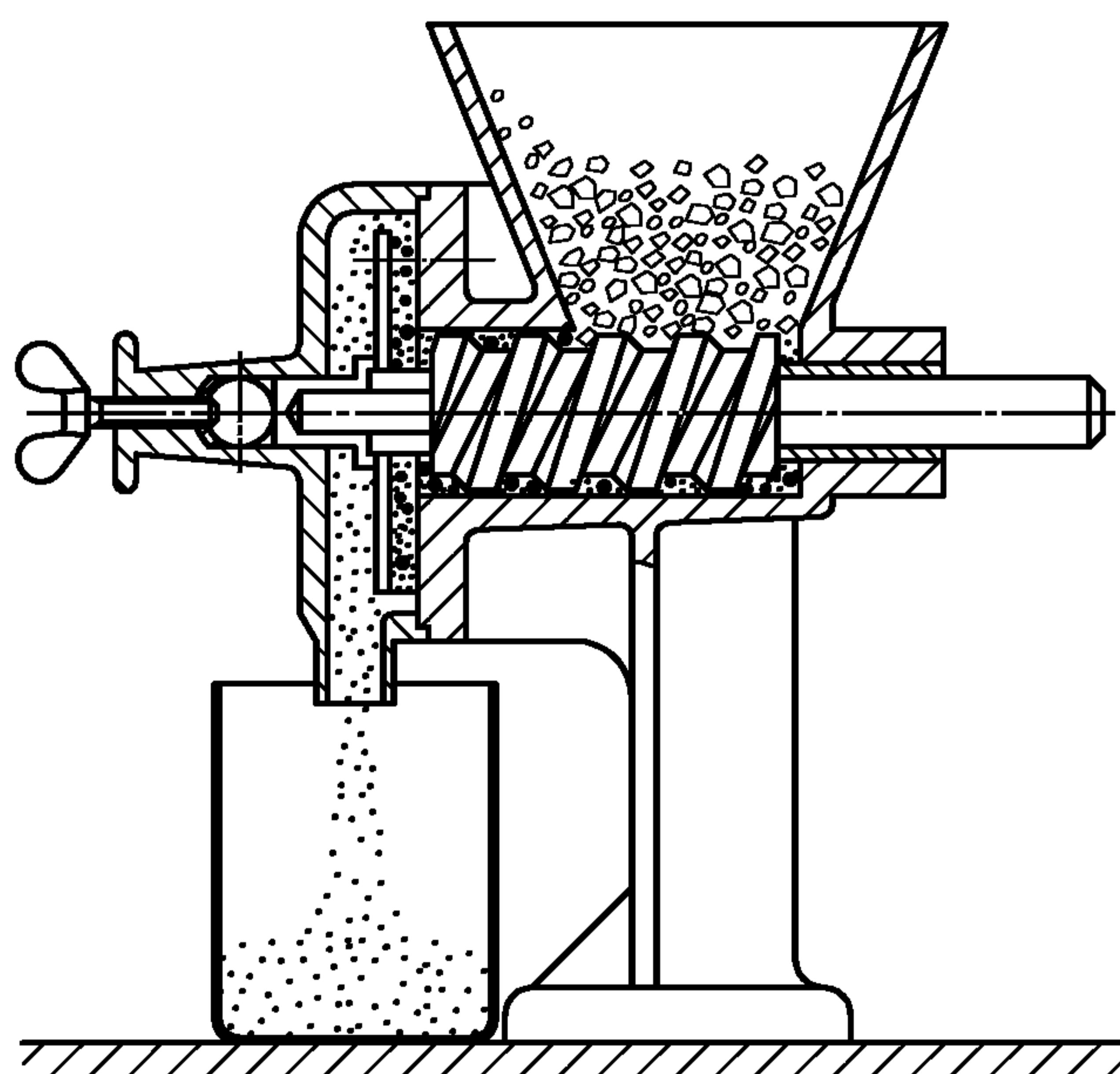
Рисунок А.4 — Пример механической мельницы
