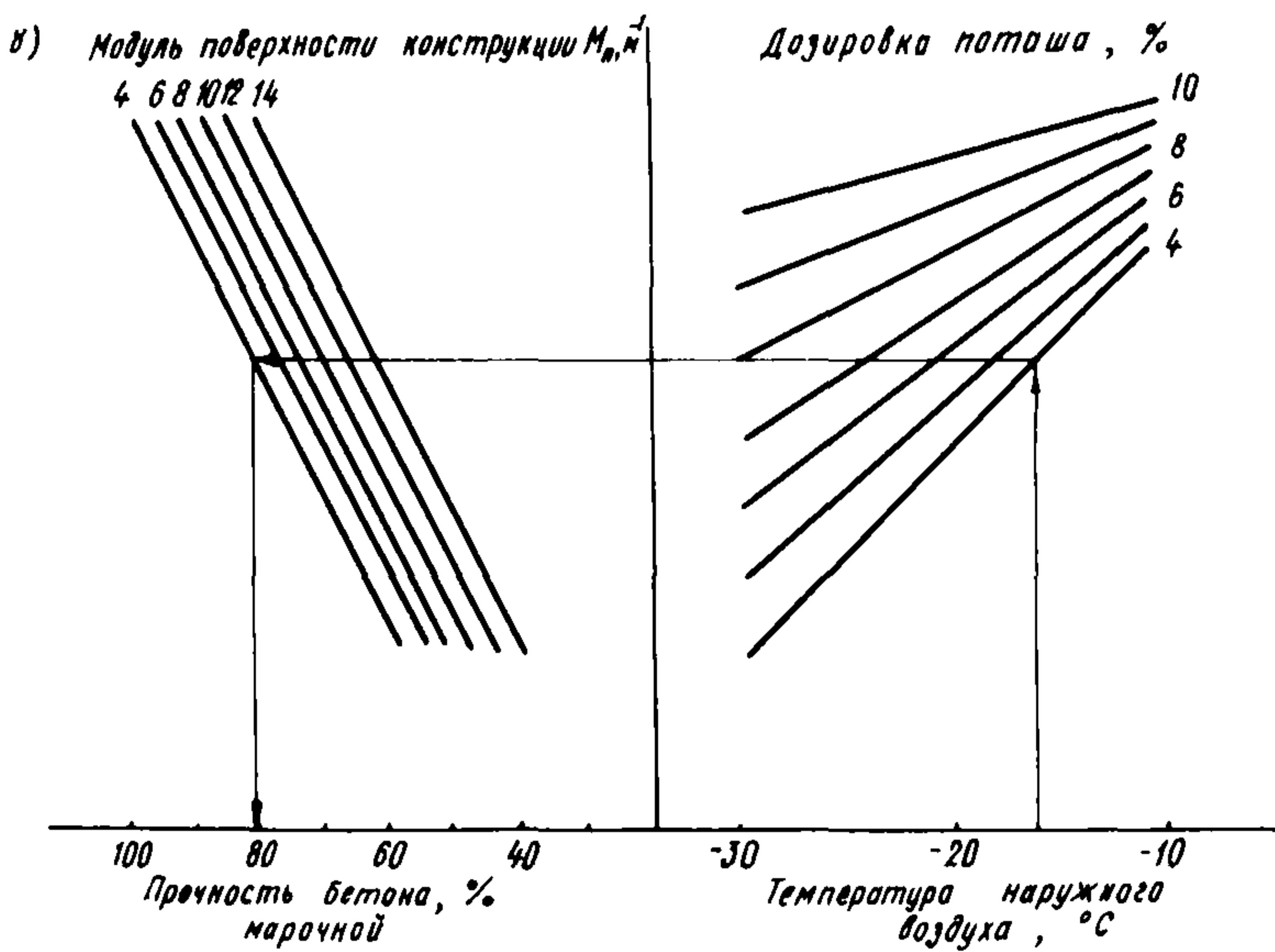
Номограмма для определения дозировки поташа и прогнозирования прочности бетона в возрасте 7 сут (а), 14 сут (б) и 28 сут (в)
