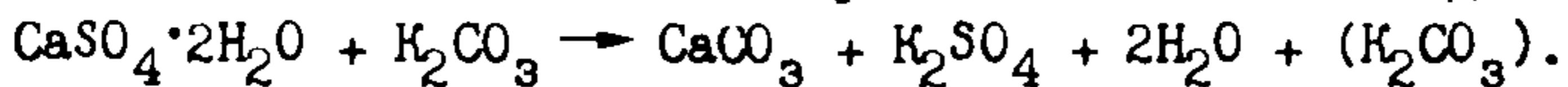
Образующиеся в результате обменной реакции продукты ( $\text{CaCO}_3$  и  $\text{K}_2\text{SO}_4$ ) не являются противоморозными добавками и поэтому не обеспечивают гидратацию цемента при отрицательной температуре. В результате данной реакции часть поташа (приблизительно 4 %) и гипс (5 %) выводятся из процесса гидратации. Именно поэтому минимальная дозировка поташа для обеспечения твердения бетона на морозе по данным нормативных документов составляет 5 % массы цемента.
