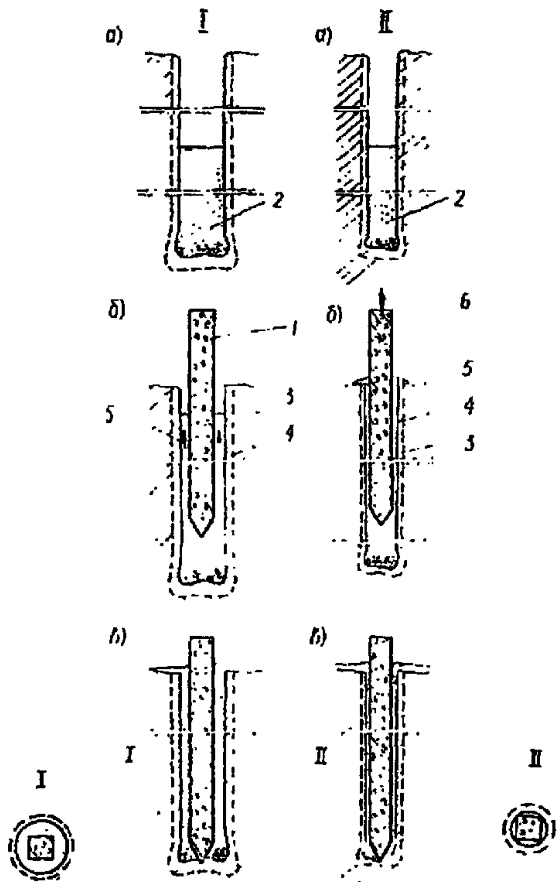
Рис.4. Способы погружения свай в скважины, пройденные паровым вибролидером:
