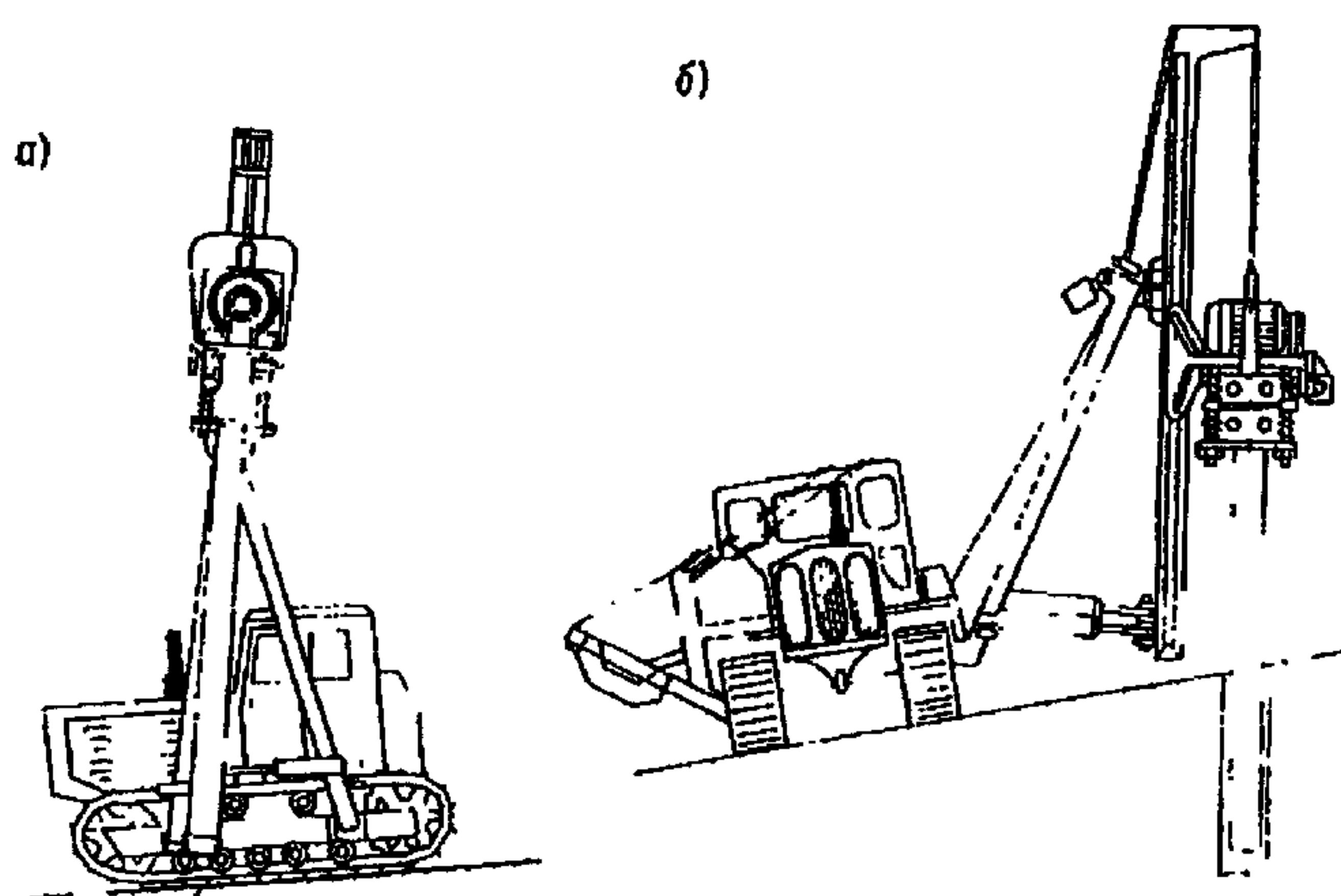
Рис.5. Обеспечение вертикальности скважин при работе установки по уклону местности (а) и перпендикулярно к нему (б)
