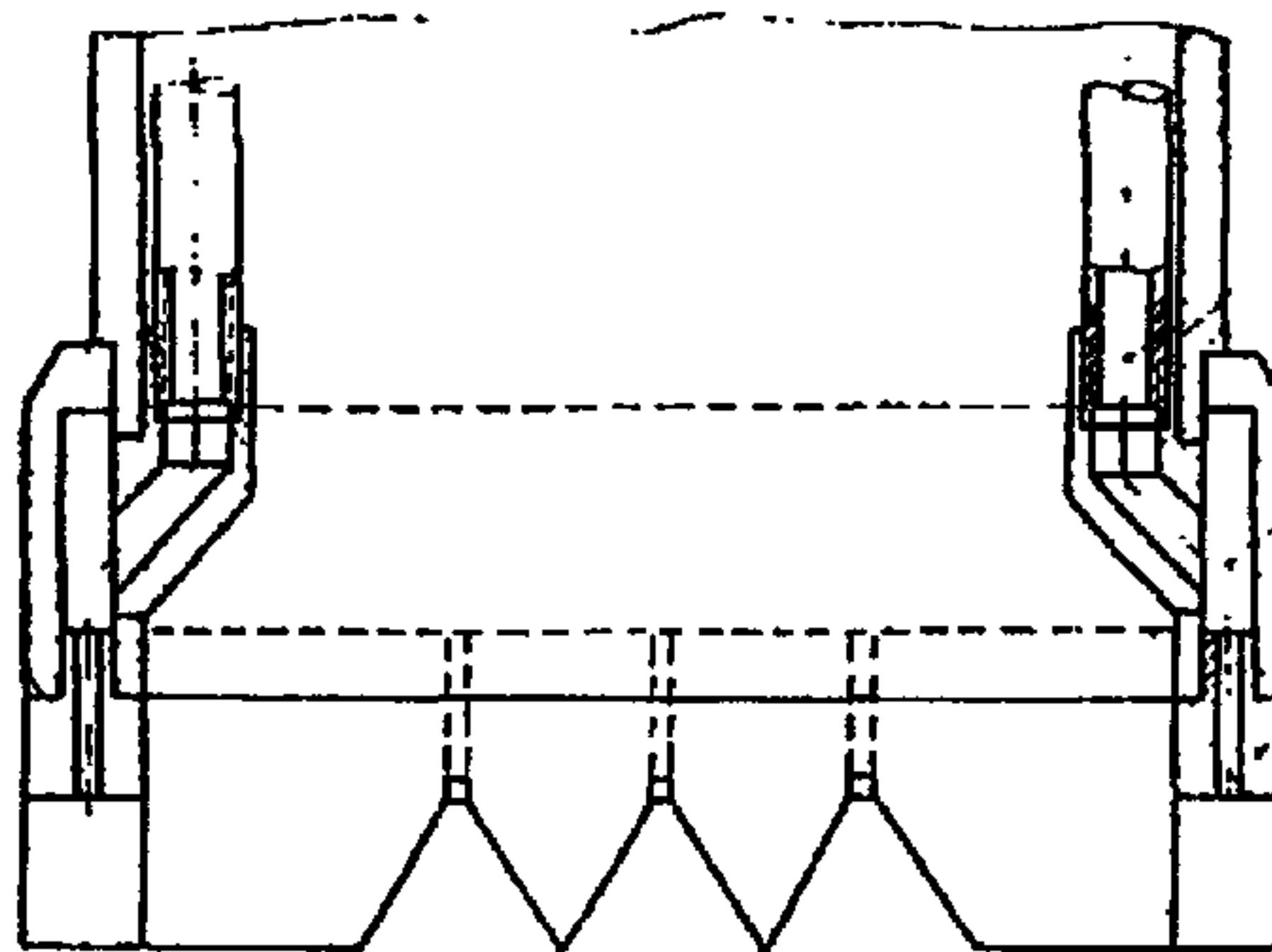
Рис.2. Конструкция нижней части лидера, предназначенного для проходки скважин в грунтах с крупнообломочными включениями:
