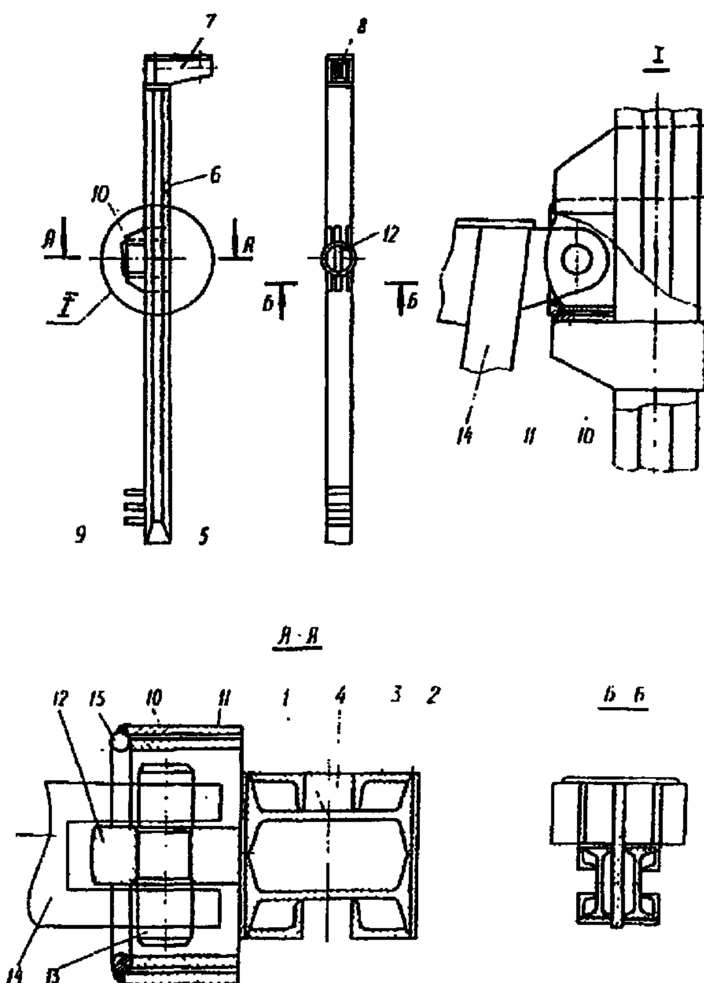
Рис.6. Направляющая парового вибролома
